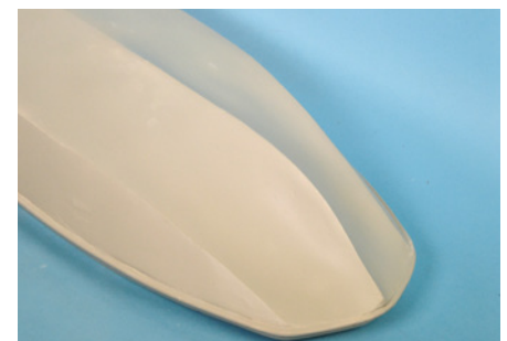
Fertig gespachtelter Bug – hier wird erstmals die besondere Rumpfkonstruktion sichtbar
