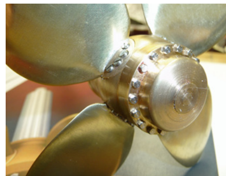
Die Blattschaufeln sind an die Mitnehmer angelötet und montiert
