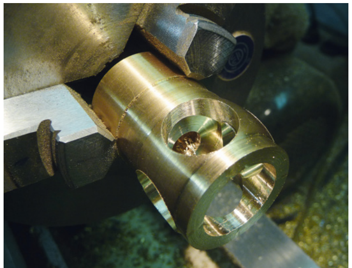
Drehen der Nabe für die Aufnahme der Verstellpropellerblätter. Die Nabe ist später fest mit der Antriebswelle verbunden
