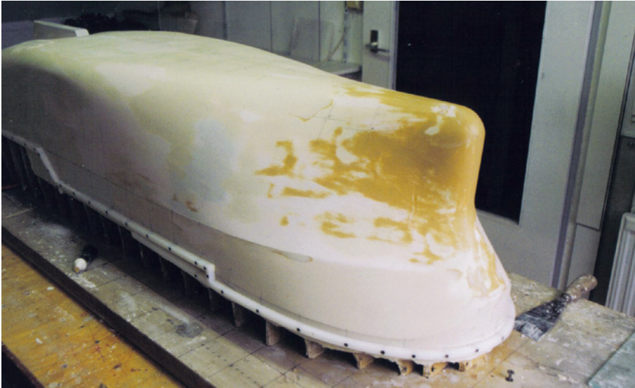
Sorgfältiges Arbeiten vor allem im Bugbereich war erforderlich, um die typische Rumpfform des AHTS-Schiffs herauszuarbeiten
