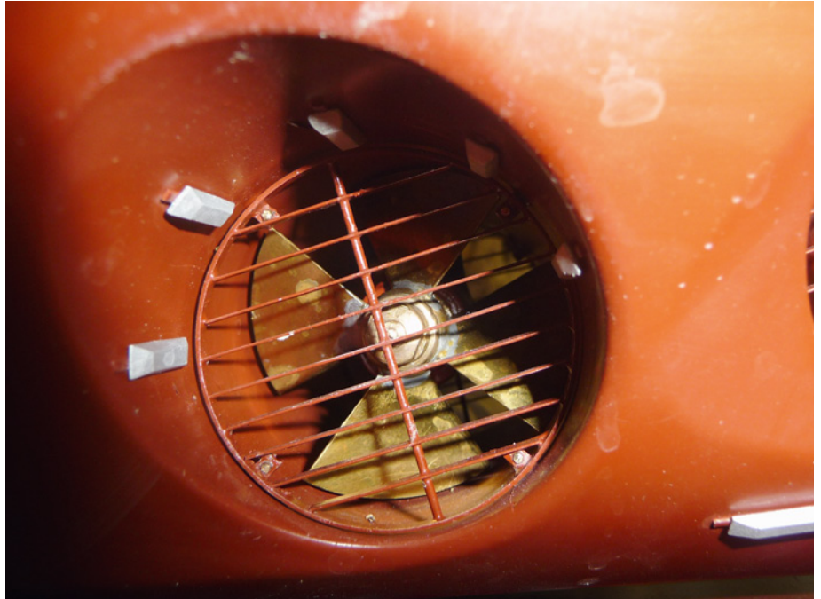
Damit sich keine Gegenstände verfangen können, schützen Sperrgitter die Antriebe. Opferanoden sind übers ganze Unterwasserschiff verteilt
