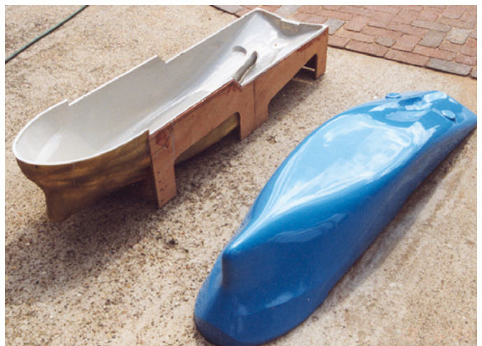
Die Negativform ist sehr stabil ausgeführt und versteift, im Verzug zu vermeiden, sowie mit fünf Löchern versehen, die das Herauslösen der Positivformen erleichterten. Die blaue Farbe ist direkt im Gelcoat eingebracht
