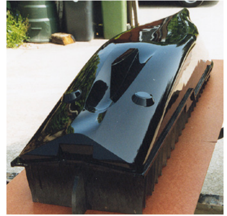
Nachdem die letzten Spachtel- und Schleifarbeiten am Polyester abgeschlossen waren, wurde der Urrumpf schwarz-glänzend lackiert, um allerletzte Unebenheiten zu erkennen und zu beseitigen – erst danach erfolgte der Negativ-Abzug
