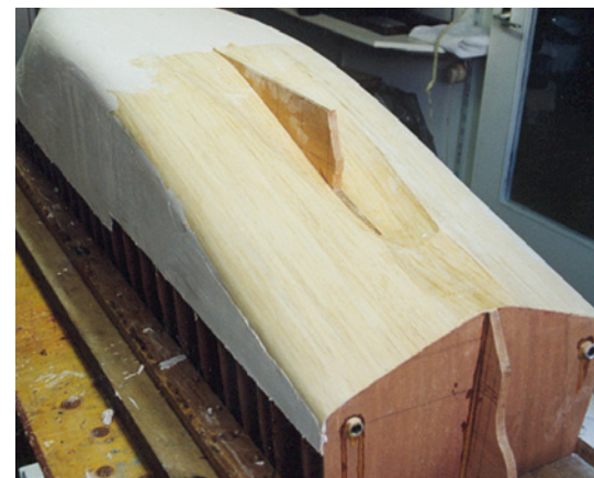
Nach Fertigstellung der Beplankung folgte das obligatorische Spachteln mit Polyester, dem wiederum mehrere Schleifgänge folgten
