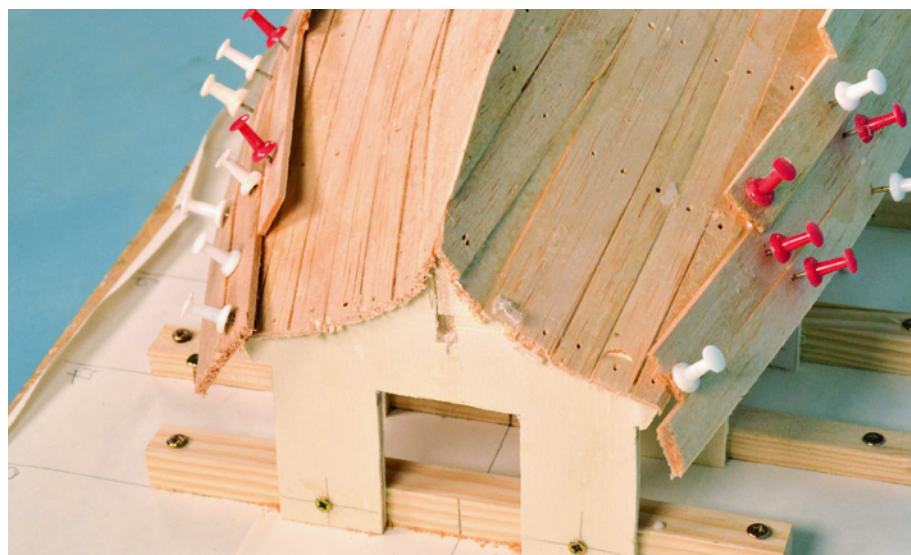
Der Bugspant ist angeklebt. Im nächsten Schritt sind vorgeformte Bugklötze anzubringen
