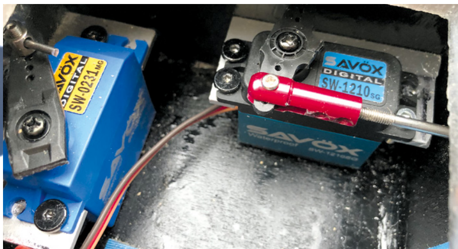
Die beiden Test-Servos befinden sich in einer RC-Box für ein Verbrenner-Rennboot. Das SW-0231 übernimmt die Gasanlenkung und das stärkere SW-1210 die Ruderansteuerung
