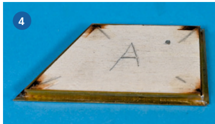
Gelöteter Rahmen, Innenseite mit Innenholzteil
