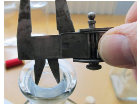
Zum Bestimmen des Flaschenhalsdurchmessers hat sich eine Schieblehre bewährt
