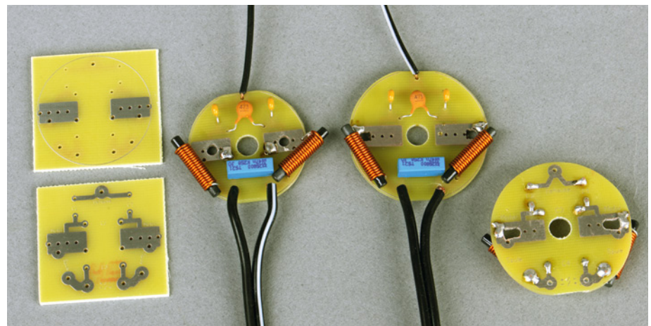
Links die kleine Platine EF32 eckig mit Vor- und Rückseite. Mittig die bestückte EF32 und 38 in rund und ganz rechts EF38 Rückseite rund
