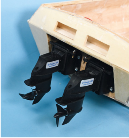
Der Spiegel im Rohbau mit den beiden Z-Antrieben Typ G-Power 150 von Bauer
