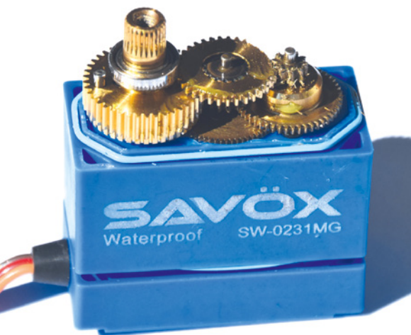
Metallgetriebe und Coreless-Motoren ermöglichen hohe Stellkraft und -genauigkeit
