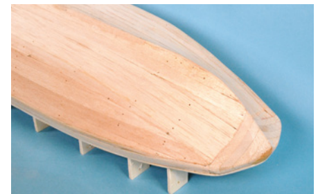
Fertig verschliffener Bugklötz aus 10-mm-Balsaplatten
