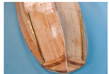
Aufgesetzte Verstärkungen aus 4-mm-Messing-T-Profil auf der Kimm im Bugbereich
