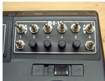
Ein spezielles Multiswitch und Prop-Modul gestattet das Ansteuern von Winden, Beleuchtung und einiges mehr
