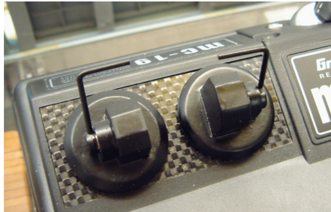
Die gezielte Ansteuerung der beiden Azimuth-Antriebe wird über die speziellen Prop-Module möglich. Sie haben einen Kipphebel für die Gasdrosselung und lassen sich drehen, um die 360-Grad-Verstellung zu steuern
