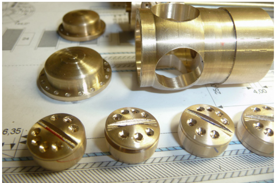
Unten zu sehen sind die vier Mitnehmer für die Schraubenblätter – in die Schlitze werden die Blätter eingelötet. Darüber rechts die Nabe und links die Verschlusskappe
