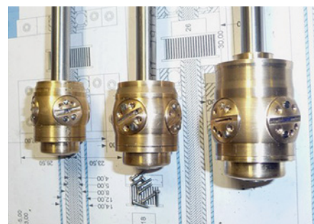
Es hat drei Versuche gebraucht – von links nach rechts – bis der Verstellpropeller wirklich funktionierte
