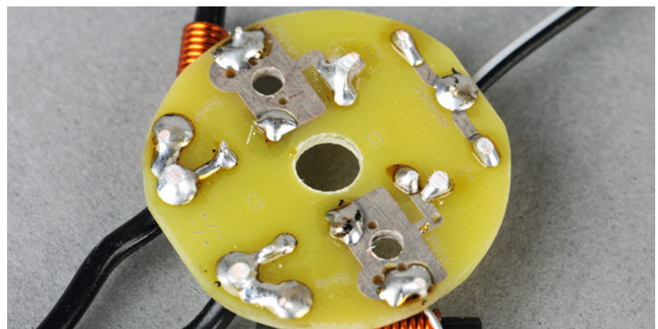
Blick auf die Rückseite, wo sich die Lötstellen befinden. Dadurch ist auch beim Anbringen am Motor eine Distanzscheibe zur Isolation erforderlich
