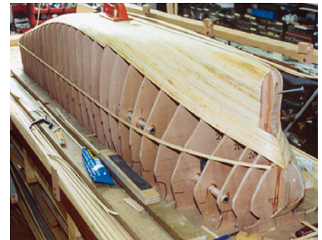
Die zahlreichen Beplankungsleisten aus Abachi-Holz wurden selbst mit Hilfe einer Kreissäge erstellt
