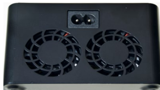
Die beiden Lüfter an der Stirnseite sind recht klein dimensioniert und limitieren das Gerät beim Entladen
