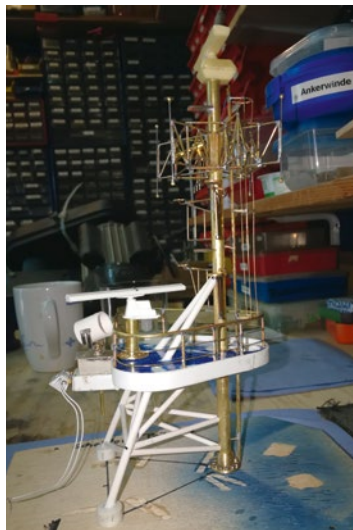
In dem filigranen Peilmast stecken nicht nur jede Menge Arbeitsstunden, sondern auch technische Feinessen wie die Beleuchtung und sich drehende Radarköpfe
