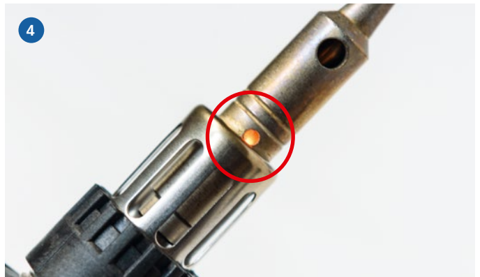
1) Insgesamt sieben verschiedene Aufsätze und ein Reflektorblech für Schrumpfschläuche liegen dem Profi-Set für knapp 120,- Euro bei. 2) Mit Hilfe des Reflektorblechs lassen sich Schrumpfschläuche einfach erhitzen. 3) Ein blauer Schieber betätigt die Zündung, der andere schaltet die Gaszufuhr ein oder aus. 4) Wenn es in der kleinen Öffnung orange-gelblich glüht, dann brennt der LötKolben. Aber Vorsicht: Hier treten auch heiße Gase aus
