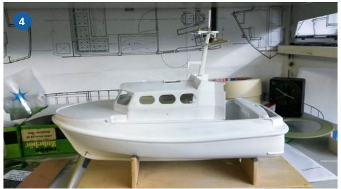
1) Bevor der Aufbau entstehen konnte, mussten in mühsamer Puzzlearbeit alle erforderlichen Polystyrol-Teile des Häger-Frästeilsatzes herausgefunden werden. 2) Die dünnen und filigranen Polystyrol-Teile so zu verkleben, dass später noch die Fenster passten, war eine der großen Herausforderungen. 3) Parallel zur EMMI entstanden auf der HANS HACKMACK alle Bereiche, die voneinander abhängen, wie die Heckwanne. Geht man so vor, sind Anpassungen gleich und nicht im Nachhinein machbar. 4) Im Mast sind Kabel für klassische Lichter untergebracht. Man kann sich vorstellen, wie eng es zugeht
