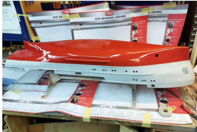
Während das Abkleben des Unterwasserschiffs noch relativ überschaubar war, kostete diese Arbeit auf dem Deck viele Stunden. Die gesamte Lackierung durfte 2 Wochen durchtrocknen
