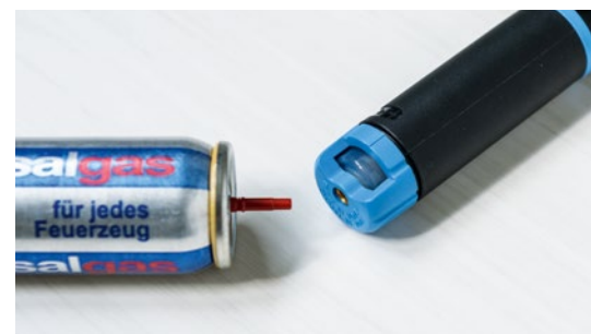
Befüllt wird der LötKolben wie ein Feuerzeug. Über das blaue Einstellrad kann die Leistung von etwa 25 bis 130 W verändert werden
