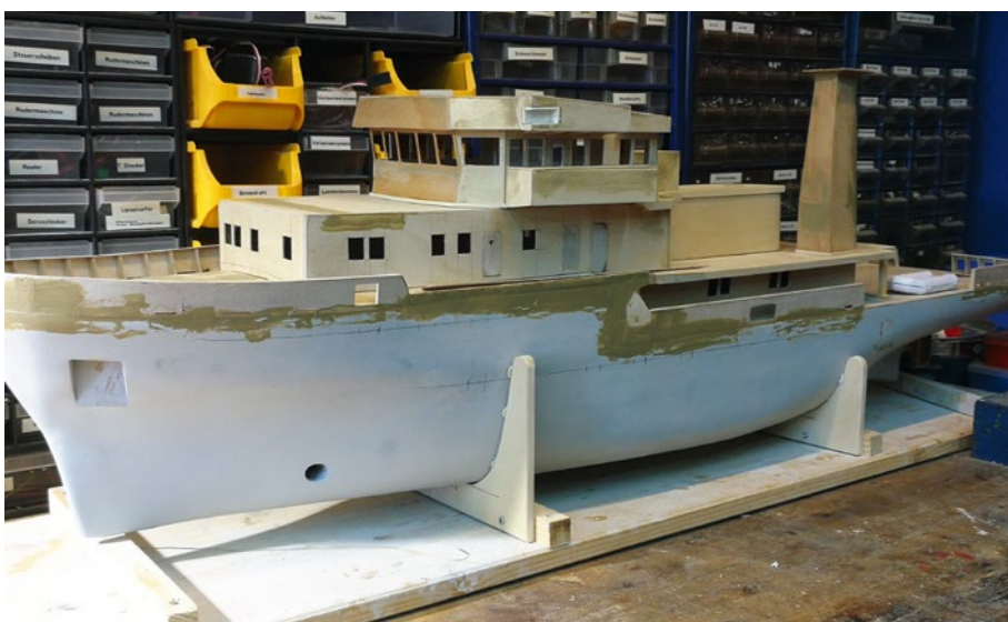
Der Rumpf der DENEb entstand ganz klassisch aus Holz. Das Bugstrahlruder und alle weiteren Öffnungen im Rumpf sind mit reichlich Harz abgedichtet
