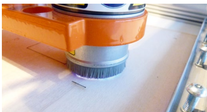
Die Kamera erkennt hier im Betrieb ein leicht bläuliches Schimmern des 445-nm-Lasers, was einem beim Tragen der Brille komplett herausgefiltert wird
