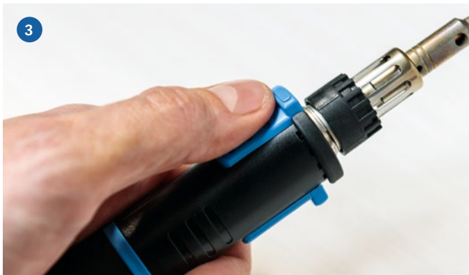
1) Insgesamt sieben verschiedene Aufsätze und ein Reflektorblech für Schrumpfschläuche liegen dem Profi-Set für knapp 120,- Euro bei. 2) Mit Hilfe des Reflektorblechs lassen sich Schrumpfschläuche einfach erhitzen. 3) Ein blauer Schieber betätigt die Zündung, der andere schaltet die Gaszufuhr ein oder aus. 4) Wenn es in der kleinen Öffnung orange-gelblich glüht, dann brennt der LötKolben. Aber Vorsicht: Hier treten auch heiße Gase aus
