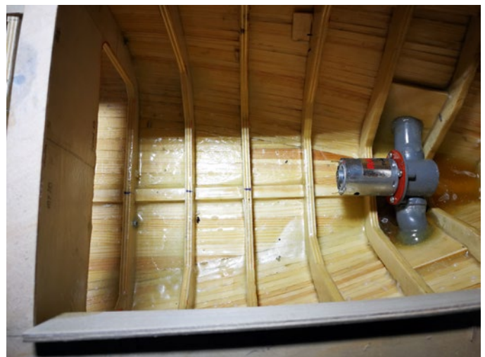
Der Rumpf der DENEb entstand ganz klassisch aus Holz. Das Bugstrahlruder und alle weiteren Öffnungen im Rumpf sind mit reichlich Harz abgedichtet
