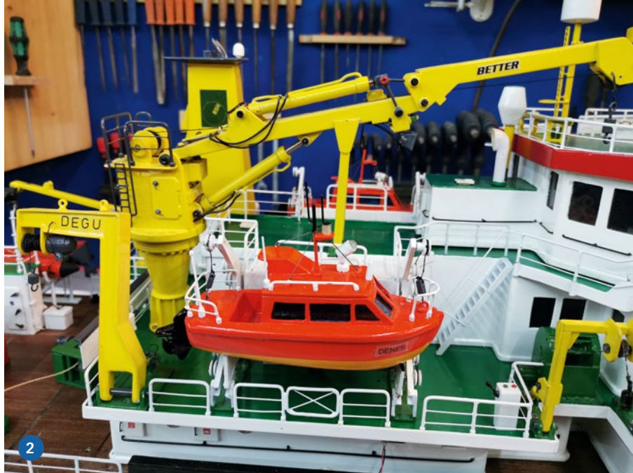
1) Langsam entsteht Leben auf dem Deck. 2) Der fertige Hauptkran ist eine wahre Augenweide. Die kleinen Beiboote entstanden ebenfalls komplett im Eigenbau, hauptsächlich aus Holz und Messingteilen
