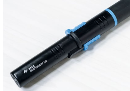
Zum Set gehört auch eine Verschlusskappe, die beim (richtigen) Aufschieben gleich die Gaszufuhr abschaltet
