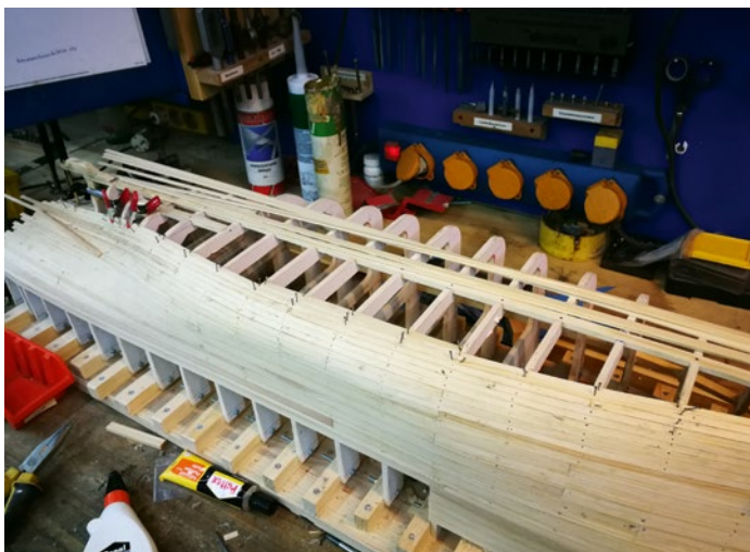
Der Rumpf der DENEb entstand ganz klassisch aus Holz. Das Bugstrahlruder und alle weiteren Öffnungen im Rumpf sind mit reichlich Harz abgedichtet
