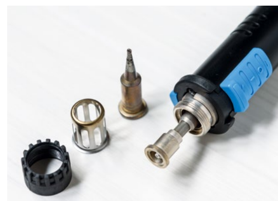
Nachdem man die schwarze Überwurfmutter aus Kunststoff gelöst hat, kann man die Lötspitze samt Halteklammer abnehmen. So dauert das Wechseln der Spitze nur Sekunden
