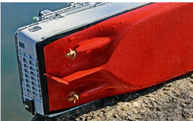
Zwei 25-mm-Propeller wurden auf 12 mm abgedreht
