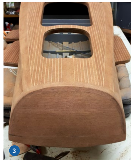
1) Im fertig geschliffenen Rumpf wurden der Antriebsmotor samt V8-Attrappe und die RC-Anlage eingebaut. 2) Auch die Klappen sind fertig mit Mahagoni beplankt. 3) Besonders anspruchsvoll und zeitintensiv war die Verkleidung des Spiegels
