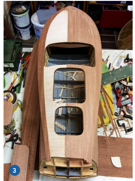
1) Der Rumpf wurde innen mit Bilgenfarbe lackiert. 2) Die Rahmen der Zugangsklappen wurden aus mehreren Schichten Mahagonifurnier hergestellt. 3) Wichtig bei der Beplankung mit Furnier ist es, die überall dieselbe Faserrichtung beizubehalten, damit es nach dem Lackieren keine Farbunterschiede gibt
