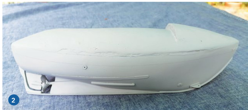
1) Der Rumpf der JOHANN FIDI wurde aus GFK-Matte direkt auf der Form laminiert. 2) Das Tochterboot ist grundiert
