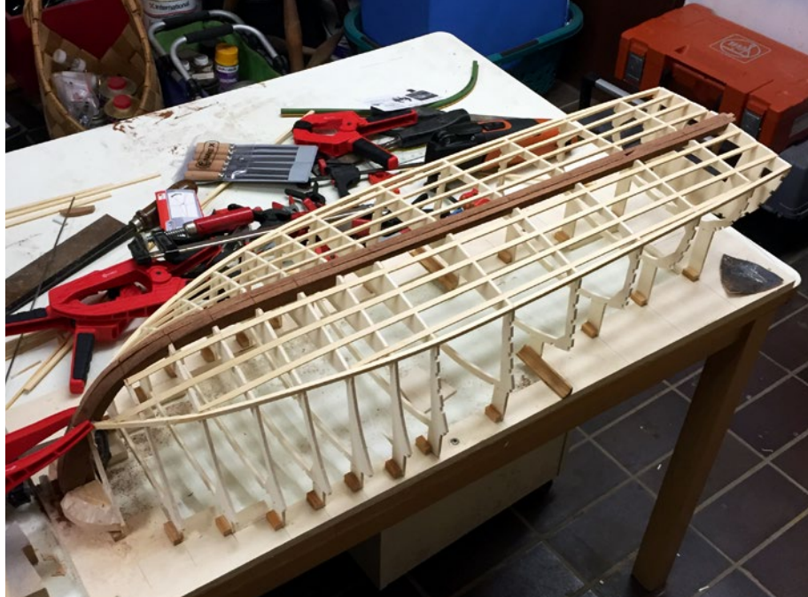
Das Grundgerüst der RIVA entstand aus Pappelsperrholz und Kiefernleisten
