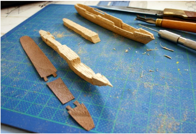
Der in der „Schultz’schen Schüsseltechnik“ zerlegte Rumpf
