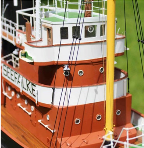
Die Bullaugen wurden in Weiß lackiert, um sie farblich von den Aufbauten abzugrenzen
