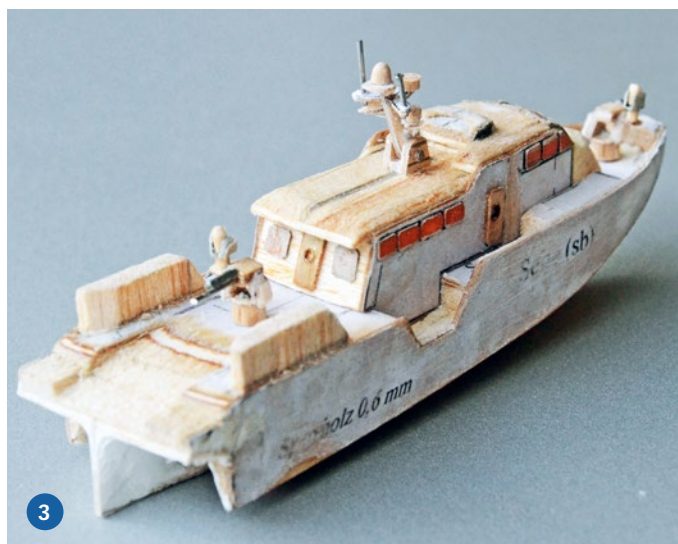
3) Das Rohmodell von steuerbord achtern. Gut zu erkennen ist hier der Klappmechanismus des Masts. 4) Der Rumpf besteht aus Balsa- und Sperrholz
