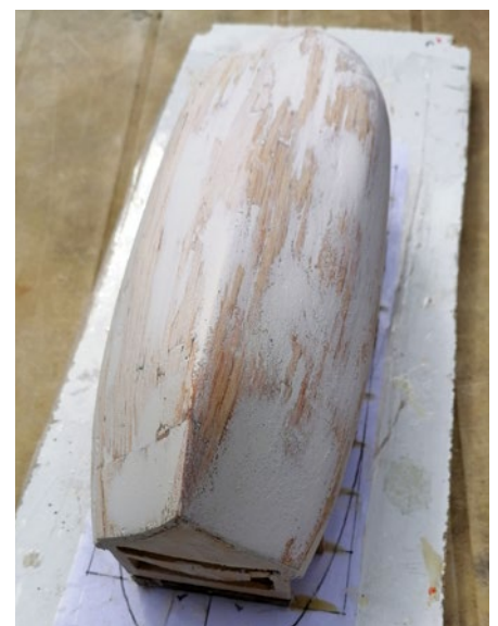
Nach dem Beplanken konnte alles gespachtelt und geschliffen werden
