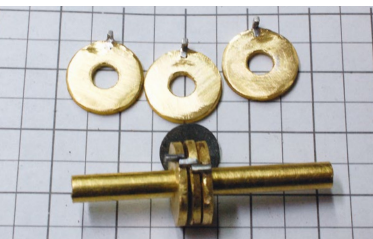
Die Mitnehmerscheiben beim Probezusammenbau
