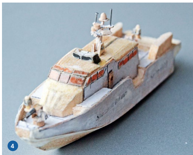
3) Das Rohmodell von steuerbord achtern. Gut zu erkennen ist hier der Klappmechanismus des Masts. 4) Der Rumpf besteht aus Balsa- und Sperrholz
