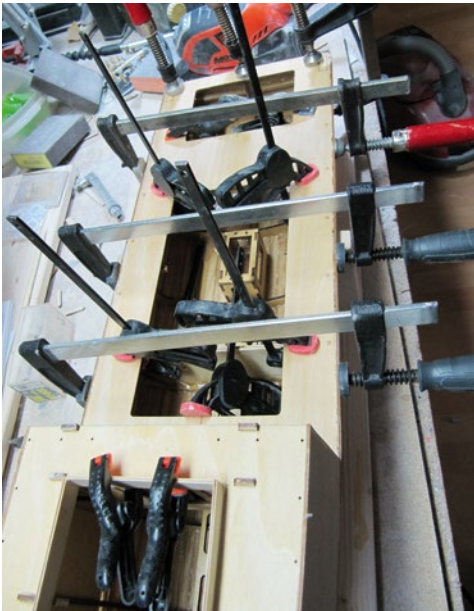
Von Schraubzwingen in Position gehalten, werden Decks und der Rumpf verklebt
