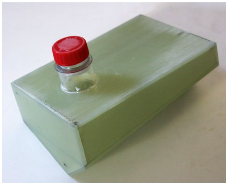
Der Smoke-Inhalt des Verdampfungssystems ist in einem aus GFK selbst gebauten Tank untergebracht – der Befüllstutzen entstammt einer Plastikflasche
