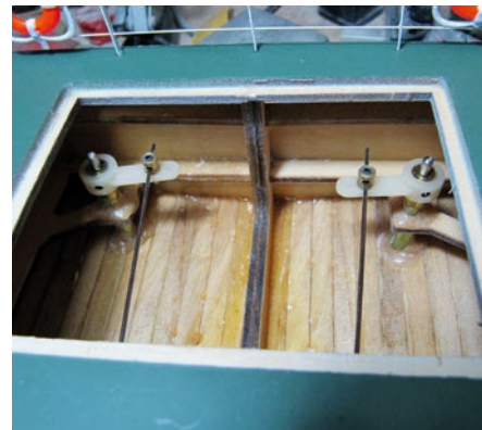
Über ein Zentralservo erfolgt die direkte Ansteuerung der beiden Ruder
