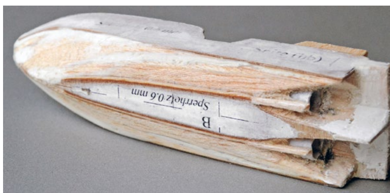
Das Rohmodell von unten. Zu erkennen die aufgeklebte Seitenverstärkung, die beiden Wellenhosen und die Kielflosse
