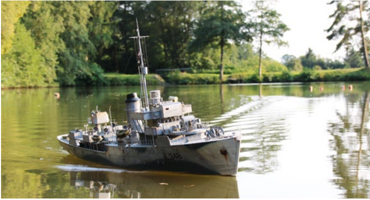
Bei der ersten ausgiebigen Probefahrt des fast fertigen Modells verrutschte ein Akku, was die Schräglage erklärt, aber die Schwimmlage war dennoch bereits gut
