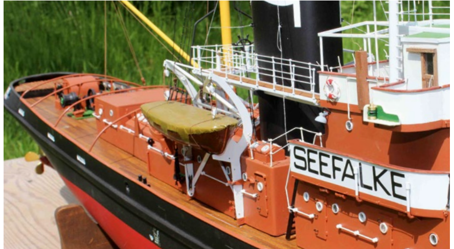
Die Beiboote wurden als fertige Rumpfschale erworben – auf der Steuerbord-Seite hängt ein hölzernes Ruderboot
