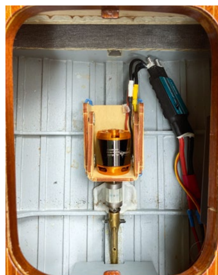
Der Brushlessmotor hat mehr als genug Leistung. Halbgas reicht für vorbildgetreue Volle-Kraft-vorausfahrt bereits aus
