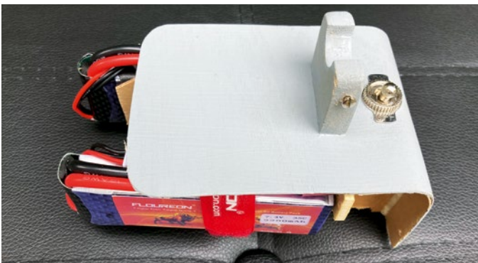
Zwei 2s-LiPos treiben die Riva an. Zusammen mit der RC-Anlage sitzen sie im Heck unter der Zugangsklappe
