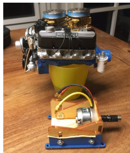
Die V8-Motoratruppe sitzt über dem eigentlichen Elektromotor. Hitzeprobleme gibt es deswegen nicht
