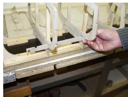
Aufstellen und Einfügen der Spanten
