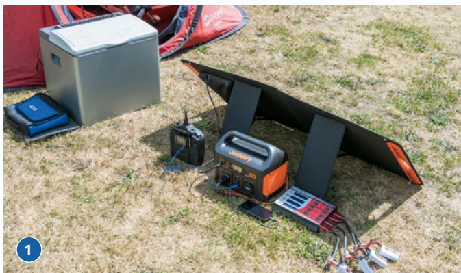
1) Das war eigentlich die Wunsch-Konstellation: Alles solar laden und auch noch die Kühlbox betreiben. Letzteres musste zumindest mit dem Jackery 500 Solargenerator von der Liste gestrichen werden, denn die Kühlbox verbraucht zu viel Strom. 2) In der prallen Sonne wird's auch mal unangenehm heiß, sodass sich der Generator lieber im Schatten aufhalten sollte
