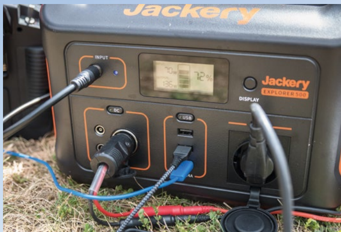
Die Anschlüsse der Generator-Box: Oben links geht's zum Solarpanel und unten reihen sich die drei separat zuschaltbaren Spannungsversorgungen auf für 12 V (10 A), USB (3 × je 2,4 A) und eine 230-V-Netzsteckdose
