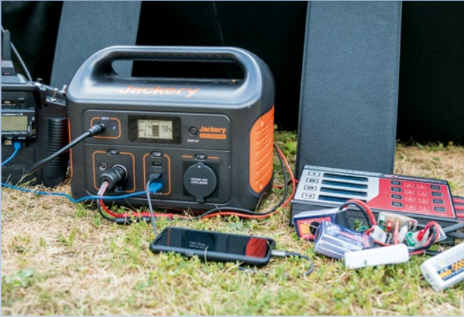
Bei diesem Bild zog eine hinterhältige Wolke vorbei, sodass die Solarzelle von den benötigten 61 W nur müde 11 W zurückspies. Aber keine Panik: Der integrierte 500-Wh-Puffer hatte noch satte 73% übrig
