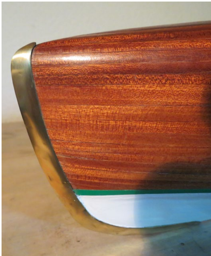
Die Bugspitze ist von einem Messing-Teil geschützt. Beim Original war der Schlagkräfte wegen so etwas ein Muss
