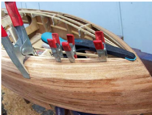
Der schwierig herzustellende Übergang zum achteren Deck
