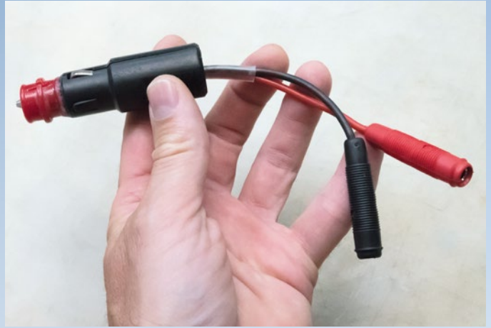
An der 12-V-Versorgungsseite steht im Wesentlichen der vom Camping bekannte Zigarettenanschluss mit 10 A Maximalstrom zur Verfügung. Hierfür wurde ein Adapter mit 4-mm-Buchsen konfektioniert
