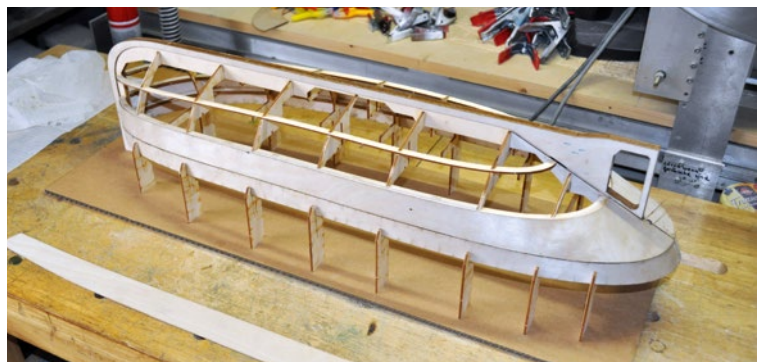
Großflächige und der sphärischen Form entsprechende Beplankungsplatten erleichtern den Rumpfbau. Wässert man die Planken vor, lassen sie sich leichter biegen
