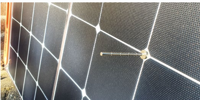
Eine möglichst lotrechte Ausrichtung zur Sonne macht sehr viel aus. Dabei hilft ein Peilstab aus ein paar Zylinder Magneten, die auf einem Scheibenmagneten stehen. Wirft der Stab keinen Schatten mehr, ist die Ausrichtung perfekt
