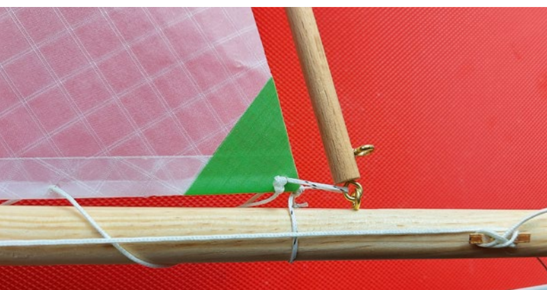
Der Baumbeschlag vor dem Umbau
