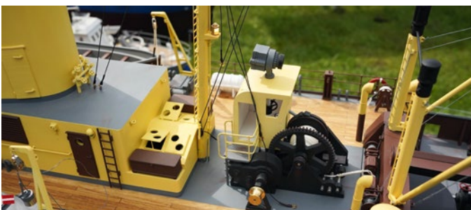
Auf dem Dach des Windenhauses, gut versteckt als Suchscheinwerfer getarnt, ist eine der drei Kameras platziert
