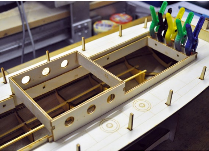
Direkt auf dem Deck wird auch der Unterbau des Deckshauses aufgebaut. Es ist nur darauf zu achten, dieses nicht versehentlich festzukleben
