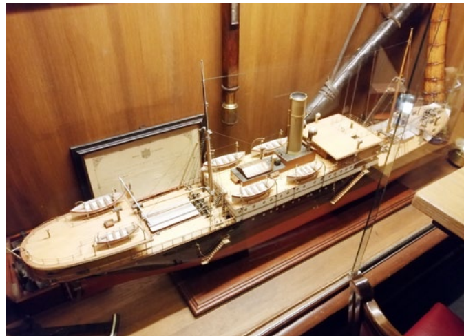
Namenloser Dampfer aus der Zeit um 1900 mit Schornstein, zwei Signalfleggenmasten und sechs Beibooten
