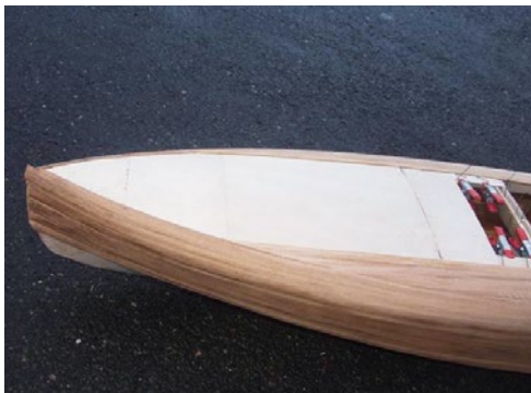
Mit der Beplankung des Decks macht das Modell optisch einen Sprung nach vorne
