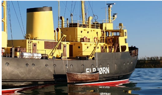
Das Beiboot lässt sich über die Davits absetzen und kann dann im Wasser treiben
