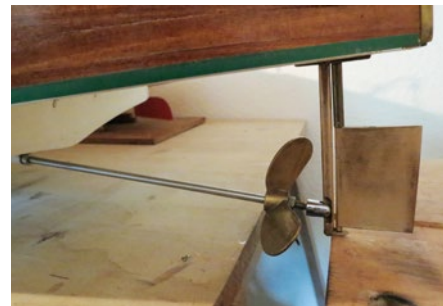
Schraube und Ruder der BABY BOOTLEGGER. Diese Beschlagteile gibt es auch beim Hersteller Exclusive Shipmodel
