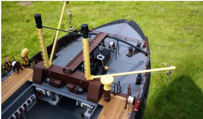
Über Kleinstmotoren können die Ladebäume abgesenkt und ein Stahlseil abgelassen werden, das wiederum einen Elektromagneten am Haken hat
