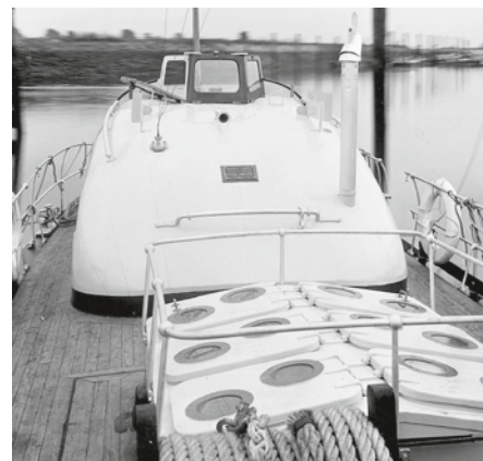
Blick auf die Schutzhaube über den Steuerstand
