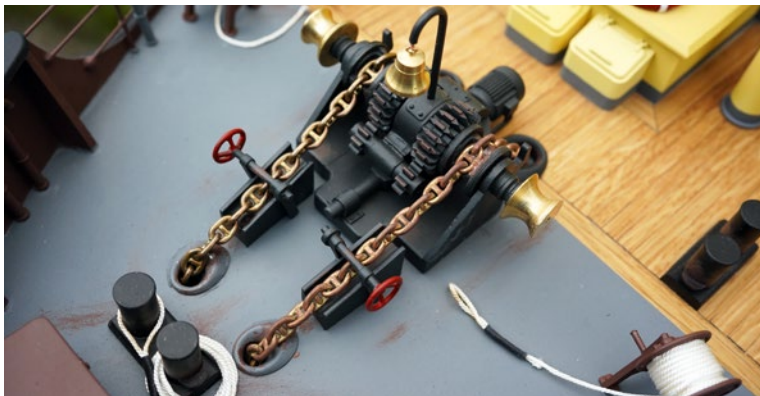
Anhand der Größe und Form der Kettenglieder wurde eine Kettennuss konstruiert sowie 3D-gedruckt, damit die Kette beziehungsweise der Anker vorbildgetreu fallen gelassen und gelichtet werden kann
