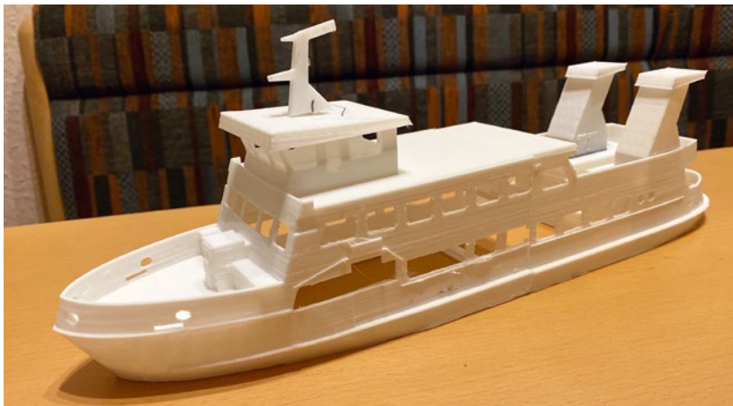
Die gedruckten Einzelteile werden am besten mit einem lösungsmittelhaltigen Klebstoff verbunden
