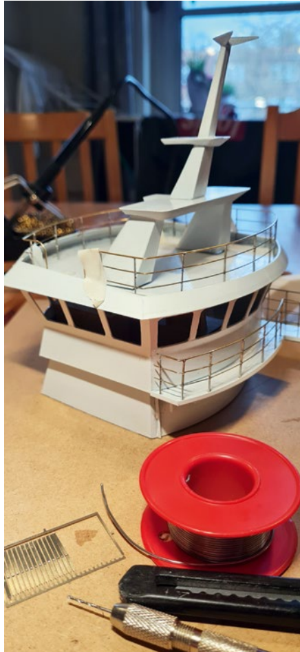
An der fertigen Brücke wird schon mal die Reling montiert
