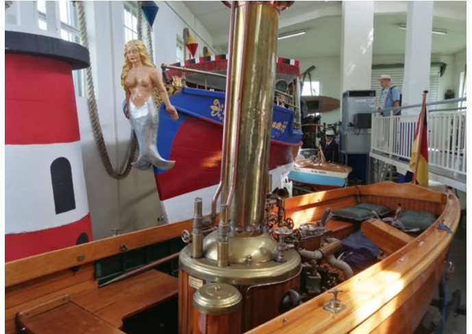
Die Dampfmaschine des englischen Boots von 1903 leistet 5 PS
