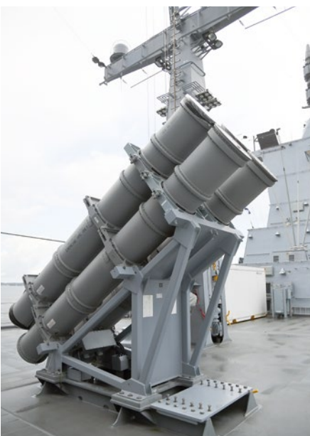
Die Starter für Seezielflugkörper RGM-84 Harpoon
