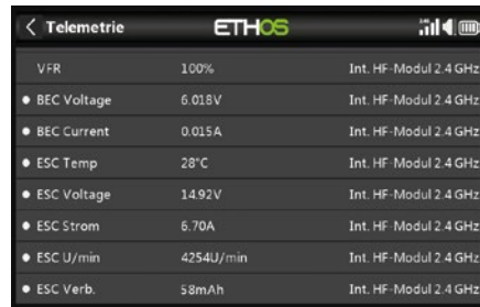
Ein Neuron II-Regler stellt umfangreiche Telemetriedaten zur Verfügung
