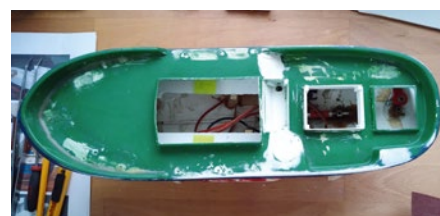
Das Loch, wo der Kran stand, wurde zugespachtelt
