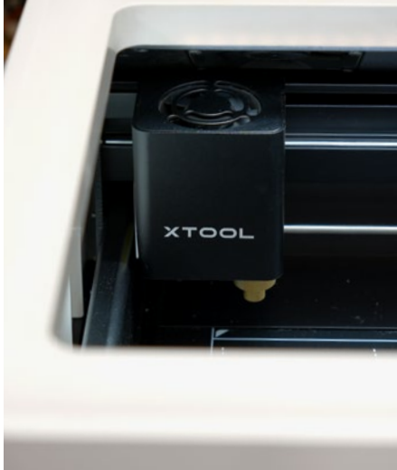
10 W Leistung bringt der Laser im xTool M1 und damit genug Power zum Schneiden verschiedener Hölzer bis 8 mm Materialdicke
