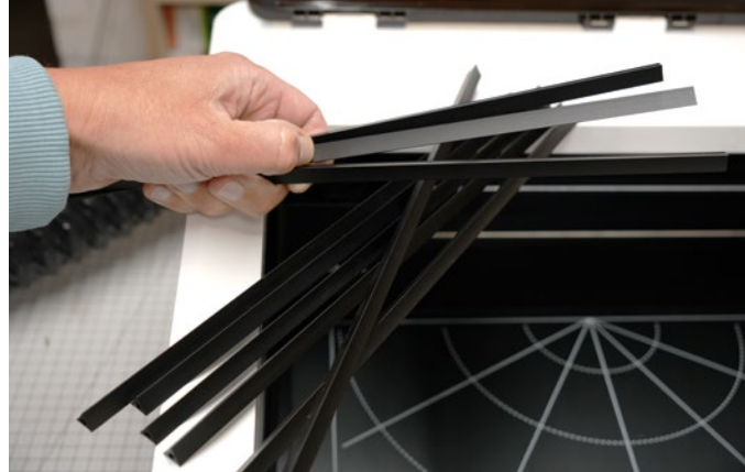
Mit den Dreiecksprismen lassen sich Holzbrettchen etwas erhöhen und damit effektiv unschöne Abbrandspuren reduzieren. Soll die Plotterfunktion des M1 verwendet werden, ist eine ebene Bodenfläche und das Entfernen der Prismen nötig
