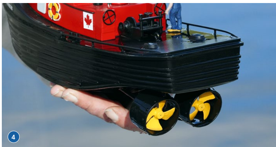
3) Die Motoren sind überdimensioniert, sorgen aber für Ballast. 4) Durch die beiden Schrauben benötigt der Schlepper kein Ruder
