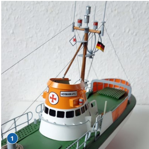
1) Lampen, Peilantene und Flaggen sind am Mast angebracht. 2) Der obere Fahrstand ist ausgestattet, nur der Kompass fehlt
