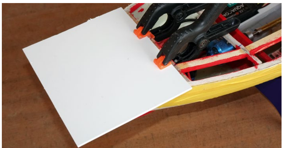
Grobe Anpassung des Backdecks, dessen Kontur nach dem Fixieren von unten grob angezeichnet wird. Vor dem Verkleben wird das Deck dann grob ausgeschnitten
