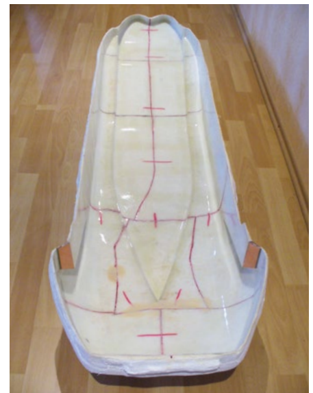
Mit GFK wurde eine Negativform abgenommen und mit Gipsbinden verstärkt
