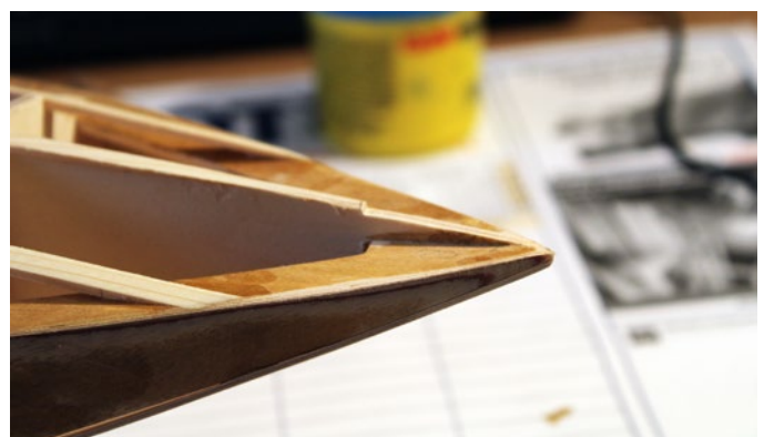
Die ersten 30 mm am Bug werden mit Holzbeplankung, daher die eingefeilte Stufe
