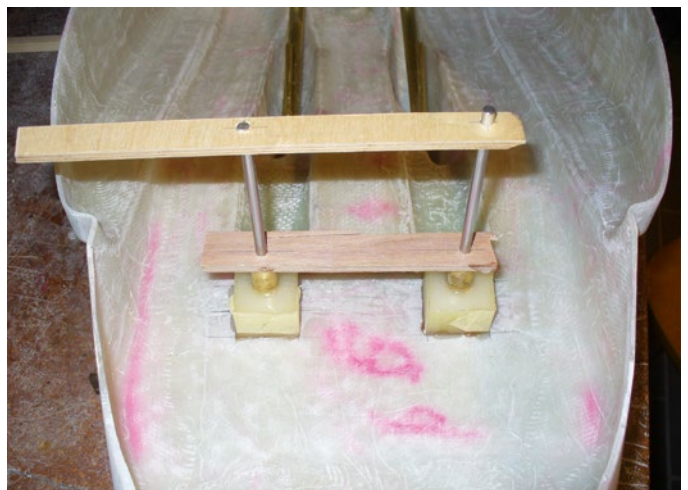
Für die Ruderachsen wurden zwei Fundamente mit angedicktem Harz ausgegossen
