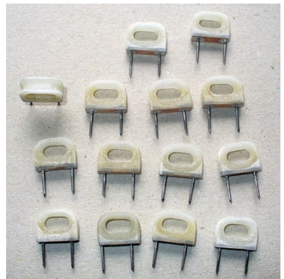
Die selbstgegossenen Panamaklüsen werden mit den Nägeln ins Deck eingelassen
