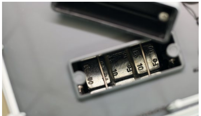
Über die Serviceklappe im Bug kommt man an die Ruderanlage – zu sehen sind hier die ab Werk befestigten Trimmgewichte
