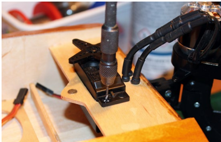
Das Lenkservo wird in die vorgesehene Öffnung eingebaut
