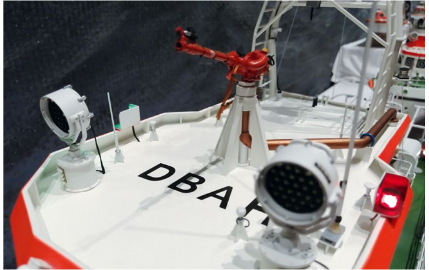
Der Löschmonitor auf der BERLIN lässt sich über das Steigrohr schwenken
