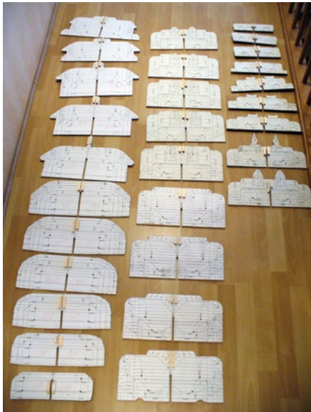
Die kopierten Papierspanten wurden auf 6 mm dickes Sperrholz geklebt und ausgesägt
