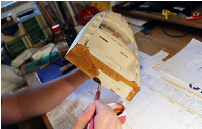
Beim Beizen lässt sich die Farbintensität mit dünnen Schichten steigern
