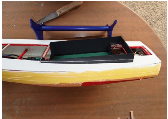
Vor dem Verschleifen der Decks wird der Rumpf mit Kleband geschützt. Die Seitenwände der Plicht wurden passend abgesägt
