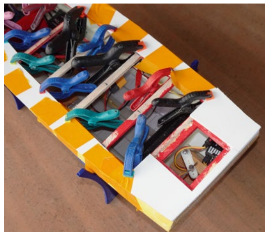
Die Seitendecks werden beim Verkleben außen mit Klebeband und innen mit Klammern fixiert
