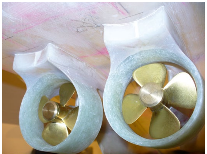
Die beiden selbstgebauten Propeller passen perfekt in die Kortdüsen
