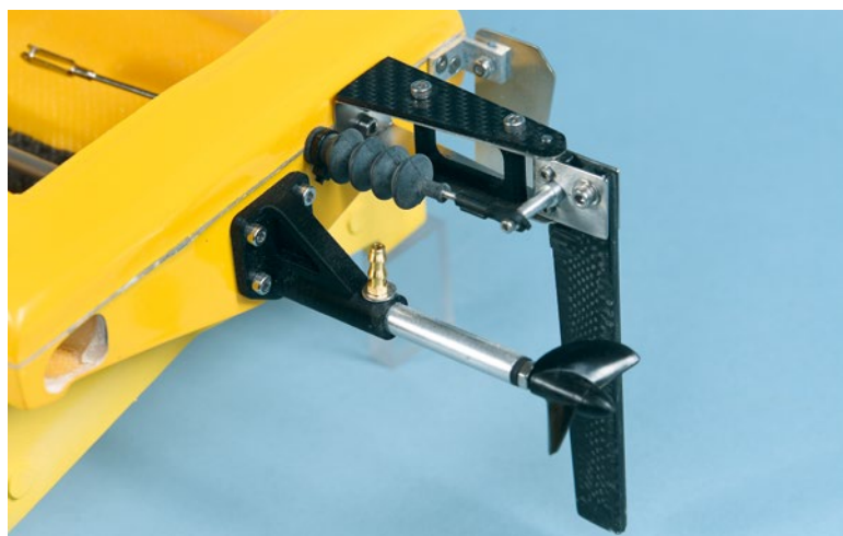
Die Ruder- und Antriebsanlage ist am Heckspiegel montiert
