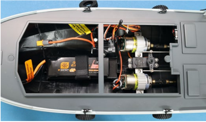
Fixiert vom Klettband kann man den Akku exakt positionieren. Die Motoren liefern eine zum Modell passende Leistung
