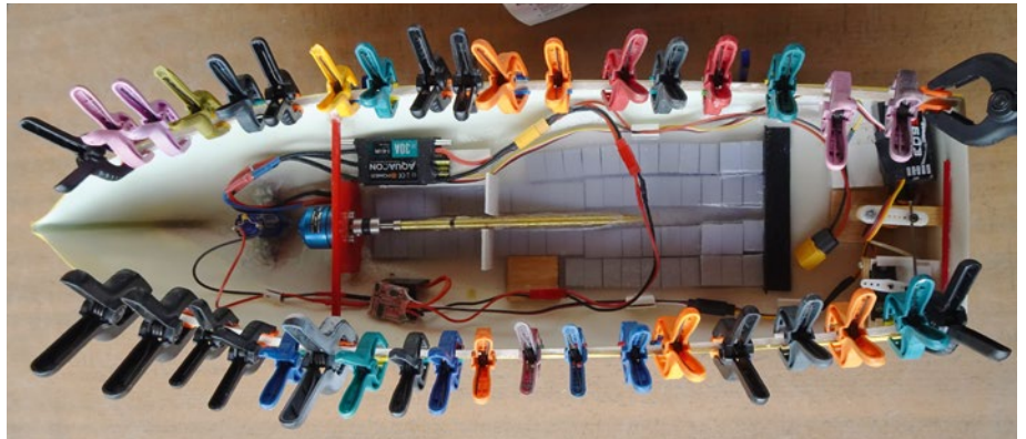
Klammern kann man nie genug haben. Eng gesetzt, sorgen sie dafür, dass die Auflageleiste für die Decks beim Verkleben gut an der Rumpfwand anliegt
