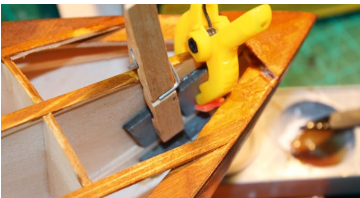
Mit Ballast im Bug muss das Gewicht des Motors ausgeglichen werden
