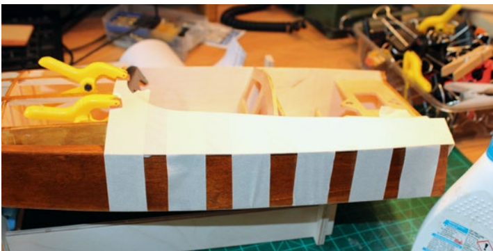
Mit Klebebändern wird die Decksbeplankung am Cockpit gesichert
