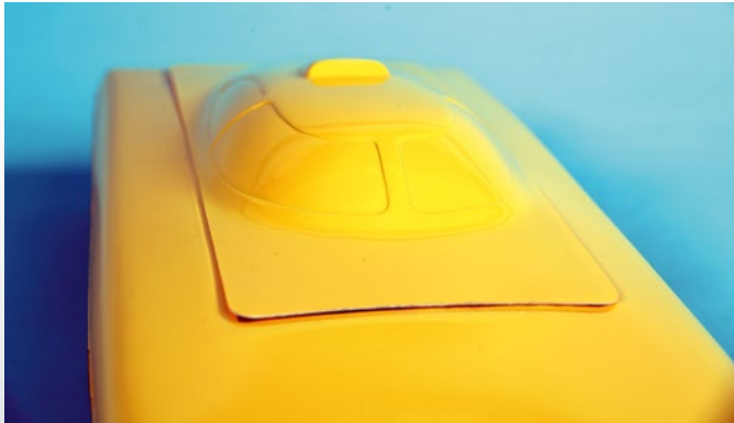
Das Cockpit wird in die umlaufende Vertiefung des Decks gelegt
