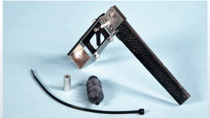
Das Spatenruder ist klappbar, was sehr praktisch ist
