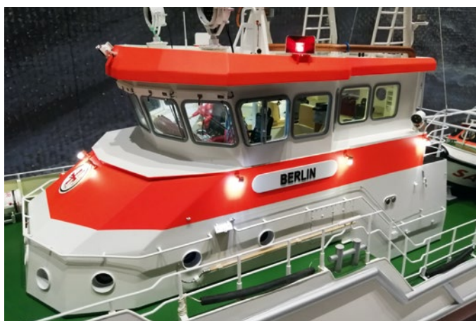
Die Brücke der BERLIN wird außen mit SMD-Dioden beleuchtet
