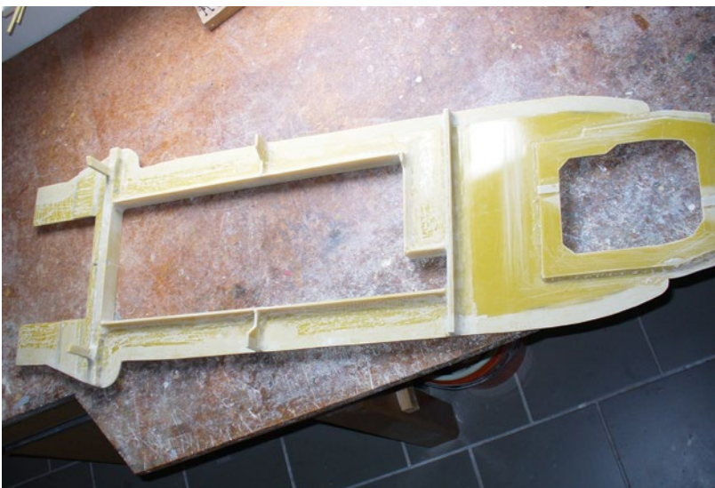
Das Hauptdeck mit dem Süllrand, der Öffnung für den Ruderzugang sowie den Unterzügen
