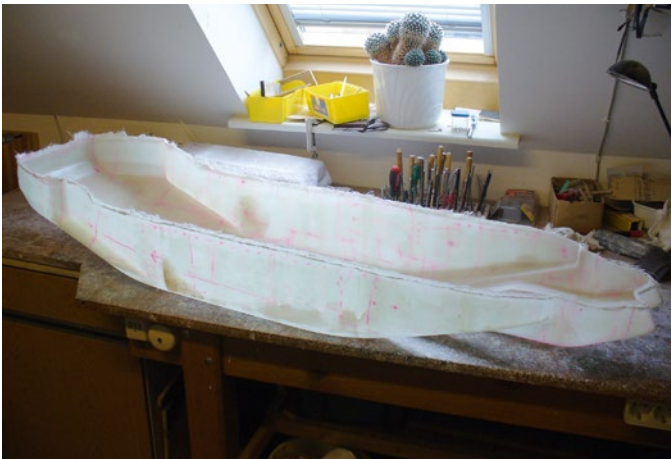
Nach zwei Tagen Arbeit war der Rumpf dann fertig laminiert
