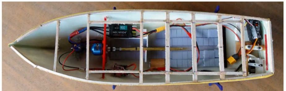
Die Auflagen für die Decks werden eingeklebt. Zuerst die Querstreben, dann werden die Längsstreben in Einzelteilen entlang der Ausschnitte für die Plicht und den Zugang unter den Aufbauten eingesetzt
