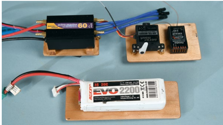
Die Komponenten der Fernsteuerung werden auf Brettchen montiert
