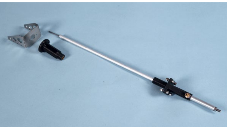
Die Wellenanlage mit Motorhalterung und Rumpfdurchführung
