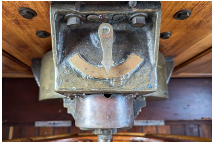
Simple Mechanik: Ein Zeiger hinter dem Steuerrad für den Einschlagwinkel des Ruders
