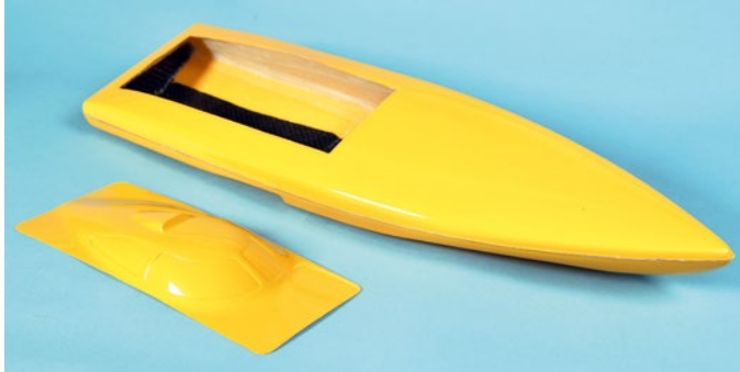
Der GFK-Rumpf der TIBURÓN mit eingefärbter Gelcoat-Schicht
