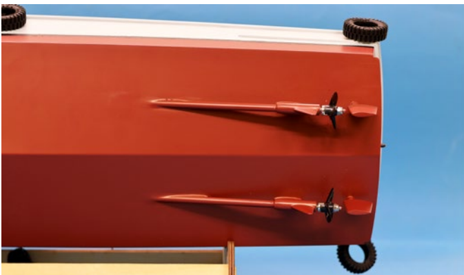
Links- und rechtsdrehende Propeller schließen Drall aus. Die Ruder wirken sehr gut
