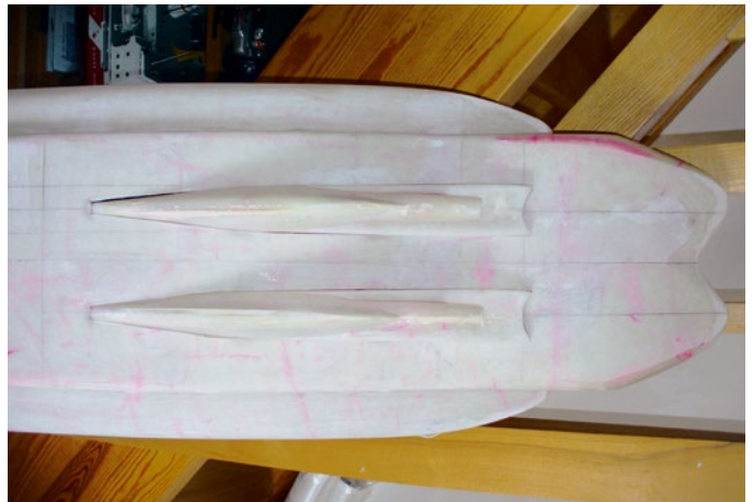
Die Wellenhosen wurden zuerst mit Sekundenkleber angepunktet und kontrolliert
