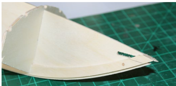
Der Schlitz im Kielbrett für die Decksstringer wird noch angepasst
