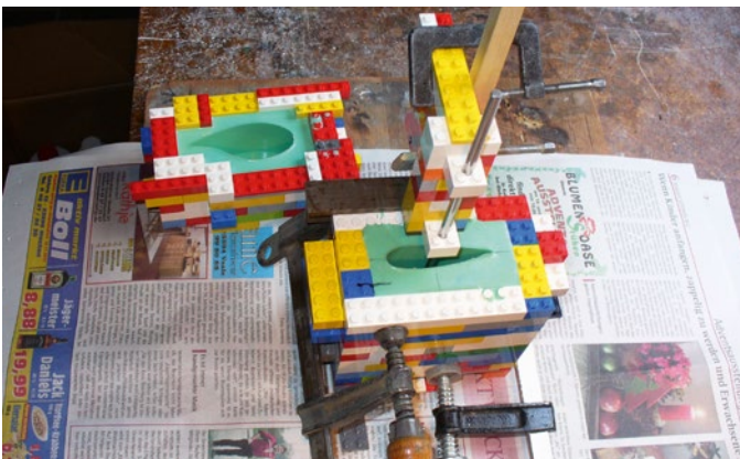
Die Ruderachsen wurden ebenfalls mit LEGO ausgerichtet und mit eingegossen
