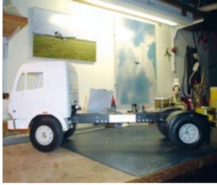
Das Fahrzeug wurde um 68 Millimeter verlängert, damit der vorbildgetreue Radstand des MB SK 1953 AK erreicht wird
