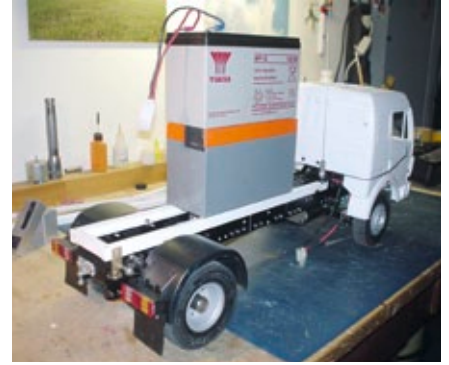
Belastungstest am Hilfsrahmen, langsam nimmt der neue Lkw seine Form an
