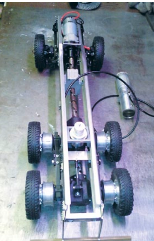
Der Fahrzeugrahmen wurde komplett aus Edelstahl gefertigt und passgenau auf die Antriebs-elemente zugeschnitten
