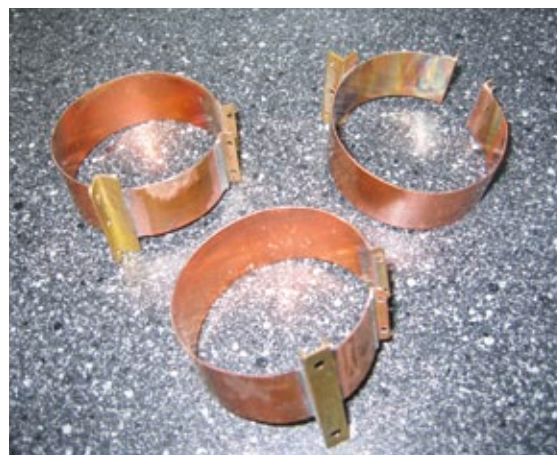
Aus den Resten einer Kupferdachrinne wurden Klammern für die Impeller angefertigt, die mit Messingwinkeln am Truck befestigt sind
