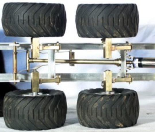
Der Rahmen wurde aus Aluwinkelprofilen neu aufgebaut. Als Vorlage diente das Fahrgestell von Siku
