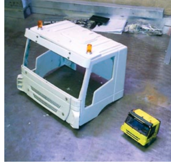
Anhand eines 1:43er-Modells wurde das Fahrerhaus des Trackers im Eigenbau angefertigt
