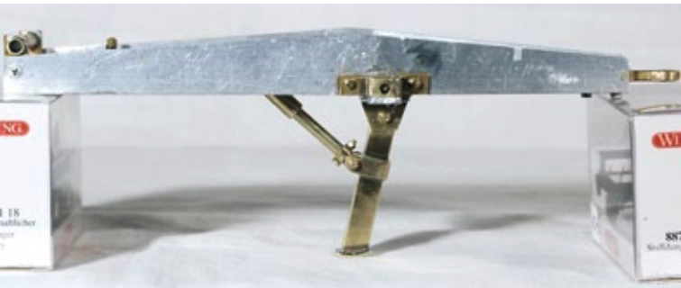
Der fertig zusammengebaute Schleppfuß wird an der Zugvorrichtung befestigt
