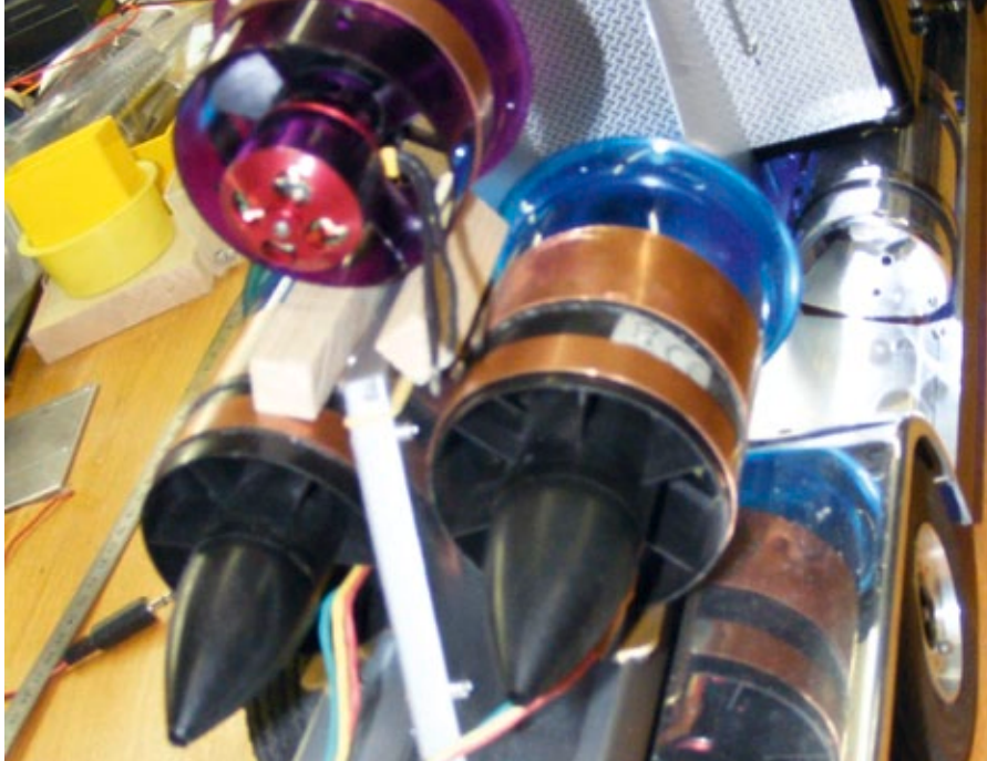
Die Anordnung der Impeller erfolgt in Dreiecksform. Als Halterung dienen Klammern aus Kupfer, die im Eigenbau angefertigt wurden
