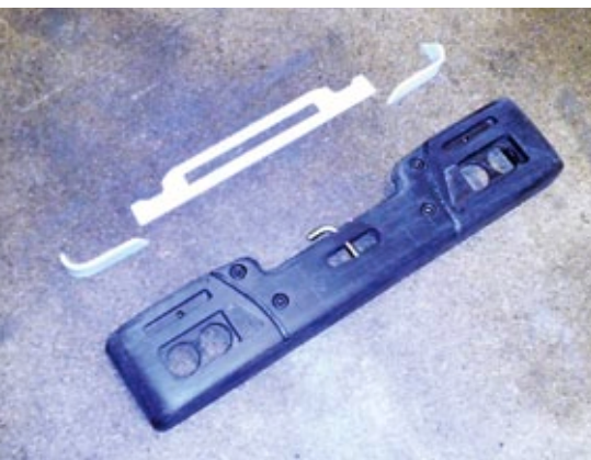
Mithilfe von Dremel und Flex entstand die Stoßstange. Als Material dient hier robustes Hart-PVC
