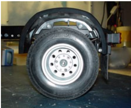
Der Rahmen wurde mit Alu-Vierkantprofilen um 10 Millimeter höher gelegt
