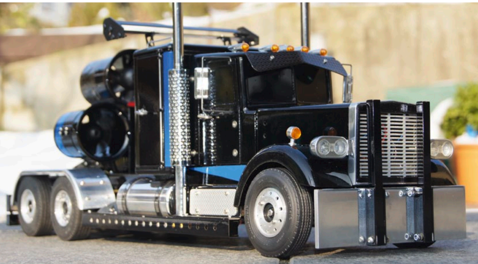
Für die Beleuchtung wurden vorne, an den Seiten und Hinten SMD-LED eingesetzt. Blinkleuchten, Hauptscheinwerfer und die Lichter am Kotflügel werden mit normalen Glühlampen betrieben
