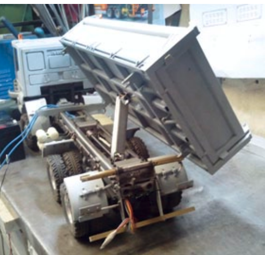
Der Kippaufbau besteht aus dünnwandigem Edelstahlblech, die gesamte Mechanik wurde aus über 60 Einzelteilen gefertigt
