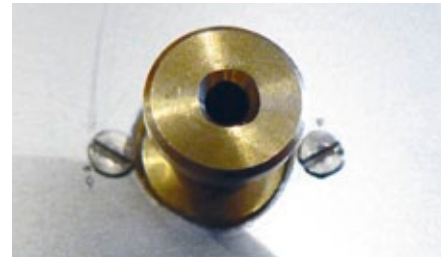
Der hohl gebohrte Königsbolzen von MM Modellbau. Im Inneren findet die Empfangsdiode für die Lichtfunktionen ihren Platz
