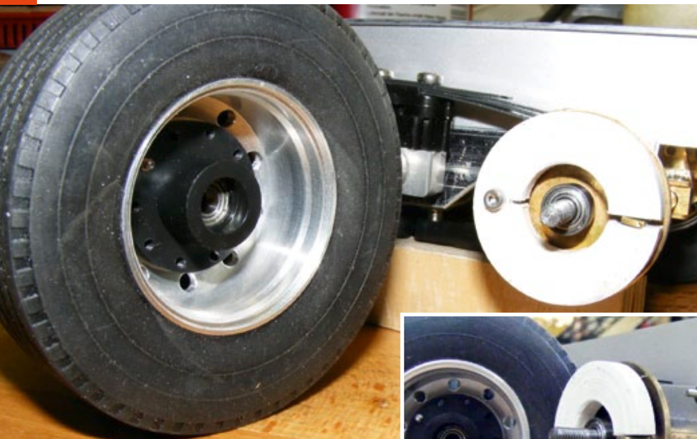
Dringend musste eine starke Bremse nachgerüstet werden. Hierfür wurde eine Trommelbremse im Eigenbau angefertigt
