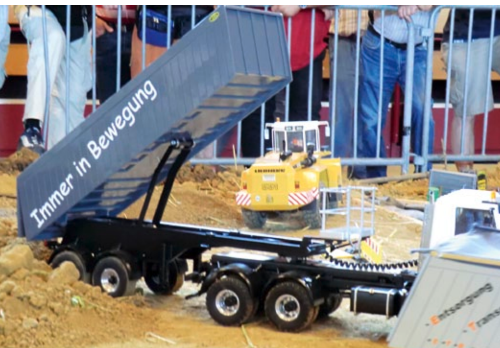
Für die Kippvorrichtung dient eine M8-Trapezgewindespindel. In gut 20 Sekunden wird die Mulde damit nach oben gedrückt
