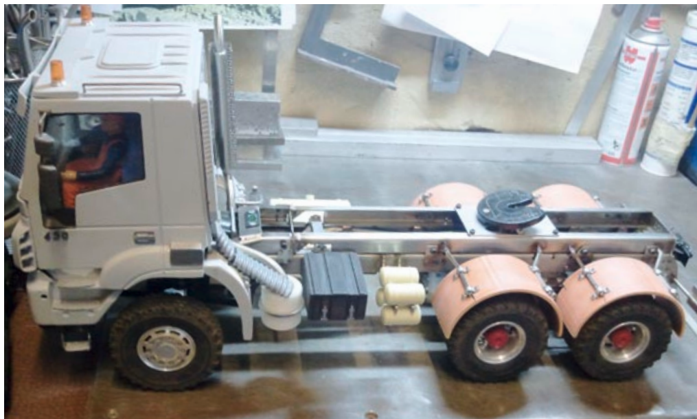
Mit einem flexibel einsetzbaren Wechselrahmen wurde der Sattelanhänger realisiert. Somit war es möglich, vom Kippaufbau auf den Sattelrahmen zu wechseln
