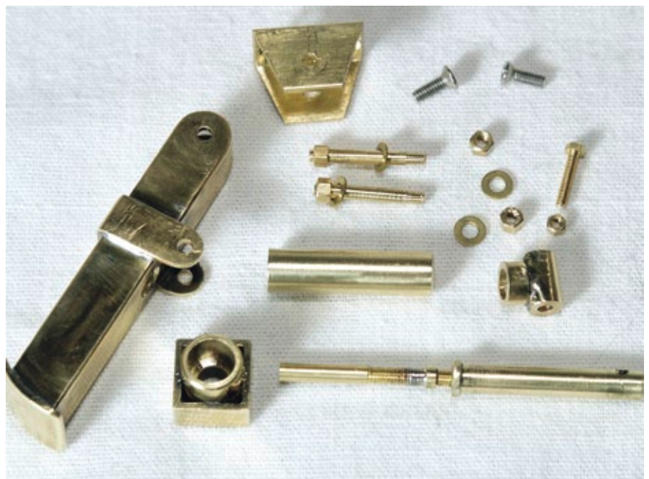
Die Einzelteile des hydraulischen Schleppfußes bestehen aus unterschiedlichen Messingprofilen
