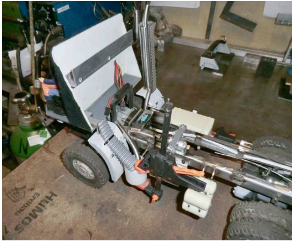
Ein Akkuschauberantrieb mit zwei Gängen und ein 3s-LiPo sorgen für genügend Vortrieb
