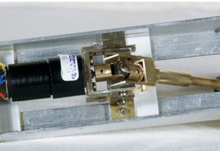
Die Hydraulik am Schleppfuß wird mit einem Faulhabermotor 1516SR von Lemo-Solar betrieben
