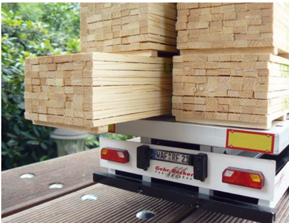
Hinter den Palettenatrappen verstecken sich die AMO-Einheit von Servonaut und ein LiPo-Akku
