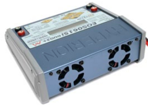
Entstehende Abwärme aufgrund hoher Ströme wird mit zwei Lüftern abtransportiert
