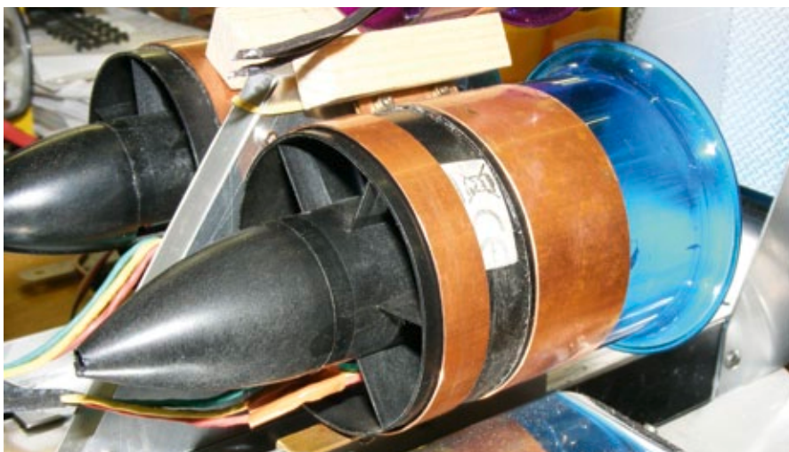
Zur besseren Führung wurden für die unteren beiden Impeller noch zwei Düsen-Föns gekauft, aus denen die Motorbefestigung heraus gesägt wurde
