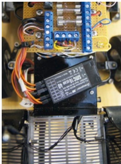
Als Empfänger dient ein SMC 16 Scan 40 Megahertz von Graupner. Bis zu acht Servofunktionen können so bedient werden
