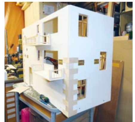
Sperrholz bildet die Grundlage für die Transportbox, die Fensteröffnungen wurden vorsichtig herausgesägt
