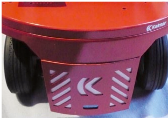
In der Heckpartie des Staplers versteckt sich das Kontergewicht, das ein Umkippen des Modells beim Verladen von schwereren Lasten verhindert
