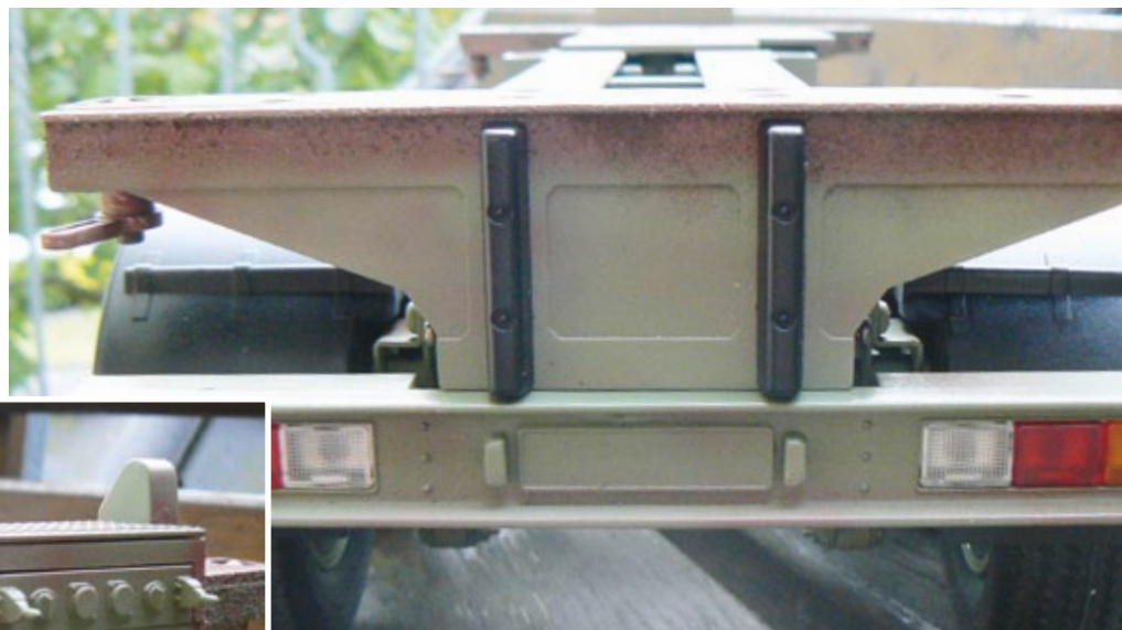
An der oberen Kante hat sich reichlich Rost angesetzt
