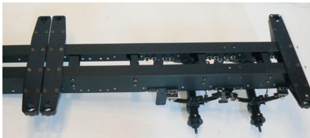
Demontage des ersten Achsaggregats
