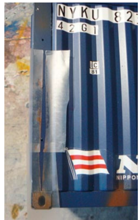
Mit Maskierfolie scharfe Kanten abgeklebt
