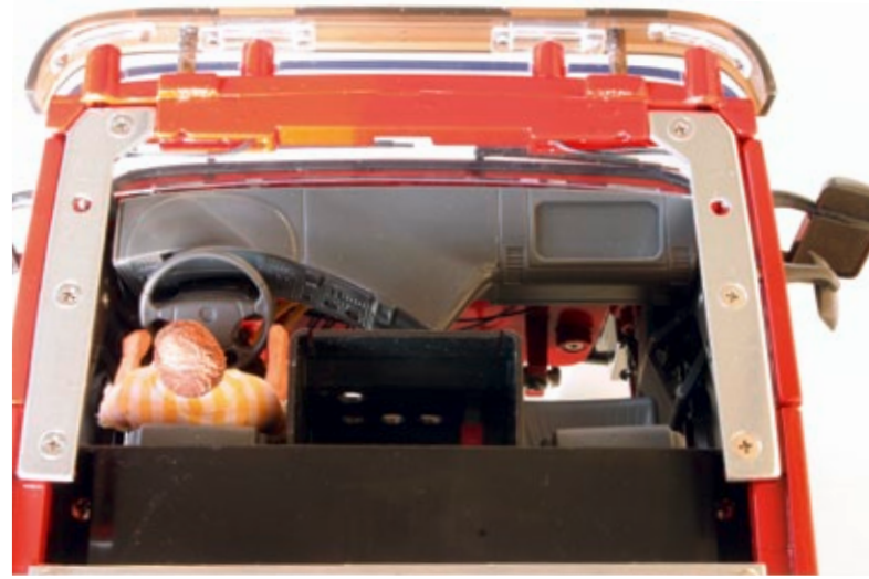
Blick von oben auf den Fahrerarbeitsplatz bei abgenommenem Dach; der Kasten in der Mitte nimmt die Schalter der elektrischen Anlage und die Funktions-LED auf
