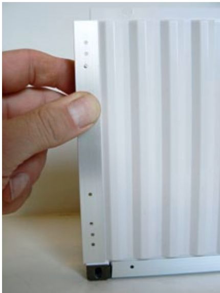
Anpassen der Container Außenecken
