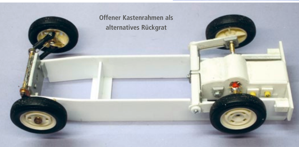
Die Vorderachse an Ort und Stelle, nur die Spurstangen sind noch nicht eingehängt
