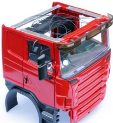
Das Fahrerhaus im Rohbau, unter dem Dach sieht man die Kabel der eingebauten Beleuchtung
