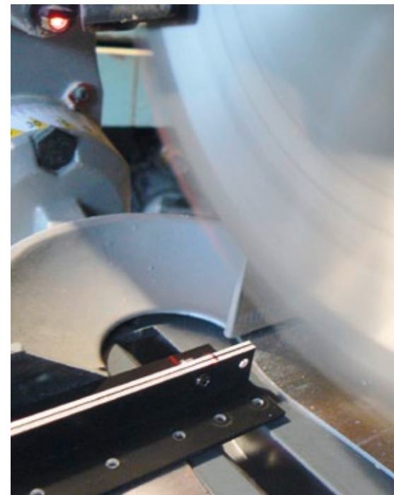
Trennschnitt an der elektrischen Kappsäge
