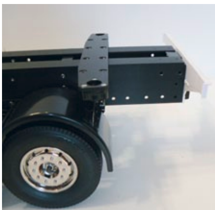
So weit muss die Twistlock-Aufnahme nach vorne
