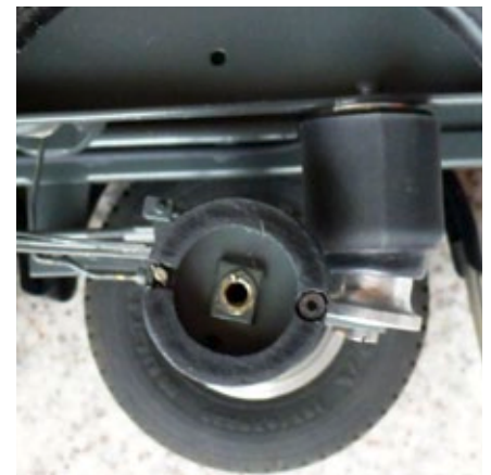
Die Bremse ist betätigt, das Messingblech drückt den ABS-Kunststoffring in der Alu-Bremstrommel auseinander, der Luftbalg ist ausgefahren
