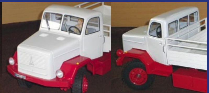
Magirus-Deutz 1:14-Fahrerhausbausatz für Tamiya-Fahrzeuge • beinhaltet 3-teiliges Fahrerhaus, Stoßstange, Spiegel, Scheibenwischer, 2 Lampen, Scheiben, Lenkrad, Türgriffe, Embleme, Armaturenbrett • Maße: Länge 18,5 cm, Breite 18 cm, Höhe 14 cm • Bestell-Nr. 5014 • Preis 250,- €
