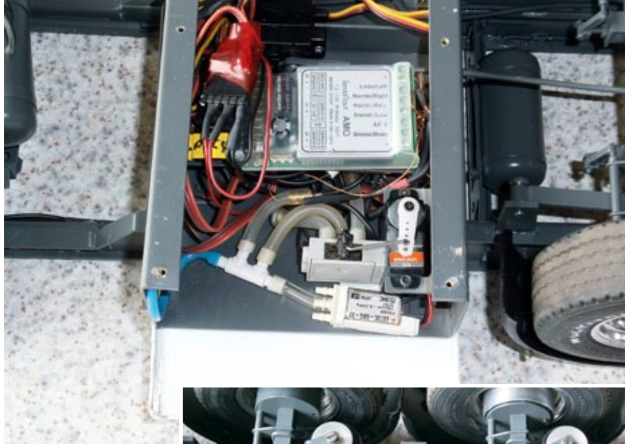
Das Lego-Ventil der Liftachse
