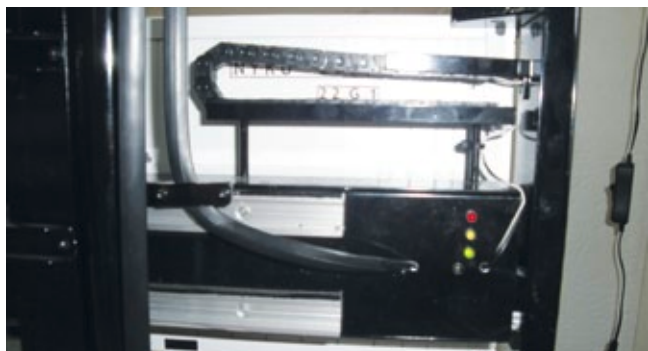
Mit Hilfe einer „LED-Ampel“ ist der Verriegelungszustand des Spreaders eindeutig abzulesen
