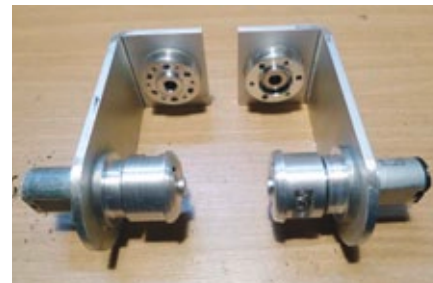
Beide Antriebe bestehen aus zwei Mikromotoren mit entsprechenden Rad-Adaptern
