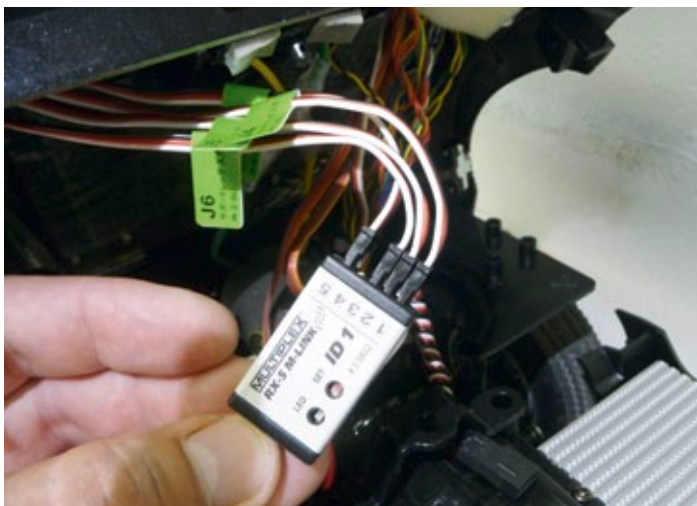
Es wird ein Fünfkanal-Empfänger gebraucht, dennoch bleibt Kanal 4 frei
