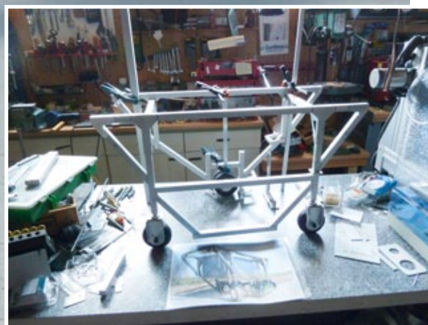
Die Portalsegmente wurden zusammengefügt und sind bereit für den ersten Test
