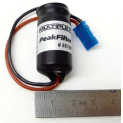
Der Peak Filter schützt die Anlage vor Stromspitzen, ausgelöst zum Beispiel von Servos
