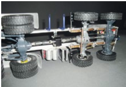
Blick von unten auf den Antriebsstrang des Scania R560
