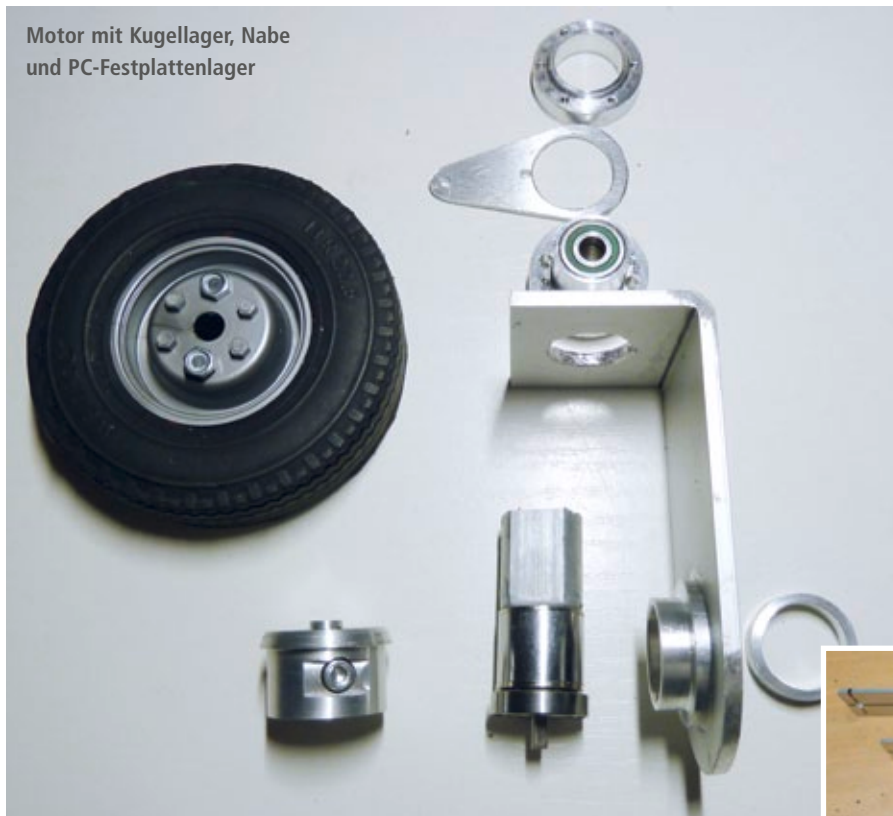
Beide Antriebe bestehen aus zwei Mikromotoren mit entsprechenden Rad-Adaptern
