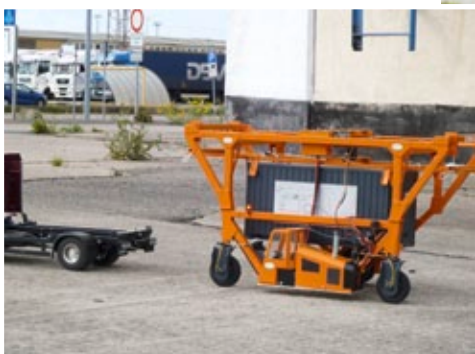
Ein Lkw wird vom Straddle Carrier entladen ...
