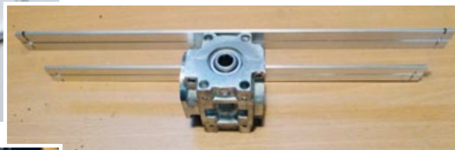
Die Halterung für das Hubgetriebe ist fertig
