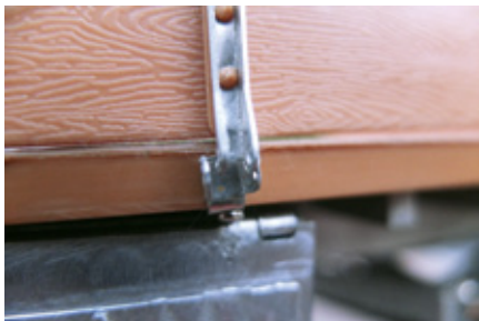
Die Halter der Bordwände und die Ösen der Bodenplatte passen nicht ineinander
