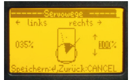
Die Servowege sind für jede Seite unterschiedlich einstellbar. Die Vorgaben werden übersichtlich auf dem Display gezeigt, sowohl grafisch ...
