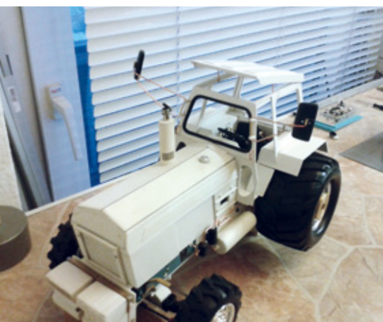
Das Dach der Fahrerkabine kann nun geöffnet werden
