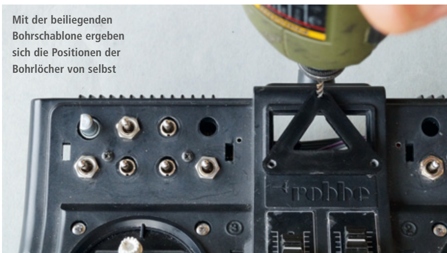
Die Schaltmodule passen in die Montageplätze für die Multiswitch-Erweiterungen. Lediglich die Bohrung für das Potentiometer muss erweitert werden
