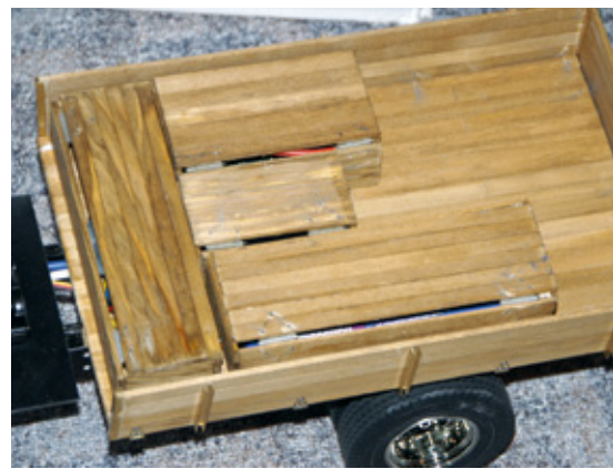
Vier Kisten verstecken Akku, Empfänger, M20 und die Kabelage
