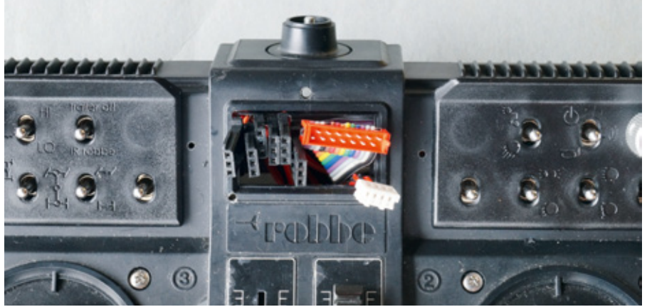
Durch das Montageloch des ehemaligen Voltmeters laufen die Anschlusskabel zum Sendemodul
