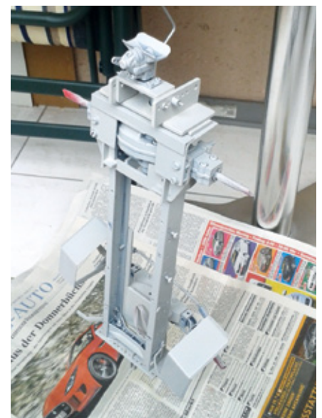
Die Anhänger-Kupplung von Carson habe ich fest mit dem Rahmen verbaut. Sie wurde wie alle Komponenten grundiert
