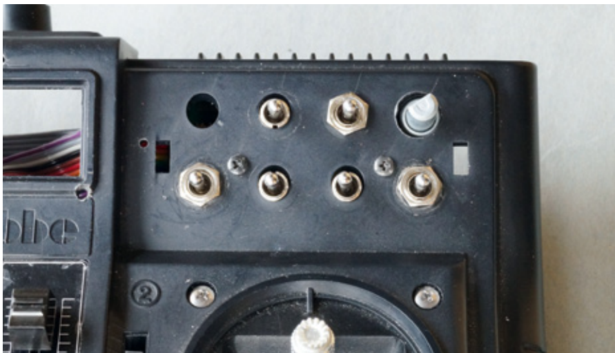
Die Schaltmodule passen in die Montageplätze für die Multiswitch-Erweiterungen. Lediglich die Bohrung für das Potentiometer muss erweitert werden
