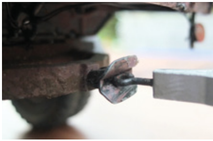
Das Auge der Deichsel ist viel zu mächtig für das Kupplungsmaul des Opel Blitz
