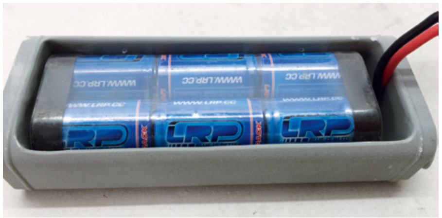
Im Haupttank findet ein handelsüblicher 7,2-Volt-Akkupack seinen Platz. Er benötigt jedoch eine Ladebuchse, da das Auseinandernehmen des Turms zum Laden sehr umständlich ist
