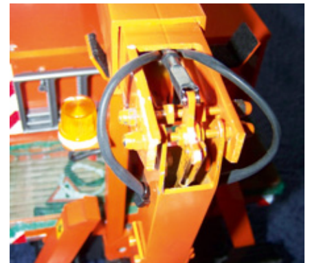
Hier sieht man das Kippgestänge für den Korb
