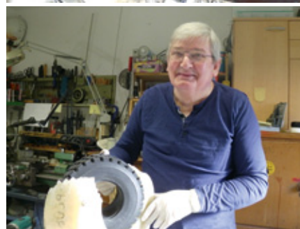
Bernhard Barnhausen füllt die Form mit Gummi aus und befreit nach kurzer Zeit den Guss. In der Zwischenzeit schafft er mit seiner Frau bis zu 40 Pneus am Tag
