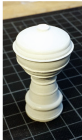
Das gedruckte Modell wird mit Spritzspachtel beschichtet, verschliffen, grundiert und lackiert
