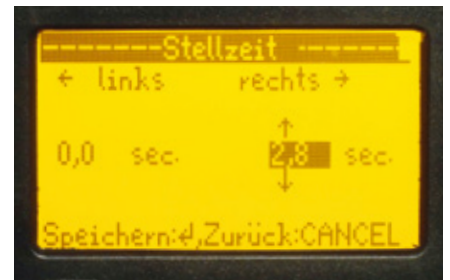
Die Stellzeit der Servos kann von null bis 10 Sekunden für jede Richtung parametrierbar werden
