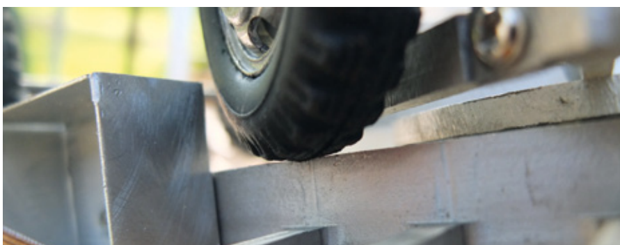
Ein weiteres Manko an der Vorderachse: die Reifen schleifen am Rahmen
