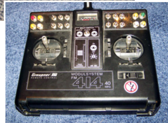
Aufgepeppter Oldie: Die bunten Taster der Fernsteuerung bedienen die Lichtfunktionen, die Kipptaster steuern die Elektromotoren für den Arm und die Stützen
