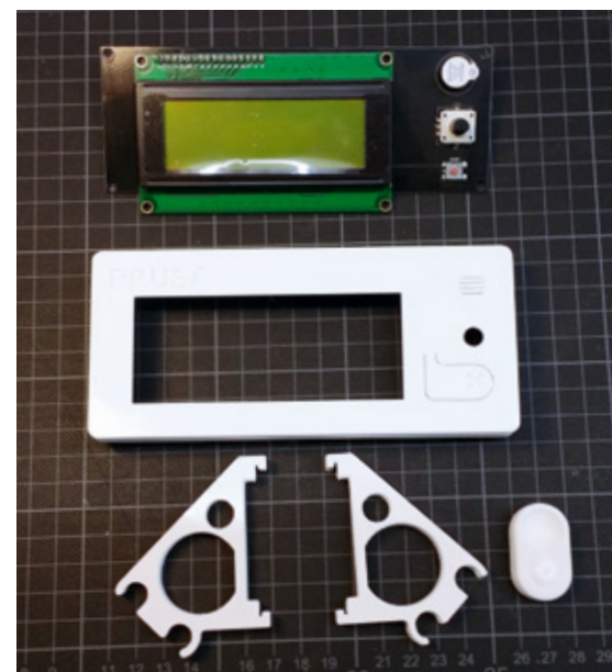
Die selbstgedruckten Einzelteile für das Gehäuse des LCD-Controllers
