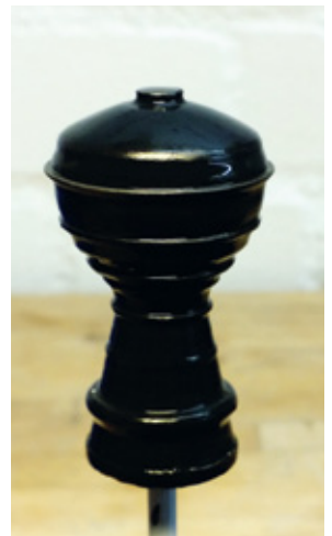
Das gedruckte Modell wird mit Spritzspachtel beschichtet, verschliffen, grundiert und lackiert
