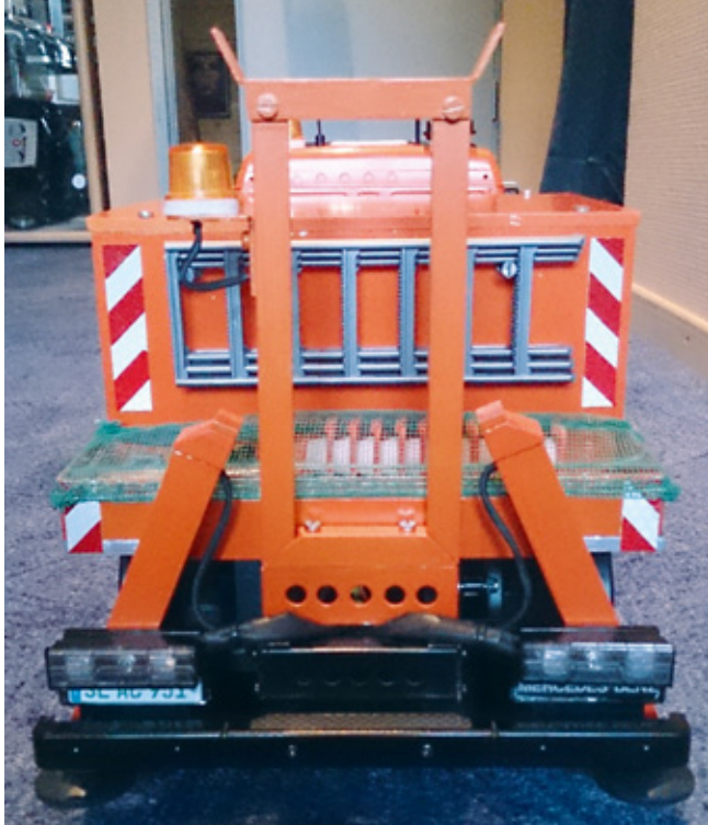
Heckansicht mit Haltetraverse für den Kranarm: Die Leitung für die Rundumleuchte liegt innen
