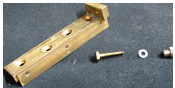
Der neue Anschlag in seinen Einzelteilen. Es wird die originale Feststellschraube verwendet. Die variable Anbauplatte wird mit drei M2 Senkkopfschrauben befestigt. Ansicht von oben
