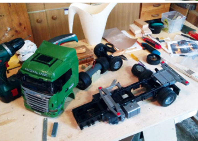
Beim Scania lässt sich der Sensor nicht so leicht verstecken und muss auf die Stoßstange aufgesetzt werden
