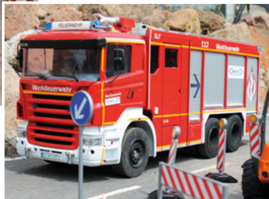
Das SLF ist eines von drei wasserführenden Fahrzeugen im Löschzug und hat bis zu 3 Liter Wasser dabei
