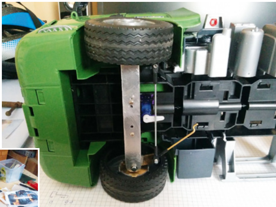
Der Scania verfügt zwar über Servos und Akkus, jedoch keine RC-Anlage. Er lässt sich dank des Arduino-Umbaus per Smartphone steuern
