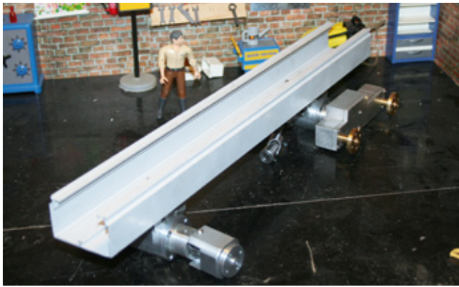
Der Kabelkanal als Rahmen hat die Vorder- und Hinterachse aufgenommen
