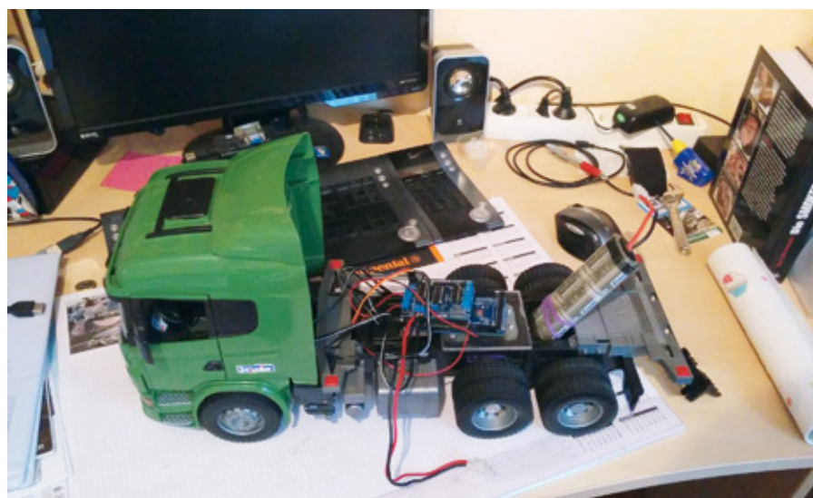
Das Arduino ist sehr kompakt und passt deshalb auch in kleinere Modelle
