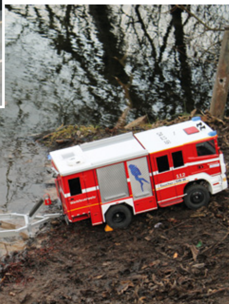
Der GW-W bietet die Möglichkeit, ein Boot zu Wasser zu lassen
