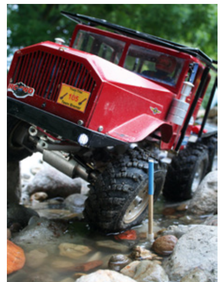
Die Boogieachse sorgt dafür, dass auch beim Truck-Trial immer Bodenkontakt besteht
