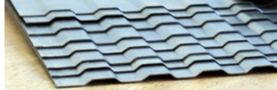
Präzision in der Blechbearbeitung: Heck-Bleche des Finescale-Containers nach dem Tiefziehen
