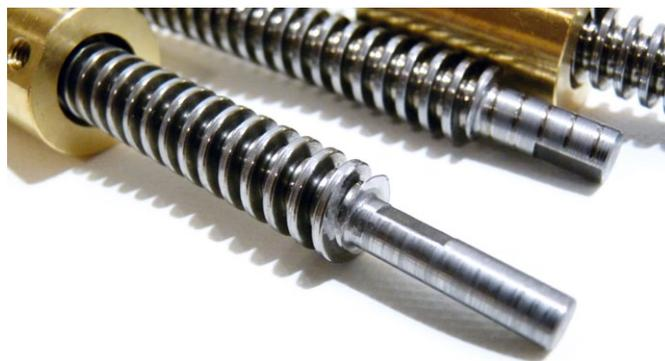
Die Gewindespindeln sollten vor dem Einbau sauber entgratet und anschließend im Seifenbad von jeglichen Metallspänen oder anderen Verunreinigungen befreit werden. Nur so ist später ein seidenweicher Lauf in den Messingbuchsen gewährleistet
