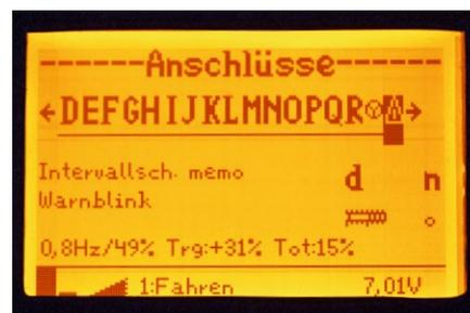
Im Auswahlmodus „Anschlüsse“ können die einzelnen Anschlüsse konfiguriert werden
