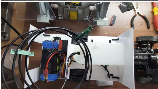
Der hintere Aufbau enthält alle relevanten Bauteile sowie den Tank
