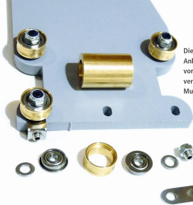
Die Montage der Achsen läuft an allen vier Stellen ähnlich ab und setzt die Anbringung von jeweils vier Laufrollen samt Spieleinstellungsmöglichkeit voraus. Hier können alternativ die gezeigten Muttern mit Nyloneinsatz verwendet werden, da eine spätere Demontage bei locker werdenden Muttern sehr viel Zeit verschlingt
