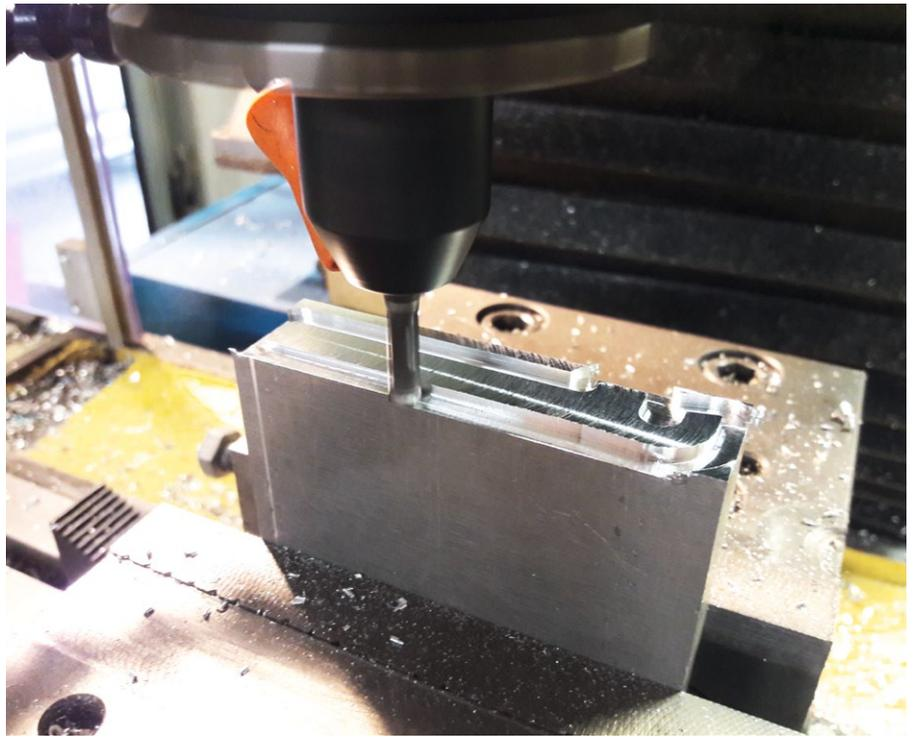
Die Unterlenker der Heckhydraulik wurden auf der CNC-Fräsmaschine mit einem 5-Millimeter-Fräser hergestellt. Danach wurden die Löcher gebohrt
