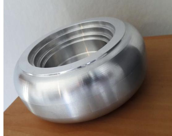
Die fertig CNC-gedrehte Felge für die Hinterachse mit Sicht auf die angepasste Außenkontur passend zu den Bruder-Reifen
