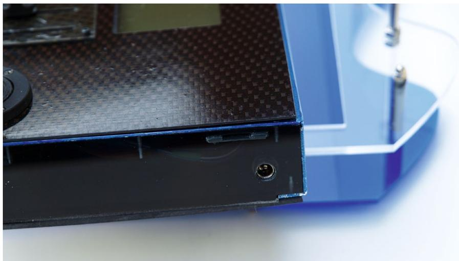
Seitlich angeordnet sind die Ladebuchse und der Kartenadapter
