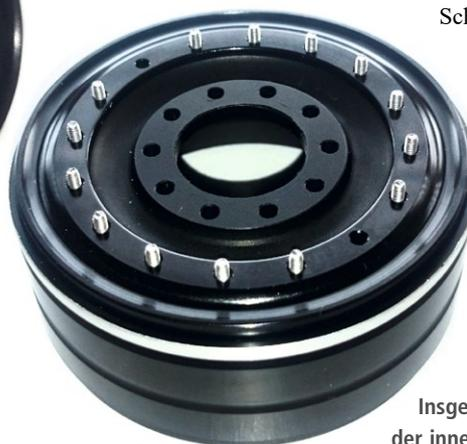
Insgesamt 16 Schrauben werden an der inneren Felge angebracht
