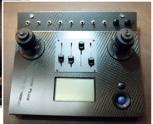
16 Schalter/Taster einzubauen. Die ersten vier Taster werden mit je einem Servokabel direkt an die Platine angeschlossen. Die weiteren zwölf werden zu Viererblocks zusammengefasst. Dabei werden für vier Taster nur zwei Servokabel benötigt. Ein Schaltplan ist in der Bauanleitung enthalten. Wer nicht selber löten möchte, kann auch eine fertige Platine mit vier Tastern im Shop von Blauzahn-RC kaufen.
