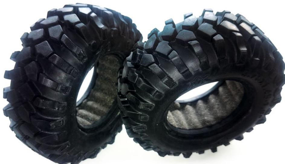
Die Reifen haben ein 4 Millimeter tiefes Blockprofil. Sie müssen gesondert bestellt werden
