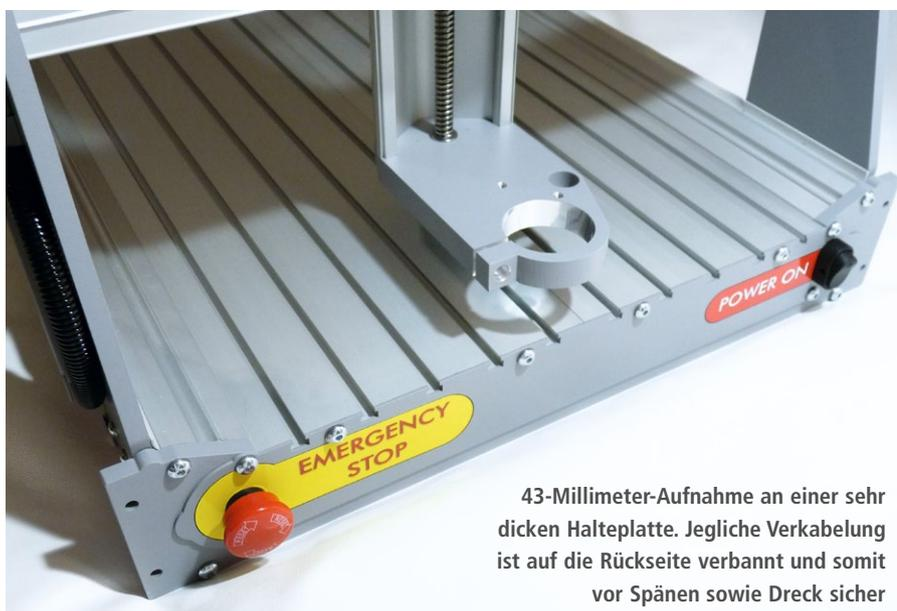
43-Millimeter-Aufnahme an einer sehr dicken Halteplatte. Jegliche Verkabelung ist auf die Rückseite verbannt und somit vor Spänen sowie Dreck sicher
