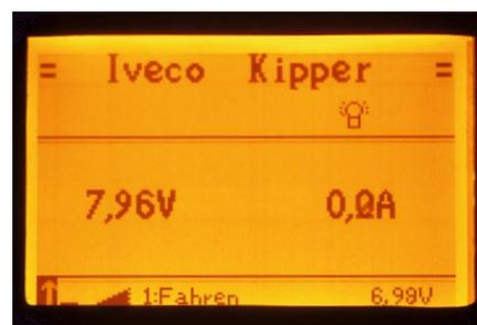
Hier die Anzeige während des Betriebs. Im Display ist zu sehen, dass die Rundumleuchte eingeschaltet ist
