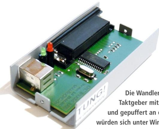
Die Wandlerbox beinhaltet einen quarzstabilisierten Taktgeber mit integriertem Speicher, um die Daten in Echtzeit und gepuffert an die Maschine geben zu können. Andernfalls würden sich unter Windows-Systemen schon nach etwa 30 bis 40 Minuten erste Schrittverluste einstellen
