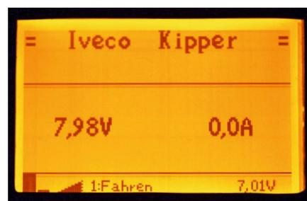
Oben im Display erscheint der Modellname. Darunter in den Telemetriefeldern die gespeicherten Werte. Hier die Spannung des Akkus im Modell sowie der Strom
