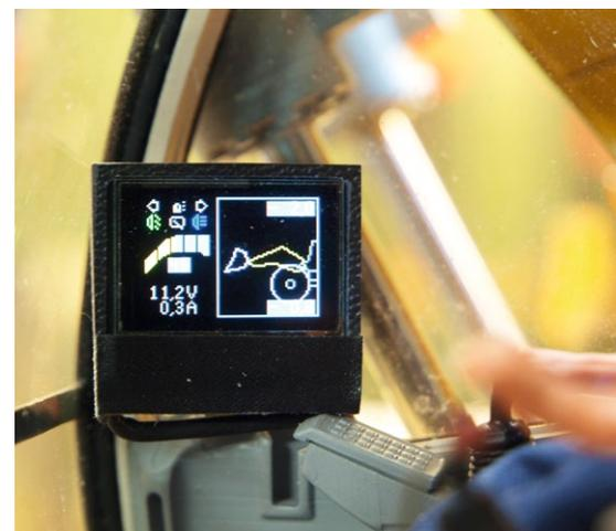
Displayanzeige für Frontlader mit Balkenanzeige und Kontrollleuchten
