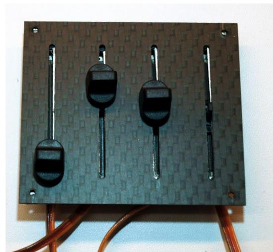
Die Platte mit den Schieberegler ist einbaufertig. Die Bedientknöpfe sind zum Teil probeweise aufgesteckt
