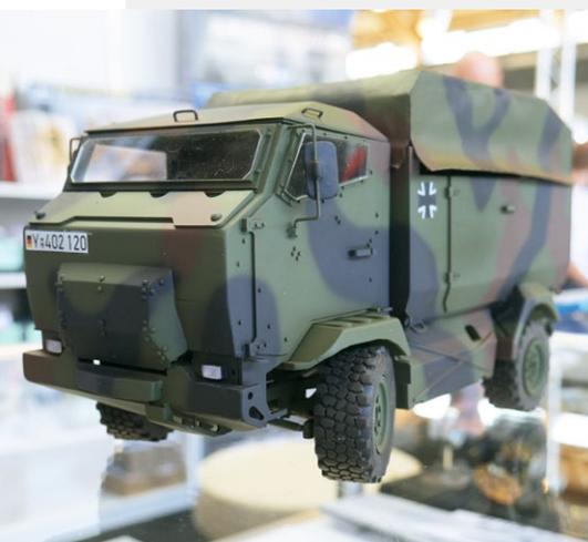
Im vergangenen Jahr zeigte AFV Model den Prototyp, zwölf Monate später gab es den serienreifen Mungo in 1:16 zu sehen. Aluminium-Rahmen, Allradantrieb und ein detaillierter Aufbau aus Polystyrol: für 719,- Euro bekommen Militärmodellbau-Fans einen spannenden Bausatz geliefert.
