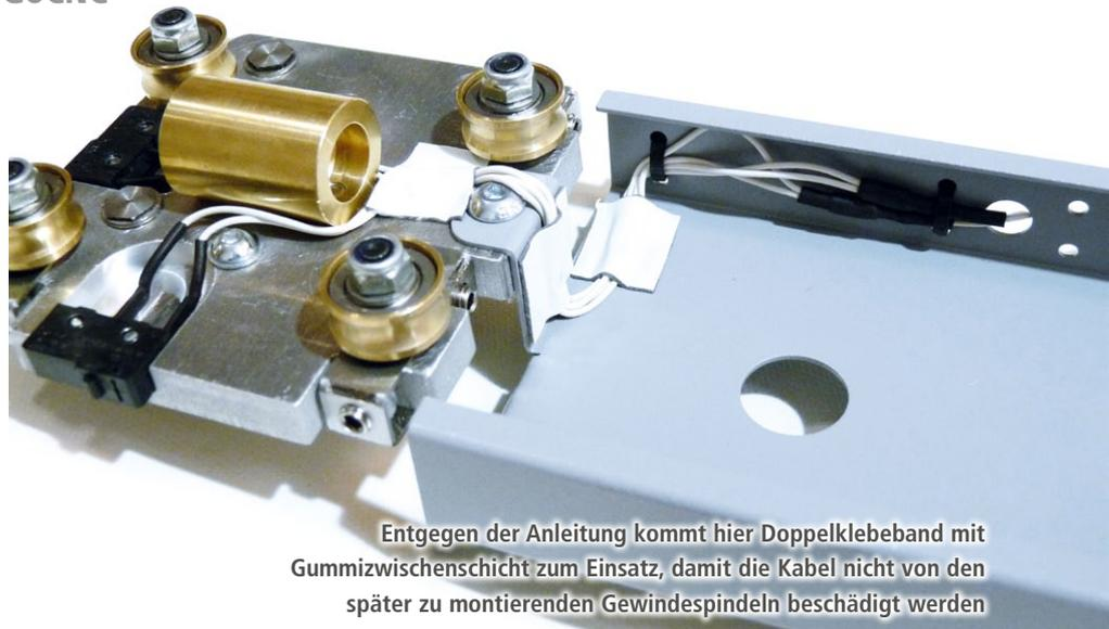
Entgegen der Anleitung kommt hier Doppelklebeband mit Gummizwischenschicht zum Einsatz, damit die Kabel nicht von den später zu montierenden Gewindespindeln beschädigt werden
