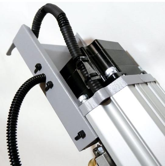
Als kleine Zugentlastung wurde das Motorkabel der Z-Achse noch etwas an der Seite fixiert
