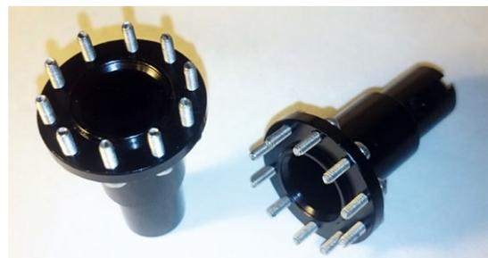
Die Radnaben sind aus Aluminium und müssen ebenfalls separat bezogen werden
