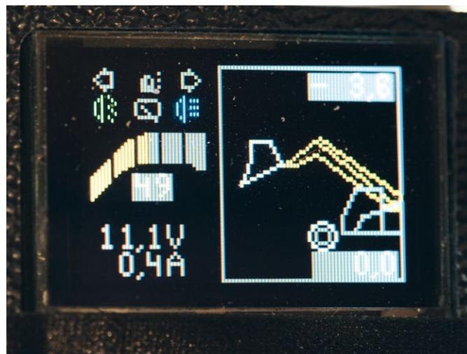
Die Anzeige mit Kontrollleuchten für einen Frontlader
