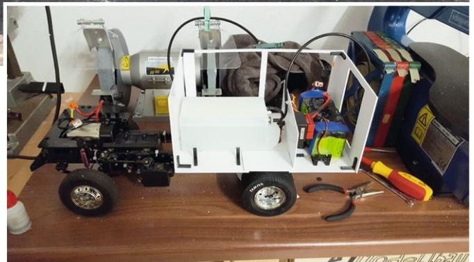
Der Aufbau selbst wurde aus ABS-Platten konstruiert
