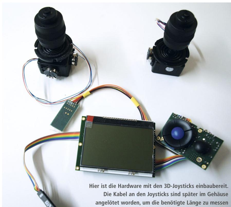
Hier ist die Hardware mit den 3D-Joysticks einbaubereit. Die Kabel an den Joysticks sind später im Gehäuse angelötet worden, um die benötigte Länge zu messen
