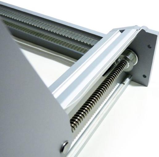
Die Kraftübertragung von einer Seite zur anderen geschieht über einen 10 Millimeter breiten Riemen vom Typ T5. Diese etwas größere Verzahnung setzt eine pingelige Justierung bei der Parallelität der beiden Seitenwangen zueinander voraus, um ein Verkanten zu vermeiden
