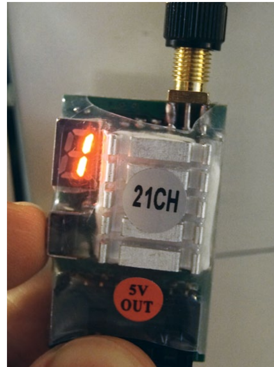
Mit dem Taster seitlich stellt man die Sendefrequenz ein: kurzer Druck ändert den Kanal, langer Druck schaltet um auf das nächste Band
