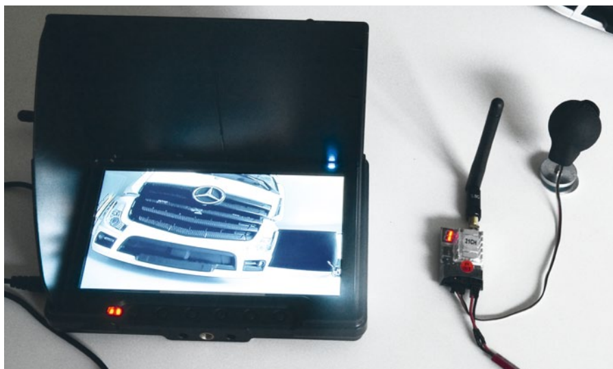
Der Versuchsaufbau ist in Rekordzeit erledigt und zeigt das Trägerfahrzeug vorerst von außen: Monitor aus Netzteil und Sender aus Akku versorgen, Kamera am Sender einstecken, gleiche Frequenz wählen und los geht's
