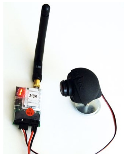
Der Sender mit der Knickantenne und die angeschlossene Kamera im optionalen Gehäuse sind recht kompakt in den Abmaßen
