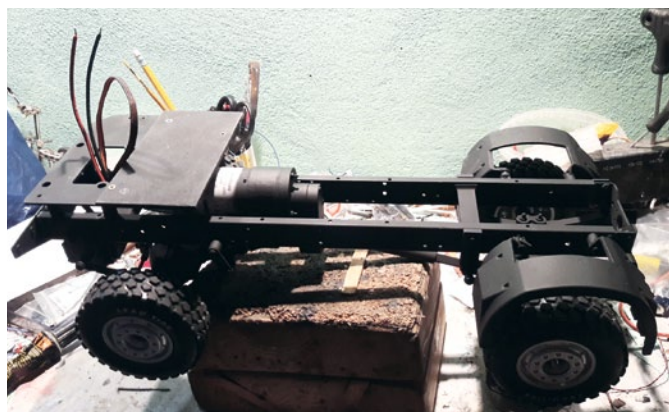
Frisch mit Unterbodenschutz besprüht, damit im Gelände nichts rostet. Der Klarlack fehlt hier noch
