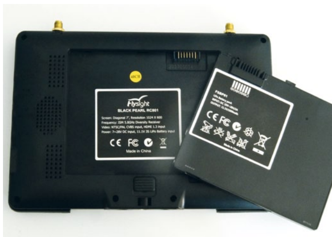
Der 3s-LiPo mit 1.000 Milliamperestunden Kapazität ist austauschbar, wird aber bei Stromversorgung von außen geladen
