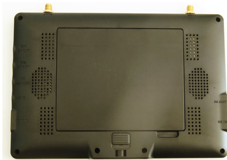
Anschlussvielfalt auf der Rückseite, links: Video-Ausgänge für beide Empfänger getrennt und gemeinsam, Video-Eingang und HDMI-Eingang; oben erkennt man die Schraubanschlüsse für die Antennen
