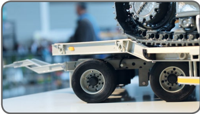
Die Steuerimpulse für die gelenkten Achsen fünf und sechs werden per Hallsensor im Drehschemel generiert
