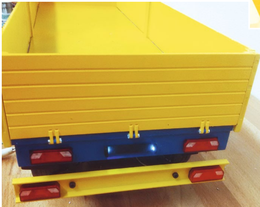
Schickes Detail: die selbstgefertigte Kennzeichenbeleuchtung
