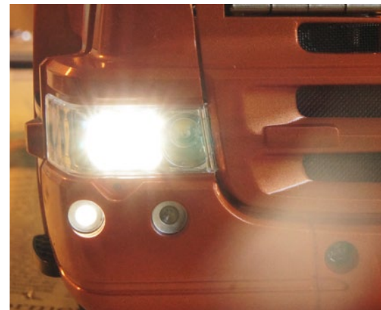
Das Abblendlicht mit Xenoneffekt beim Einschalten ist eindrucksvoll hell; in der Vorserien-Hard- und Software sitzt das Standlicht noch im Rundscheinwerfer außen, das Abbiegelicht innen
