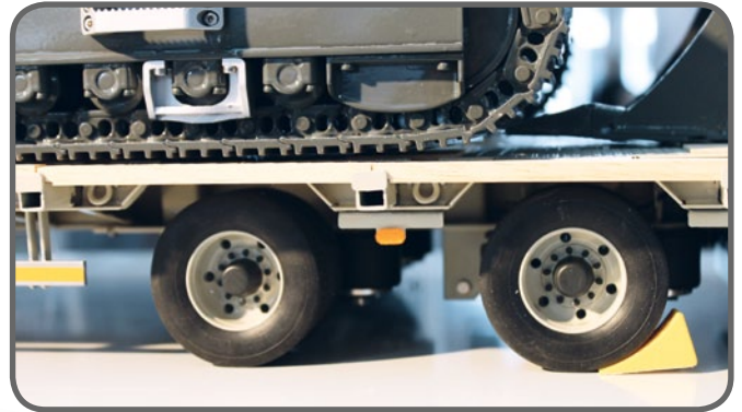
Über die optional erhältliche Luftfederung lässt sich eine Niveauregulierung realisieren
