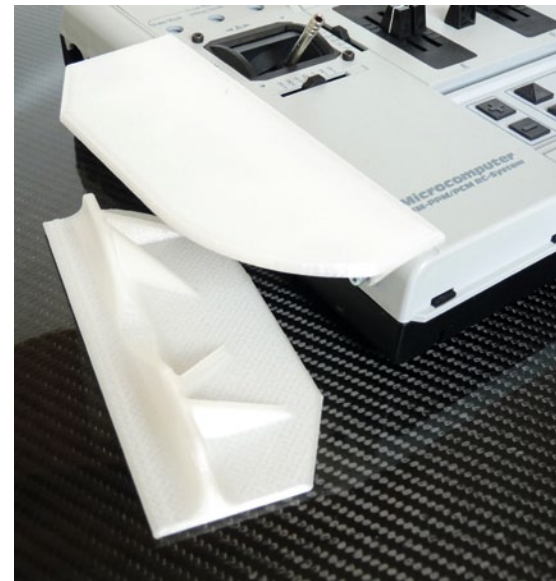
Diese seitlichen Handauflagen für einen RC-Sender wurden kurzerhand per CAD entworfen, am Dreamer ausgedruckt und passten auf Anhieb ohne weitere Nacharbeiten
