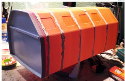
Die Klebestöße wurden verspachtelt, damit die Übergänge so wenig wie möglich auffallen
