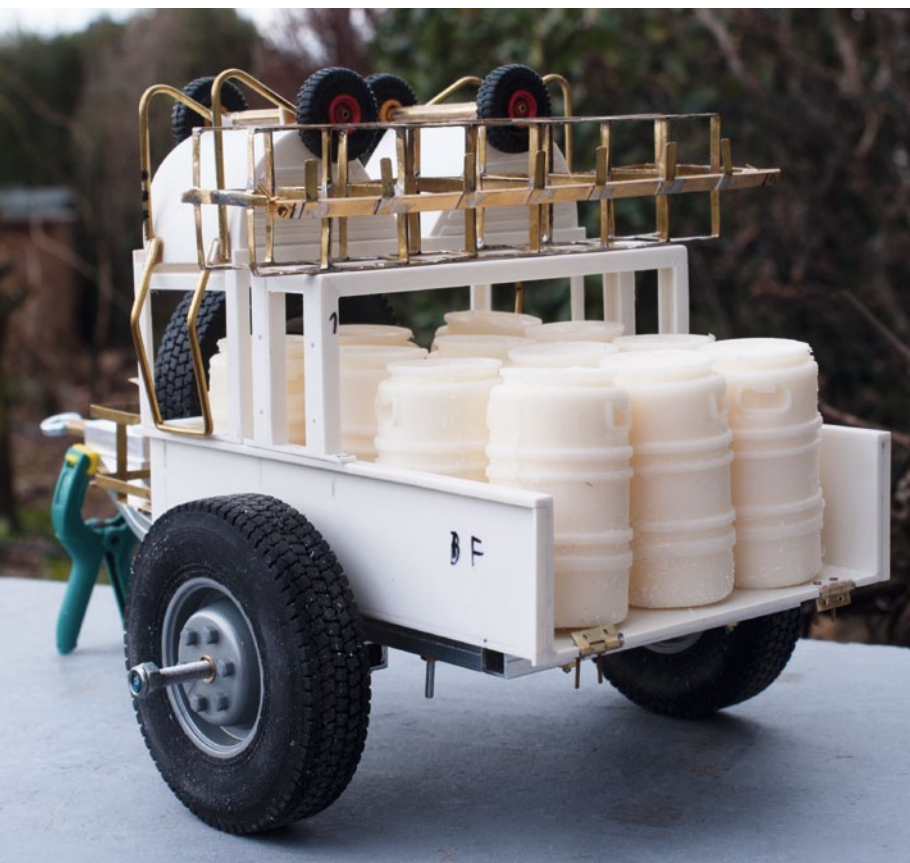
Die Fässer wurden mit Hilfe eigens angefertigter Silikonformen aus Resin gegossen
