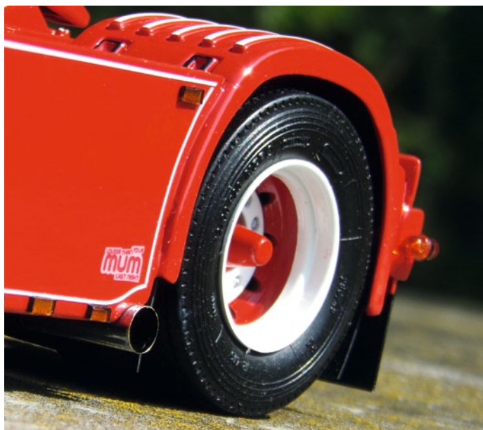
Aus den Spitzen von Plastik-Kugelschreibern entstanden die Radnaben auf der Hinterachse
