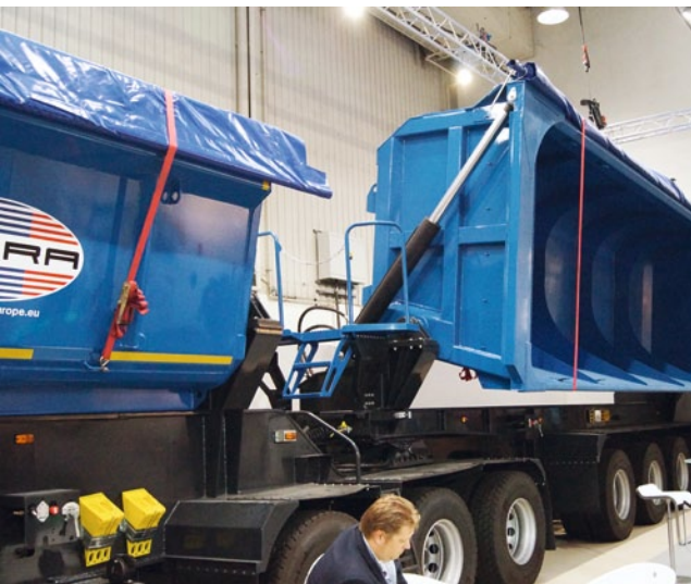
Besonders robust: Seitenkipperzug mit zwei Aufliegern für spezielle Märkte
