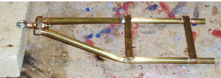
Fahrgestell des Pulverlöschanhängers TroLa 250 im Rohbau
