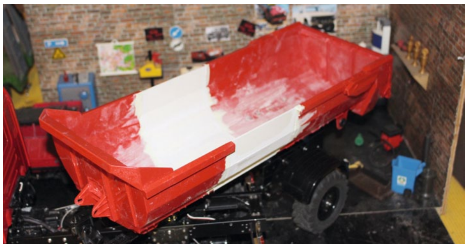
... und mit Hilfe von U-Profilen aus dem Baumarkt auf das benötigte Maß gebracht
