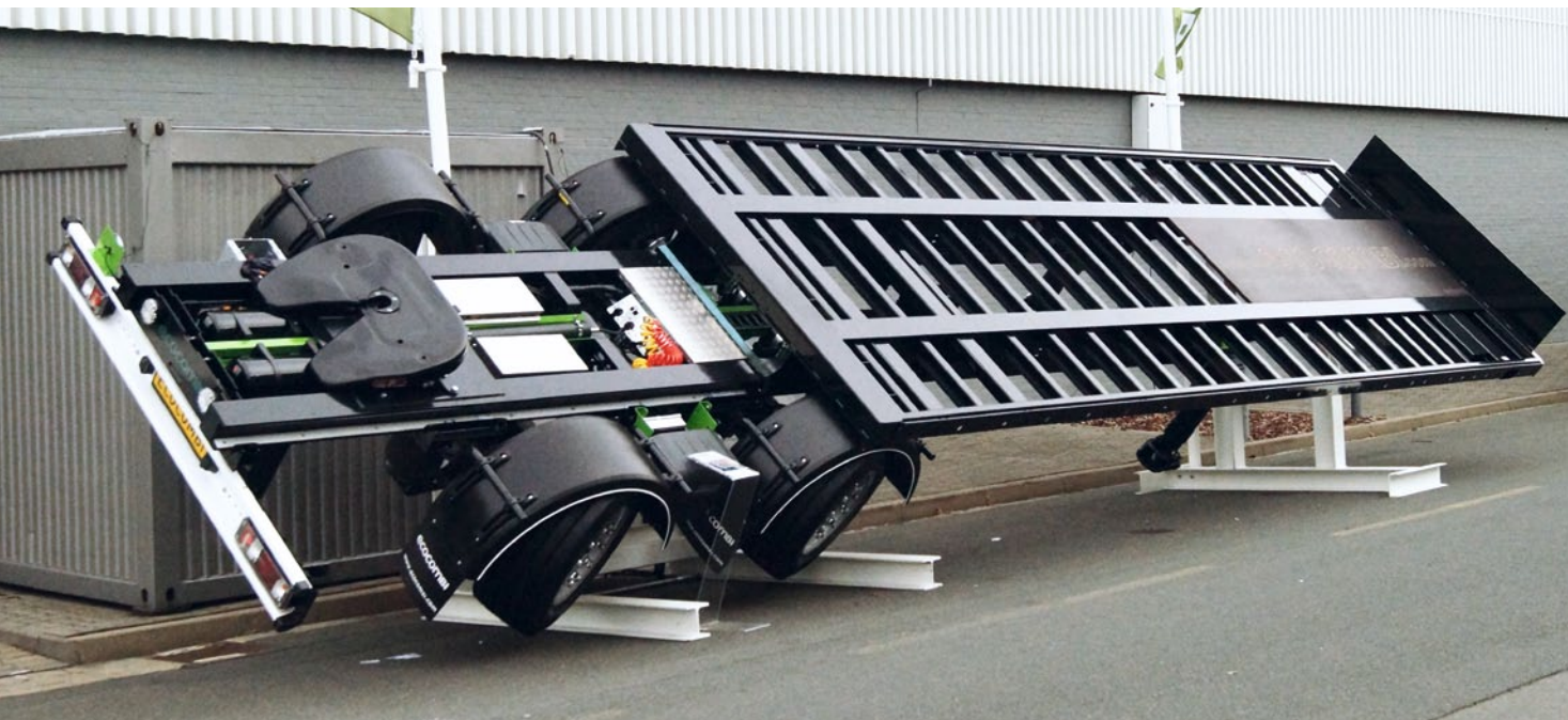
Gigaliner-Bausatz: ausziehbarer Auflieger Ecocombi mit Sattelplatte am Heck
