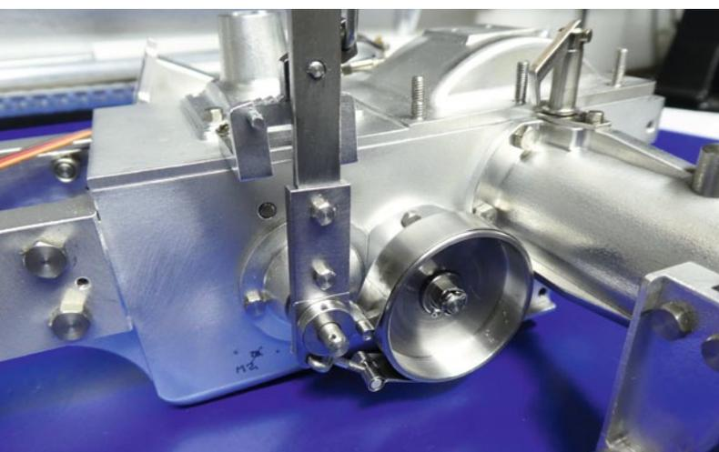
Handbremshebel, Bremsstrommel und Bremsband
