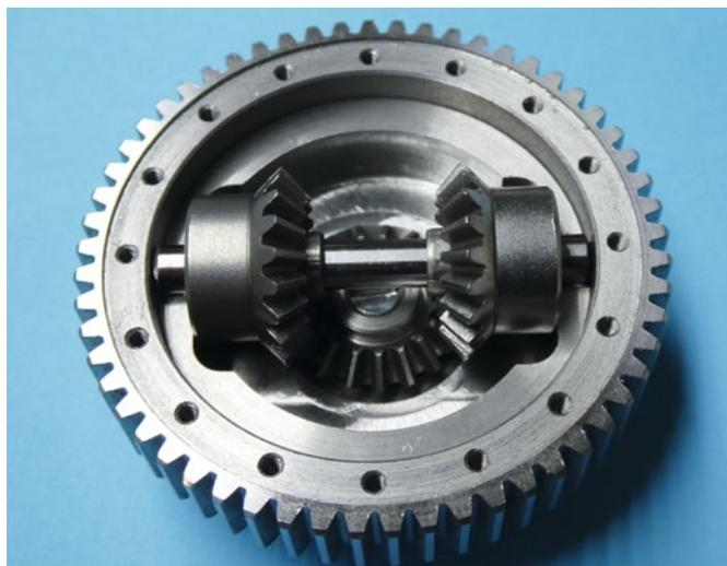
Das Differentialgetriebe entspricht dem Original
