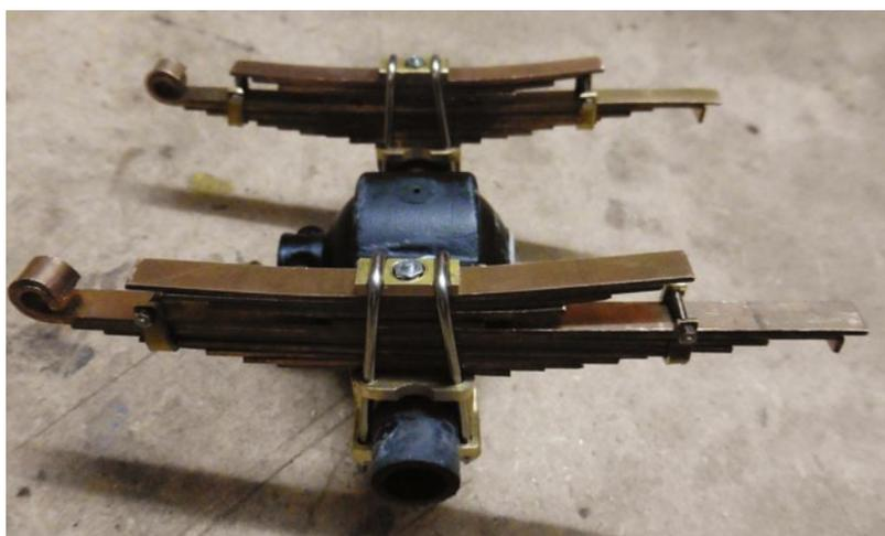
Federpaket mit Achse
