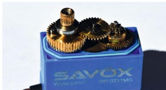
Metallgetriebe und Corelessmotoren ermöglichen hohe Stellkraft und -genauigkeit
