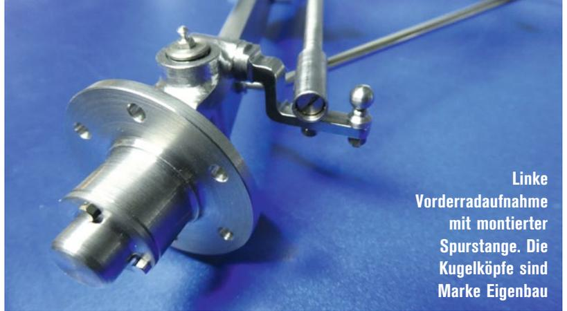
Linke Vorderradaufnahme mit montierter Spurstange. Die Kugelköpfe sind Marke Eigenbau
