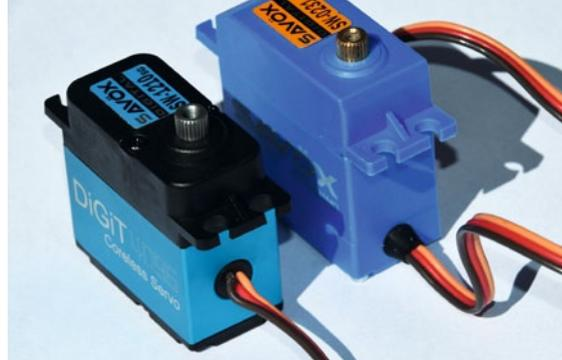
Die Servogehäuse sind nach IP-67-Norm wasserdicht konstruiert
