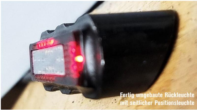
Fertig umgebaute Rückleuchte mit seitlicher Positionsleuchte
