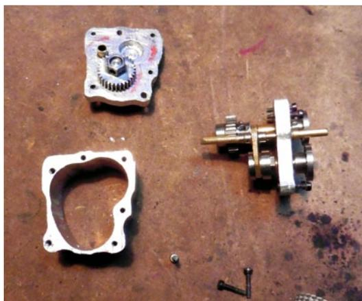
Die Einzelteile des Eigenbau-Zwischengetriebes
