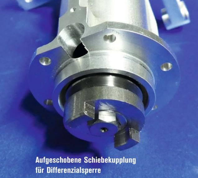
**Aufgeschobene Schiebekupplung für Differenzialsperre**
