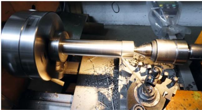
Nur noch ein paar Späne bis zur fertigen Steckachse
