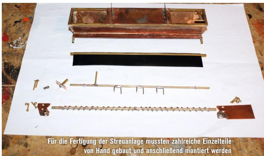
Für die Fertigung der Streuanlage mussten zahlreiche Einzelteile von Hand gebaut und anschließend montiert werden
