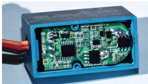
Die RC-Elektronik ist nicht extra geschützt. Savöx baut offensichtlich auf die Wasserbeständigkeit des Gehäuses
