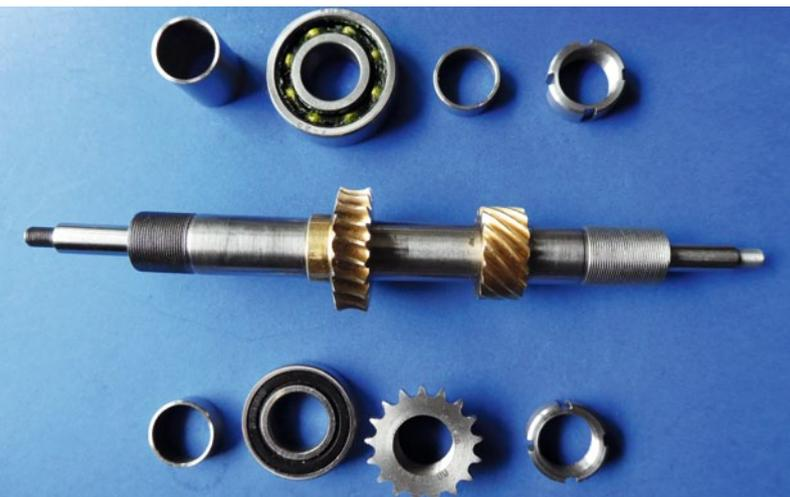
Einzelteile der Hauptwelle. Schneckenrad und Schraubenrad sind aufgespresst
