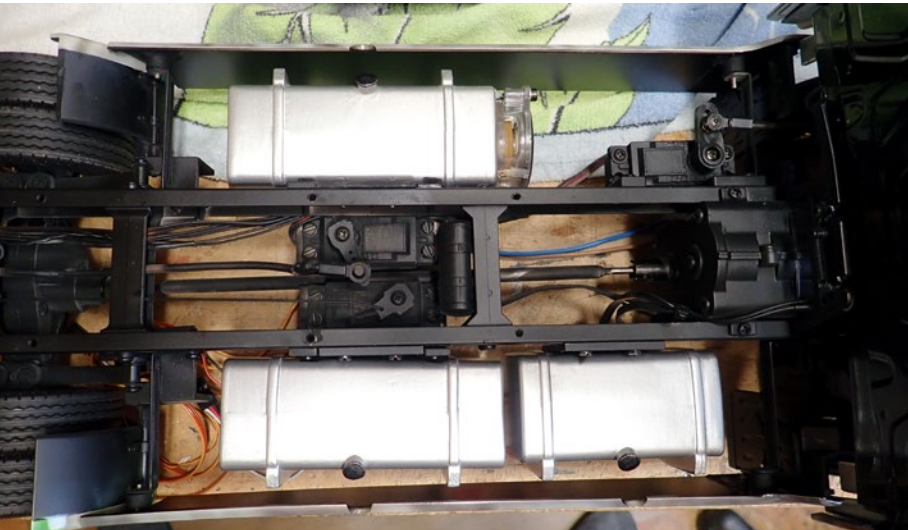
Blick von oben: Die Rahmenmitte mit den Tanks. In den oberen ist der Lautsprecher eingebaut
