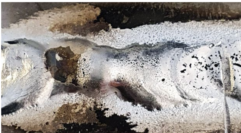
Blick auf eine Stumpfnah zweier Alubleche von je 1,5 Millimeter Stärke
