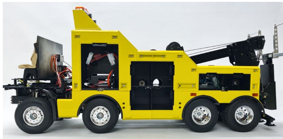
Die hinteren Karosserieteile sind montiert, die Elektronik ist verstaut. Jetzt fehlen nur noch die Klappen
