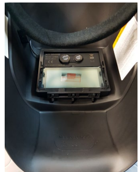
Blick in das Innere der Haube: die elektronisch geregelte Sichtschutzscheibe
