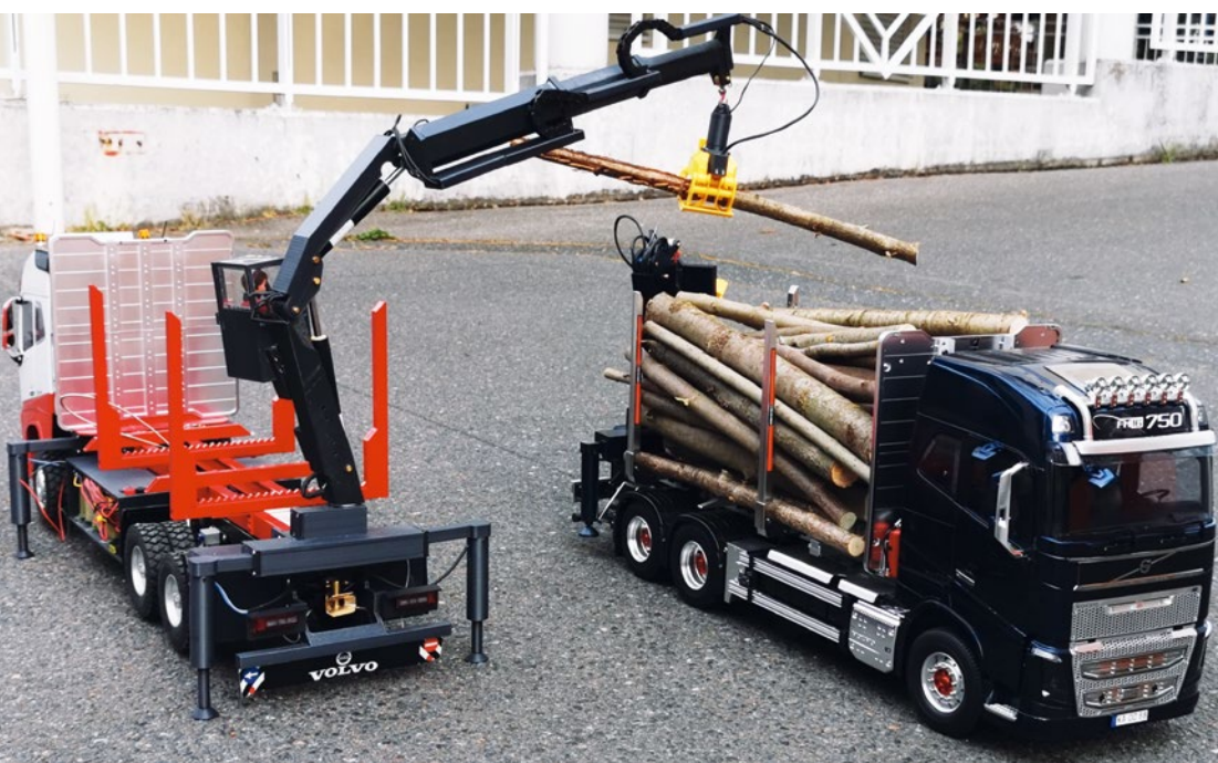
Der Holzladekran kann unkompliziert am Volvo befestigt werden. Beide Kräne sind um 360 Grad drehbar
