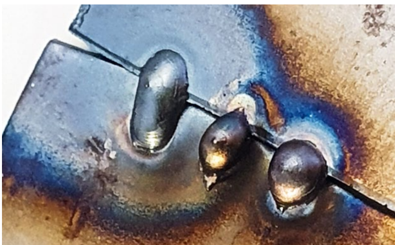
Nahaufnahme von drei Schweißpunkten, die zwei Stahlbleche von einem Millimeter verbinden. Es wurde nur sehr wenig WSGII-Zusatz genutzt
