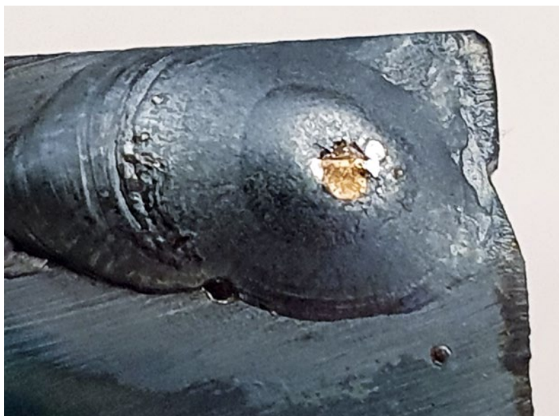
Detailaufnahme einer gelungenen Schweißung einer Ecknaht
