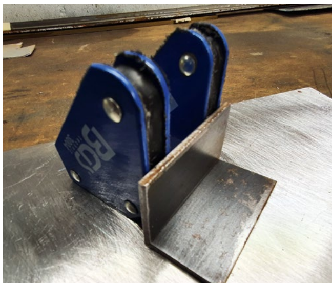
Magnetwinkel helfen, Teile für das Schweißen zueinander im rechten Winkel auszurichten
