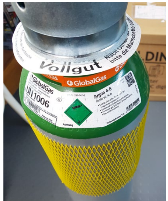
Argon 4.6 wird in unterschiedlichen Flaschengrößen angeboten. Eine 10-Liter-Flasche ist aber für den Heimgebrauch mehr als ausreichend
