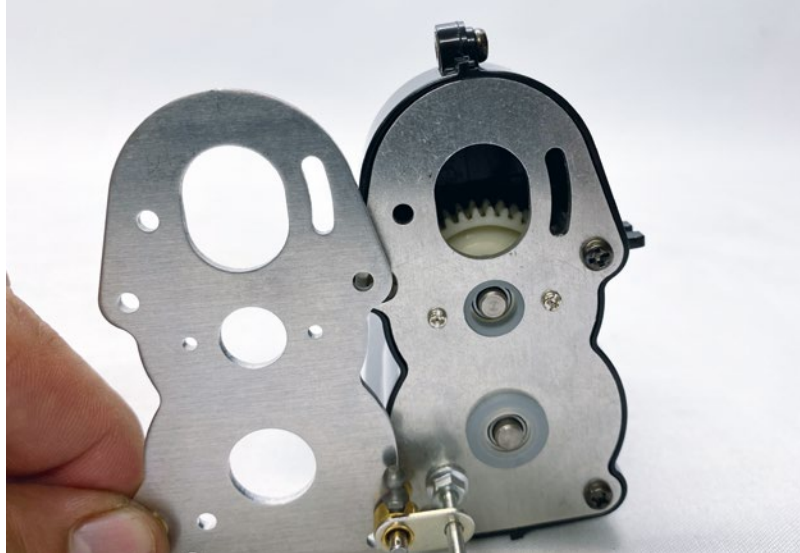
Das sogenannte Carson-Drehmomentset beinhaltet eine geänderte Stirnplatte mit erweitertem Langloch, um später den Motor mit kleinerem Antriebsritzel weiter Richtung Getriebezahnrads drehen zu können
