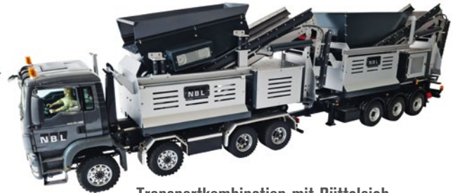
Transportkombination mit Rüttelsieb, Aufgabebunker und Abrollanhänger
