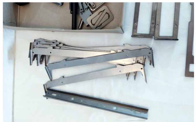
Die unteren Rungenhalter sind zweiteilig ausgeführt
