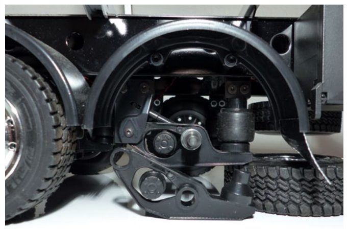
An der Neigung kann man den Unterschied erkennen, unten die plus 8 mm Variante
