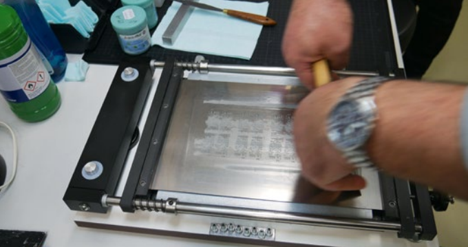
Die Platinen werden mit Zinnpaste beschichtet
