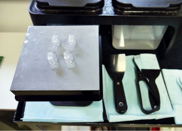
Nach dem 3D-Druck müssen die Teile gesäubert werden
