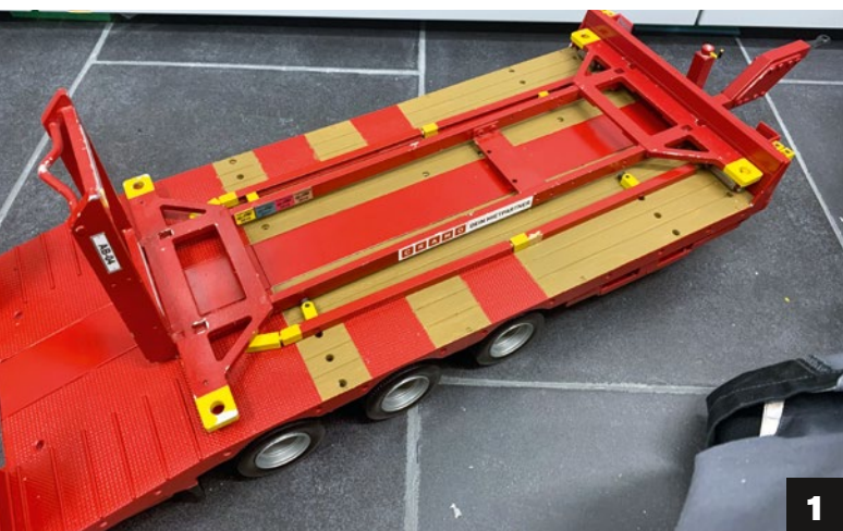
1) Probehalber aufgeschobenes Container-Rack (Leimbach/Bruder), das auch von mir ersonnen wurde, um die Container nicht fest darauf verschrauben zu müssen. 2) Zwei der Kleinteilschubladen. Erstellt aus 1-mm-Polystyrol-Platten
