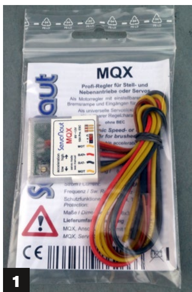
Der MQX-Regler ist zwar beim Testmuster aus der Vorserie noch mit 10 A gekennzeichnet, kann aber laut Daten bis zu 12 A Strom liefern. Die Anschlussleitungen zu Batterie und Motor sind 30 cm lang und sollten beim Einbau auf das benötigte Maß gekürzt werden
