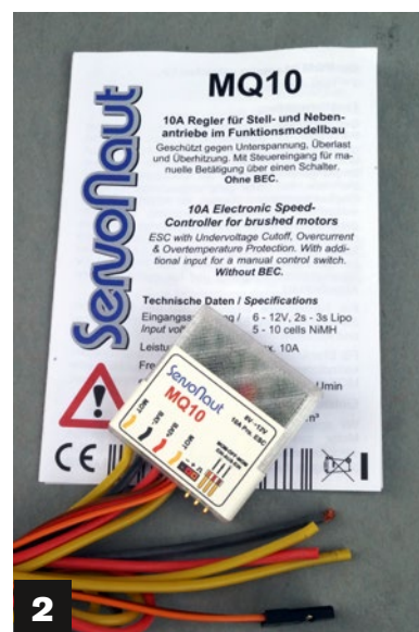
Der MQX-Regler ist zwar beim Testmuster aus der Vorserie noch mit 10 A gekennzeichnet, kann aber laut Daten bis zu 12 A Strom liefern. Die Anschlussleitungen zu Batterie und Motor sind 30 cm lang und sollten beim Einbau auf das benötigte Maß gekürzt werden
