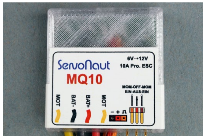
Der MQ10 lässt sich auch ohne Fernsteuerung über einen mechanischen Schalter betätigen. Der Anschluss dazu ist rechts unten zu erkennen und erfolgt über ein Servokabel. Im ScaleART-Unimog kommt aus Platzgründen der Fahrregler MFX – funktionsgleich mit dem MQX – zum Einsatz. Den Anlaufschutz übernimmt in diesem Fall die Programmierung der Commander-Fernsteuerung
