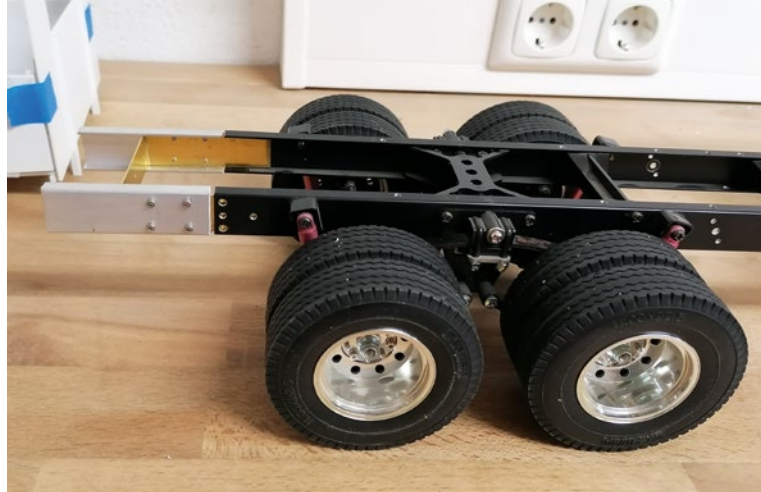
Die Rahmenverlängerung war einer der ersten Bauschritte
