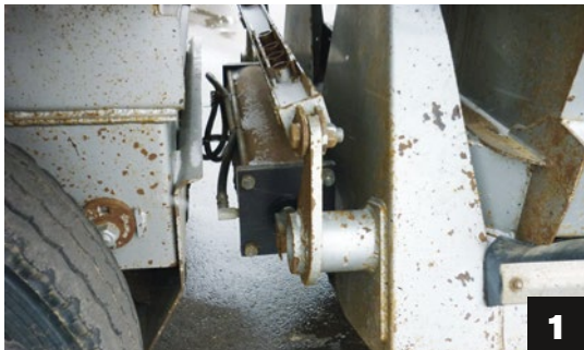
1) Nahaufnahme des Druckluftöffnungsmechanismus. 2) Nahaufnahme einer querliegenden Klappe. Weiterhin gut zu erkennen sind Rahmendetails und die „Stützbeinchen“. 3) Eine von vielen Heckvarianten
