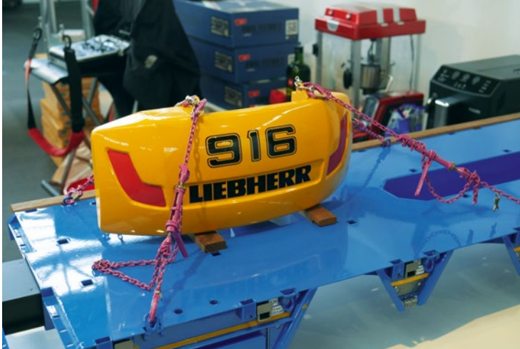
Der Auflieger aus 1-mm- und 2-mm-Stahlblech bietet ausreichend Befestigungsmöglichkeiten. Zum Beispiel für maßstabsgetreue Fahrzeugteile
