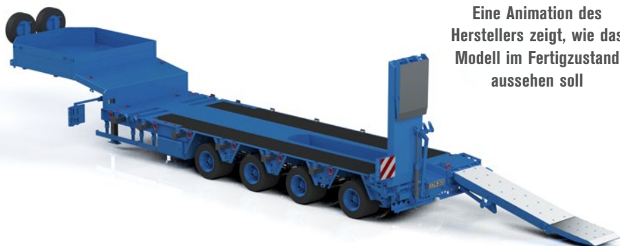
Auch hinten stimmen die Details und sorgen für eine überzeugende Gesamtoptik. Der Tieflader ist übrigens um 250 mm teleskopierbar
