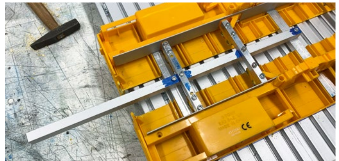
Vormontierte Quertraversen mit dem Rohteil der Deichsel, alles mit M3-Schrauben befestigt
