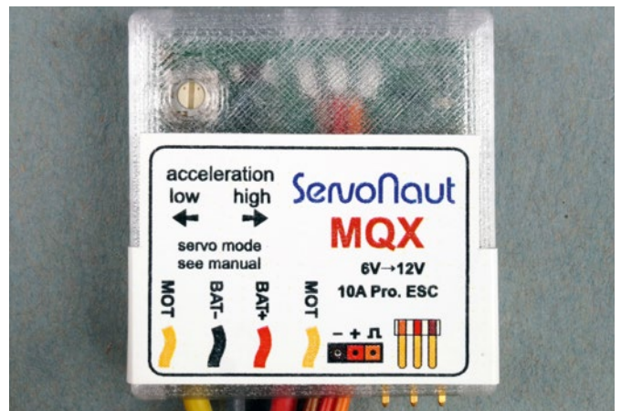
Mit dem Trimmer links oben lassen sich beim MQX das Verhalten der Regelung im Servo- und beim Motorbetrieb einstellen. Unten rechts sieht man die Steckerleiste für das Poti beziehungsweise die Endlagenschalter
