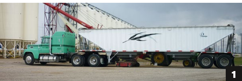
1) Dieser Grainhopper (Getreide) steht zur Entladung in einer Siloanlage. Von hier geht es per Bahn mit „Hopper Cars“ weiter. Bei diesem Auflieger ist der Trichter deutlich zu erkennen. 2) Bei diesem B-Train-Hopper sind die Trichter verkleidet
