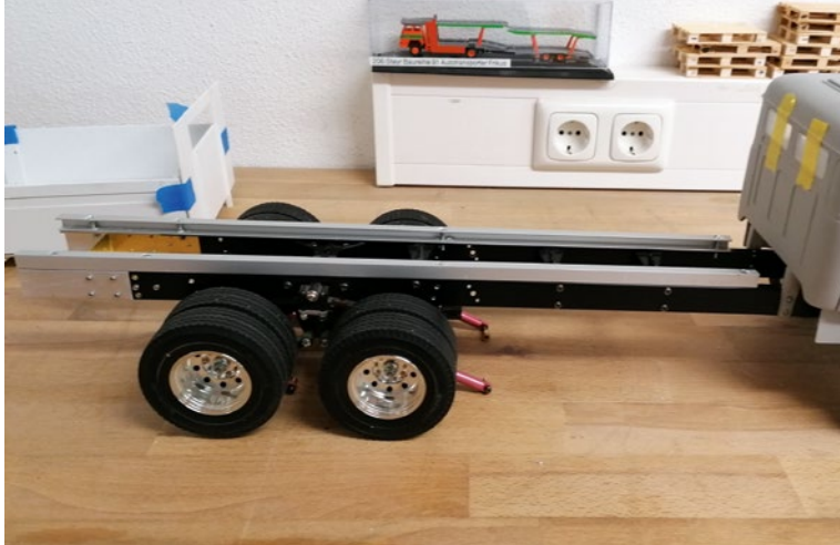
Der Hilfsrahmen wird an den verlängerten Rahmen angebaut
