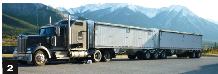
1) Dieser Grainhopper (Getreide) steht zur Entladung in einer Siloanlage. Von hier geht es per Bahn mit „Hopper Cars“ weiter. Bei diesem Auflieger ist der Trichter deutlich zu erkennen. 2) Bei diesem B-Train-Hopper sind die Trichter verkleidet
