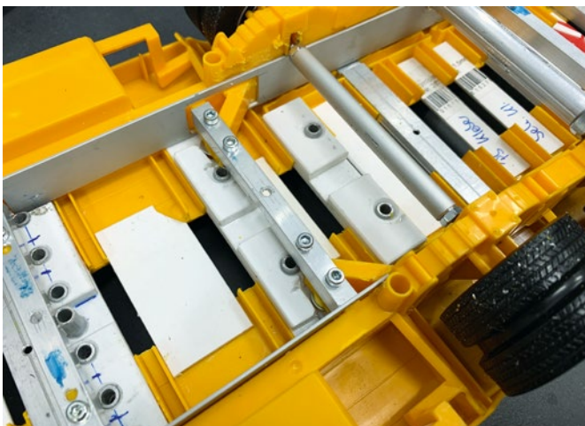
Die Achsen, sowie die Unterfütterungen mit den eingeklebten Aluminiumrohren für die Rungen und Befestigungsmittel
