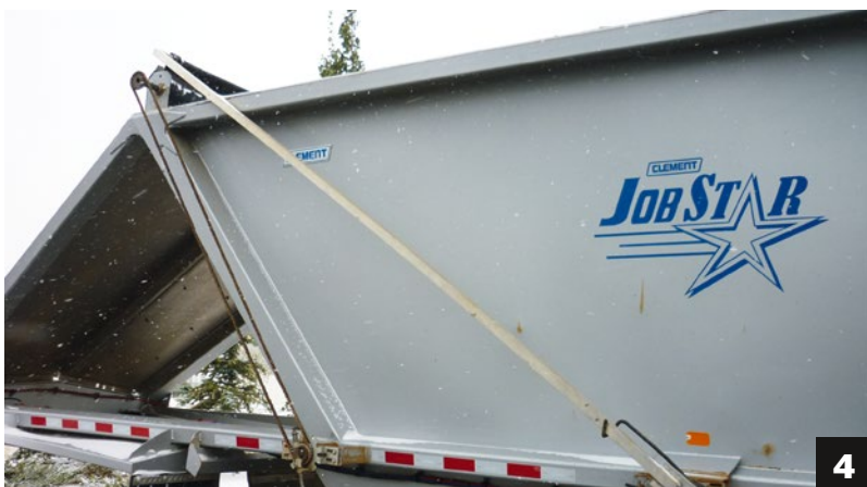
4) Die Abdeckung (tarp) der Ladung ist wichtig. Häufig werden „Roll Tarps“ verwendet. Mit dem Bügel wird die Plane von der Rolle bis zum Heck gezogen und mit der Kurbel und dem Kettenantrieb wird sie wieder aufgerollt. 5) Rahmendetails
