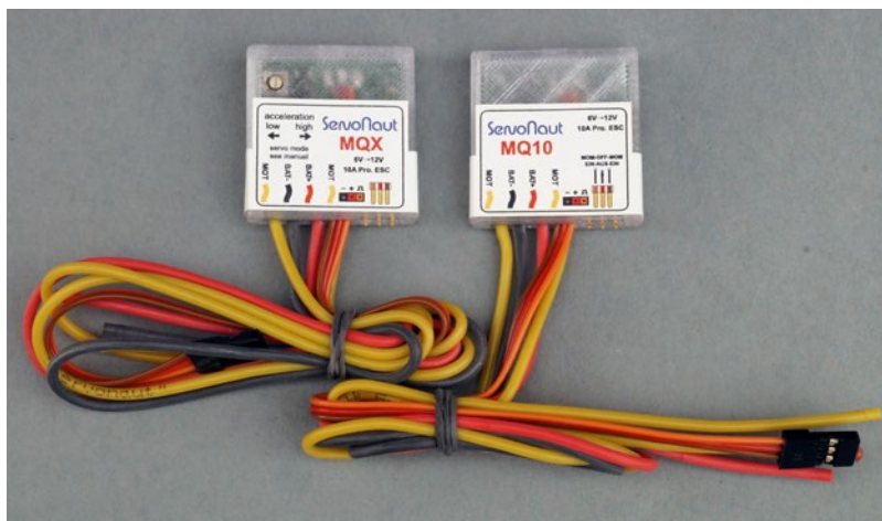
MQ10 und MQX sind von den Abmessungen und den Hauptanschlüssen identisch, aber unterscheiden sich in den inneren Werten
