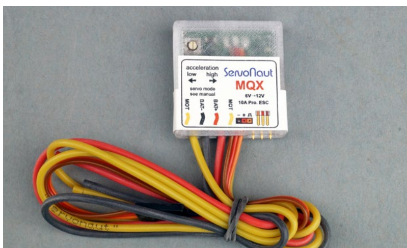
Der MQX-Regler ist zwar beim Testmuster aus der Vorserie noch mit 10 A gekennzeichnet, kann aber laut Daten bis zu 12 A Strom liefern. Die Anschlussleitungen zu Batterie und Motor sind 30 cm lang und sollten beim Einbau auf das benötigte Maß gekürzt werden
