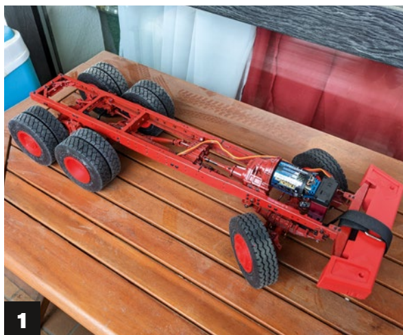
1) Das Fahrwerk vor dem Getriebeumbau auf Brushless mit Planetengetriebe. 2) Der Antrieb bietet ein beachtliches Drehmoment – selbst bei langsamem Anfahren können alle sechs Reifen zum Durchdrehen gebracht werden
