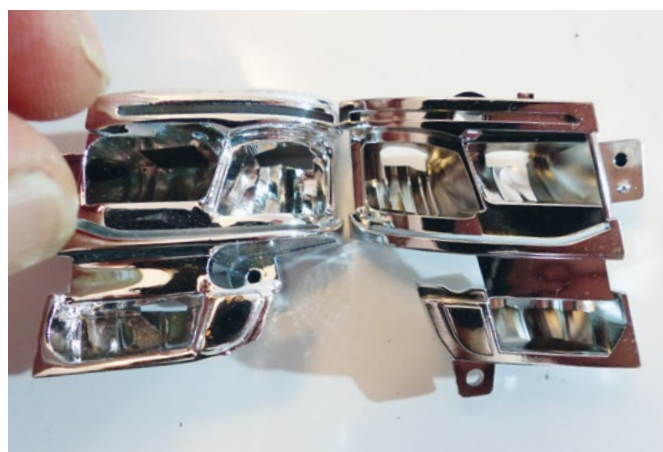
Links der neue Kraftwerk Leuchtkörper, deutlich zu sehen, unten das Tagfahrlicht, ober der Lauflichtblinker
