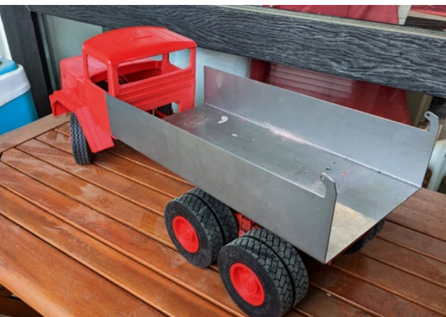
Als Basis für den Kippaufbau dient 1,5-mm-Blech
