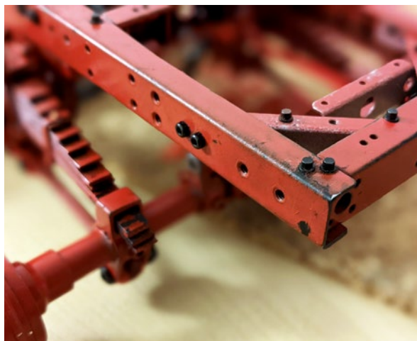
Der Rahmen des gekauften Untersatzes ist aus Stahlblech gefertigt
