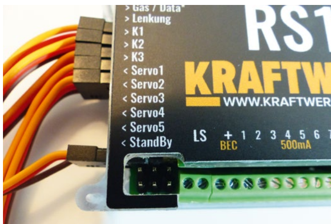
Über die sechs Jumper werden der Sound und das Kraftwerk PAD eingestellt
