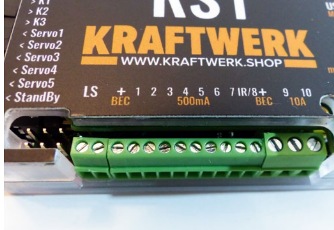
Von links nach rechts. Jumper, Lautsprecher, Lichtausgänge plus Infrarot Ausgang, 9 und 10 sind für die Zukunft
