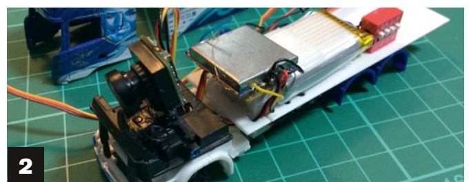
1) Scania G500 XT – Las Vegas bei Nacht im Miniaturwunderland. 2) Objektiv, Videosender, LiPo für FPV-System, Switcher für die Kanalwahl
