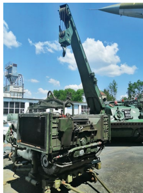
Ein Bergepanzer hebt den tonnenschweren Motor auf ein extra Chassis
