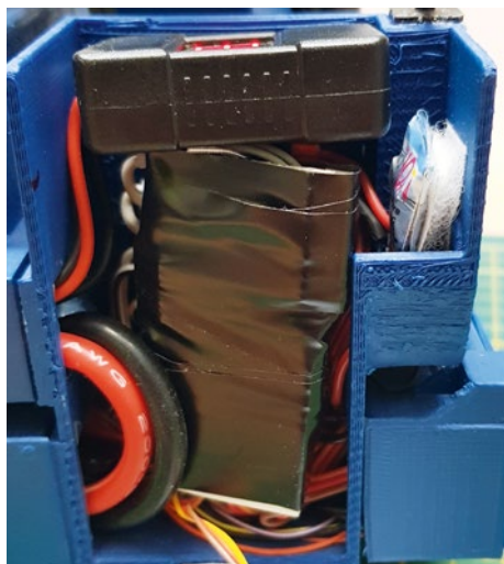
Durch den oberen Kabelkanal kommt das Balancer-Kabel zum LiPo im seitlichen Kasten
