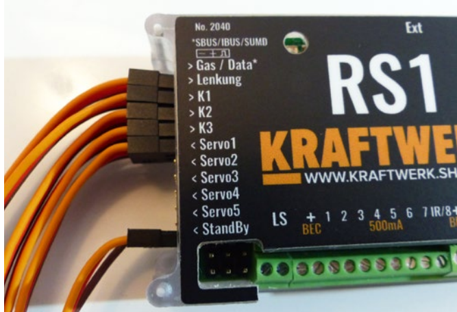
Links die Servokabel für den Empfänger, plus 5 weitere Servoausgänge
