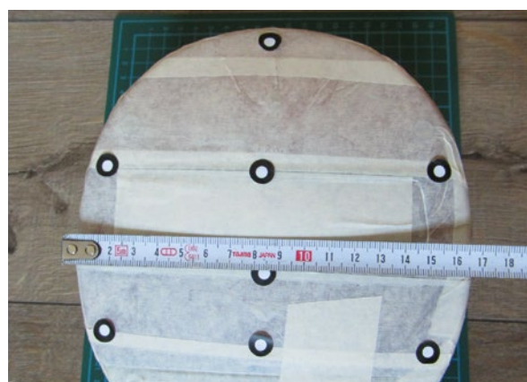
Das Vermessen der Original-Rückleuchte ist nötig, um den richtigen Skalierfaktor zu bestimmen. Mit diesem ist es möglich, das Objekt im benötigten Maßstab zu drucken
