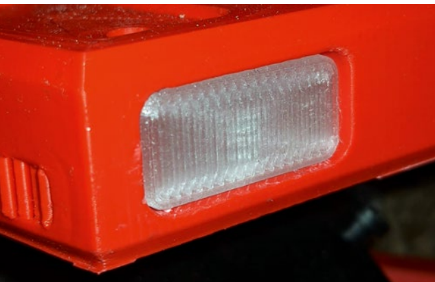
Aus PETG gedruckter Scheinwerfer
