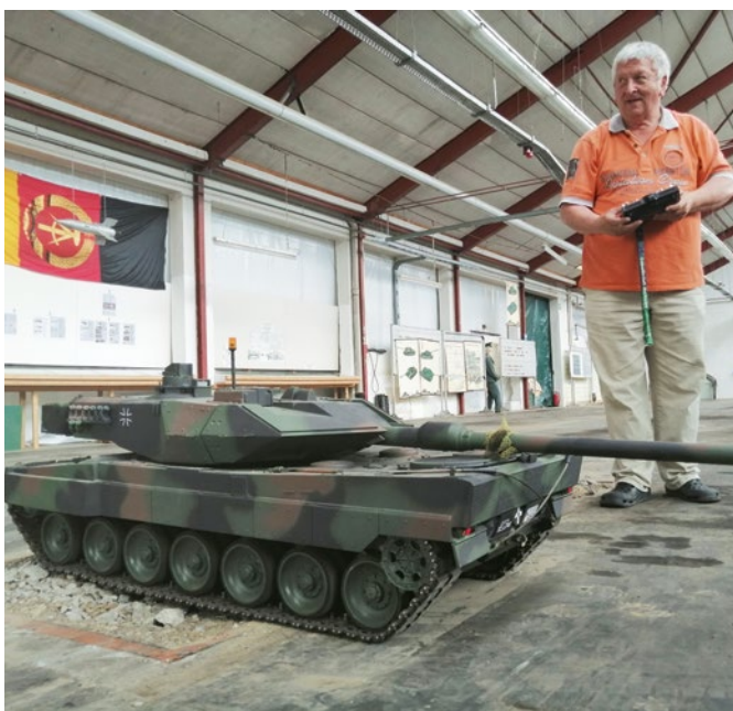
Kurt Webers Leopard 2A6 im Maßstab 1:6 hat ein Gewicht von fast 85 kg und misst ohne Kanone schon 130 cm
