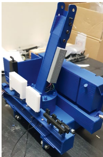
Erste Passprobe des Wagens mit unverschlossenen Kästen und Stützenattrappen
