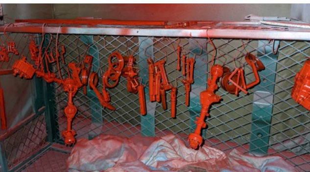
Alle Chassis-Teile wurden per Spraydose rot lackiert
