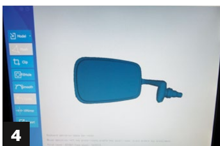
3) Hier kann man sehen, wie sich das zu scannende Objekt langsam Punkt für Punkt aufbaut. 4) Fertig zusammengestellter Scan, der später gedruckt werden kann. 5) Letzte Vorbereitungen, bevor der 3D-Druck starten kann
