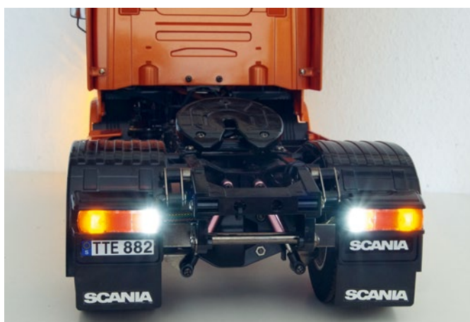
Beim Einlegen des Rückwärtsgangs werden automatisch die Rückfahrcheinwerfer und die Warnblinker aktiviert
