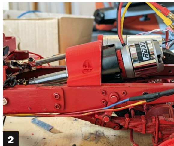
1) Das Fahrwerk vor dem Getriebeumbau auf Brushless mit Planetengetriebe. 2) Der Antrieb bietet ein beachtliches Drehmoment – selbst bei langsamem Anfahren können alle sechs Reifen zum Durchdrehen gebracht werden
