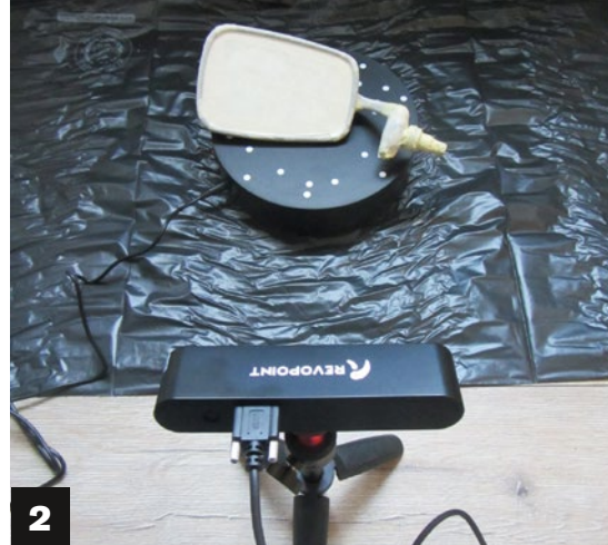
1) Erster Scanversuch mit durch Kreidespray mattiertem Spiegel. Das Spray lässt sich später ohne Rückstände wieder mit Wasser entfernen. 2) Zweiter Scanversuch. Diesmal mit Mattierung per Malerkrepp, da das Kreidespray schnell abbröckelte. Im Vordergrund ist der Aufbau des Scanners zu erkennen
