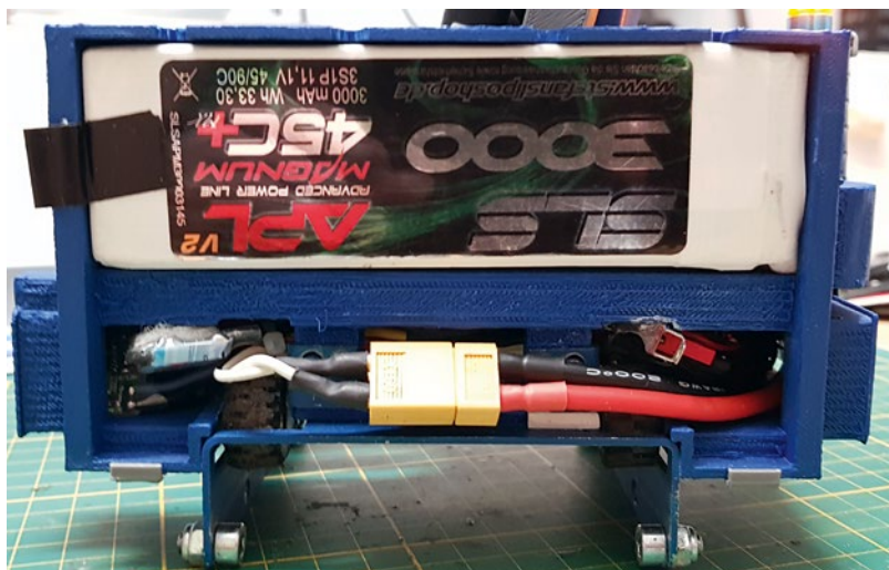
Im Modell nimmt der Akku den Platz von Hydraulik- und Benzintank ein
