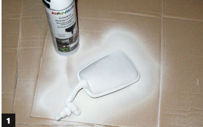
1) Erster Scanversuch mit durch Kreidespray mattiertem Spiegel. Das Spray lässt sich später ohne Rückstände wieder mit Wasser entfernen. 2) Zweiter Scanversuch. Diesmal mit Mattierung per Malerkrepp, da das Kreidespray schnell abbröckelte. Im Vordergrund ist der Aufbau des Scanners zu erkennen
