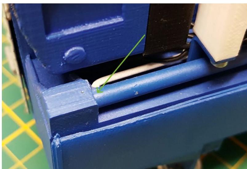
Der Hydraulikzylinder (Messing-Rundprofil) samt Aufnahmeklotz wurde oben auf den Stützenattrappen installiert
