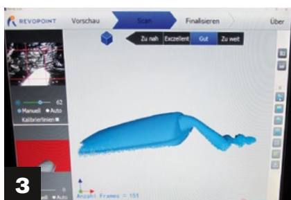
3) Hier kann man sehen, wie sich das zu scannende Objekt langsam Punkt für Punkt aufbaut. 4) Fertig zusammengestellter Scan, der später gedruckt werden kann. 5) Letzte Vorbereitungen, bevor der 3D-Druck starten kann
