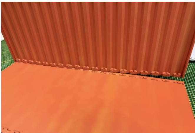
Leicht verzogen sind die Seitenwände des Containers. Die 19 Befestigungspunkte ziehen das Teil aber wieder in Form
