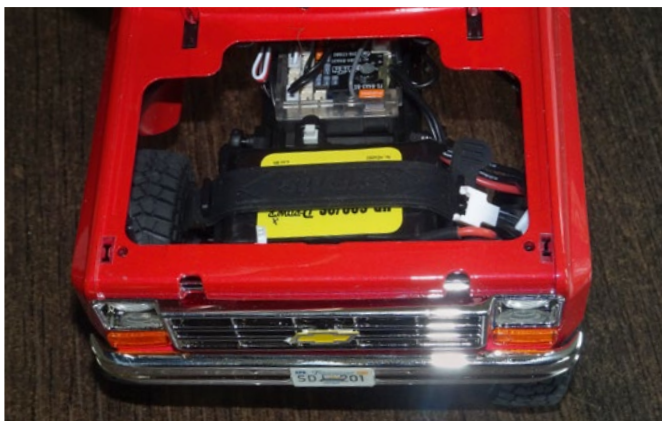
Viel Platz unter der Motorhaube für den riesigen 900-mAh-Lipo
