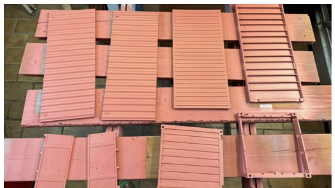
Die Teile wurden mit der Spraydose lackiert, was wegen der Verarbeitung keiner langer Vorbereitung bedarf
