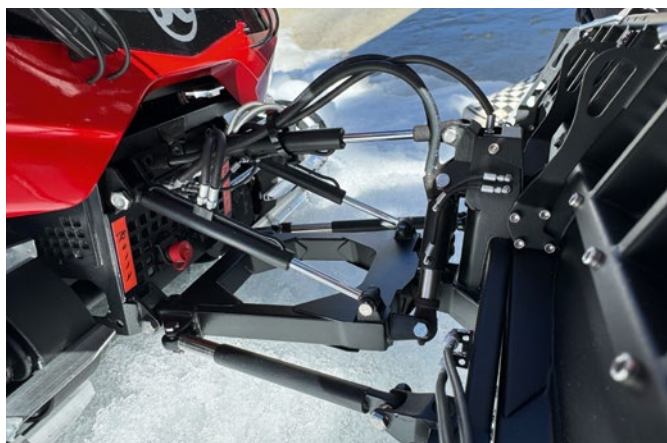
Geräteträger mit den originalgetreuen winzigen Hydraulikan schlüssen
