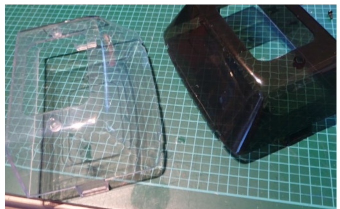
Zum Interieur von FairRC bekommt man auch noch eine glasklare Verglasung. Rechts daneben die serienmäßige „Verglasung“
