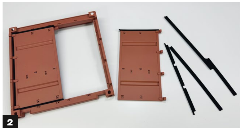
Die Teile wurden mit der Spraydose lackiert, was wegen der Verarbeitung keiner langer Vorbereitung bedarf
