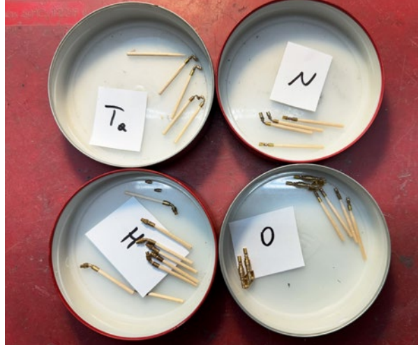
Winzige Messingdruckteile für die Hydraulikanschlüsse
