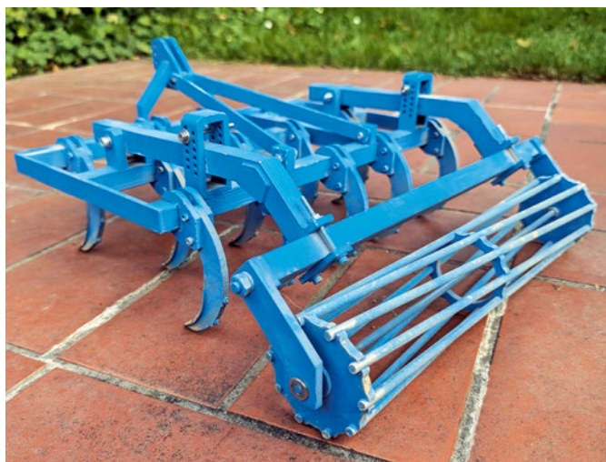
Die Krümelwalze erhält die diagonalen Streben durch Verdrehen der beiden Enden gegeneinander
