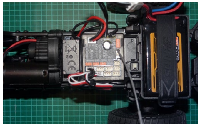
Ohne Fahrerhaus hat man einen freien Blick auf das Chassis mit dem Zweiganggetriebe und der Elektronikeinheit sowie den Akku
