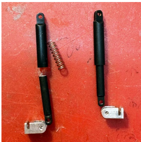
Selbst angefertigte Dämpfer und Halterungen
