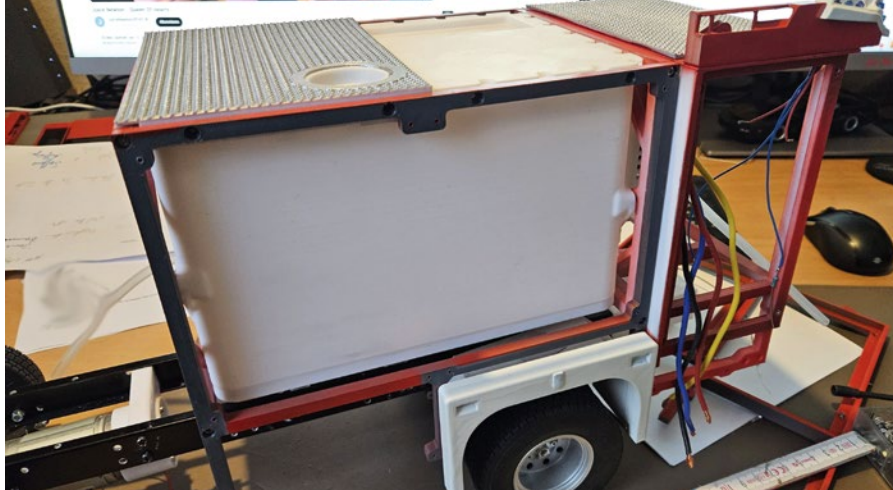
Das passt: Der Tank wurde in den Fahrzeugrahmen eingesetzt
