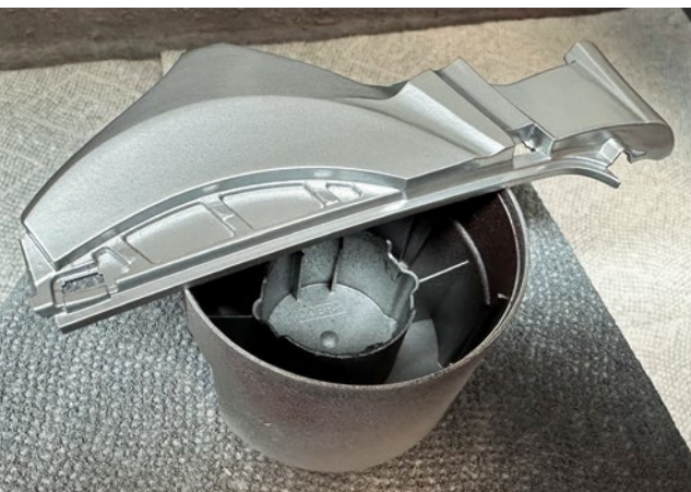
Grundierung der Druckteile mit Silberlack als UV-Schutz
