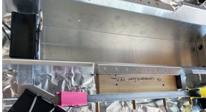
Verkleben der Fahrwerkswanne
