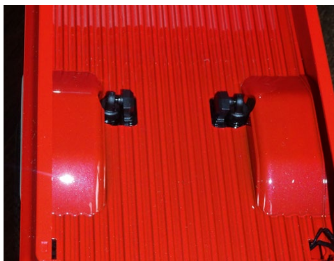
Leider wird die Ladefläche nicht nur durch die Radhäuser unterbrochen sondern die Aufnahmen für die Federbeine bleiben auch sichtbar
