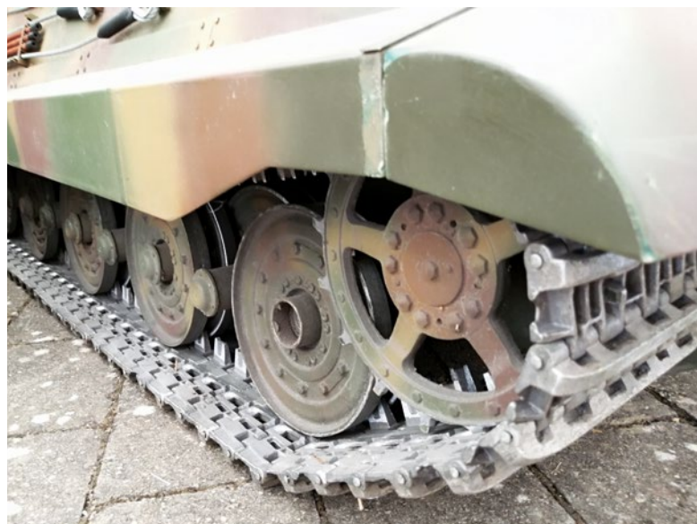
Detaillierte und vor allen Dingen haltbare Ketten sind bei Panzermodellen ein ganz wichtiger Punkt
