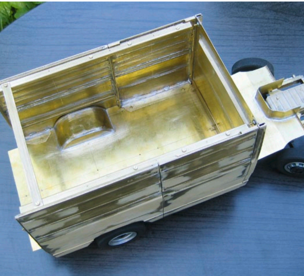
Laderaum im Entstehungsprozess. Zum Fahrerhaus besteht eine Trennwand, die dem ganzen Aufbau die nötige Verwindungssteifigkeit verleiht
