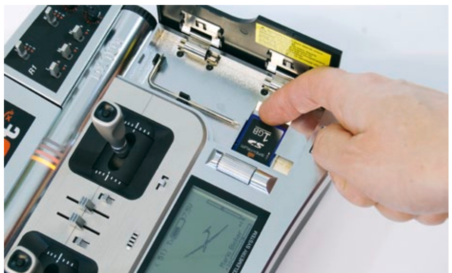
Im rechten Fach ist der SD-Kartenslot. Speicherkarten bis zu 32 Gigabyte ermöglichen Software-Updates, umfangreiche Flugdatenlogs und Modellkopien
