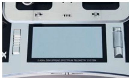
Links neben dem Display ist der nicht hervorstehende Ein-Aus-Schalter und rechts der Rolldrucktaster zum Programmieren platziert
