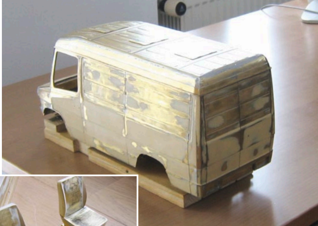
Nachdem die filigrane Regenrinne auch im Heckbereich fertiggestellt war, wurde das Dach geschlossen
