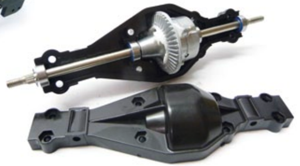
Das komplette Differentialgetriebe besteht aus Metallteilen. Um einen reibungslosen Betrieb zu gewährleisten, kann eine großzügige Schmierung nicht schaden
