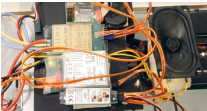
Alles aus einem Hause: Zwo4-Empfänger, Fahrregler Servonaut S20, Soundmodul SMT und Testobjekt SM+ beim Testlauf
