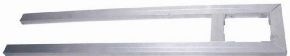
Das Grundgerüst des Aufliegers besteht aus verschiedenen Aluprofilen
