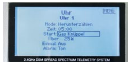
Zwei Timer, die die Zeit stoppen, mit- oder runterzählen lassen sich einstellen – verknüpft an einem frei wählbaren Kanal oder Schalter
