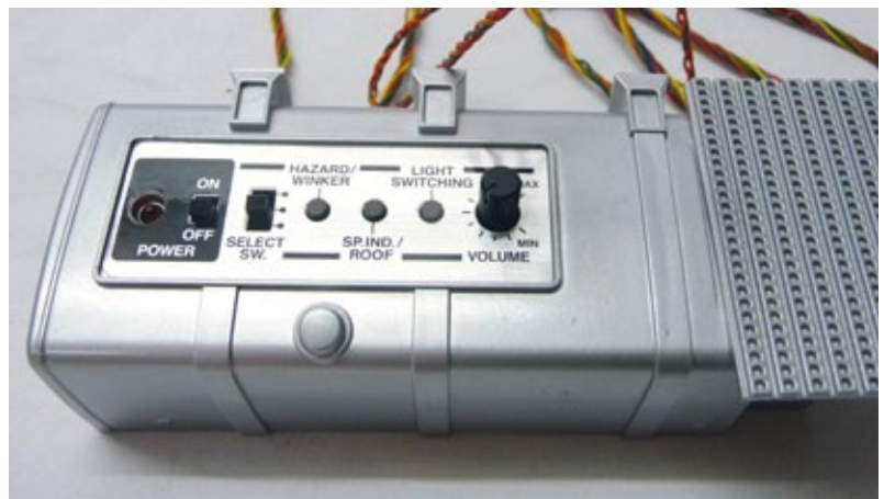
Die Schalteinheit der MFC-01 wird im silbern lackierten Tank untergebracht
