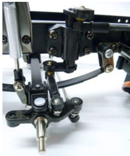
Um eine vorbildgetreue Lenkung zu ermöglichen, wurden die beiden Achsschenkel um 180 Grad gedreht eingebaut
