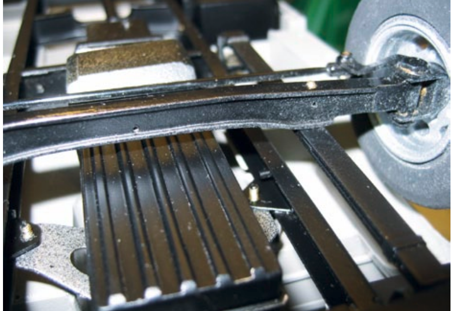
Die Vorderachse entstand aus einem aus vier Blechstreifen zusammengelöteten Kastenprofil. Die Achsschenkel sind dank Lagerbüchsen weitgehend spielfrei
