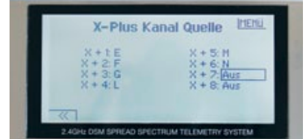
Ist die Kanalerweiterung X-plus aktiviert, stehen acht weitere, frei belegbare Funktionen bereit
