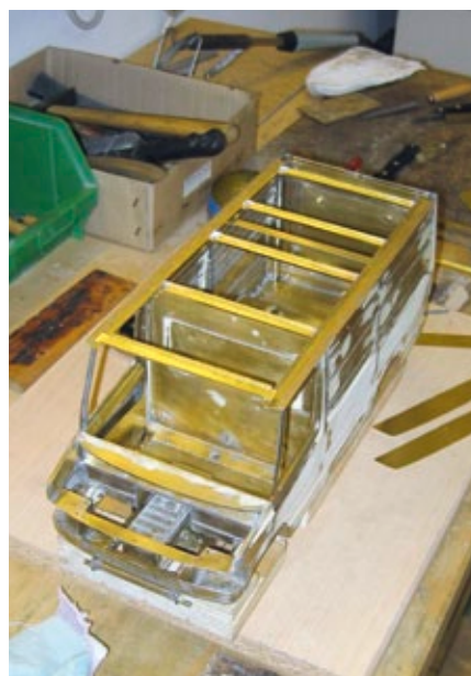
Die Spanten für die Dachkonstruktion liegen schon parat
