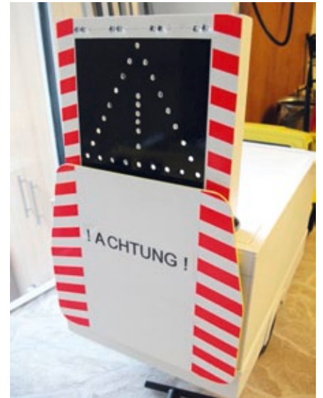
Warnleuchten und Lauflichter: jedes Loch soll hier eine LED beherbergen
