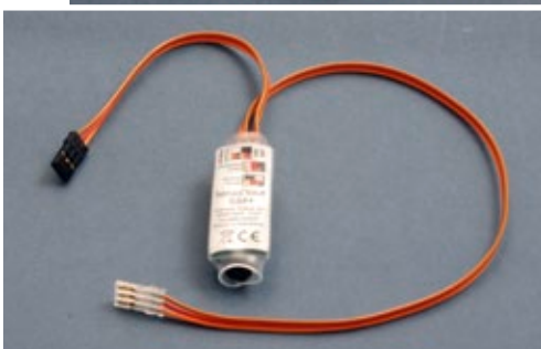
Geräuschmodul SM+; die beiden Servokabel stellen die Verbindung zum SMT oder SMX und zum Empfänger her
