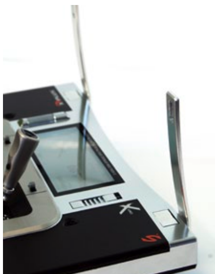
Im Gehäuse sind die Bügelhalter zum Anbringen des Sendergurts integriert
