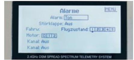
Mehrere Alarme – zwei davon freien Kanälen zuordnungsfähig – sind optisch, akustisch und/oder als Vibrationsalarm einstellbar
