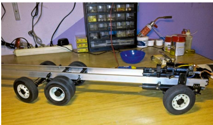
Statt der Motor-Getriebeeinheit von Tamiya war das Modell bereits aus früheren Tagen mit einem Truckpuller von LRP ausgerüstet
