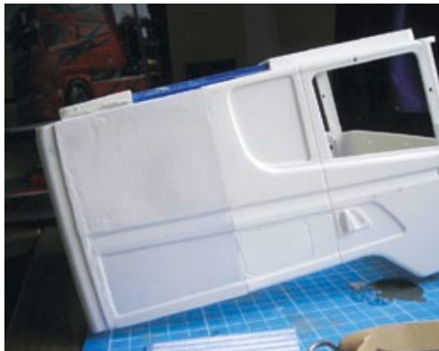
Marke Eigenbau: Sicken aus Polystyrol überbrücken den Zwischenraum
