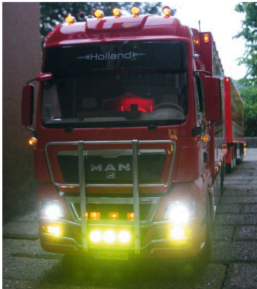
Spot an: Insgesamt kommen über 120 Lampen am Gigaliner-Modell zum Einsatz. Die Elektronik dafür stammt von Servonaut und MM-Modellbau
