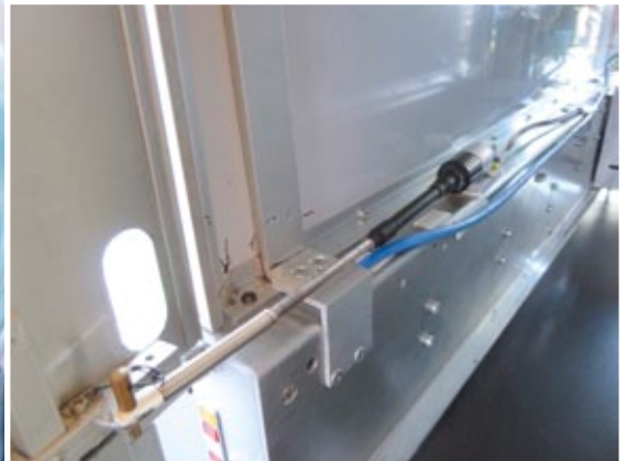
Der Öffnungsmechanismus für die hintere Tür des Aufliegers
