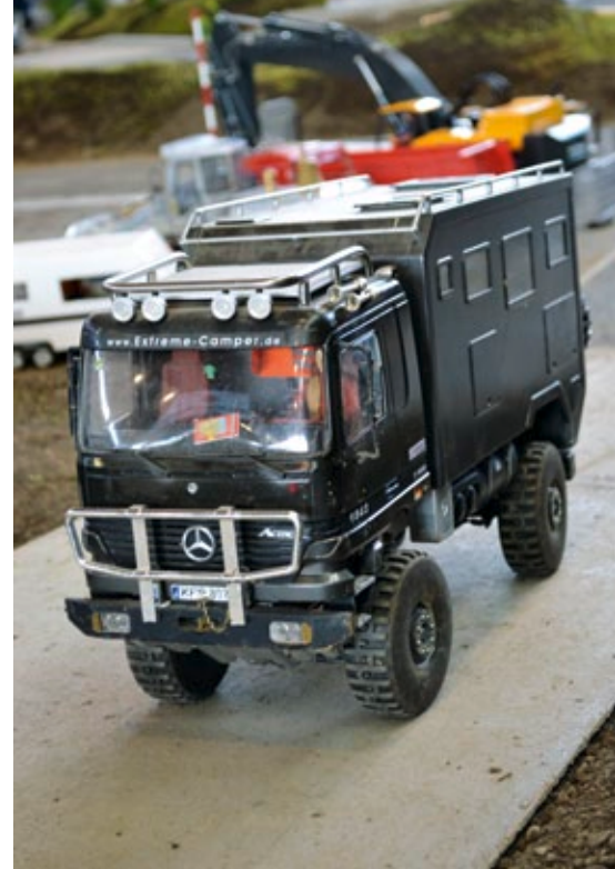
Der Actros ist ein Nachbau eines 6x6er-Fahrzeugs. Im Modell wurde der Truck zugunsten des Wendekreises auf 4x4 gekürzt
