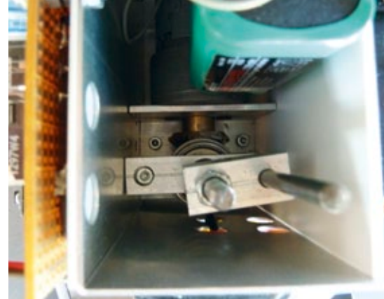
Das vordere Hubgetriebe für die Schwinge mit Winkeltrieb und Drucklager
