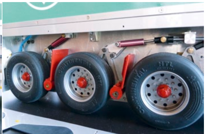
Leerfahrt auf Achse zwei (linkes Bild), die Achsen eins und drei bei voller Beladung
