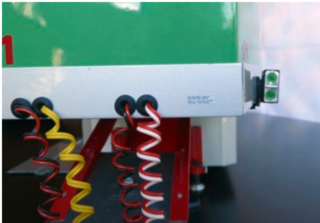
Ein wichtiges Detail ist die Anzeige der Ladungssicherung: Die Lampe auf der rechten Seite
