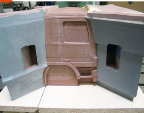
Vom Urmodell des Actros MP3 wird eine Negativform erstellt
