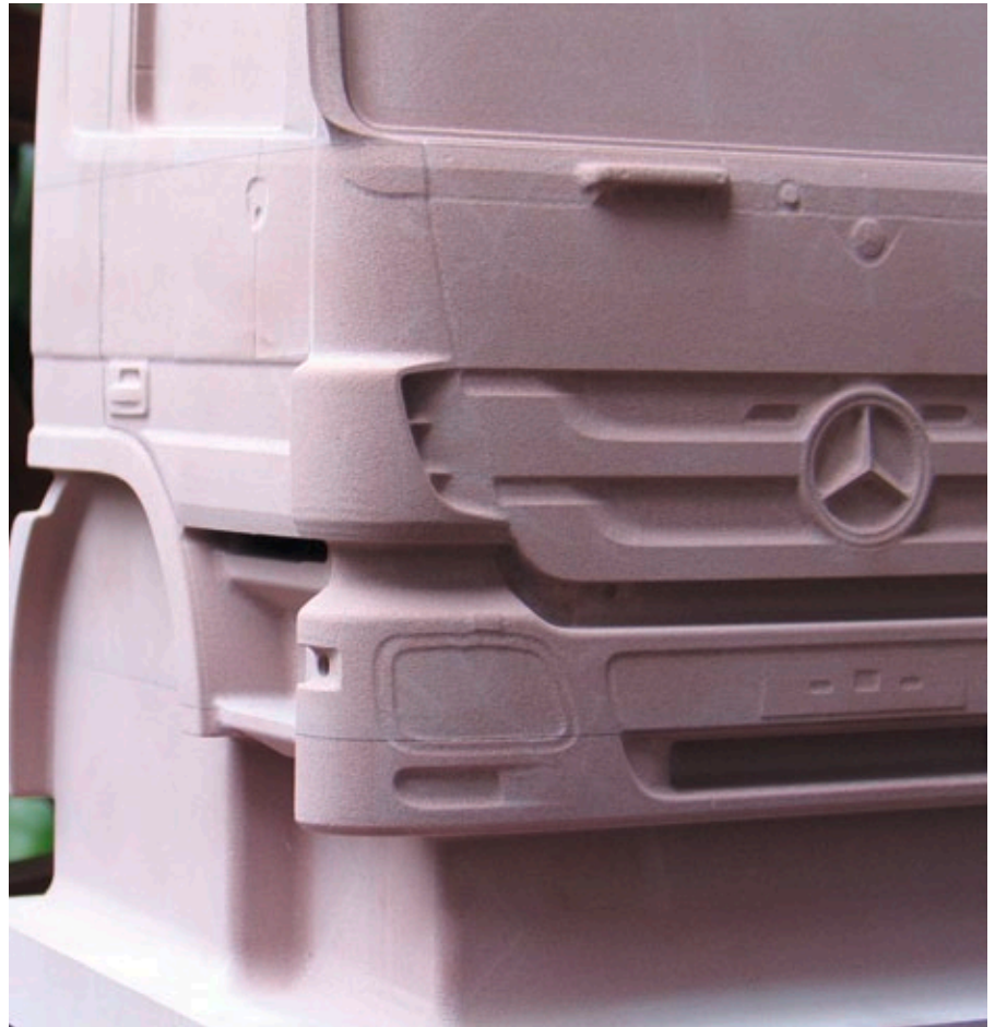
Mittels CNC und CAM wurde aus Kernblockmaterial das Urmodell hergestellt
