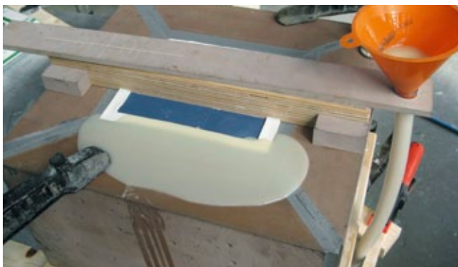
Die Negativform wird in ein wasserdichtes Gehäuse fest eingepresst, als Gussmaterial dient Resin
