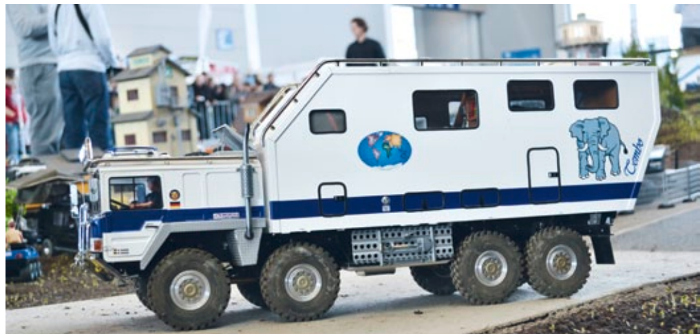
Der MAN SX 8x8 verfügt wie alle Extreme-Camper-Modelle über einen Allradantrieb und außerdem voll funktionsfähige Differenzialsperren
