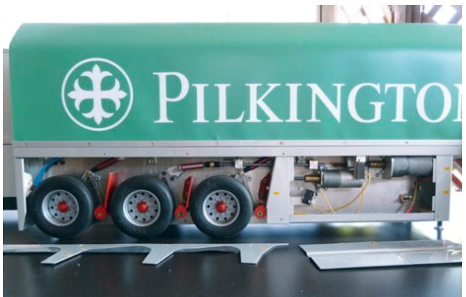
Die erste und die dritte Achse laufen über Gestänge und Motor, während die mittlere Achse über ein Federbein, Gestänge und Motor betätigt wird
