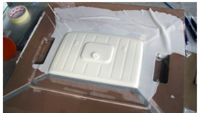
Nach dem Aushärten kann das frisch gegossene Fahrerhaus aus dem Gehäuse genommen werden
