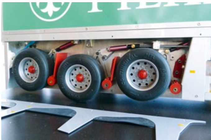
Leerfahrt auf Achse zwei (linkes Bild), die Achsen eins und drei bei voller Beladung
