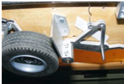
Ein Achslager mit Schwinge aus 6-Millimeter Aluminium im Rohbau
