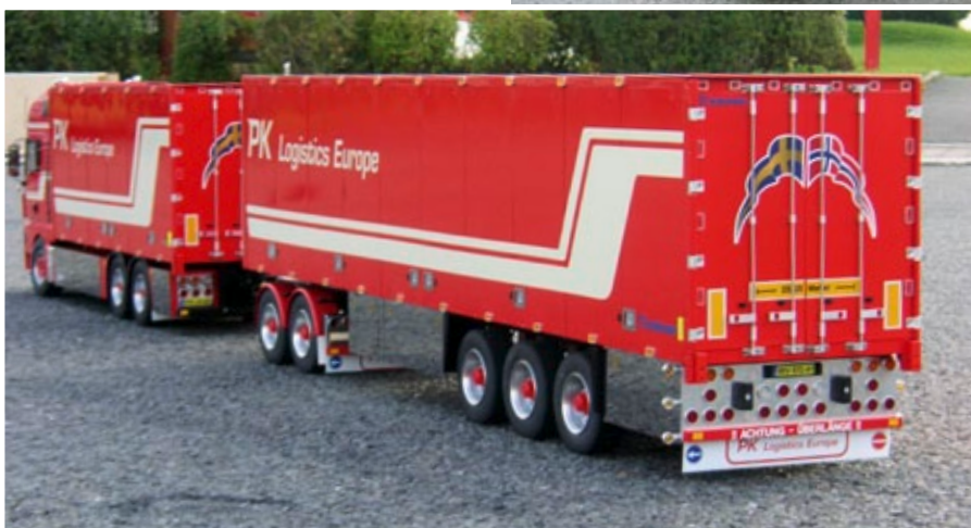
Statt einer für Kratzer anfälligen Lackierung wurde der Gigaliner mit schwarzem und rotem Kunststoff beschichtet
