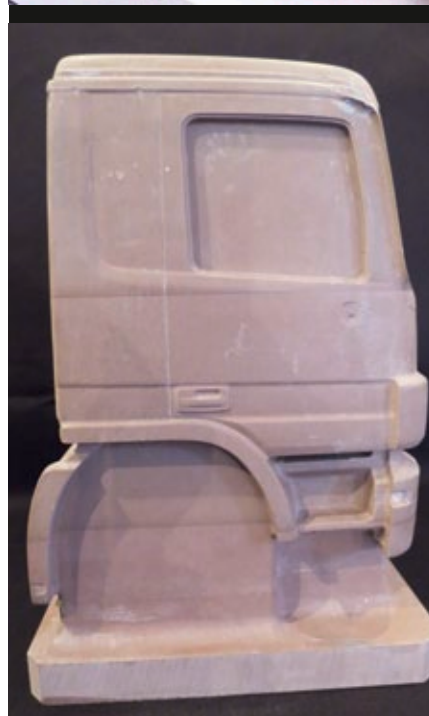
Mittels CNC und CAM wurde aus Kernblockmaterial das Urmodell hergestellt
