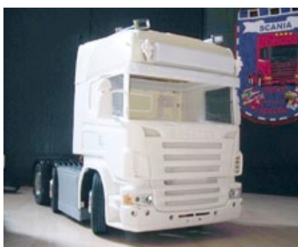
Das fertige Fahrerhaus. Um daraus einen Scania-Longline zu machen, muss es in zwei Hälften gesägt werden
