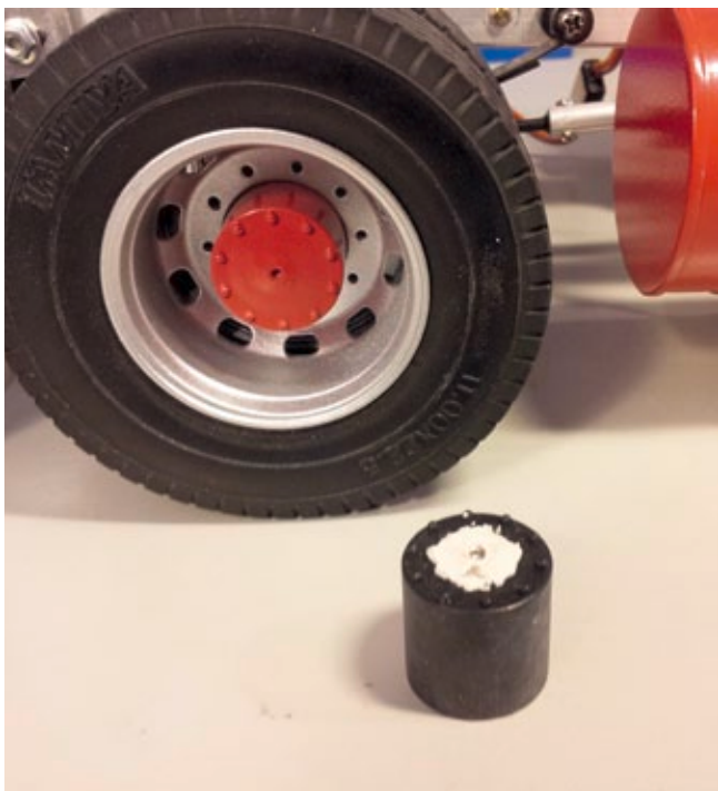
Die Felgen stammen von Seitz Modellbau, die Außenplaneten-Attrappen wurden mit Köpfen kleiner Inbusschrauben aufgewertet
