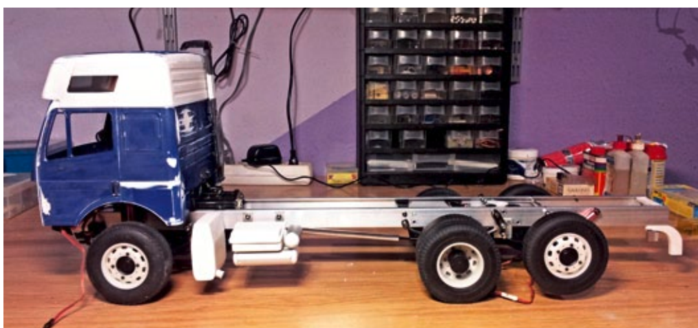
Die Basis für das Modell bildet ein Tamiya 1838 LS, von dem allerdings nur Fahrerhaus, Achsen und die Motor-Getriebekombination verbaut wurden
