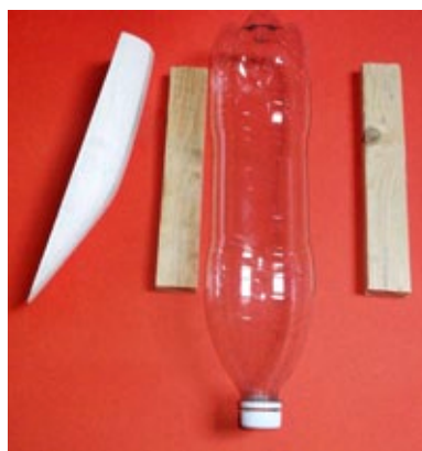
Das benötigte Material: Die Positivform aus Balsaholz, die PET-Flasche und zwei Holzabschnitte zum Fixieren
