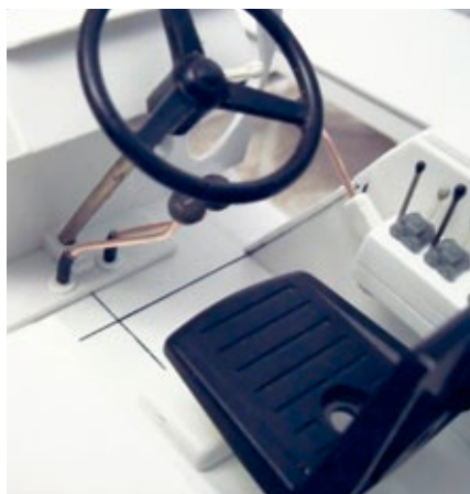
Blick ins Innere des Fahrerhauses. Der Sitz wurde aus Polystyrol angefertigt, die Schaltknüppel aus Messing
