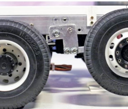
Die hintere Achse dient als Liftachse, die aus einer alten Lenkachse gebaut wurde. Über ein separates Servo kann sie gesteuert werden
