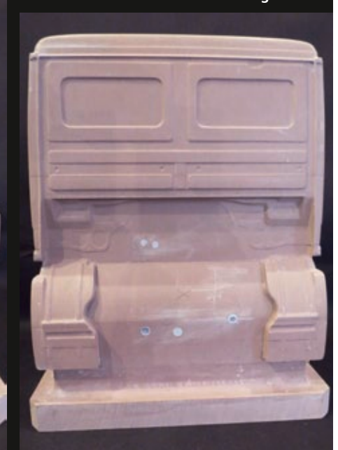
Mittels CNC und CAM wurde aus Kernblockmaterial das Urmodell hergestellt
