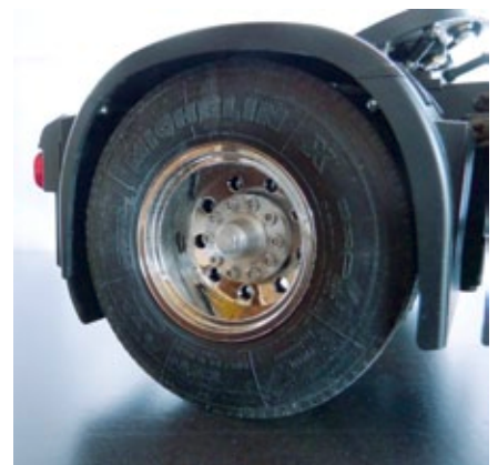
Die Steckachsen entstanden aus Aluminium-Vollmaterial in Eigenbauweise
