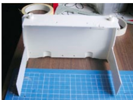
Streben verlängern den abgesägten Rumpf des Fahrerhauses
