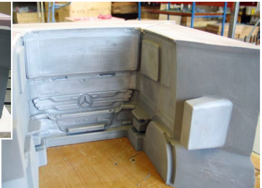
Die Einzelteile der Negativform werden zusammengebaut
