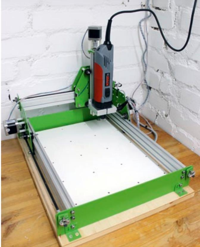
CNC-Fräse eShapeOko mit Kress-Frässpindel
