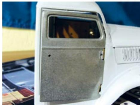
Die Türen lassen sich mit den mitgelieferten Scharnieren nicht passgenau einbauen
