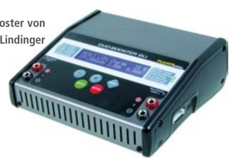
Der Duo-Booster ist ein Ladegerät ohne integriertes Netzteil mit zwei Ausgängen zum Laden von bis zu 8s-LiPos. Die Ladeleistung beträgt maximal 800 Watt. Zwei kräftige Lüfter im Gehäuse sorgen für eine ausreichende Kühlung. Zum Lieferumfang gehören zudem zwei Adapterplatinen für verschiedene Balancerstecker-Typen sowie Krokodilklemmen zum Anschluss an eine 12-Volt-Stromquelle. Die Eingangsspannung beträgt 10,5 bis 28 Volt und der Entladestrom liegt bei maximal 100 Watt. Der Preis: 119,90 Euro
