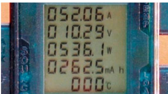
Alles schön auf einem Blick. Das Display ist gut kontrastiert und daher bei allen Lichtverhältnissen lesbar. Mehr Strom als angezeigt, sollte allerdings nicht auf Dauer fließen. Der Temperatursensor ist hier nicht angeschlossen
