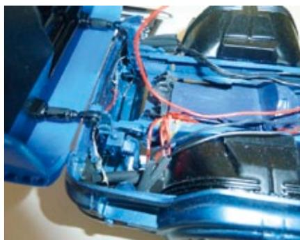
Stromleitungen der Stoßstange vor dem Einbau der Stromverteiler unter dem Fahrerhaus
