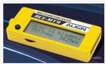
Der align Multi-Function-Tester RCE-MT9 von robbe kann als LiPo-Checker, Servotester und Drehzahlmesser verwendet werden. Alle Werte werden auf einem LC-Display dargestellt und lassen sich über einen Knopf auswählen. Der Tester hat eine 3 Ampere BEC-Ausgangsleistung und integrierten Verpolschutz. Zusätzlich kann das Display die BEC-Spannung und das Ausgangssignal des Empfängers darstellen. Der Preis: 59,90 Euro.
