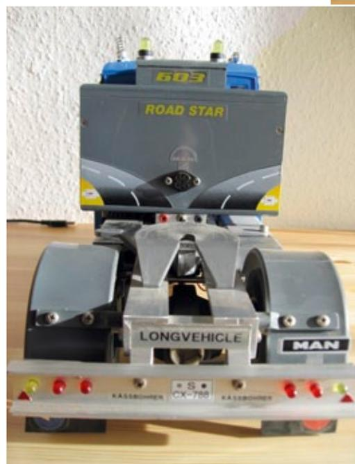
Hintere Stoßstange mit Kotflügelhalter
