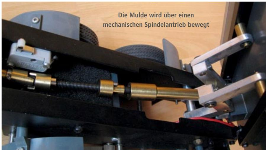
Die Mulde wird über einen mechanischen Spindelantrieb bewegt
