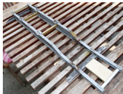
Der fertig verlötete Rahmen ist stabil und wartet auf Farbe
