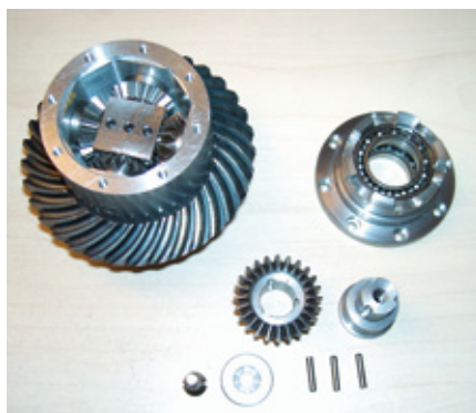
Hier ist das Ausgleichsgetriebe noch zerlegt. Später nimmt es in seinem Inneren die vier Ausgleichsräder auf
