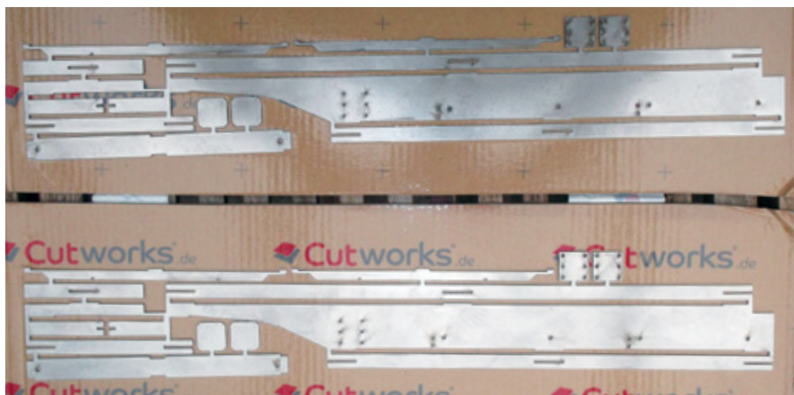
Nachdem alles so gut passte, konnten die gelaserten 1,5-mm-Stahlbleche geordert werden
