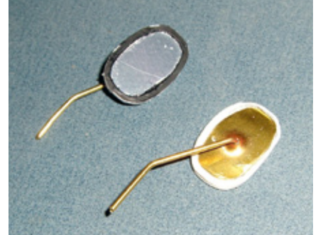
Hier erkennt man es detaillierter: der fünfteilige Außenspiegel in Mischbauweise
