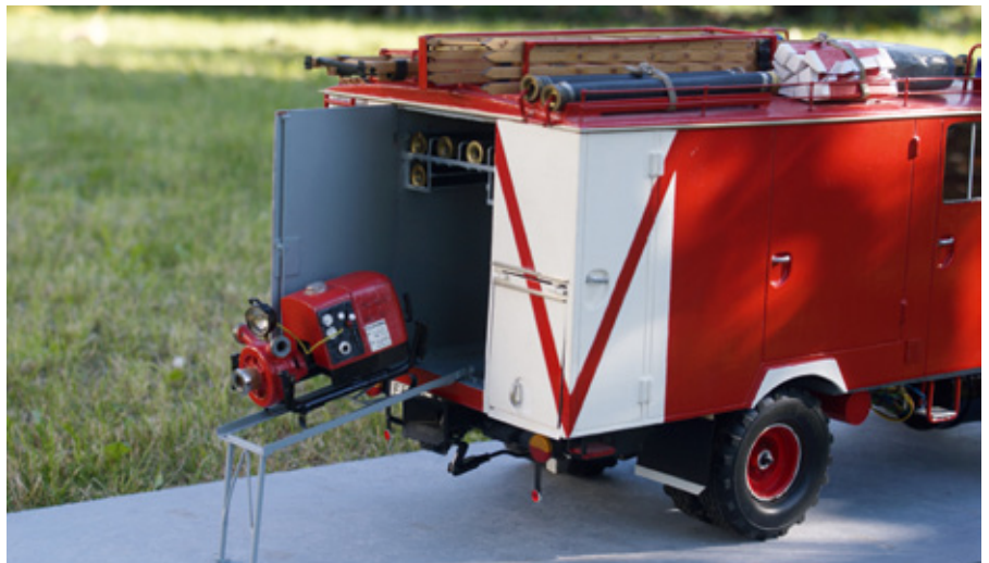
Im Heckgeräteraum wird die Tragkraftspritze untergebracht
