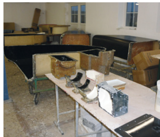
Die Urmodellformen warten darauf, mit GFK gefüllt zu werden
