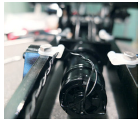
Durch diese mitgelieferten Führungen werden die Zuleitungen zum Motor und zur Beleuchtung geführt
