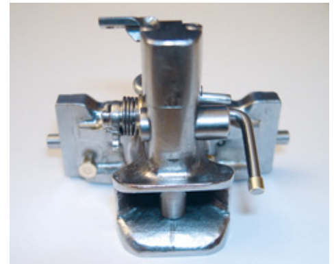
Die Anhängerkupplung gehört zu den verschiedenen Anbauteilen und ist verschiebbar
