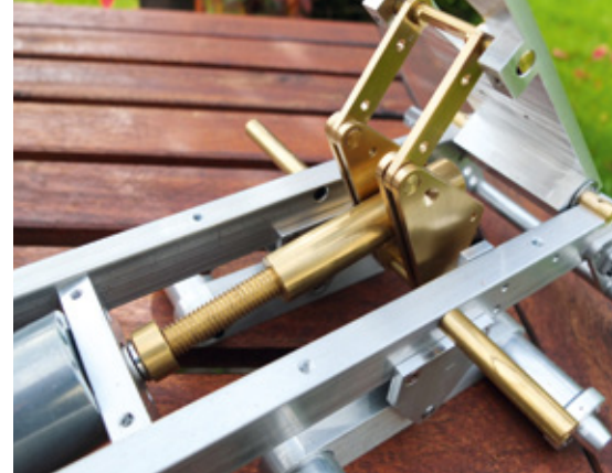
Der Kippantrieb arbeitet kraftvoll und auch bei größerer Beanspruchung laufruhig
