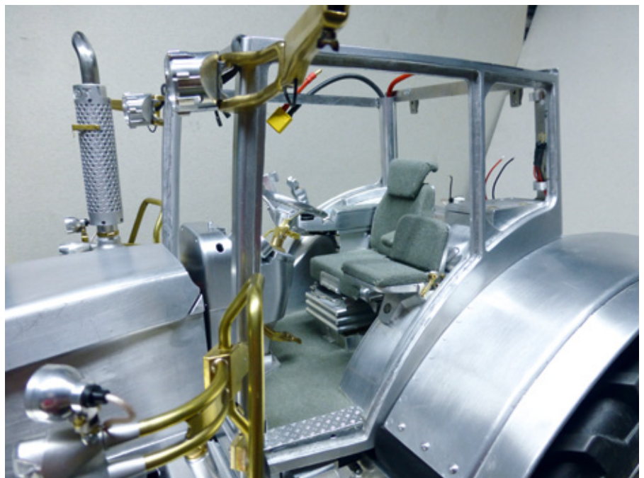
Einfach Platz nehmen und losfahren: Rückenlehne, linke Armlehne sowie Kopf- und Rückenstütze sind verstellbar. Hinten ist die Auspuffanlage gut zu erkennen
