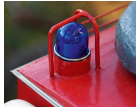
Das Blaulicht erhielt einen Ring aus Lötzinn. Die Regenrinne ist aus Neusilber-Schienenprofilen einer H0-Modellbahn
