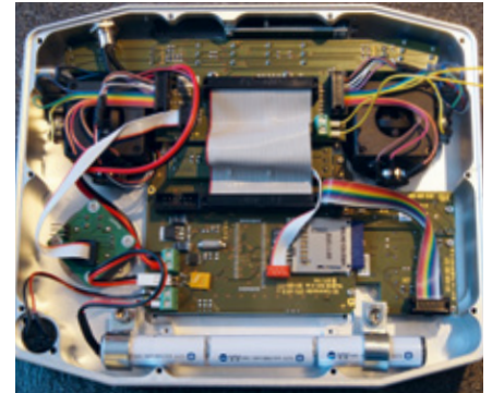
Der Blick ins Innere darf nicht fehlen; sowohl die Metaller als auch die Elektroniker haben sauber gearbeitet
