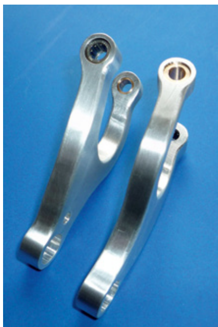
Die Schwingarme sind an der Getriebeseite in Nadellagern und BZ-Buchsen gelagert
