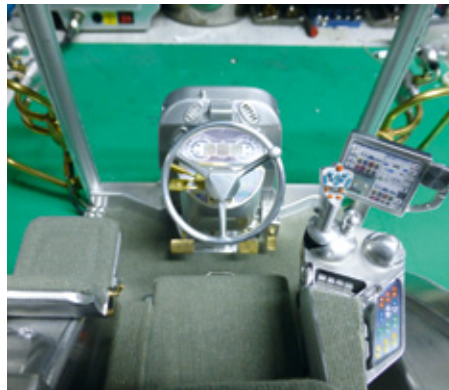
Der Arbeitsbereich des Fahrers ist vorbildgetreu nachgebildet. So findet sich rechts das beleuchtete Terminal, das aus einem verkleinerten Foto des Original-Bildschirms entstand
