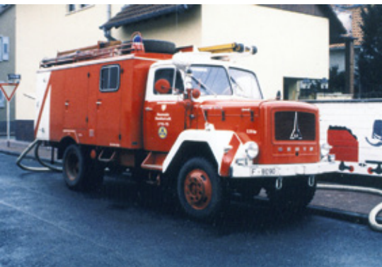
Das Vorbild war das Löschgruppenfahrzeug LF16-TS auf einem Magirus Eckhauberfahrzeugstell Mercur 125A
