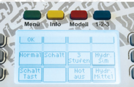
Je nach Menü ändern die Tasten ihre Funktion, was über den Bildschirm angezeigt wird; Hier das Gebermenü zur Einstellung der Funktion der Taster oder Kreuzknüppel
