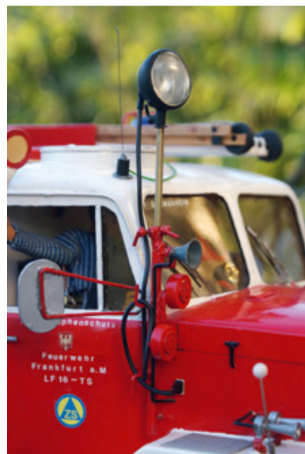
Auf dem Fahrgestell ist der ausfahrbare Arbeitsscheinwerfer montiert
