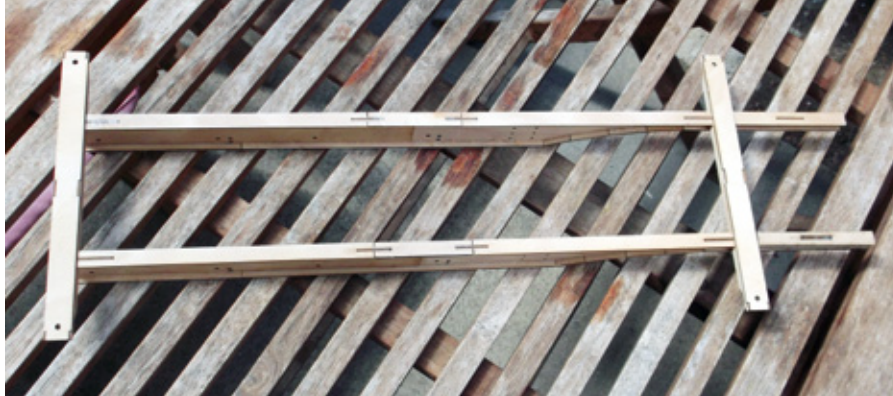
Das Chassis wird als Muster zusammengesetzt und verleimt
