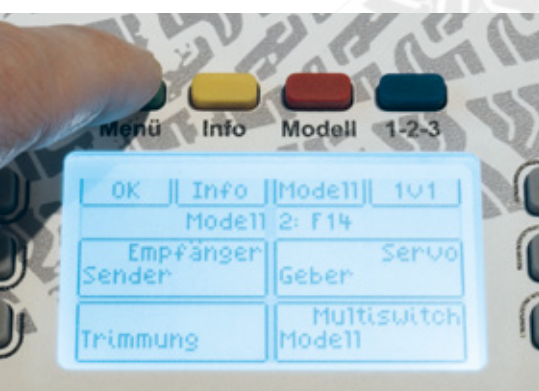
Die vier farbig gekennzeichneten Tasten stehen für Menüzugriffe zur Verfügung
