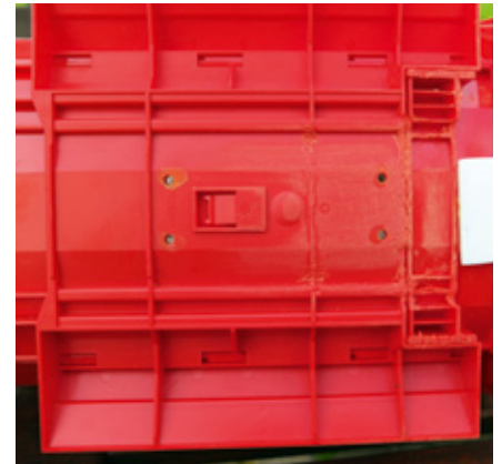
Fertig vorbereitete Kipperwanne: vier vorgebohrte Löcher und ein ebener Boden
