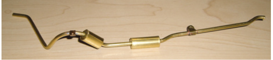
Das Auspuffrohr besteht aus einem Stück mit Töpfen und Schellen. Es ist fertig zur Montage
