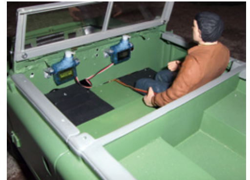
Die Ansteuerung der Lüftungsklappen erfolgt jeweils direkt über Schubstangen
