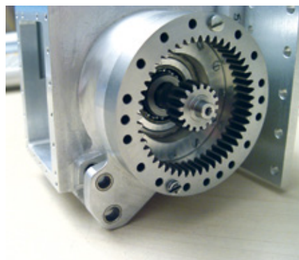
Das angesetzte Hohlrad mit der Steckachse der rechten Seite. Die Schrauben dienen nur der Fixierung für den Probeanbau
