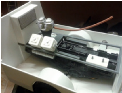
Das Innenleben des Anhängers nimmt langsam Gestalt an. Die Zylinderköpfe bestehen aus einzelnen Polystyrol-Plättchen
