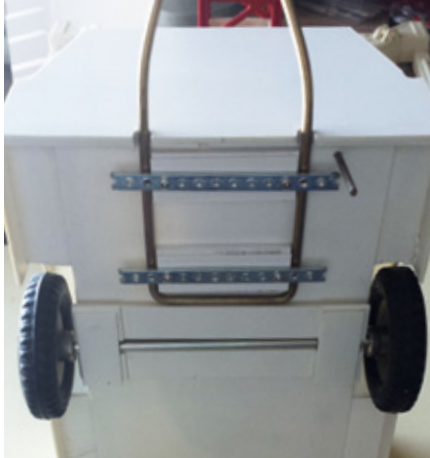
Ansicht von unten: Die Zugdeichsel wurde aus Messingdraht gelötet
