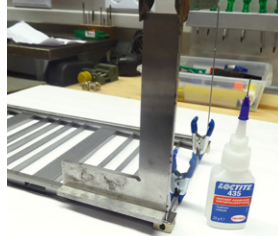
Mit einem Winkel wird der Frontrahmen ausgerichtet
