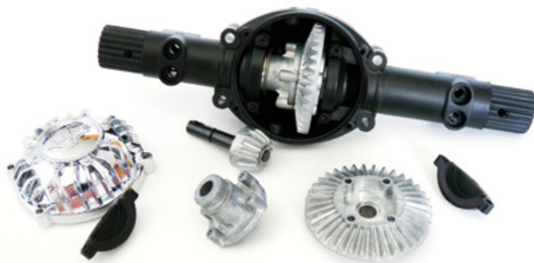
Damit der Truck auch lange einsatzfähig bleibt, ist der Antriebsstrang mit präzise gefertigten Alugussteilen ausgestattet
