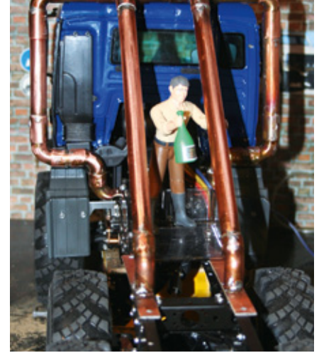
Der Überrollkäfig wurde aus Rohrstücken aus dem Baumarkt gelötet
