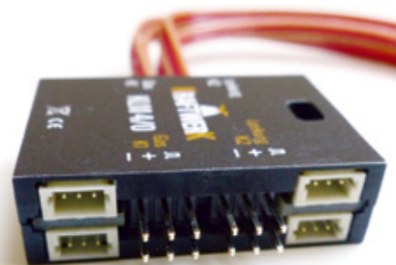
Der Lichtassistent von Kraftwerk: An den weißen Steckverbindungen werden die einzelnen Lichtmodule angeschlossen
