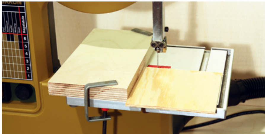
Lässt sich der rechts auf dem Arbeitstisch einzuführende Winkelanschlag nicht nutzen, reichen bereits ein Anschlagbrett und zwei Zwingen, um eine linksliegende Führung zu erstellen. Die exakt winklige Ausrichtung erfolgt zuvor mit einem Geodreieck
