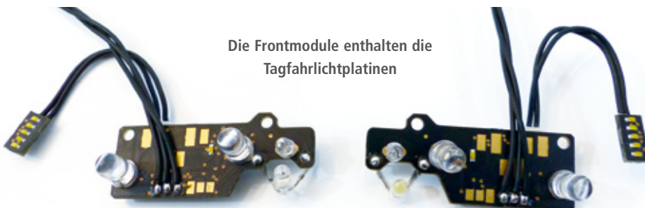
Der Lichtassistent von Kraftwerk: An den weißen Steckverbindungen werden die einzelnen Lichtmodule angeschlossen
