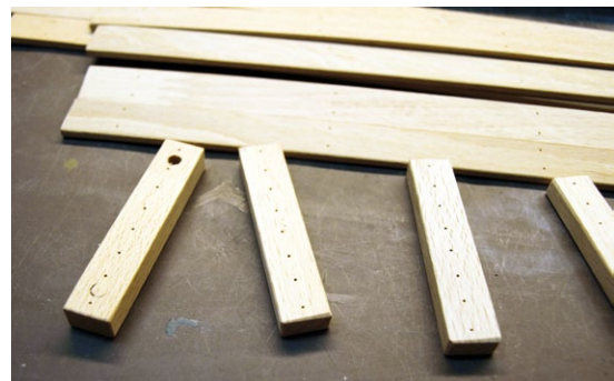
In den Klötzen sind die Bohrungen zu sehen. Die großen Bohrungen im linken Klotz sind für Magnete vorgesehen, mit denen der Holzboden im Rahmen gehalten wird
