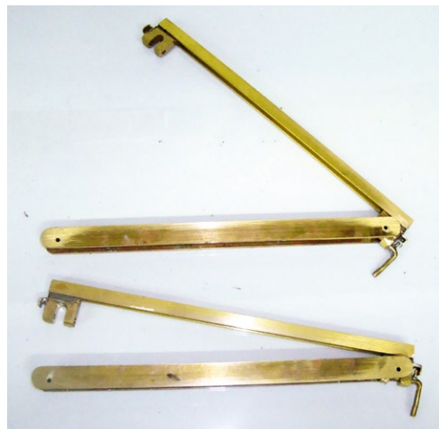
Die Kipperbrücke besteht aus Messing-Profilen, die auf Länge gebracht und verlötet wurden
