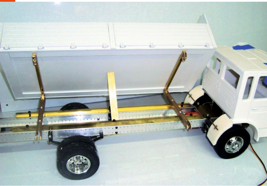
Hier ist die Pritsche bereits beweglich montiert. Die elektrische Ansteuerung fehlt jedoch noch
