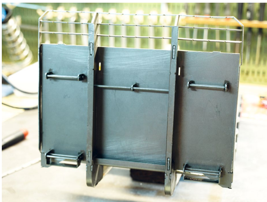
Die Rundstangen sind eingebaut. Es folgen der Gitterrahmen und der Haken
