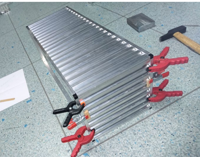
Die Profile, aus denen die Containerwände bestehen, sind 167 Millimeter hoch
