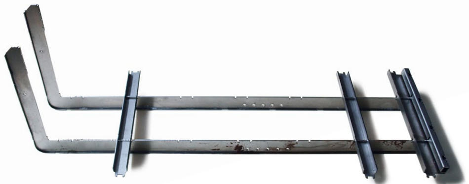
Die Untergurte sind verklebt und die ersten Querträger aufgesteckt
