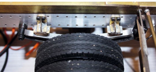
Die Blattfedern an den Hinterachsen sind dem Original genau nachempfunden
