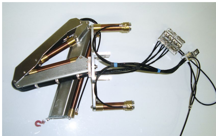
Der Kran wurde zugekauft. Da er normalerweise aber nicht als Heckkran gedacht ist, waren einige Umbauarbeiten vonnöten
