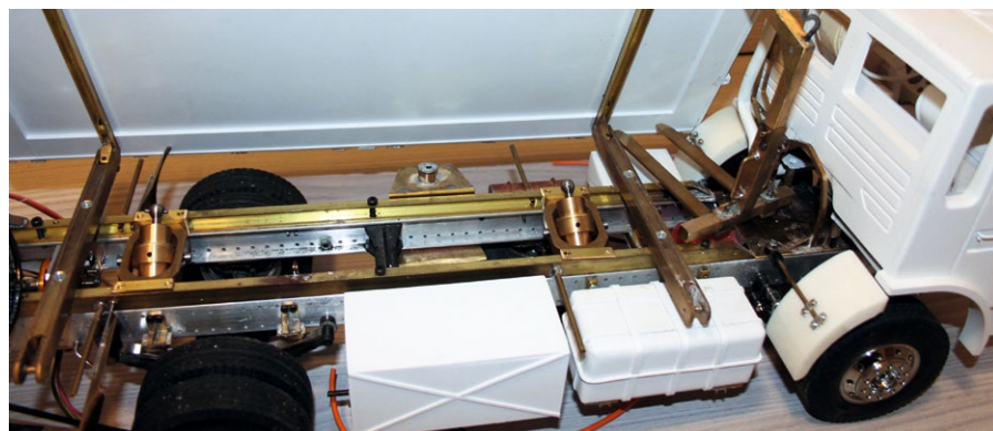
Die Technik ist in den Kästen am Rahmen gut versteckt. U-Profile bilden die Basis für den Aufbau der Pritsche
