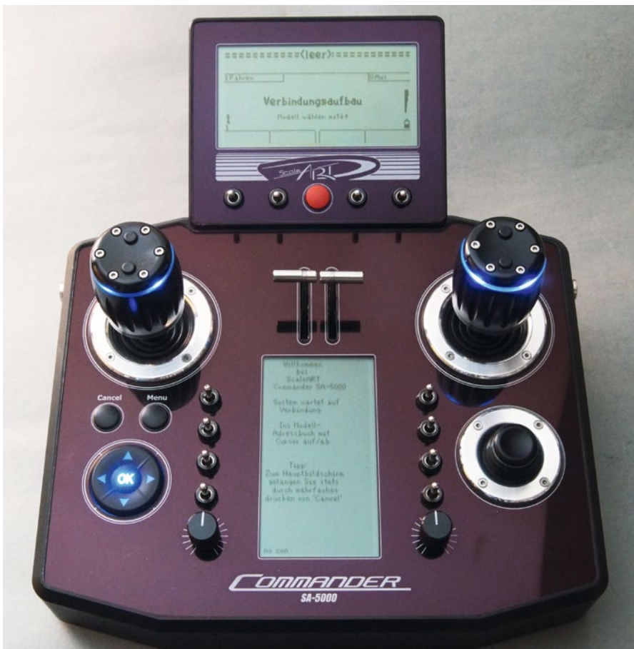
Wem ist es aufgefallen? Die beiden Taster auf den 4D-Knüppeln sind gegenüber unserer ersten Testversion um 90 Grad gedreht; erst dadurch war die Idee gekommen, diese am Gasknüppel mit der Gangschaltung auf/ab zu belegen
