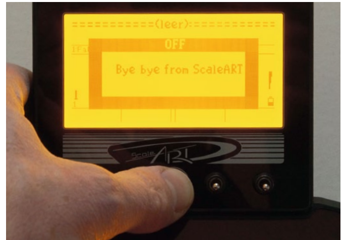
Langes Drücken auf den roten Knopf schaltet den Commander aus, der sich auch noch höflich verabschiedet
