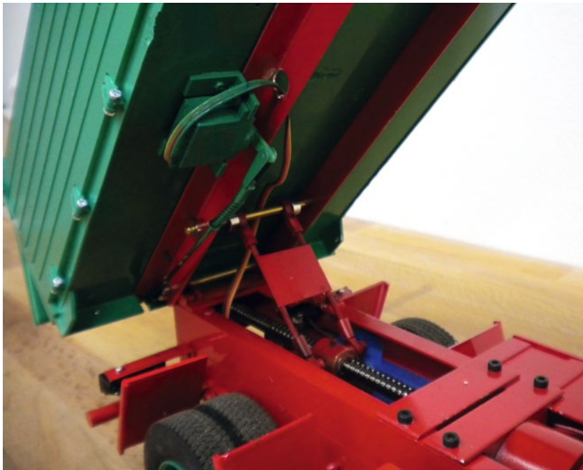
Simple, aber effektives System: Kraftübertragung via Spindelantrieb
