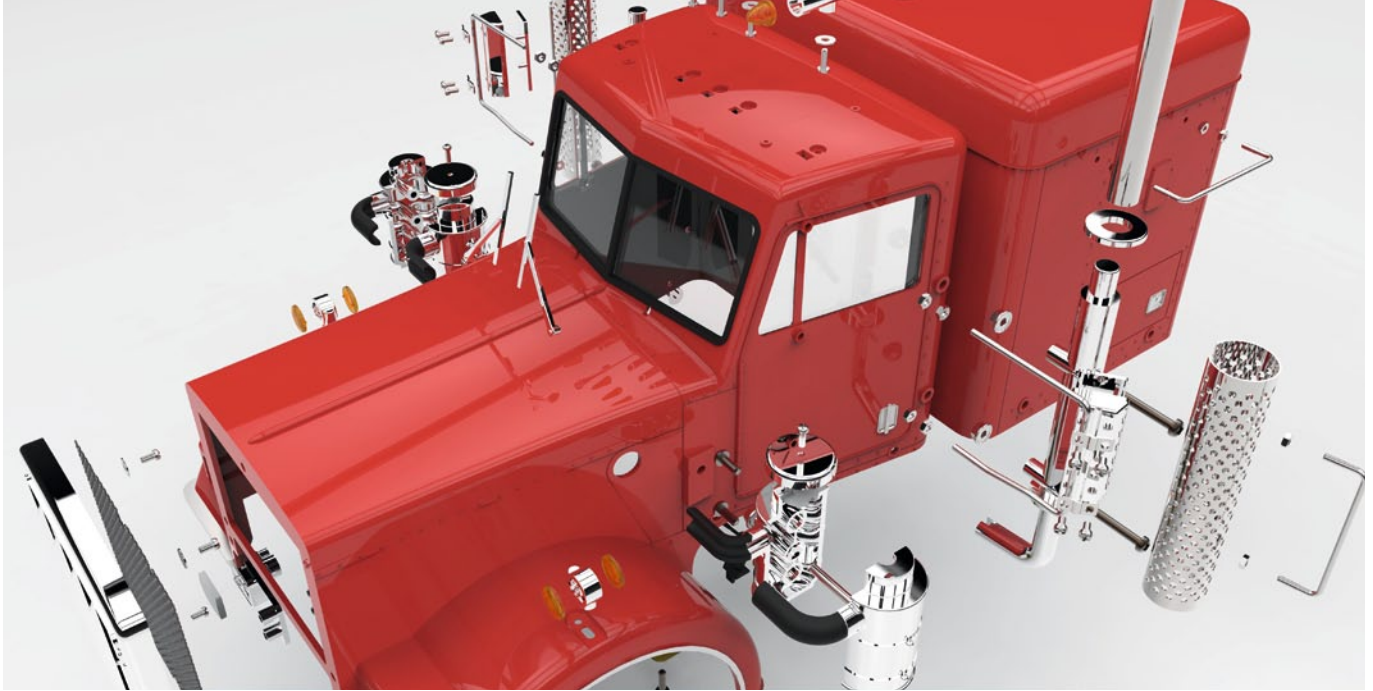
Eine gerenderte Darstellung des Fahrerhauses und seinen Einzelteilen in einer Art Explosionsansicht, diese stammt direkt aus Key Shot, welches ein Zusatzprogramm für Solidworks darstellt
