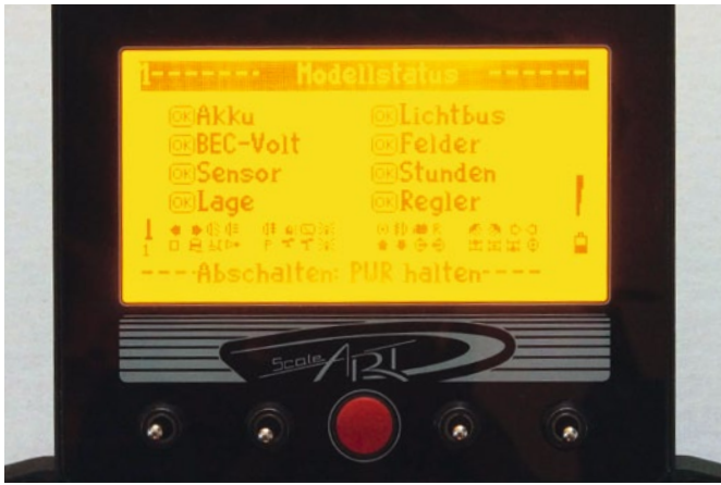
Durch kurzes Drücken des roten Knopfes unter dem oberen Display bei eingeschaltetem Sender lässt man sich den Modellstatus anzeigen; solange überall „OK“ steht, ist alles in Ordnung
