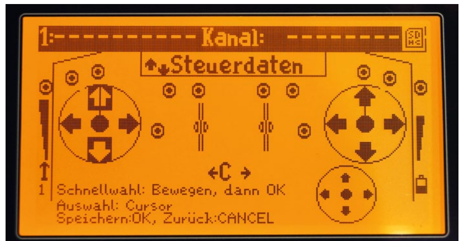
Die Ansicht der Steuerdaten hilft, bei der Kanaluordnung die Übersicht zu wahren: einfach den gewünschten Geber betätigen und mit „OK“ bestätigen
