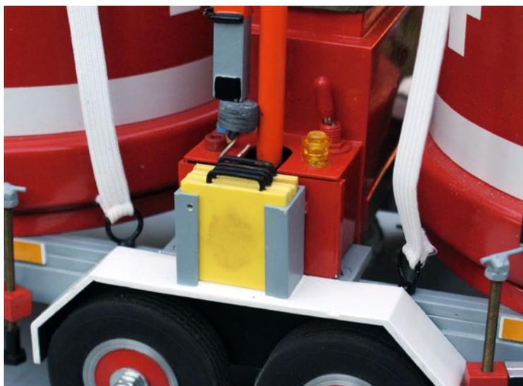
Um die Ladung auf dem Anhänger zu befestigen, kamen Zurrgurte aus Gummibändern mit Lastösen am Fahrgestell zum Einsatz. So kann die Ladung einfach ausgehängt werden
