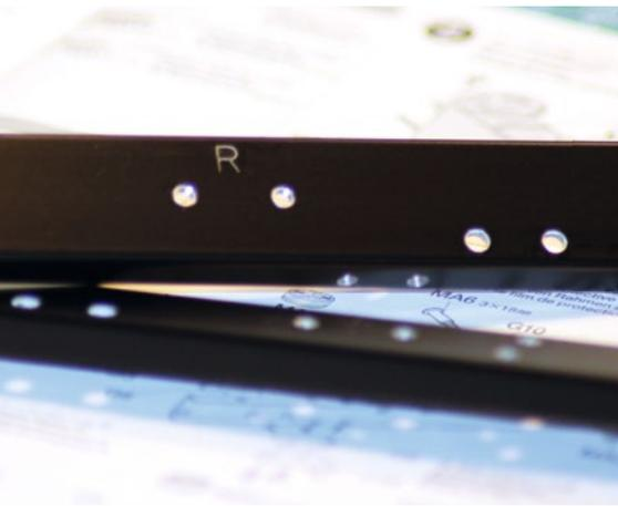
Die beiden U-Profile sind mit Buchstaben markiert, um die Positionierung auf der in Fahrtrichtung rechten oder linken Seite zu klären
