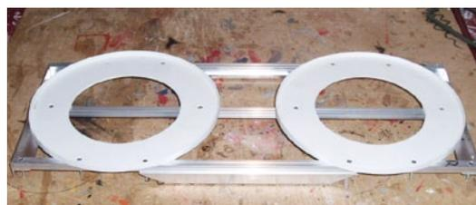
Aus Aluminium-Vierkant-Rohr und zwei passenden Winkelprofilen besteht der Anhängerrahmen für einen zweiachsigen Tandemanhänger. Auf den beiden runden Plattformen werden die Löschwasser-Behälter abgestellt
