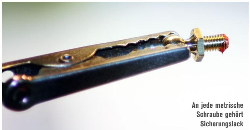
An jede metrische Schraube gehört Sicherungslack
