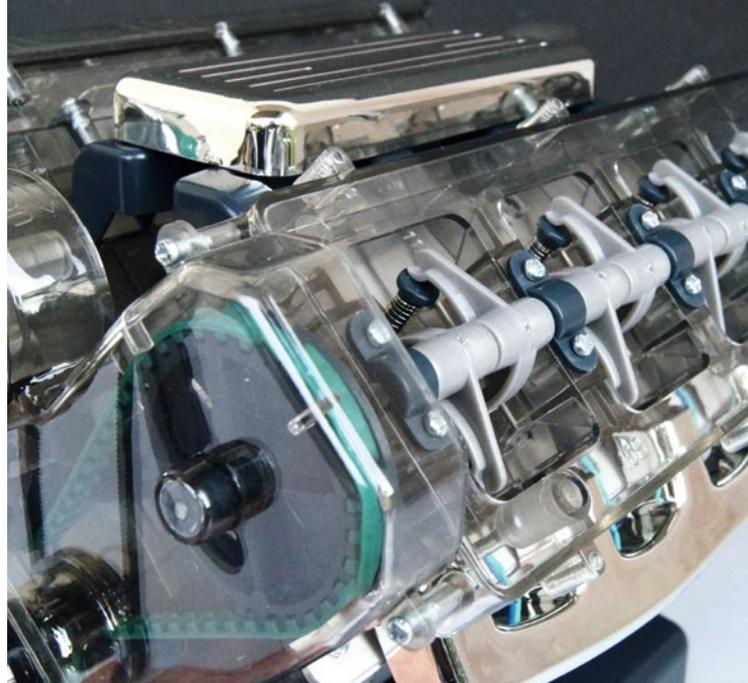
Über den Riemen wird die Nockenwelle angetrieben, die wiederum über die Kipphebel die Ventile öffnet oder zum Schließen freigibt
