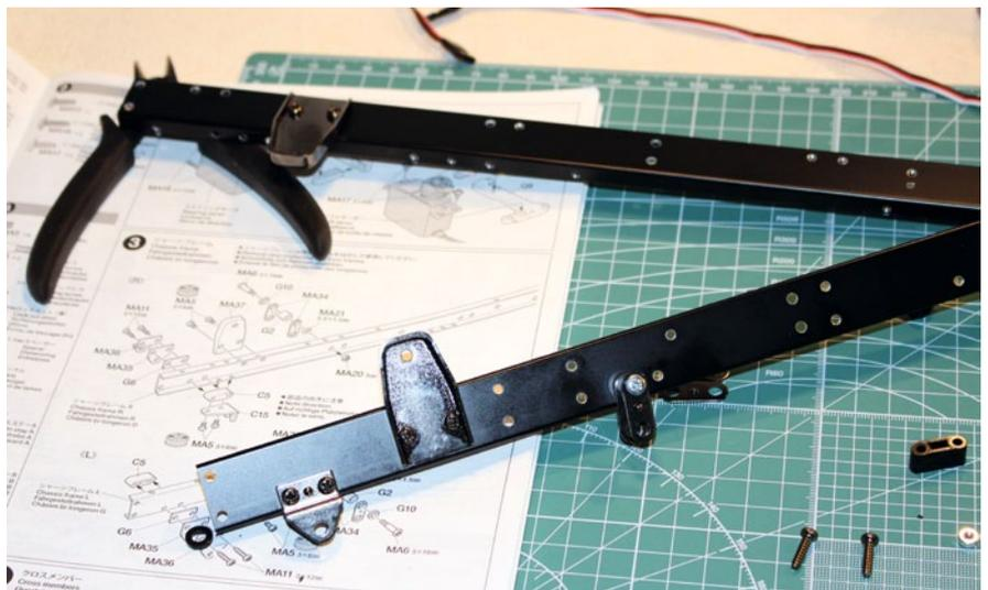
teilweise auch über ein Gewinde verfügen. Um Verwechslungen zu vermeiden, ist ein „R“ beziehungsweise ein „L“ eingraviert, was die Position in Fahrtrichtung definiert. Quertraversen aus Kunststoff halten die Profile im passenden Abstand. Die U-Profile sind für den Transport mit Folie versiegelt. Diese gilt es zu entfernen. Sind alle Traversen montiert und man stellt den Rahmen senkrecht, ähnelt das Konstrukt einer Leiter. Daher der Name.
