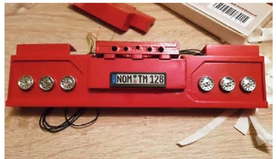
Fingerspitzengefühl war gefragt beim Bau der Stoßstange, da diese erst verklebt, zusammengebaut und die Spalte verspachtelt werden musste
