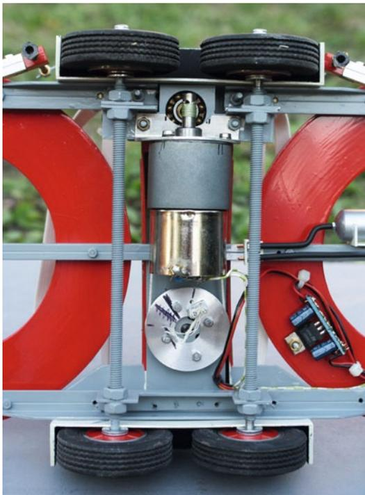
Unter den Kugellagern wurde ein RB 35-Getriebemotor mit einer kleinen Trommel für das Hubseil angebracht
