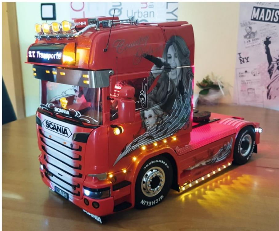
Ein Dachlampenbügel mit eckigen Scheinwerfern sorgt für die Beleuchtung. Gelbe LED wurden als Fahrlicht eingesetzt und weiße, extra helle SMD-Elemente als Fernlicht
