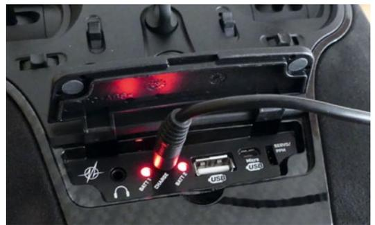
Unter der Klappe befinden sich alle Zu- und Abgänge für die externe Peripherie. Von links: 3,5-Millimeter-Klinkenbuchse für Kopfhörer, 12-Volt-Ladekabel-Anschluss mit zwei Kontroll-LED, USB-Buchse, Micro-USB und daneben ein PPM-Servoanschluss
