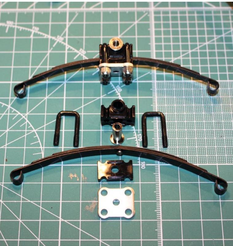
Die Blattfedern für hinten, montiert und in Einzelteilen
