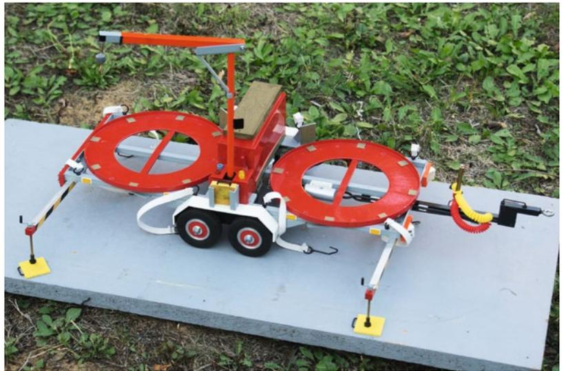
Aus einem 6 x 6-Messing-Vierkant-Rohr, in das mehrere kleine Führungsrollen für das Hubseil eingebaut wurden, besteht der Ausleger
