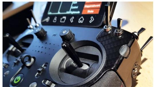
Serienmäßig ist der CORE mit 20 Gebern ausgestattet. Die vier Drehgeber rasten in der Mittelstellung deutliche ein. Dadurch kann der halbe Stellweg blind angefahren werden. Auf Wunsch sind zusätzlich dreistufige Knüppelschalter lieferbar
