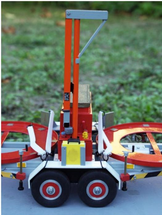
Der Ladekran ist eine senkrecht stehende, drehbare Säule mit einem klappbaren Ausleger
