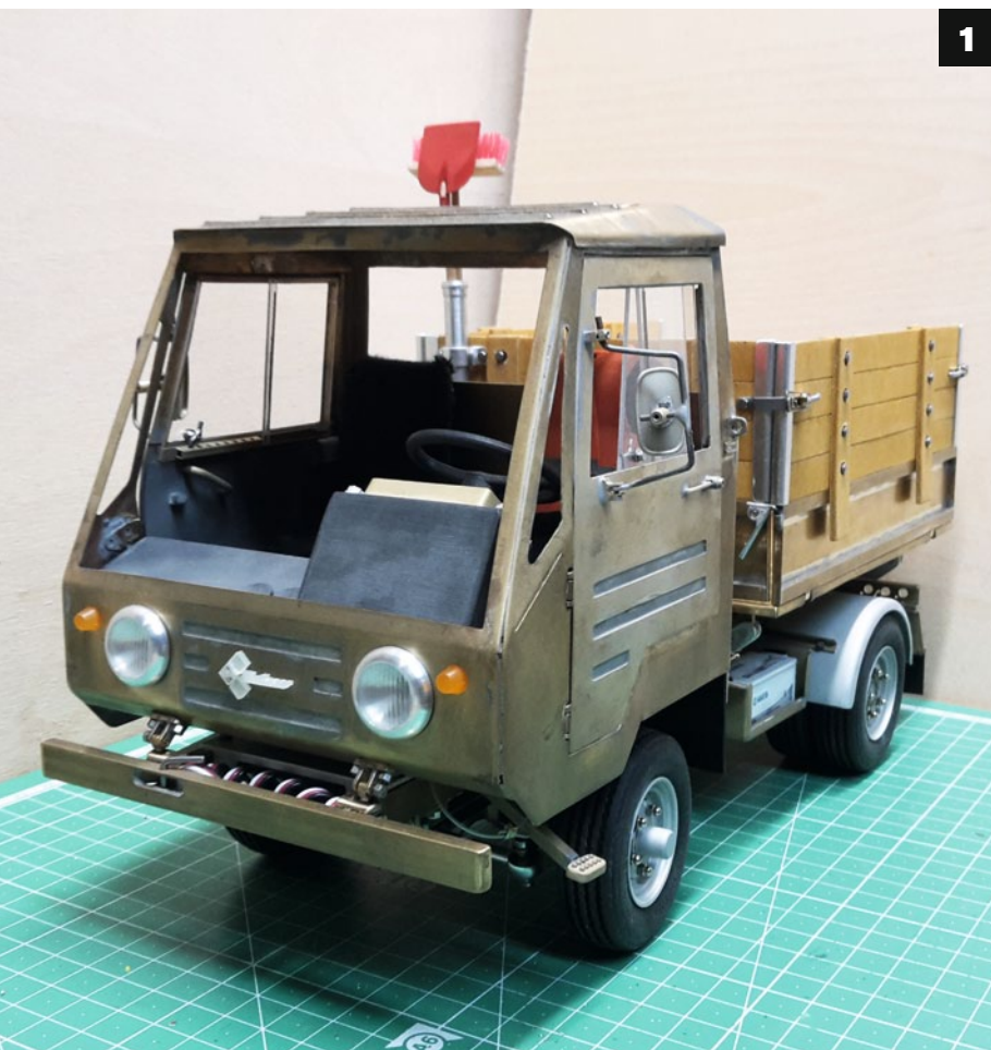
1) Der fertige Rohbau des Multicar. 2) Türverkleidungen, Sitze und das Armaturenbrett wurden nach Vorbildern aus dem Internet gefertigt. 3) Für einen authentischen Eindruck durften gelaserte Schmutzklappen aus 1-Millimeter-starker Gummimatte nicht fehlen
