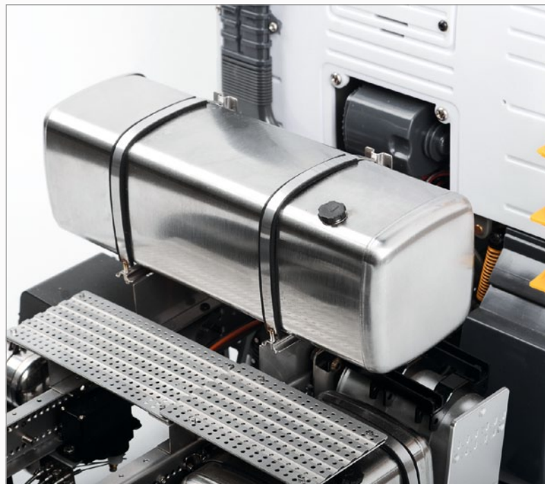
Elegante Lösung: Der Akku ist in dem grau-silbernen Kasten direkt hinter dem Fahrerhaus untergebracht und nicht zu sehen
