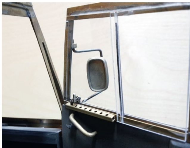
Die Seitentür der Beifahrerseite erhielt bewegliche Schiebefenster
