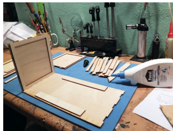
Die vorsortierten und vorgefertigten Bauteile lassen sich sehr gut mit Holzleim verkleben
