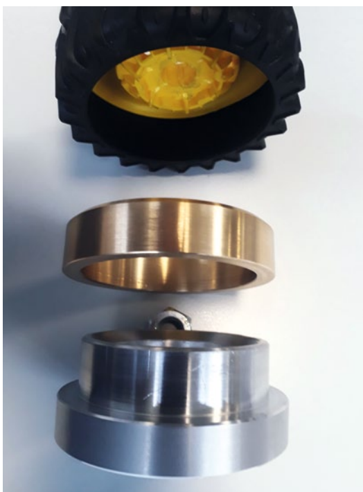
Zur Stabilisierung erhielten die Vorder- und Hinterreifen Aluringe vorne, zur Erhöhung des Gewichts Messingringe
