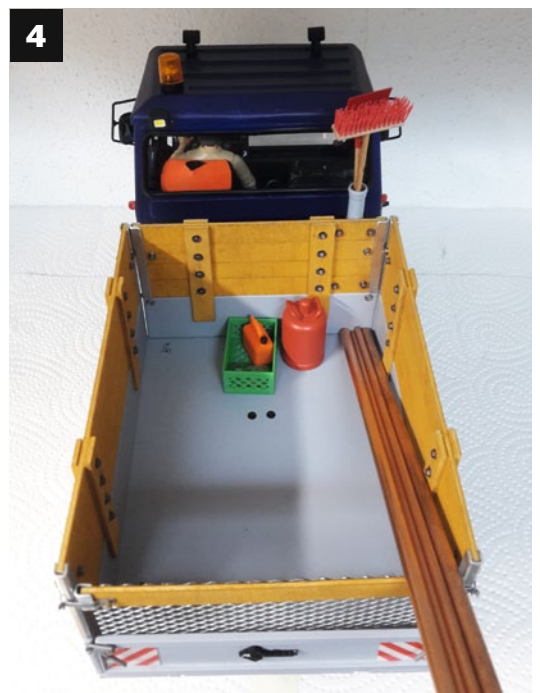
1) Filigrane Beschläge und das typische Hochtemperatur-Rohr, bestückt mit Besen und Schaufel. 2) Die Pritsche des Multicar wurde mit einer Kippmechanik versehen, die Bordwände bestehen aus Sperrholz. 3) Das Multicar-Logo ist im 3D-Drucker entstanden. 4) Die Ladefläche des fertigen Fahrzeugs bietet reichlich Platz zum Transport, für Material und Werkzeug
