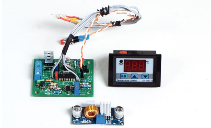
Weitere Bauteile für den Eigenbau sind ein Tiefentladeschutz (aus einem Bausatz), ein Temperaturregler sowie ein Step-Down-Modul
