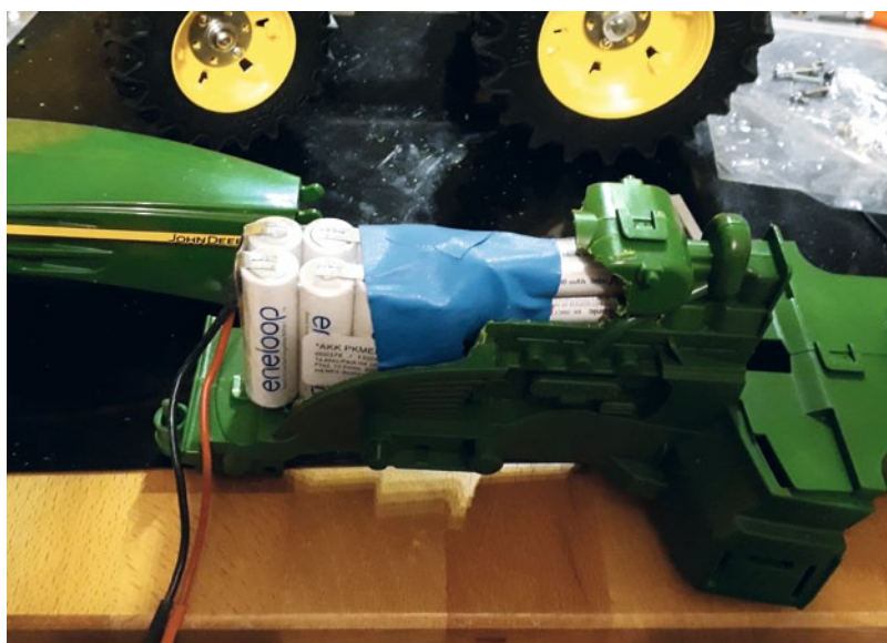
Der 12-Volt-Akku wurde neu verbunden, um unter die Motorhaube zu passen
