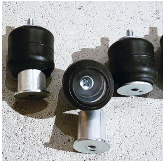
Die Luftfederbälgen sind eine Eigenkonstruktion. Hier fehlen noch die Spiralfedern
