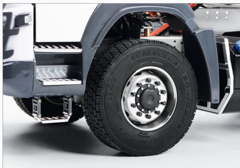
Die Scale-Felgen bestehen aus Alu
