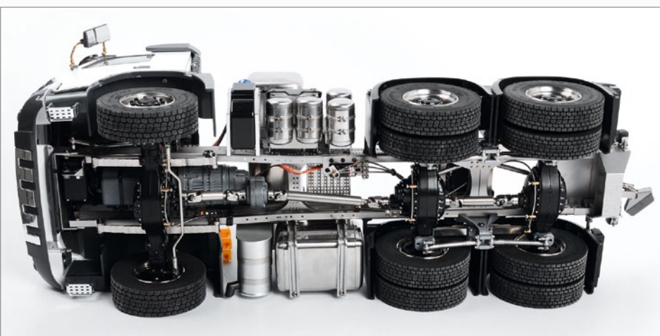
Von unten gut zu erkennen ist die Antriebswelle aus Stahl
