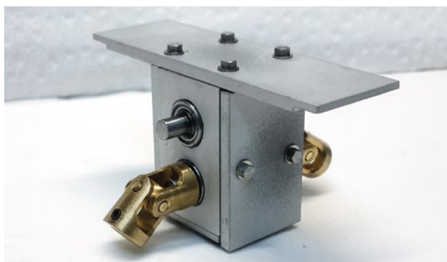
Auch das Verteilergetriebe entstand im Eigenbau
