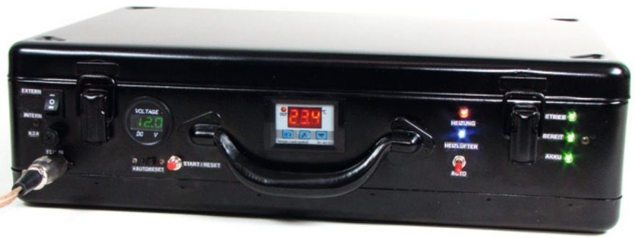
Große Ausführung des Koffers mit Temperaturregler und Spannungsüberwachung
