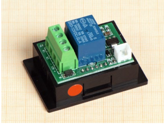
Die Basis für die Heizkofferregelung bildet der Temperaturregler XH-W1321 mit einem Relais für einen Schaltstrom von 10 Ampere
