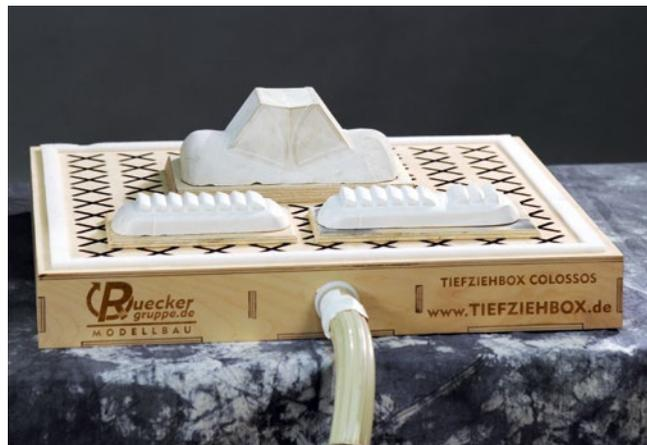
Hier liegen die Ur-Formen, die tiefgezogen werden sollen, mit etwas Auflage auf dem Vakuum-Kasten
