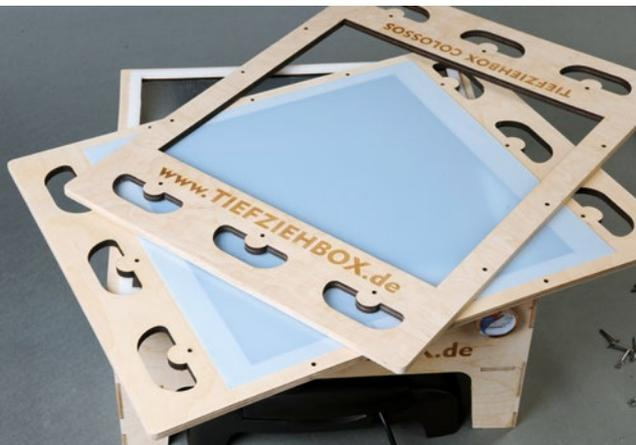
Tiefziehplatten aus verschiedenen Materialien lassen sich im Spannrahmen einspannen
