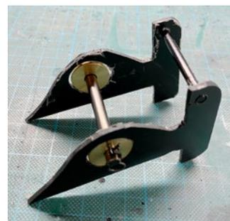
Um das Abklappen der Brille hydraulisch umsetzen zu können, wurde ein neues Bauteil konzipiert und hergestellt
