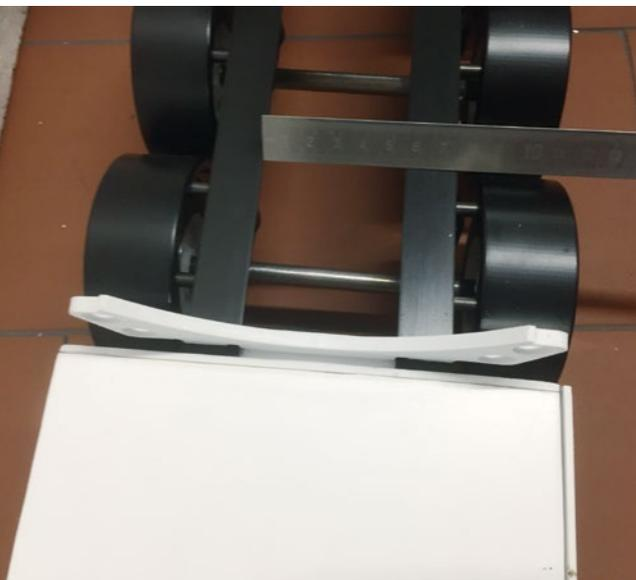
Das 160-mm-Rohr, das später den Tank darstellte, diente als Schablone für die halbrunde Aufnahme
