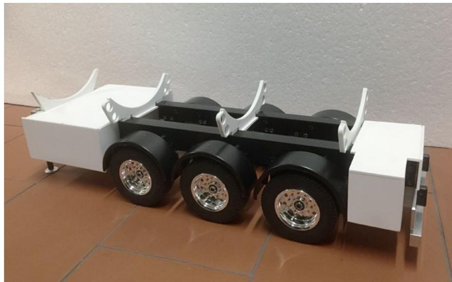
Die Halter wurden dann so an das Fahrwerk angefügt, dass der Tank waagrecht auf dem Fahrwerksrahmen aufliegen konnte
