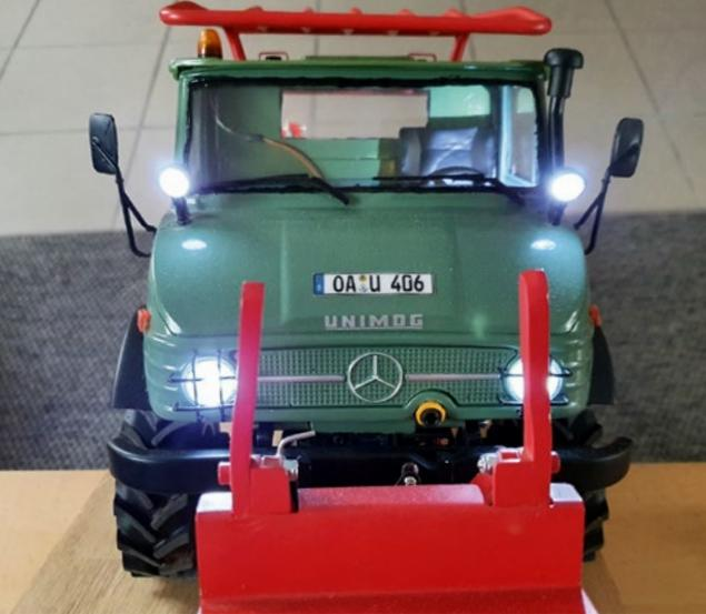
Die Fenstergummis sind mit schwarzer Window Color mit einem Holzfleischspieß nachgeformt. Die Arbeitsscheinwerfer oberhalb der Motorhaube sind dem Original nachempfunden
