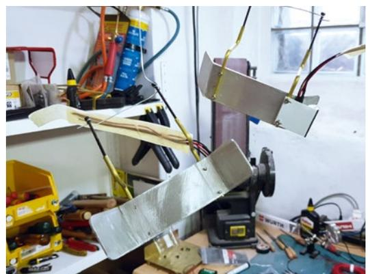
Lackieren der hinteren Schutzbleche, die aus 2-Millimeter-Alublech gekantet und anschließend mit gebogenen 3-Millimeter-Messingröhrchen am Rahmen befestigt wurden
