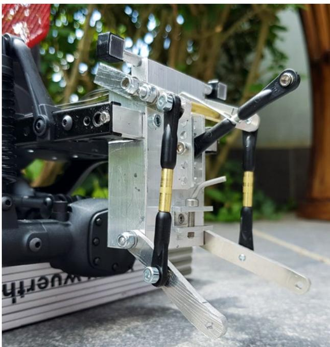
Bau des Heckkrafthebers
