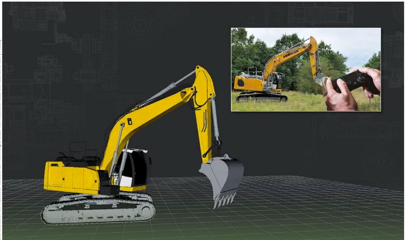
Am virtuellen Zwilling des Roboter-Baggers kann ein autonomes System jede Aktion vor der realen Ausführung mit dem Bagger bis ins Detail planen, berechnen und in der Simulation überprüfen
