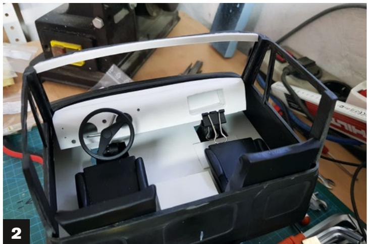
1) Zusammenbau des Hardtops für das Fahrerhaus. Den Unimog 406 gibt es mit vielen verschiedenen Fahrerhaus-Ausführungen, André Nevian entschied sich für diese Variante. Bei dem Fahrzeugtyp kann man das obere Teil des Dachs abnehmen. 2) Bau der Innenausstattung. Das Armaturenbrett ist dem Original nachempfunden, gefertigt aus ABS-Platten. An der Lenksäule ist das Lenkrad verbaut
