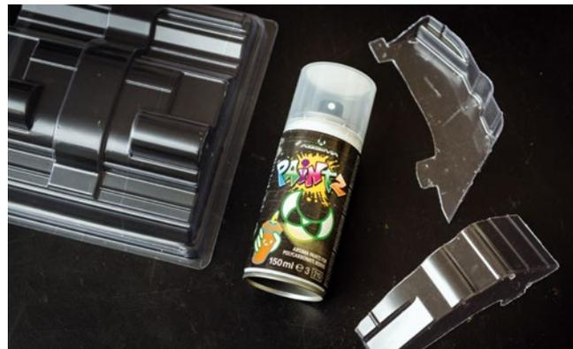
Das Innenkotflügel-Set besteht aus tiefgezogenem Lexan. Die Teile müssen zunächst ausgeschnitten und dann mit spezieller Farbe lackiert werden. Auf der Außenseite befindet sich noch eine dünne Schicht aus Schutzfolie, die Lacknebel abhalten soll
