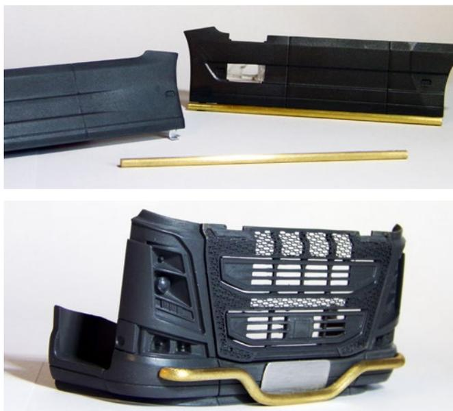
Aus Messing wurden das Rundprofil sowie die Frontbügel für die Stoßstange angefertigt
