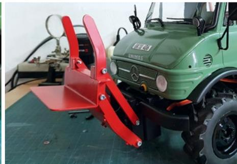
Bau des Frontheber-Polderschilds und das fertige Anbaugerät. Mit dem Polderschild lässt sich Holz sowohl aufheben als auch transportieren
