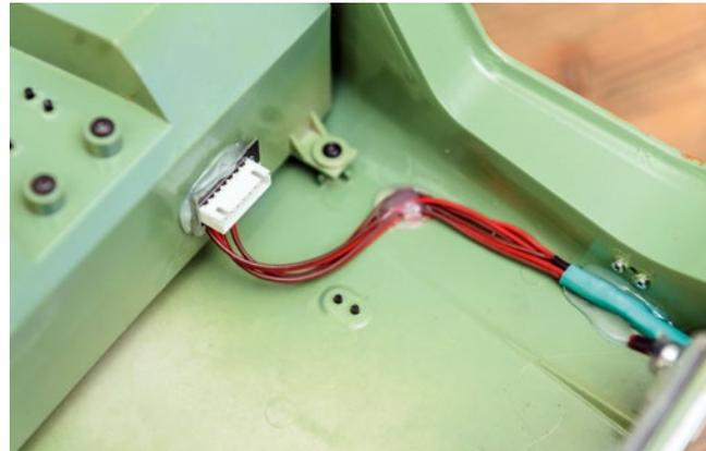
Unter der Motorhaube sind die Kabel für die Scheinwerfer und die Blinker vorne zusammengeführt und mit einer Balancer-Buchse verbunden
