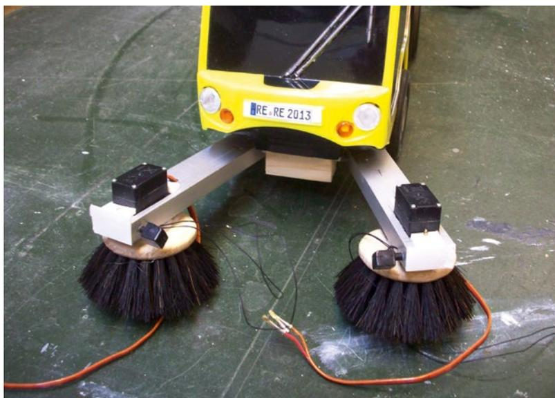
Statt Pilze putzen die neuen Kehrbesen zukünftig die Straßen. Die Besen werden per Servo und mithilfe einer Angelschnur mit Stahleinlage gehoben und gesenkt
