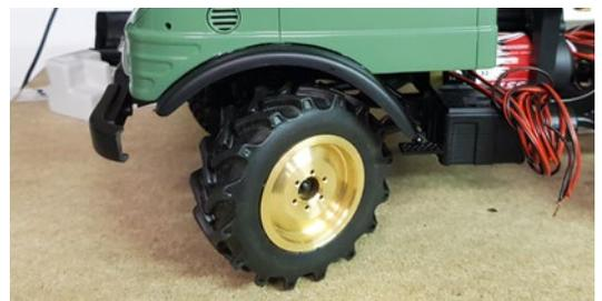
Auf Traktorreifen mit einem Durchmesser von 92 Millimeter und 34 Millimeter Breite steht das Modell. Die passenden Felgen bestehen aus Messing
