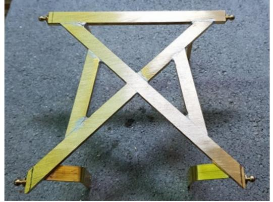
Die Ladefläche ist steckbar ausgeführt, um flexibel zu bleiben. An den Fahrzeugrahmen kam der typische Kreuzrahmen, bestehend aus einem Messing-Flachprofil
