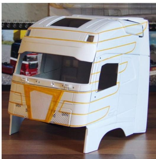
Rot-Töne dadurch unterschiedlich werden würden. Um dies zu vermeiden, wurden die anderen Teile wie das Chassis und die Spiegel in Weiß vorlackiert. Jetzt hieß es Mut zusammen nehmen und die abgeklebten Sachen in sattem Rot lackieren. Nach mehreren dünnen Rotschichten und reichlicher Trocknungszeit wurden alle Bauteile vom Klebeband befreit.
