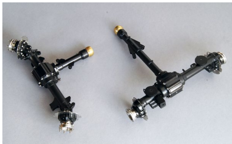
Die beiden Portalachsen mit den Schubrohren sind bereits fertig montiert und zeugen von einer hohen Fertigungsqualität
