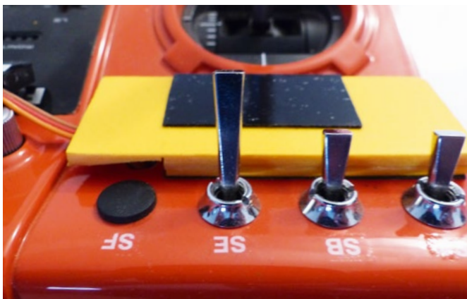
Aus PS wurde ein Halter zur Montage des Steuerpads hergestellt
