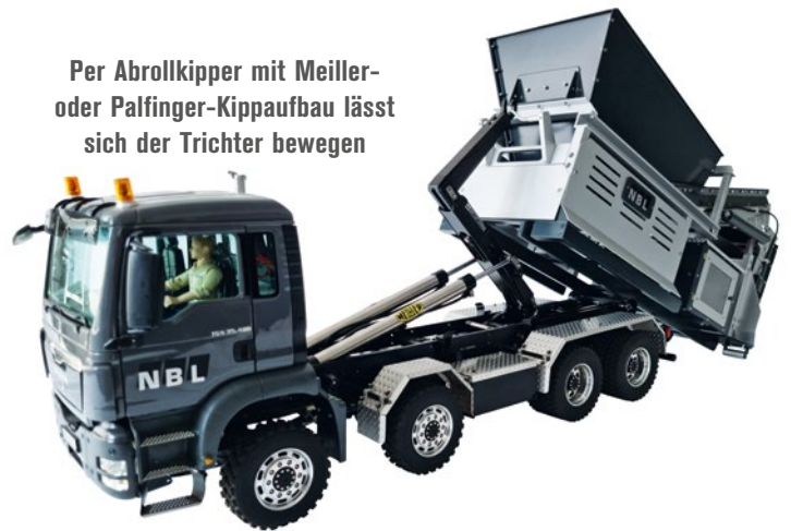
Der Trichter ist aus Messing gefertigt und steht auf einem Grundgestell im Abrollrahmen
