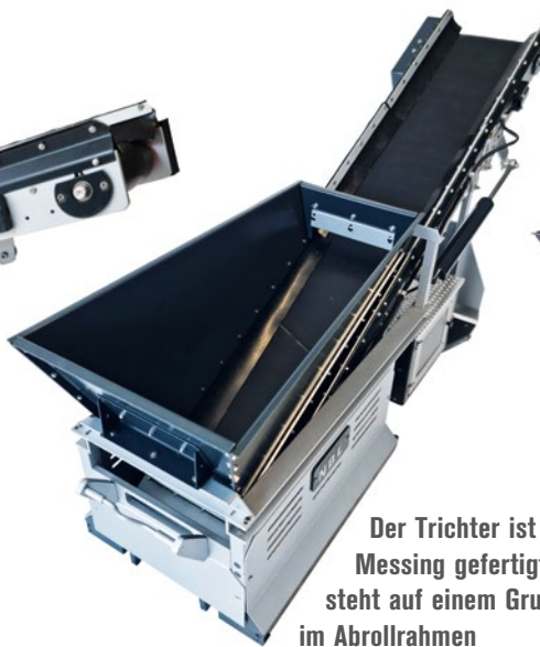
Per Abrollkipper mit Meiller- oder Palfinger-Kippaufbau lässt sich der Trichter bewegen
