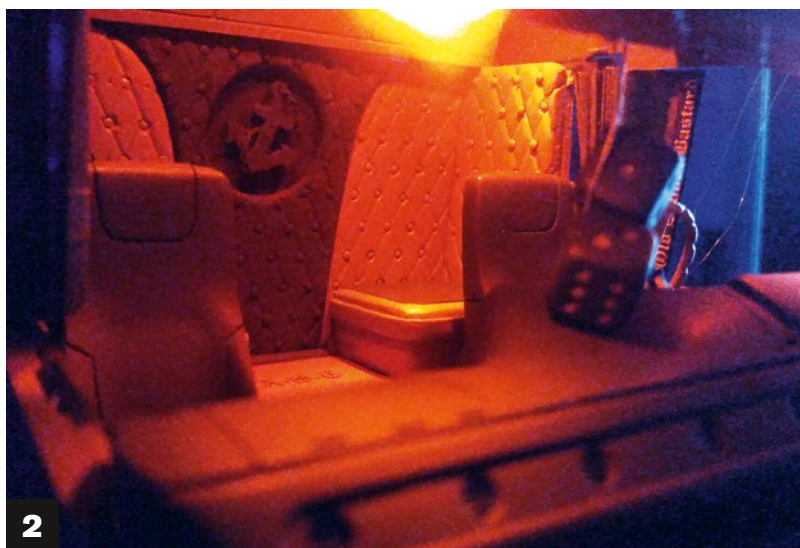
1) Die Inneneinrichtung besteht aus einer PS-Schaumstoffplatte. In das weiche Material kamen Rauten und kleine Stecknadeln als Knöpfe. 2) Um die Fahrerkabine in Szene zu setzen, wurden rote SMDs verbaut. Der Batteriekasten kam ins Rahmeninnere
