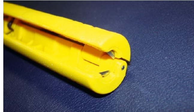
Das Werkzeug hat quer angeordnete Klingen mit einem Abstand von knapp 2 mm auf der schmalen Seite
