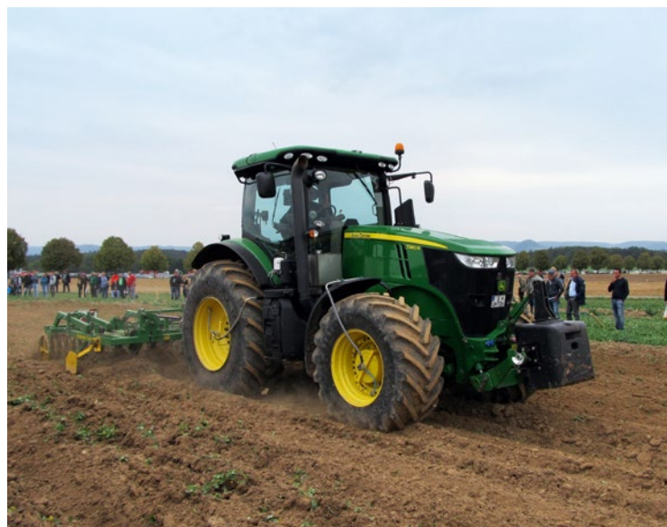
Der John Deere 7260 R ist ein Traktor mit Allradantrieb, ausgerüstet mit dem Motortyp PVX-4V-CR
