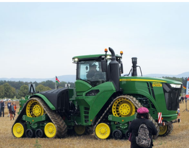
Der Raupentraktor 9620 RX von John Deere gehört mit einem Eigengewicht 24,95 t zu den Giganten der Branche
