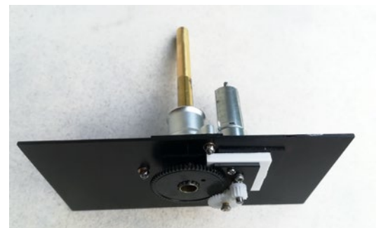
Die Grundplatte des Aufliegers mit Kranachse und Drehantrieb
