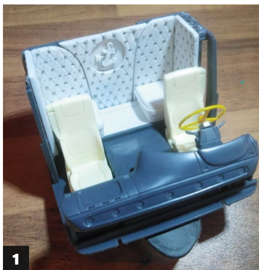
1) Die Inneneinrichtung besteht aus einer PS-Schaumstoffplatte. In das weiche Material kamen Rauten und kleine Stecknadeln als Knöpfe. 2) Um die Fahrerkabine in Szene zu setzen, wurden rote SMDs verbaut. Der Batteriekasten kam ins Rahmeninnere
