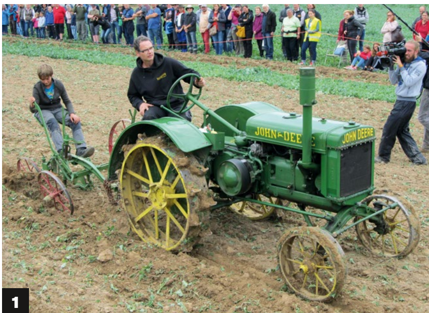
1) Das Modell „D“ John Deere mit liegendem Zweizylinder-Motor war von 1923 bis 1953 im Einsatz. 2) Hanomag verwendete für den RL 20 Bauteile aus der Pkw-Produktion. Das auf den Feldtagen vorgestellte Fahrzeug stammt aus dem Jahre 1937
