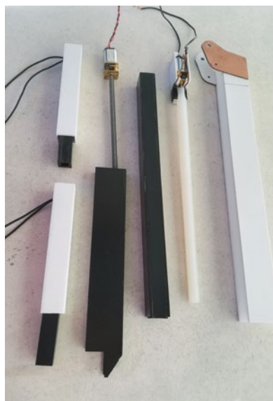
Spindelantriebe für Ausschub und Stützen
