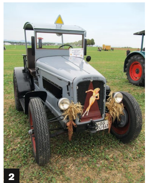
1) Das Modell „D“ John Deere mit liegendem Zweizylinder-Motor war von 1923 bis 1953 im Einsatz. 2) Hanomag verwendete für den RL 20 Bauteile aus der Pkw-Produktion. Das auf den Feldtagen vorgestellte Fahrzeug stammt aus dem Jahre 1937
