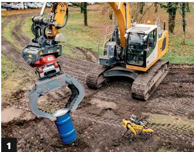
1) Das Fraunhofer IOSB hat einen 24 t Bagger umgerüstet, der mit Hilfe eines wachsenden Roboter-Vierbeiners Dekontaminationsaufgaben übernehmen soll. 2) Einen 12 t schweren Menzi Muck M545-Schreibbagger stattete man beim DFKI mit ordentlich Kamera-Power aus
