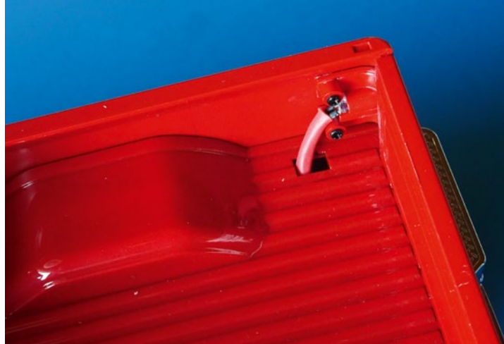
Die Kabel für die rückwärtige Beleuchtung sind auf der Ladefläche sichtbar
