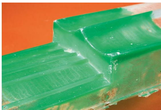
Der Test mit dem neuen Harz ist geglückt. Die Kanten sind sauber abgeformt
