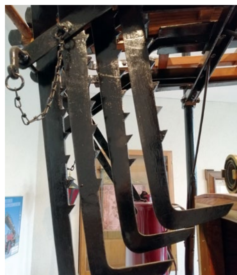
Mit diesen Rasten konnten die einzelnen Leiterelemente arretiert werden
