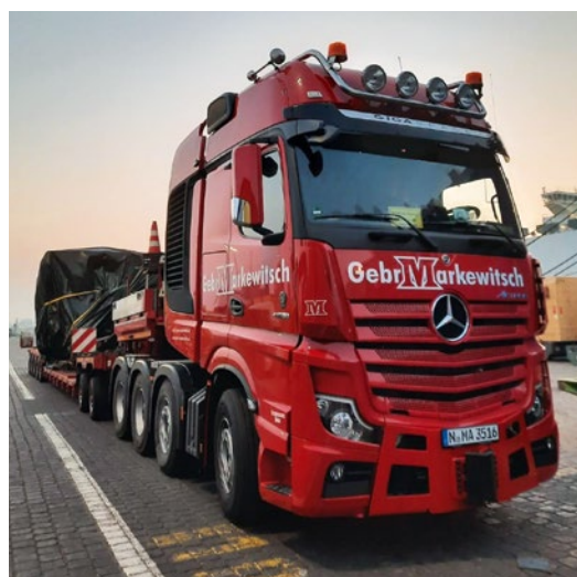
Die vierachsige Zugmaschine von Mercedes-Benz hat die Abmessungen von 8,20 m Länge sowie 2,55 m Breite
