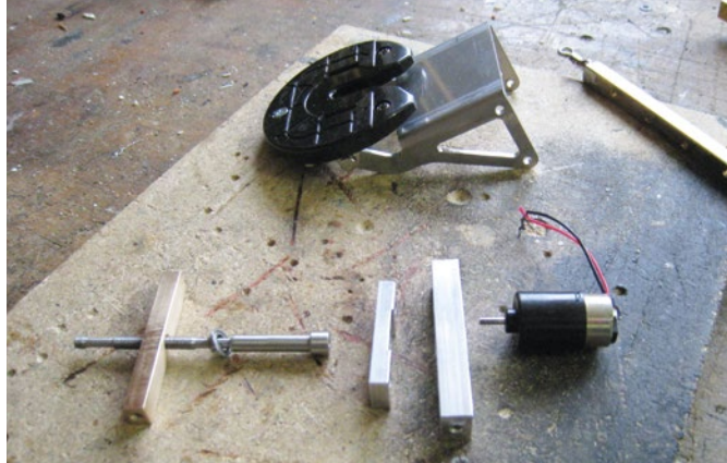
Einzelteile der Hubvorrichtung – mit Antriebsmotor, Haltern, Rikula und Spindel
