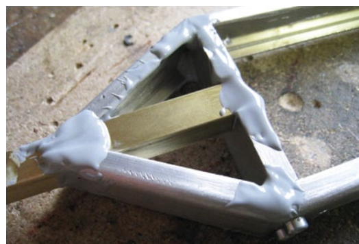
Die Rahmenteile wurden mit Araldit 2K verklebt und nach dem Aushärten geschliffen
