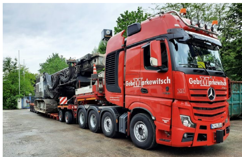
Die ersten beiden Achsen des Sattelschleppers sind gelenkt und dürfen mit jeweils 7,5 t belastet werden, die hinteren beiden sind starr und bis 10 t zugelassen
