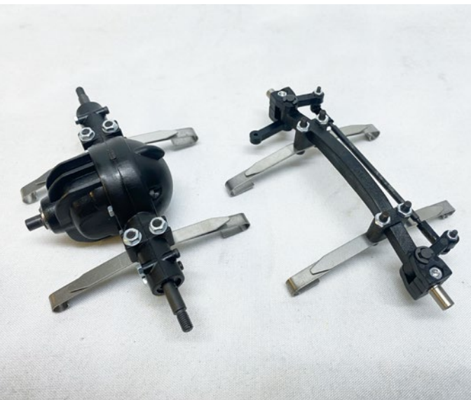
Beide Achsen werden an zweilagigen Blattfedern montiert
