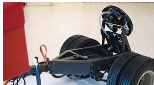
Die fertige Abschleppachse hinter der Allradzugmaschine in oberster Stellung. Beim Einfahren unter den Auflieger wird die Sattelplatte in die waagerechte gedrückt, deutlich zu sehen ist der Bowdenzug zum Öffnen der Platte
