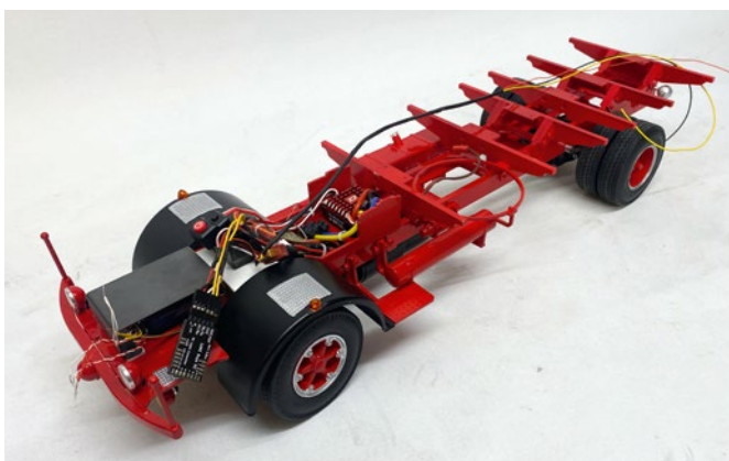
Das Abenteuer beginnt: Verlegung der Kabel. Das lange Kabel zum Heck ist vorsorglich die Anschlussleitung für den Anhänger
