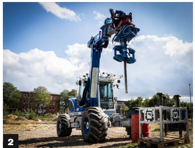
1) Das Fraunhofer IOSB hat einen 24 t Bagger umgerüstet, der mit Hilfe eines wachsenden Roboter-Vierbeiners Dekontaminationsaufgaben übernehmen soll. 2) Einen 12 t schweren Menzi Muck M545-Schreibbagger stattete man beim DFKI mit ordentlich Kamera-Power aus
