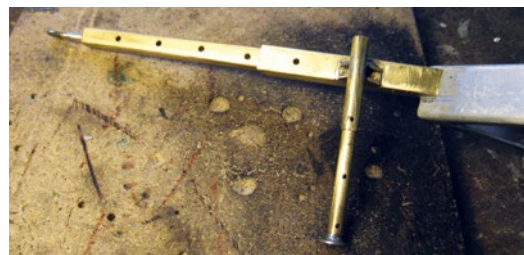
Die ausziehbare Deichsel mit den Absteckbohrungen sowie der einfache Stützfuß
