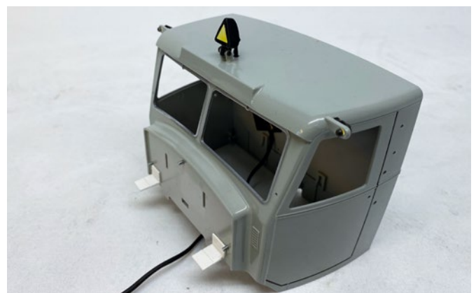
Das Fahrerhaus ist lackiert und die Beleuchtungseinrichtungen installiert. Über die beiden vorderen Winkel wird die Hütte später an den Kotflügeln befestigt
