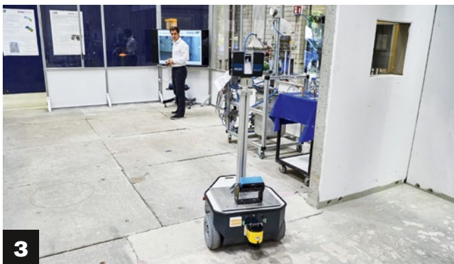
3) Der GammaBot vom KIT soll eine Erkundung sowie die Dekontamination auf Distanz möglich machen. Seine Sensoren sind auf eine Arbeitsbühne montiert und messen die Kontamination von Wänden. 4) Das FZI hat einen Demonstrator zur Sortierung von Gefahrstoffen entwickelt. Künstliche Intelligenz spielt hierbei eine Schlüsselrolle
