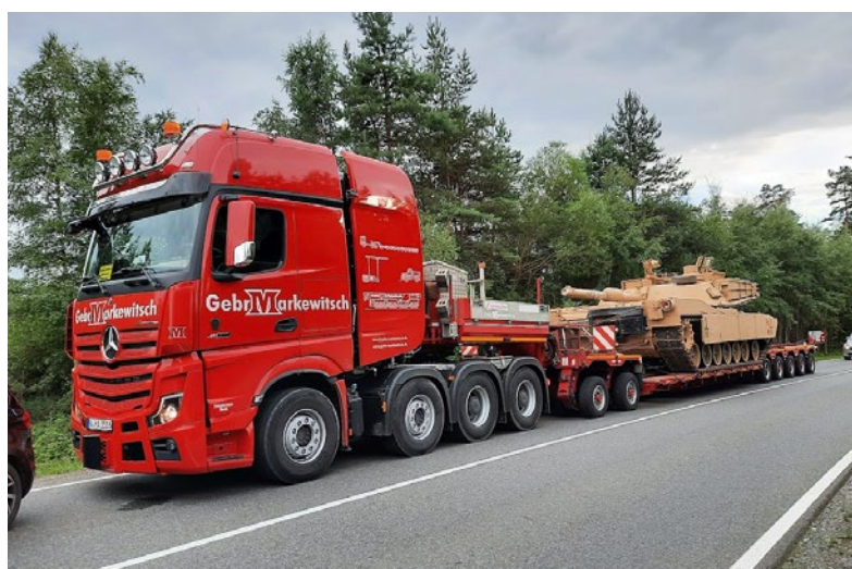
Das Leergewicht der Sattelzugmaschine von Mercedes-Benz mit 442 kW Leistung beträgt 13,85 t
