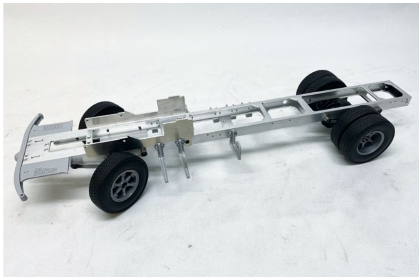
Der einteilige Fahrzeugrahmen wird mit Anbauteilen aus Kunststoff bestückt. Erste Probe der Trilex-Räder
