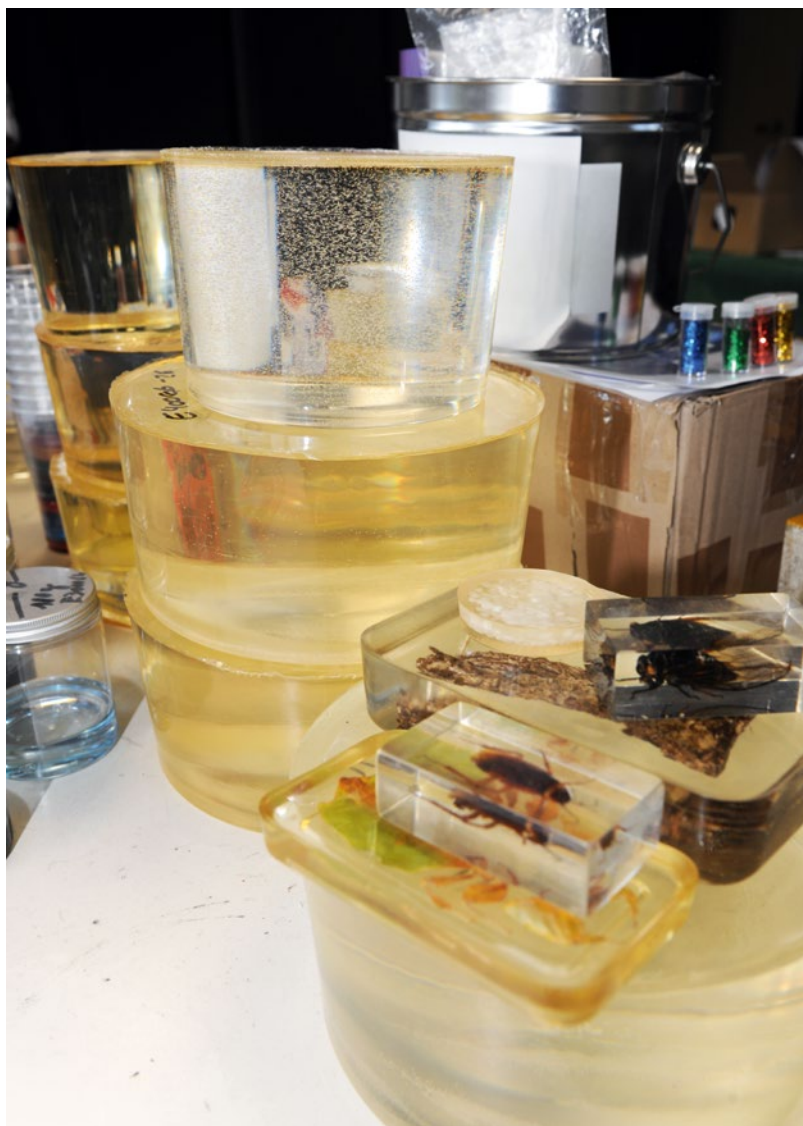
Testergebnisse bei Gießharz mit unterschiedlicher Viskosität/Temperatur. Im oberen Prüfling haben jede Menge Luftblasen nicht entweichen können
