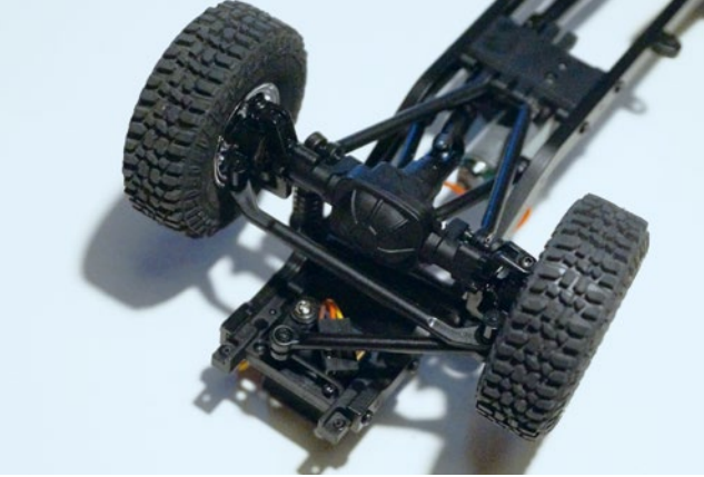
Die vordere Hälfte des Leiterrahmen-Chassis mit Vorderachse, Motor und Getriebe
