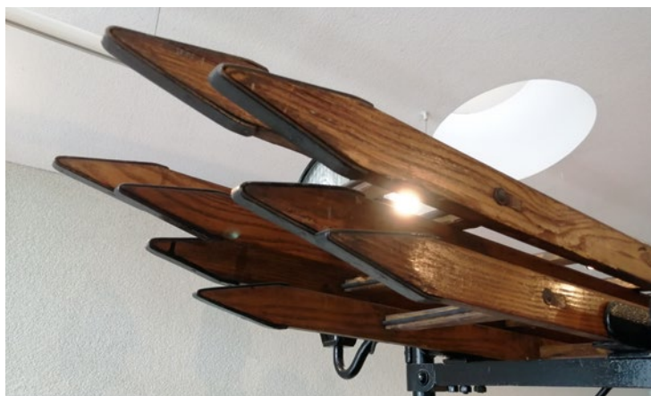
Die Leiter des Gerätewagens mit ihren spitzen Enden für sicheren Stand
