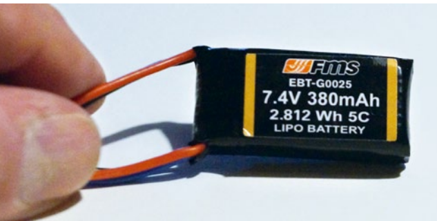
Dieser kleine Akku reicht locker für mehr als eine halbe Stunde Fahrbetrieb und ist danach wieder in 30 Minuten voll geladen
