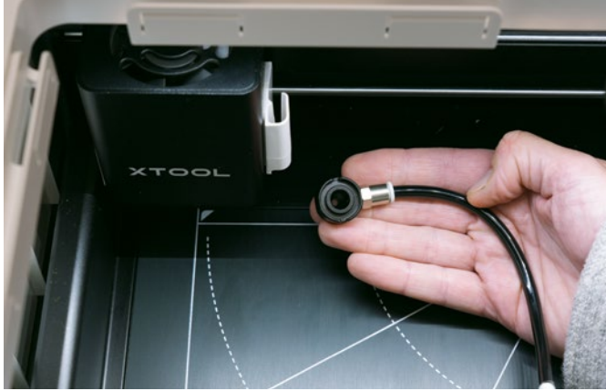
Um die Plotterfunktion weiter nutzen zu können, ist der Luftaufsatz des Air Assist einfach demontierbar
