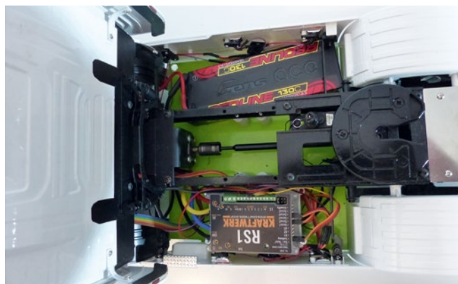
Gute Entscheidung, die Elektronik in die Seitenkästen zu verlegen
