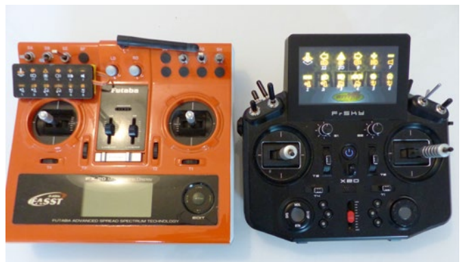
Links ist ein Sender mit Kraftwerk PAD zu sehen, das aber auch digital im Display des Senders (rechts) nachempfunden werden kann
