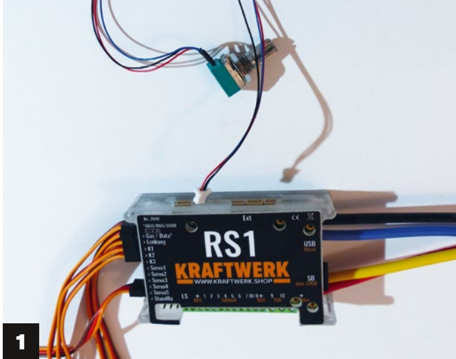
1) Das neue RS1 mit Lautstärkereger. 2) Eine der Neuheiten der Scania Front Platine, grünes Standlicht eingestellt
