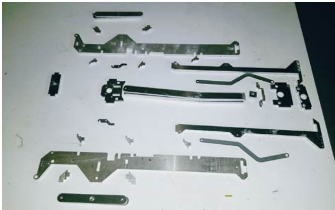
Ein Blick auf die Laserteile des Rahmens vor der anschließenden Montage
