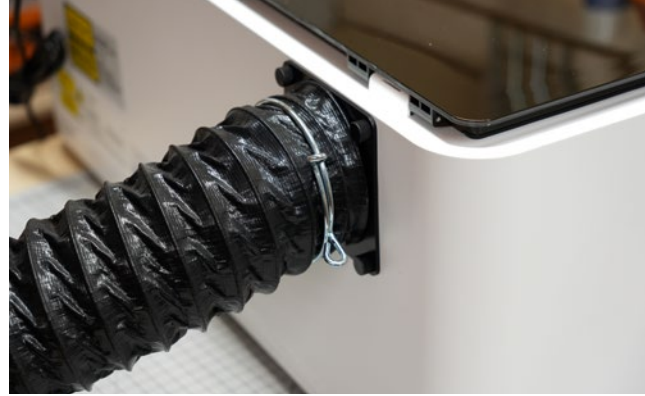
Der am xTool M1-Gehäuse zu befestigende Abluftschlauch ist zu einer Abluftfilteranlage oder einer Fensteröffnung zu führen
