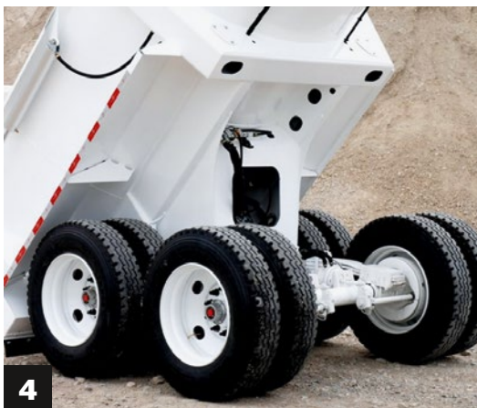
4) Bei dieser Variante bleiben die Räder beider Achsen am Boden. 5) Die Ausgleichswelle zwischen den Achsen dient als Drehpunkt
