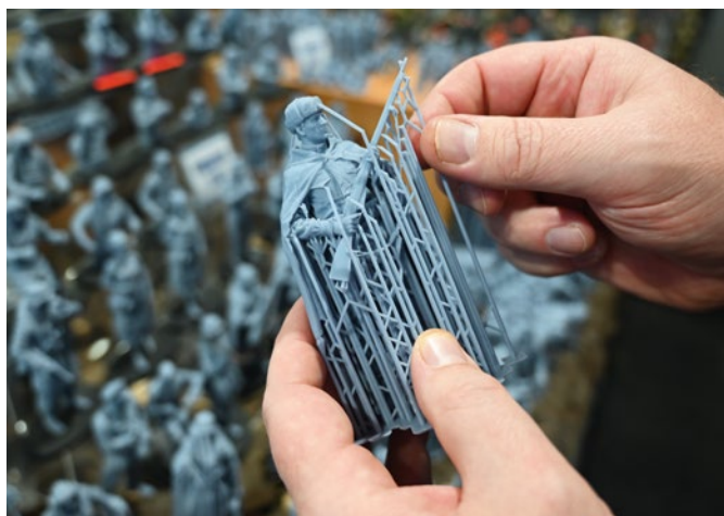
Die Figuren von Licmas-Tank entstammen dem 3D-Drucker. Das Zeichnen geht schnell, die optimale Dicke der Streben muss durch mehrmaliges Drucken erst festgestellt werden
