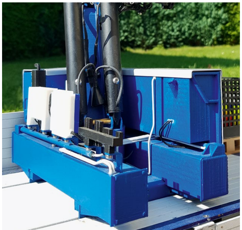
Bearbeitete Messingstangen am Wagen stellen weitere Hydraulikleitungen dar
