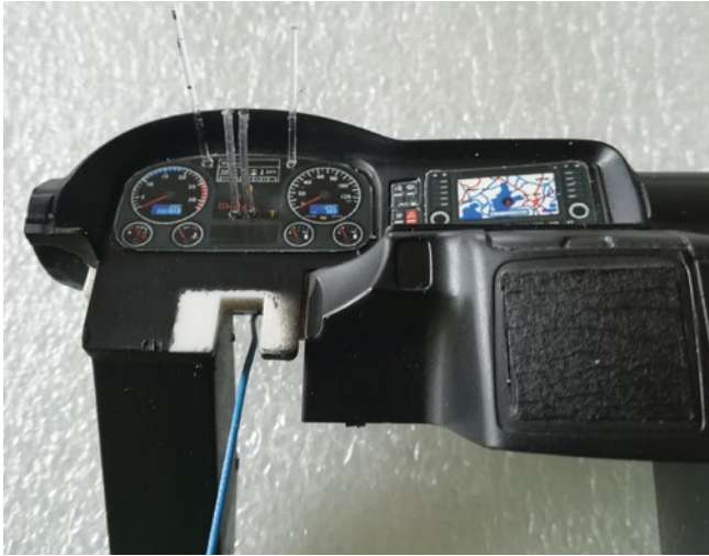
Einbau der Lichtleiter für die Kontrolllampen
