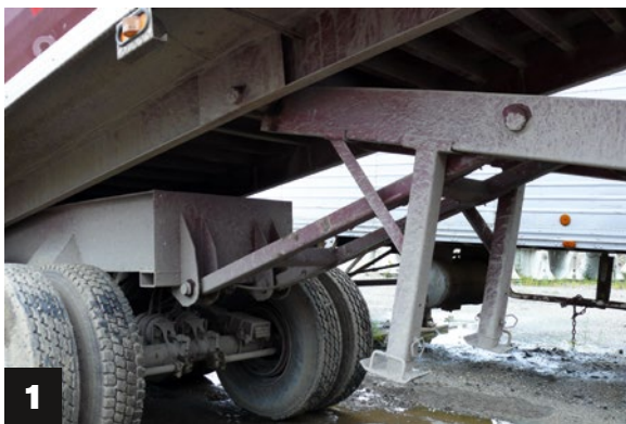
1) Beim „quarter frame trailer“ bleiben Rahmen und Räder waagrecht. Die Gestänge sind gut sichtbar. 2) Die Aufnahmeplatten auf der Sattelplatte haben alle rahmenlose Bauweisen in unterschiedlichen Bauformen. 3) Die Variante, bei der die Hinterachse als Drehpunkt dient
