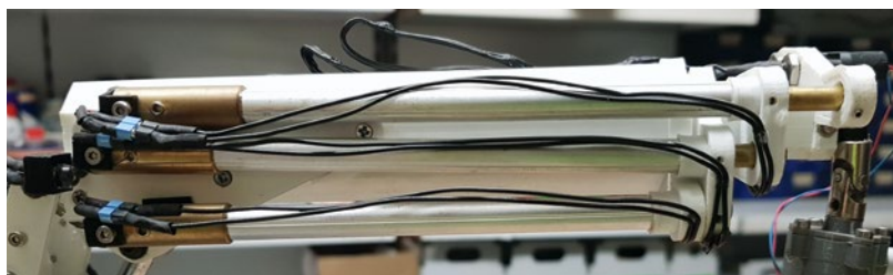
Eine Kombi aus selbstgebauten Spindelzylindern und 4-mm-Getriebemotoren ermöglicht das Teleskopieren
