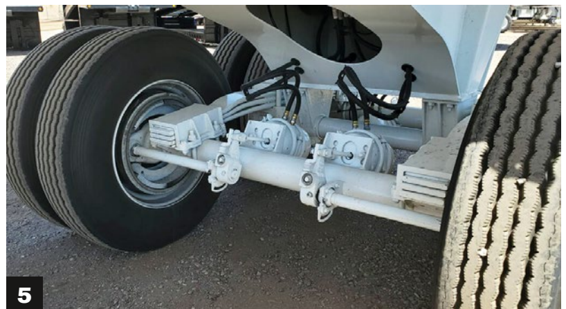
4) Bei dieser Variante bleiben die Räder beider Achsen am Boden. 5) Die Ausgleichswelle zwischen den Achsen dient als Drehpunkt
