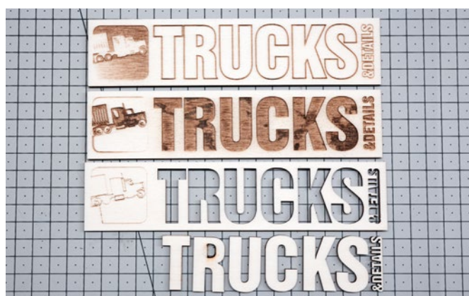
Oben die farbige Originalvorlage und mittig die schwarz-weiß umgewandelte Gravur. Beim Auslasern gab's beim R ein kleines Malheur – da hatte sich das Zwischenstück wohl quergestellt
