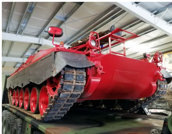
Ansicht des Feuerlöschmarders von vorne. Die Abmessungen betragen 6.790 x 3.240 x 1.950 mm
