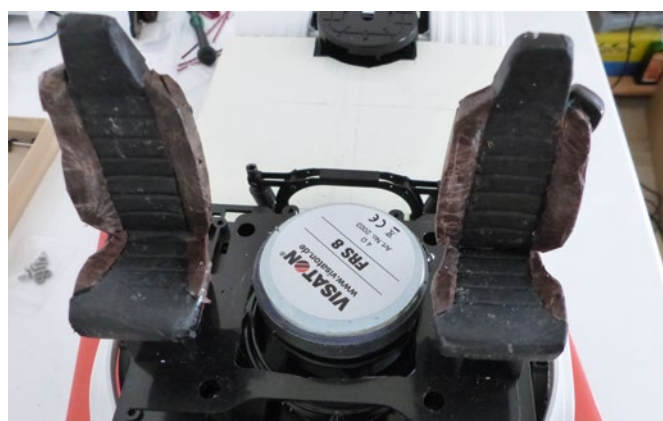
Der zwischen den Fahrersitzen platzierte Lautsprecher sorgt für ein vorbildgetreues Klangerlebnis
