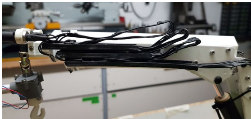
Wie eine Energiekette wurden die Kabel seitlich an den Teleskopteilen angebracht
