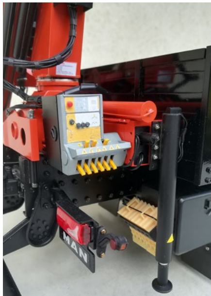
Das rechte Bedienfeld ermöglicht die gesamte Bedienung des Krans
