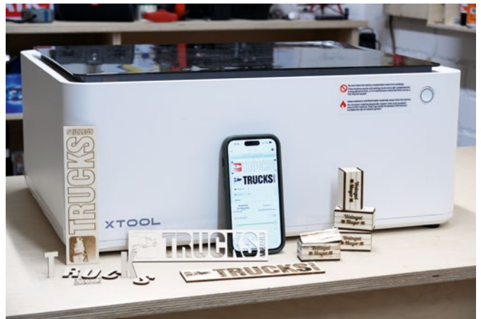
Wenn es die WLAN-Verbindung zulässt, kann auch das Smartphone den Laser steuern, um feine Teile zu lasern
