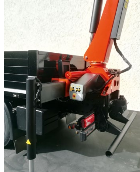
Das linke Bedienteil ist nur für die Stützen vorgesehen
