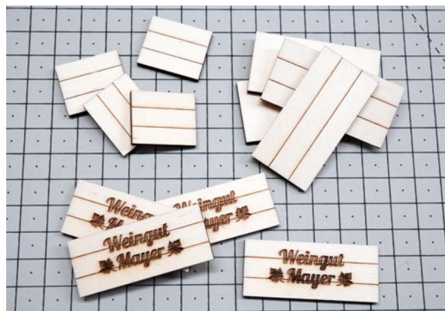
Präzise gefertigte Einzelteile zum Bau einer Weinkiste, die zugleich graviert sind
