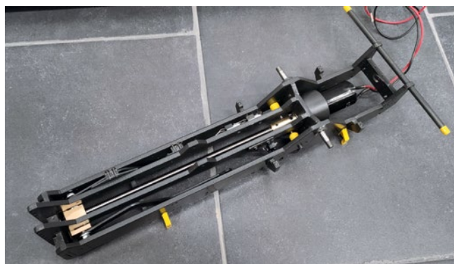
Der lackierte Hauptrahmen von unten, gut zu sehen die Spindel und mit der Hauptmutter und dem Antriebsmotor ...
