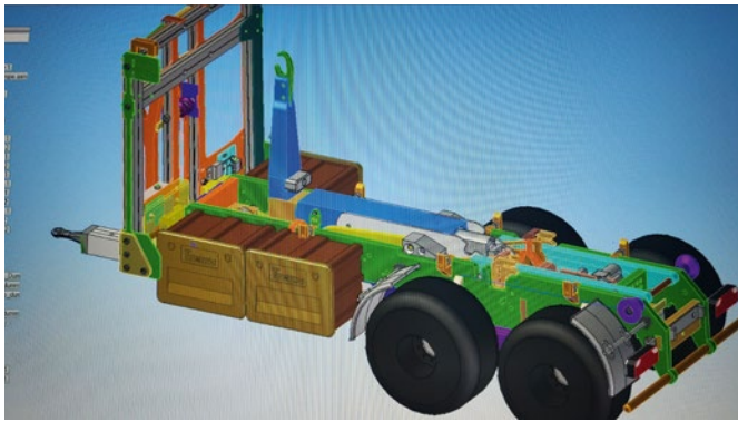
Das vollständige CAD-Modell. Bis auf die Verkabelung ist alles dargestellt
