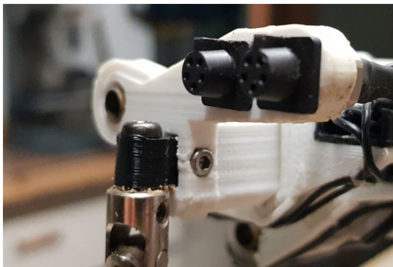
Insgesamt sechs Kabel versorgen die Kranhaken mit Strom. Sie enden an zwei fünfpoligen Steckern
