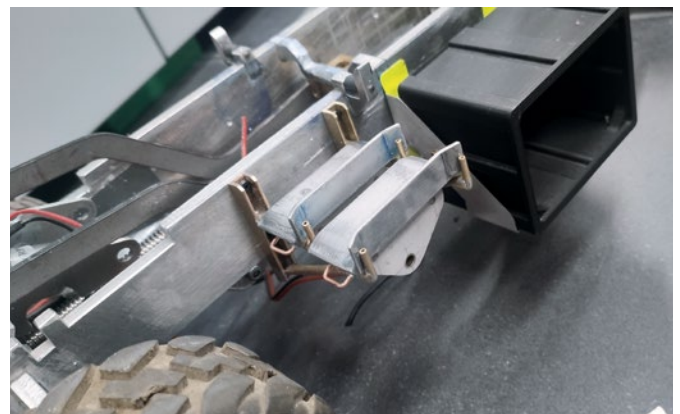
Lagerung der Gleitbahnen auf der rechten Fahrzeugseite, hinter dem rohen Staukasten
