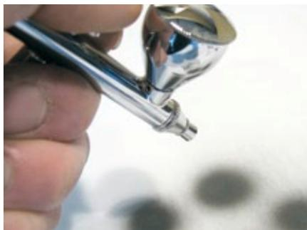
**Sprühtest:** der Kompressor sollte eine Luftleistung von zirka 15 Liter pro Minute haben, der Arbeitsdruck zwischen 1 und 3,5 bar regelbar sein
