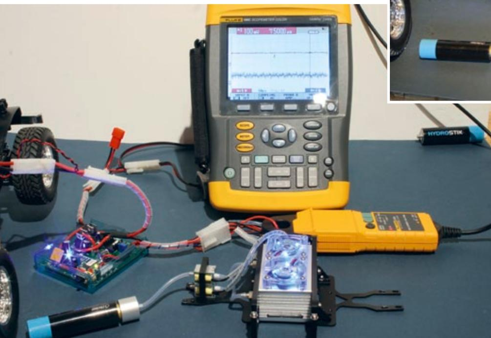
Aufzeichnung der Messwerte mit unterschiedlichen Betriebszuständen im Speicher des Digital-Scopemeters zur anschließenden Auswertung am PC: Wenn schon High-Tech, dann wenigstens auch zeitgemäße Messtechnik
