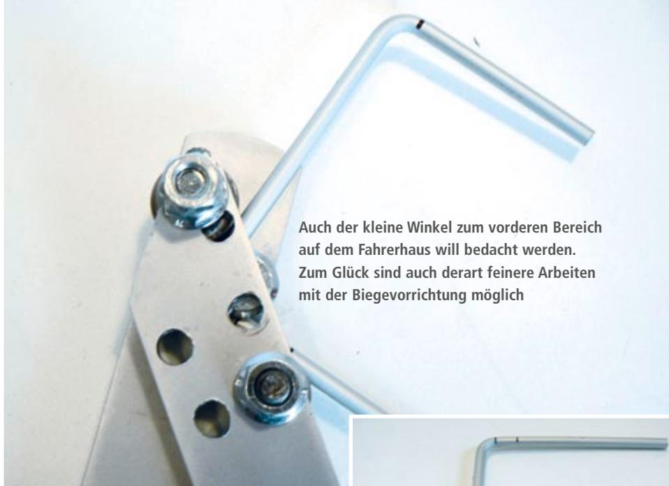
Auch der kleine Winkel zum vorderen Bereich auf dem Fahrerhaus will bedacht werden. Zum Glück sind auch derart feinere Arbeiten mit der Biegevorrichtung möglich
