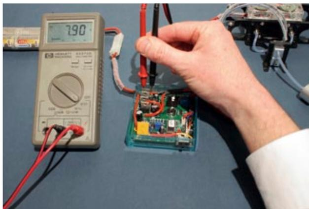
Die Ausgangsspannung der Brennstoffzelle lässt sich bequem an den Messpunkten in der Regelelektronik messen
