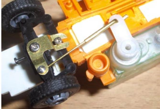
Das Lenkservo sitzt seitlich im Aufbau und steuert die Vorderachse über einen Anlenkhebel aus Messingblech an. Dieser ist über eine justierbare Anlenkstange mit dem Ruderhorn verbunden
