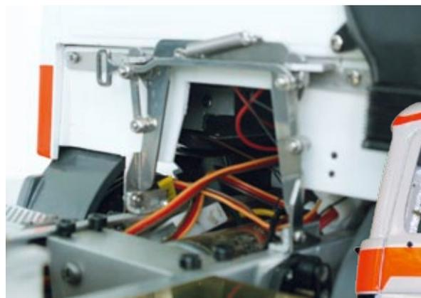
Hinter der Zwischenwand wird im Fahrerhaus ein Teil der Elektronik verbaut
