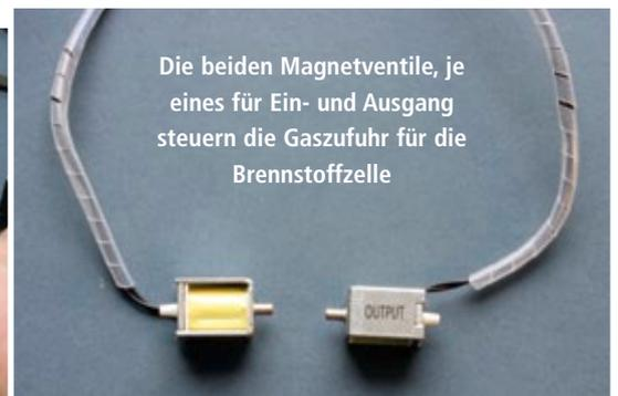
Die beiden Magnetventile, je eines für Ein- und Ausgang steuern die Gaszufuhr für die Brennstoffzelle
