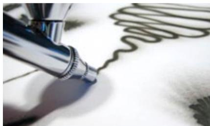
**Funktionstest:** Der Pistolengriff wird dazu erst kräftig durchgedrückt, dann nach und nach gelockert. Der aufgebraute Strich sollte entsprechend dünner werden
