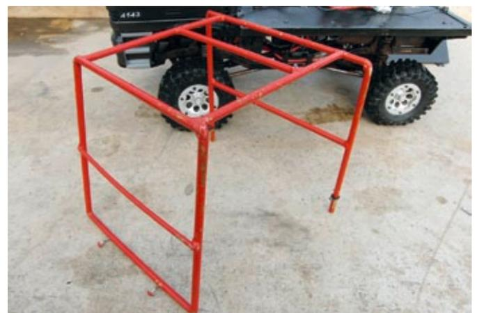
Der Überrollkäfig besteht aus miteinander verlötetem 5-mm-Messingrohr und wurde mit dem Fahrerhaus verlötet
