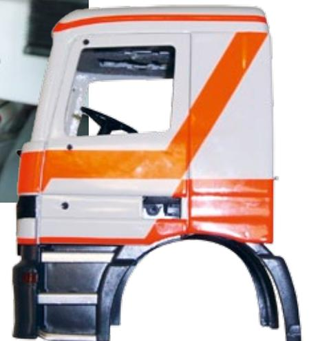
Beim bereits fertig lackierten Fahrerhaus von Oßwald Modellbau sieht man nicht mehr, dass Einstieg und Radlauf mit einer Säge passend gemacht wurden
