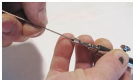
Beim Wiedereinsetzen der Nadel ist Fingerspitzengefühl gefragt. Liegt die Nadel komplett in der Düse, wird die Feststellschraube wieder angezogen und der Griff montiert
