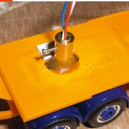
Die Anschlusskabel des Infrarotempfängers habe ich durch den hohlgebohrten Königszapfen geführt. Durch Lösen der Schraube kann ich das Drehgestell bei Bedarf demontieren
