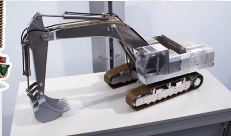
Just in time zur Messe wurde der Prototyp einer Kettenbagger-Projektstudie im Maßstab 1:14,5 fertig. Und wurde auf Antrieb einer der Stars am robbe-Stand. Das imposante Fahrzeug wiegt satte 13 Kilogramm und ist unter Verwendung der 2011 in Nürnberg vorgestellten robbe-Hydraulik-Komponenten entstanden
