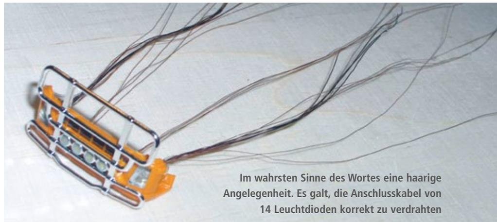
Im wahrsten Sinne des Wortes eine haarige Angelegenheit. Es galt, die Anschlusskabel von 14 Leuchtdioden korrekt zu verdrahten
