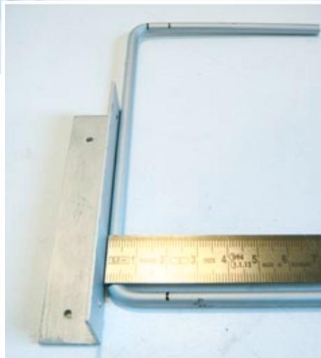
Eine Möglichkeit, die Scheinwerfer symmetrisch zu montieren: anzeichnen, nachmessen und gegebenenfalls nochmal korrigieren
