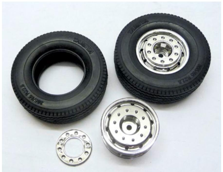
Um den Zusammenbau des Fahrgestells abzuschließen, müssen die Reifen montiert werden. Es handelt sich um eine 385er-Bereifung mit Breitfelgen
