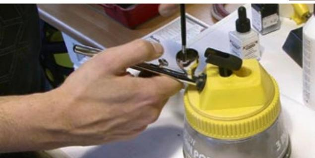
Vor einem Farbwechsel wird überschüssige Farbe in einen Spray-Out-Pot gesprüht. Anschließend muss die Pistole gut ausgewaschen werden
