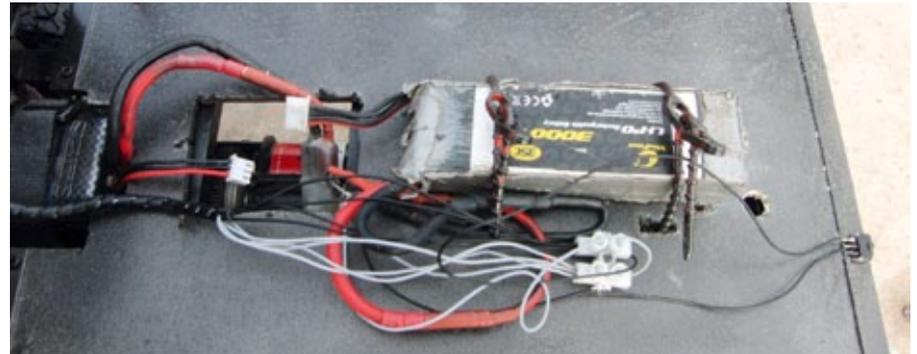
Auf der Pritsche und durch das Werbeschild vor Blicken geschützt: ein LiPo-Akku mit 3.000 Milliamperestunden Kapazität zur Versorgung von Lampen und Soundmodul
