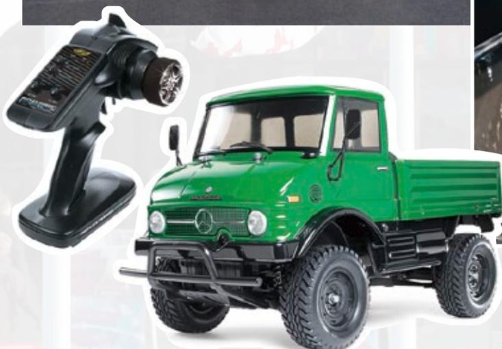
Für Unimog-Fans hat man im Hause Tamiya eine neue, komplett fahrfertige Version des Unimog 406 ins Programm aufgenommen. Das Modell basiert auf dem erprobten CC-01-Geländechassis und ist mit einer 2,4-Gigahertz-Fernsteuerung ausgestattet. Allradantrieb und Öldruckstoßdämpfer verleihen Vortrieb und Bodenhaftung
