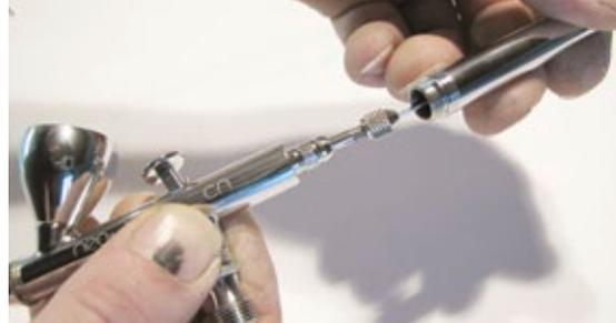
Bei einigen Airbrush-Pistolen lässt sich über eine Stellschraube an der Nadel auch die Sprühstärke einstellen
