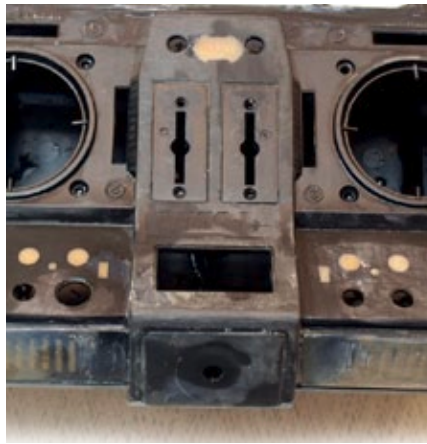
Dort, wo die Antenne war, bleibt die Bohrung zum Einbau der Kontroll-LED
