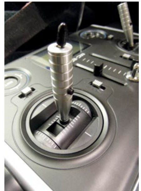
Knüppelschalter mit Dreiwegeschalter und Taster von RC Technik Peter Herr
