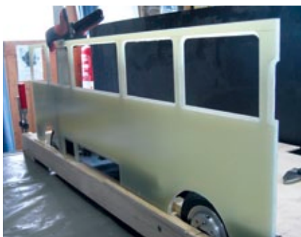
Die Anhänger-Seitenteile entstanden aus Epoxidharz-Platten
