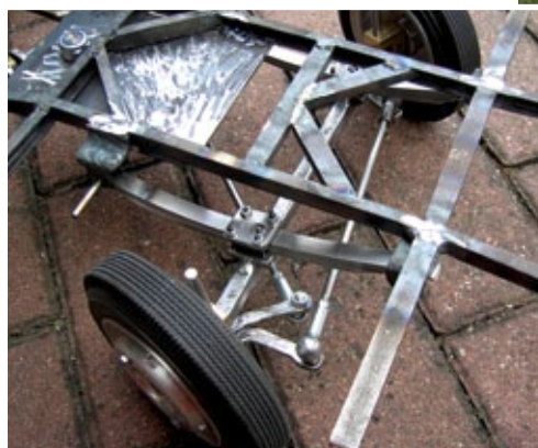
Blick auf die Achsschenkelenkung des Anhängers. Diese ist originalgetreu ausgeführt, was gerade Rückwärtsfahrten des Bus-Anhänger-Gespans zu anspruchsvollen Fahrmanövern macht
