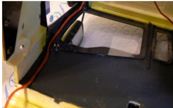
Das Kabel für die Dachbeleuchtung wird mit Servotape in der A-Säule des Fahrerhauses eingeklebt
