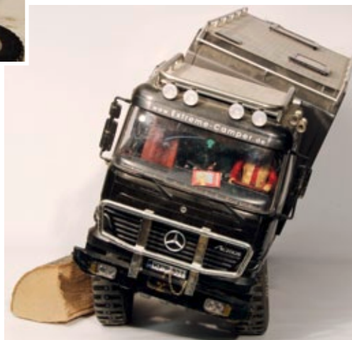
Dank des Drehgelenkes kommt eine bemerkenswerte Verschränkung zustande
