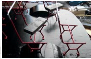
Die Sitzgestelle des Anhängers bestehen aus 3 x 1-Millimeter-Messingrohr
