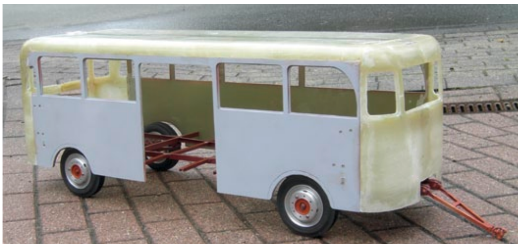
Der Rohbau des Anhängers. Neben den Epoxid-Seitenteilen sind die anderen Ausbauten aus Polyester mit Glasfaser-Verstärkung angefertigt
