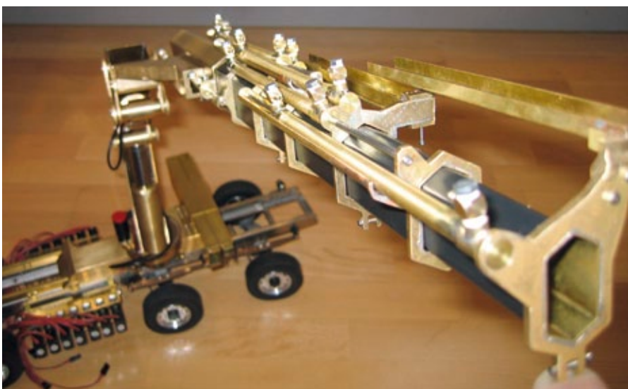
Voll ausgefahren misst der Ladekran eine Länge von gut 1.200 Millimeter und hat eine Hubleistung von noch 1.700 Gramm
