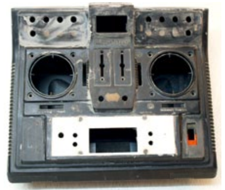
Unten befindet sich der Ausschnitt für das Display der Blauzahn. Daneben sind die Bohrungen für die Taster und dem Schalter für die Ebenen
