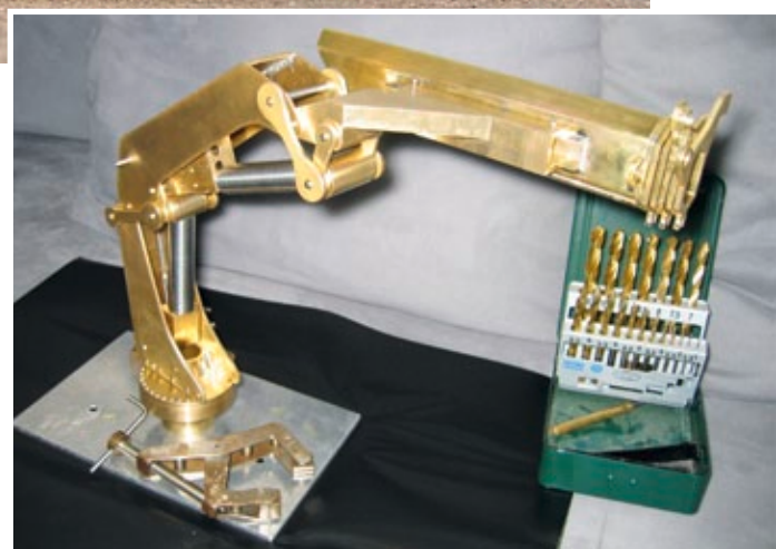
Der Rohling des Krans ist fertig. Hier ist auch die 18 Millimeter dicke Kolbenstange schön zu sehen
