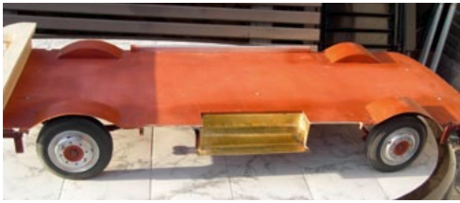
Der Boden des Anhängers besteht aus 3-Millimeter-Sperrholz. Außerdem zu sehen: Der Einstieg aus Messing
