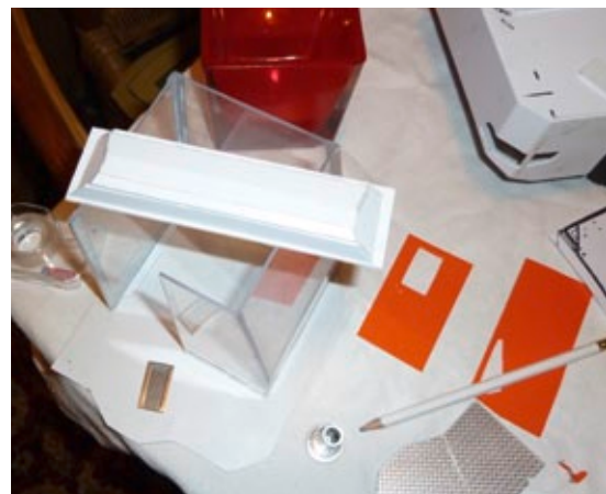
Die Einzelteile des noch nicht montierten Fahrerhauses. Rundum kommt Plexiglas zum Einsatz, das Dach besteht aus Polystyrol
