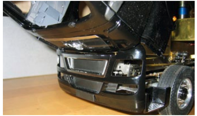
Das Fahrerhaus wurde dergestalt umgebaut, dass der Bereich um die Stoßstange nicht mitgekippt wird. Dadurch können hier die Kranstützen fest montiert werden
