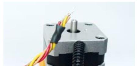
Zur besseren Identifikation der Motoranschlusskabel sollten diese vorher mit einer unterschiedlichen Anzahl an Ringen aus Schrumpfschlauch eindeutig gekennzeichnet werden, da alle vier Aderfarben jeweils dreimal vorhanden sind
