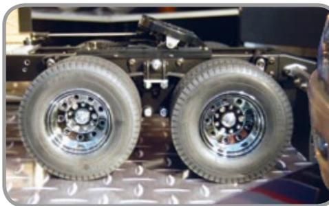
Das Modell verfügt über einen Aluminium-Leiterrahmen, Blattfeder-Aufhängung mit Federbein sowie ein Dreigang-Schaltgetriebe
