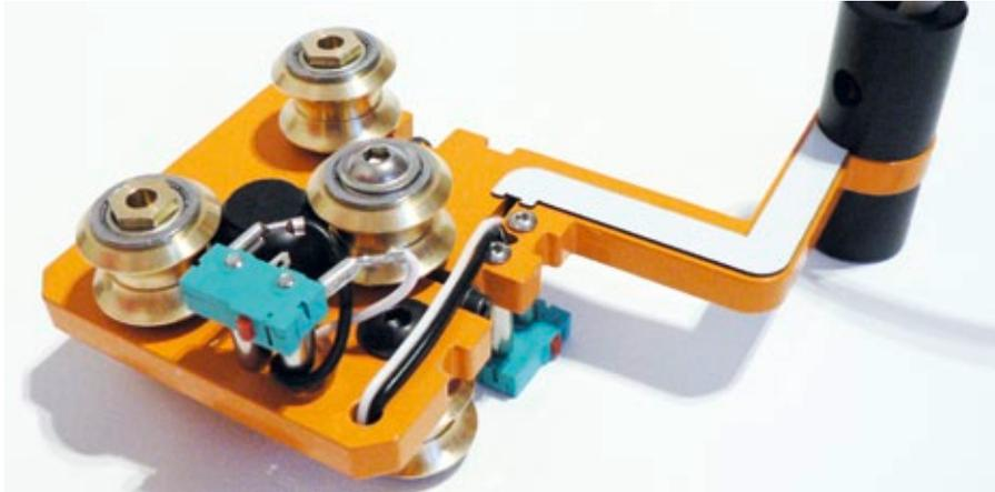
Das Verlegen der Kabel sollte mit Feingefühl und etlichen Tests erfolgen, um sicher zu stellen, dass nirgendwo ein Kabel eingeklemmt oder aufgescheuert werden kann. Die beiden grünen Endlagenschalter dienen bei der Referenzfahrt der exakten Bestimmung des Nullpunkts
