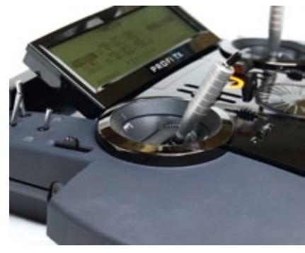
Knüppelschalter für den Multiplex Profi TX von RC Technik
