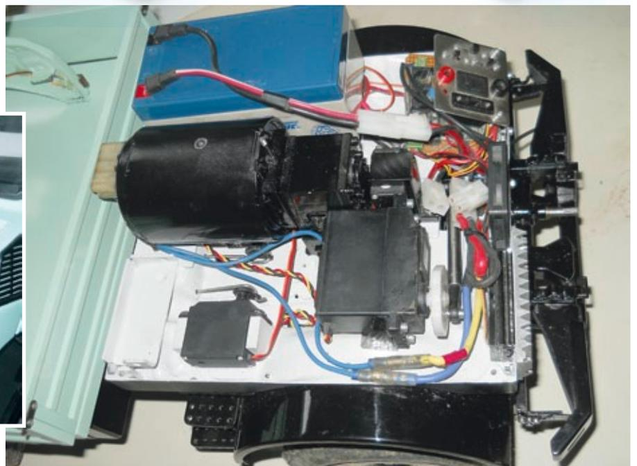
Die Fahrerkabine kann einfach abgenommen werden. Unter Akkus und Motor finden die Servos zum Schalten des Getriebes Platz
