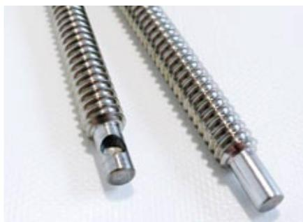
Die Rundgewindespindeln sind sehr präzise gefertigt und verfügen an den Enden jeweils über eine Ausfräsung zur Arretierung der Madenschrauben des Antriebs. Vor dem Zusammenbau sollte der Übergang der Spindel zum Schaft auf überstehende Grate kontrolliert werden, um eine Beschädigung der Spindelmutter zu verhindern
