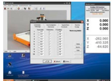
In der Vollversion können anstelle von zwei Werkzeugen bis zu zehn definiert werden. Die passenden Parameter wie Durchmesser, Wiederholung oder auch Verfahrensgeschwindigkeit lassen sich im Menü hinterlegen
