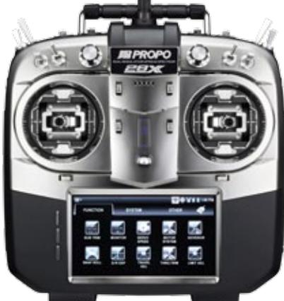
Das neue Flaggschiff von JR – Vertrieb über AKMod – hört auf das Kürzel 28X. Neben den achtbaren 28 Kanälen fällt besonders das Android-Betriebssystem als Benutzeroberfläche ins Auge, wodurch die Programmierung über externe Eingabegeräte ermöglicht wird. Angesichts des üppig bemessenen, 109 Millimeter großen TFT-Touchscreen fast schon zu viel des Guten.
