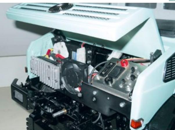
Öffnet man die Motorhaube, so blickt man auf das Innenleben: Hauptschalter, Lichtschalter und Blinker, PC-Lüfter und Kühlkörper mit Fahrregler
