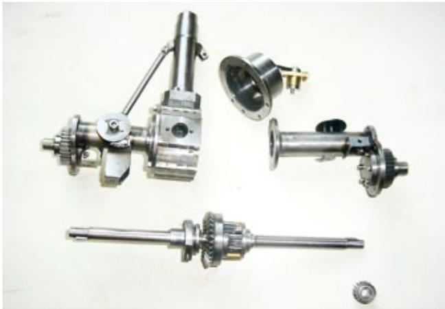
Die Hinterachse mit Stirnrad-Differenzial, Differenzialsperre und Stirnradstufen in den Radnaben
