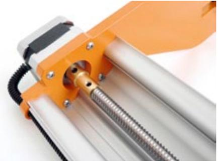
Die schnörkellose Konstruktion ermöglicht einen schnellen Wechsel der Bauteile, sollte im Laufe der Zeit irgendwo übermäßiges Spiel auftreten. Gut zu erkennen ist auch die direkte Verbindung der Motorwelle und der Spindel über ein Messingdrehteil
