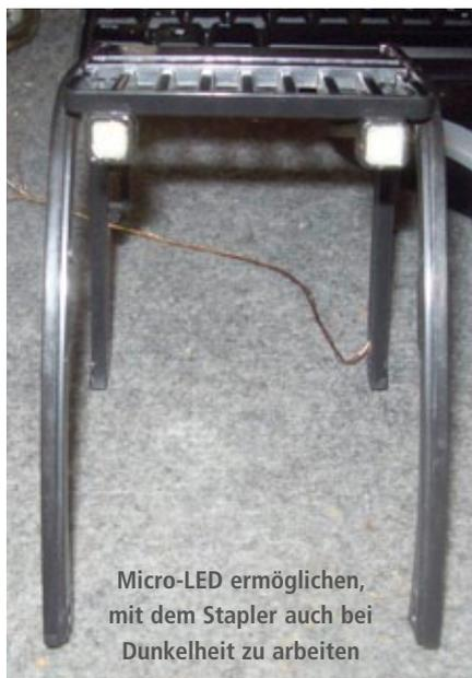
Micro-LED ermöglichen, mit dem Stapler auch bei Dunkelheit zu arbeiten
