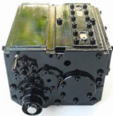
Hauptgetriebe mit Abtrieben zu den Achsen. Zwei Schaltstufen-Differenzialsperren sind unabdingbar für den Unimog
