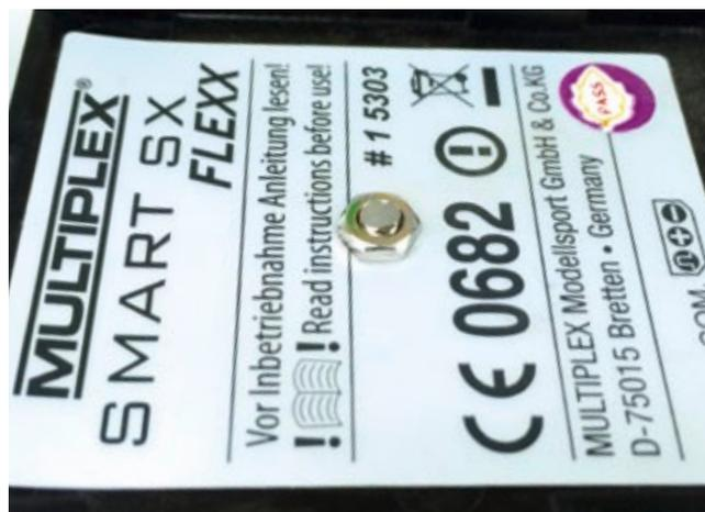
Mit einer sehr dünnen Mutter wird sichergestellt, dass kein Kontakt zu den Batterien entsteht
