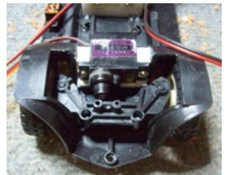
Mit Polystyrol wurde eine passende Halterung für das Servo hergestellt
