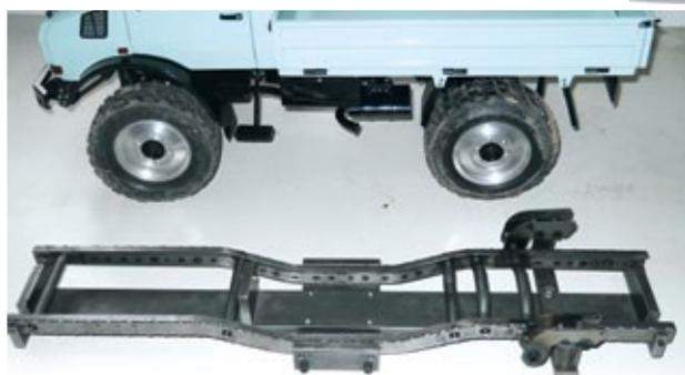
eine sehr gute Bodenfreiheit ergibt. Außerdem wird durch die Stirnradstufe das Drehmoment auf das Differenzial reduziert, wodurch das Differenzial kleiner gebaut werden konnte. Trotzdem ist das Differenzialgehäuse übermaßstäblich groß geraten, weil die Zahnradberechnung und die Verfügbarkeit der Kegelräder kein kleineres zuließen. Vorrangig ist, dass die Differenziale den enormen Belastungen im ersten Gang standhalten können.
