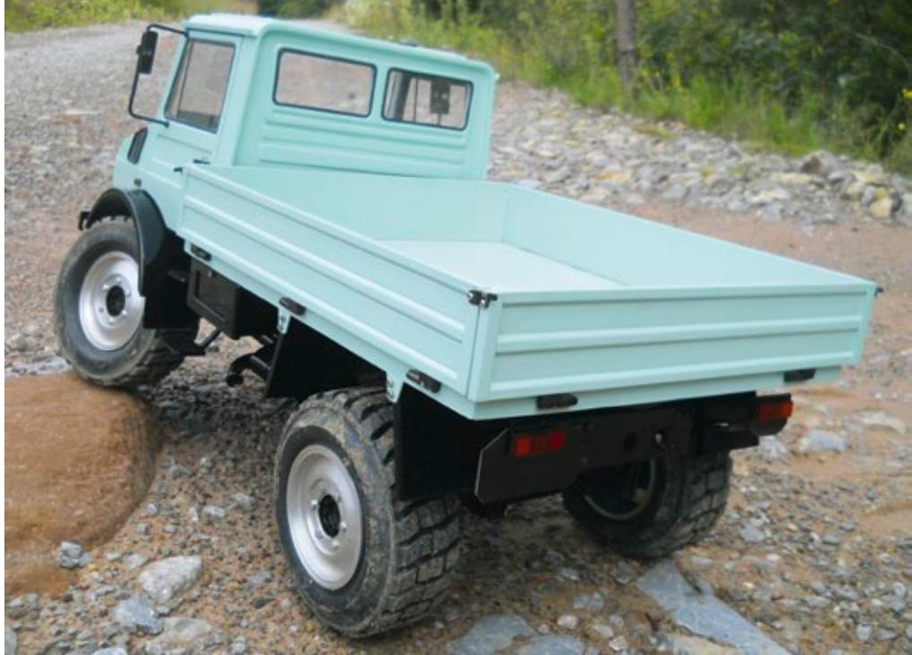
Die Verwindung des Rahmens ist durch Verdrehung der Fahrerkabine relativ zur Ladefläche erkennbar
