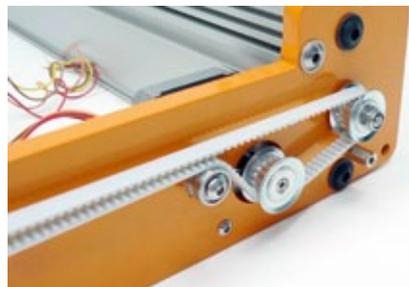
Der Riemen verbindet den Motor der Y-Achse mit den beiden Portalseiten und wird von einer Stahlblechabdeckung vor Schmutz geschützt. Gut zu erkennen ist auch der Riemenspanner, dessen Spannung allerdings nicht zu hoch sein sollte (zu hoch abgebildet), da sich sonst die Zähne des Riemens behindern können
