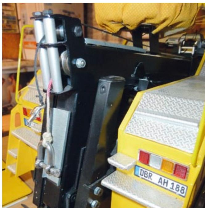
Seilrollen zur Führung der Windenseile
