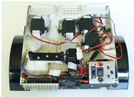
Wanne unter der Fahrerkabine mit Servos für Gangschaltung und Differenzialsperre. Daneben Fahrregler (links vorn), rechts Schalter und Ladebuchsen
