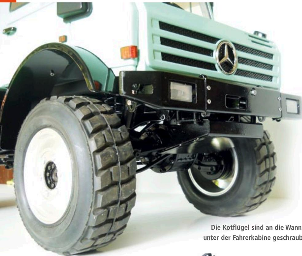
Die Kotflügel sind an die Wanne unter der Fahrerkabine geschraubt
