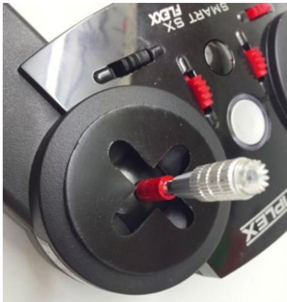
Zur perfekten Führung der Lenkung wurde eine Schablone aus 2 Millimeter starkem Polystyrol angefertigt
