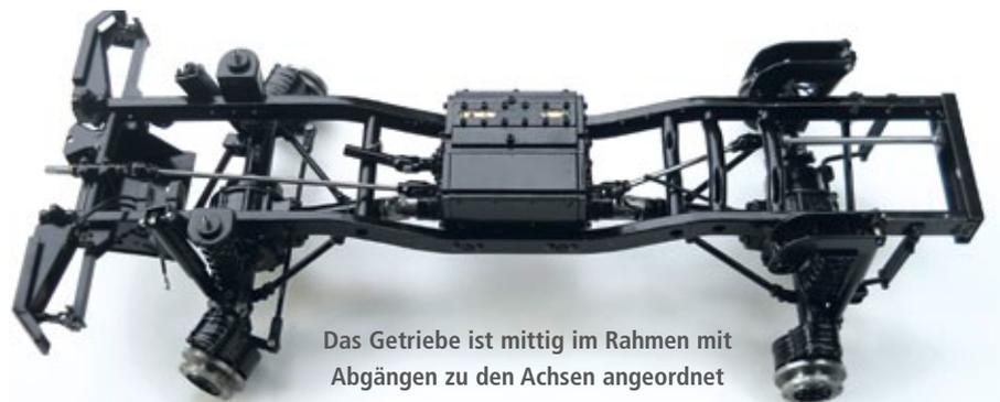
Das Getriebe ist mittig im Rahmen mit Abgängen zu den Achsen angeordnet
