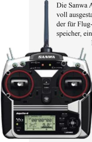
Die Sanwa Aquila-6 von LRP electronic ist ein voll ausgestatteter 2,4-Gigahertz-Sechskanal-Sender für Flug- und Funktionsmodelle. Zehn Modellspeicher, eine Reihe fertiger sowie zwei freie Mischer und drei programmierbare Phasen gehören zu den Standards. Fünfpunkt-Gas- und -Pitch-Kurven, modellspezifische Programmiermenüs, ein Lehrer-Schüler-Modus und der Ausbau mit mehreren Gebern runden das Paket ab. Der Preis: 199,90 Euro.
