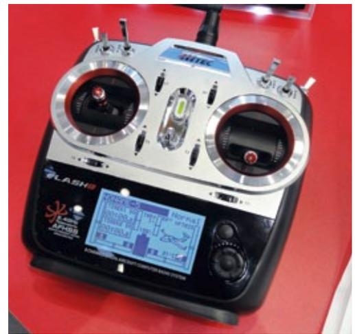
Hitec steigt mit dem Achtkanal-Sender Flash 8 in eine neue Sender-Linie ein – das kleinere Schwestermodell nennt sich Flash 7. Der 2,4-Gigahertz-Transmitter verfügt über ein AFHSS/SLT-Modul sowie ein LCD-Display, das sich durch seine gute Ablesbarkeit auszeichnet. Darüber hinaus verfügt der Sender über zwölf Geber, digitale Trimmungen sowie einen Vibrationswarner. Der Preis: 239,90 Euro.
