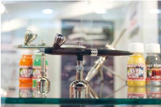
Harder & Steenbeck zeigte in Nürnberg die neue Airbrush-Pistole Evolution AL plus. Diese ist aus schwarz eloxiertem Aluminium gefertigt und mit 56 Gramm leichter als vergleichbare Modelle. Die Evolution AL plus ist im Übrigen die erste aus Alu gefertigte Airbrush-Pistole auf dem Markt und kostet 165,- Euro.
