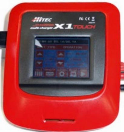
Hitec stellte das Universal-Ladegerät X1Touch (Preis 109,90 Euro) vor. Das 3,2 Zoll große, hintergrundbeleuchtete Farb-Touchdisplay des X1Touch ermöglicht eine einfache und intuitive Bedienung. Fünf Akkuspeicherplätze können personalisiert und einfach ausgewählt werden. Als weitere Besonderheit kann das Ladegerät über die Software ChargerMaster mit einem PC ferngesteuert werden. Es lädt bis 6s-Lithium-Zellen mit bis zu 7 Ampere.
