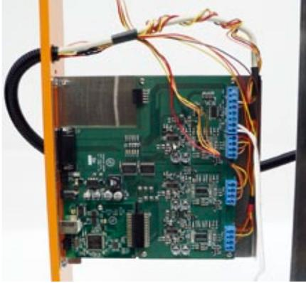
Die Motorkabel und das Kabel der beiden Endlagenschalter der X- und Z-Achse werden in einem Kunststoffschlauch geschützt unter die Maschine geleitet. Die Anleitung zeigt die Verdrahtung sehr übersichtlich und die Schraubterminals der Ansteuerungsplatine sind zudem entsprechend gekennzeichnet
