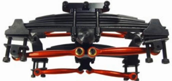
Pendelachse für Tamiya-Zugmaschinen von TTM Funktionsmodellbau
