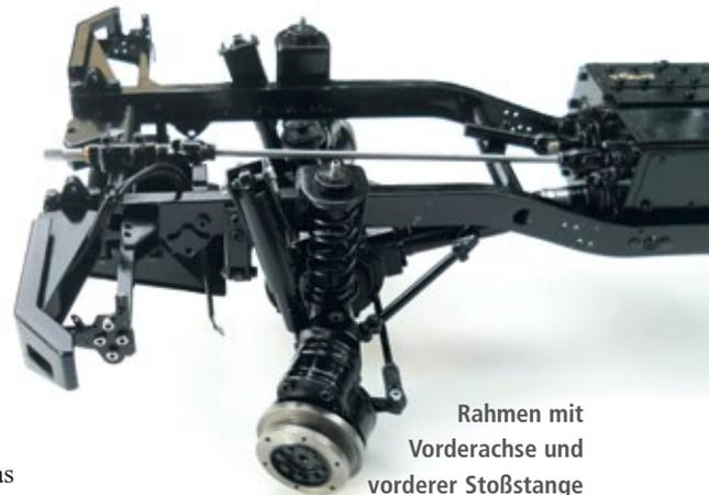
Rahmen mit Vorderachse und vorderer Stoßstange
