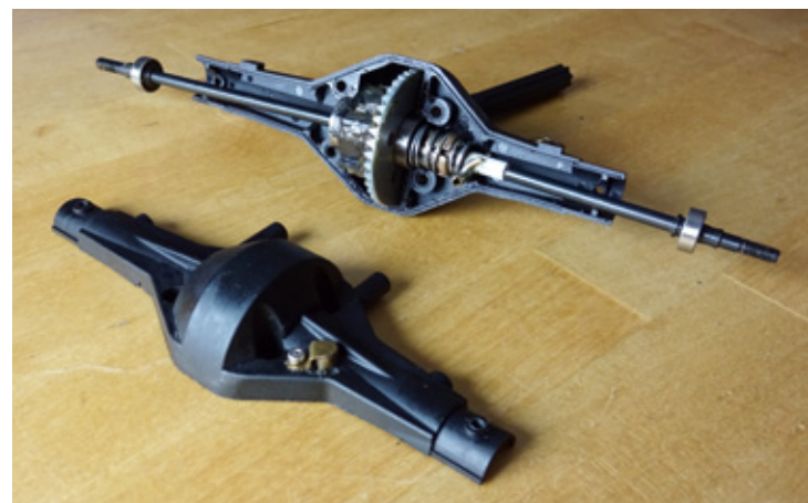
Die neuen „Innereien“ nutzen den Bauraum optimal und fügen sich exakt in das Achsgehäuse ein
