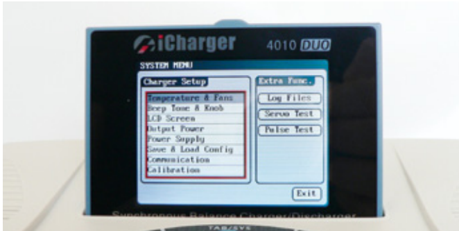
Natürlich lassen sich alle Akkuladedaten auch auf einer Micro SD-Karte speichern sowie über den USB-Anschluss am PC-Monitor darstellen. Ferner kann im Menü auch eine Begrenzung des Eingangsstroms vorgenommen werden, um Netzteile vor Schäden zu schützen
