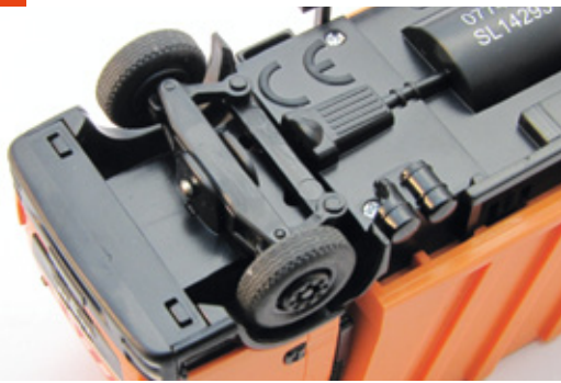
Die Vorderachse ist pendelnd gelagert und gleicht Bodenunebenheiten perfekt aus
