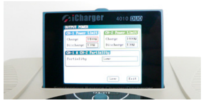
Das Lade- und Entladelimit in Watt kann je nach Ladeanschluss und Akkutyp eingestellt werden
