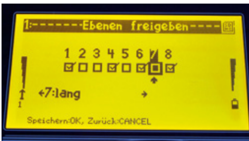
Bis zu 8 Ebenen lassen sich individuell belegen und für verschiedene Funktionen freigeben
