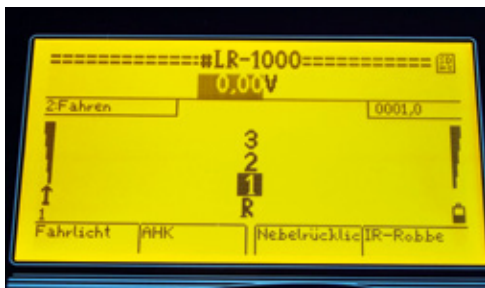
Anzeige im oberen Display beim Fahren mit dem LKW: Man sieht in der unteren Reihe die Rückmeldungen vom Fahrzeug zu Fahrlicht, Nebelrücklicht und Anhängerkupplung und in der Mitte die Position des Schaltgetriebes
