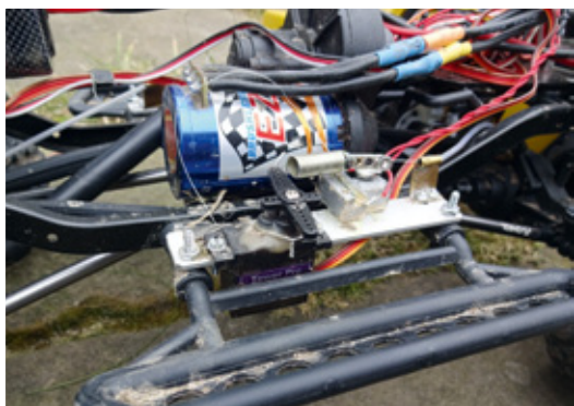
Neben der Ansteuerung der Sperre mit dem Reedkontakt für die Endstellung ist auch das reparierte Servogehäuse zu erkennen
