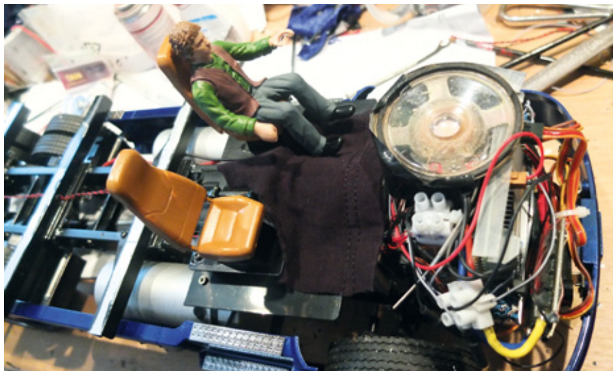
Die komplette Elektronik findet unter der Motorhaube Platz. Dabei hilft ein kleiner Bügel, welcher als zweite Ebene fungiert
