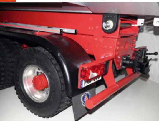
Gut zu erkennen ist der Hilfsrahmen mit dem Kipplager
