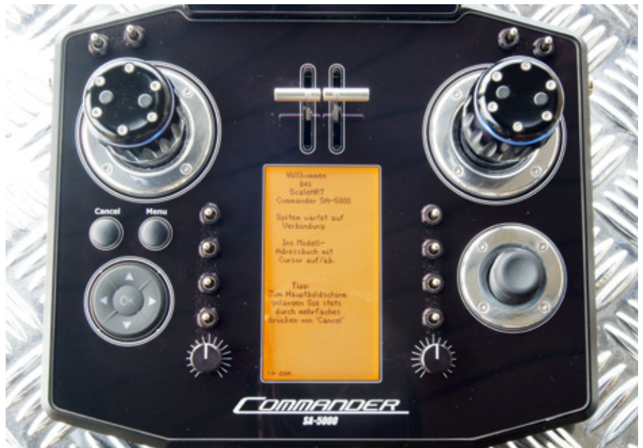
Das untere Display liefert zusätzliche Informationen. Darüber befinden sich die beiden Twinsticks für Raupenantriebe oder ähnliches
