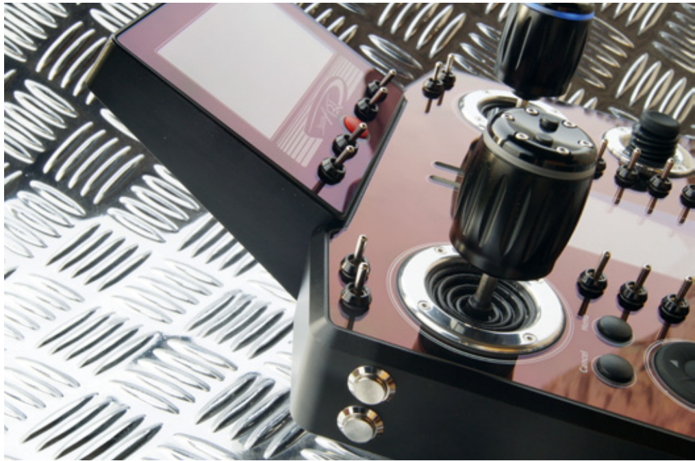
Die Taster links und rechts am Sender bieten sich an für Funktionen, die mal eben mit der Fingerspitze bedient werden wollen
