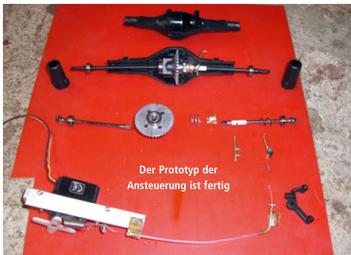
Diese Einzelteile sind notwendig: das zentrale Schiebestück als Verbindung zwischen Achswelle und Differenzialkörper
