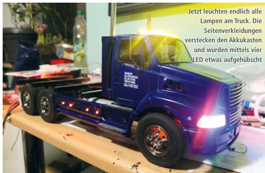
Die LED sind alle an 0,04-Quadratmillimeter-Litze gelötet worden
