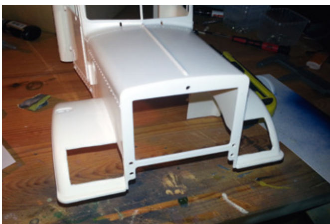
Die Umgestaltung des Fahrerhauses hat mit dem Heraustrennen der Scheinwerfergehäuse begonnen
