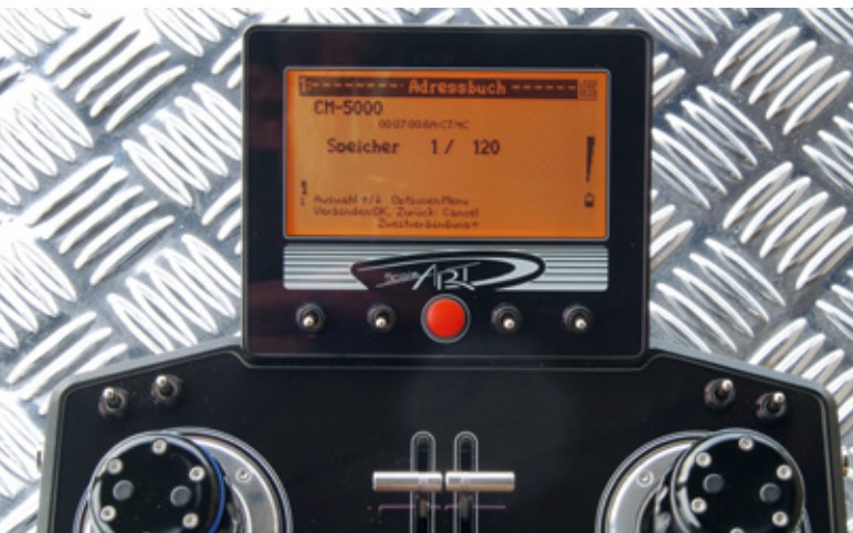
Das obere Display ist von der Größe und der Darstellung vom SA-1000 bekannt; der rote Knopf ist der Ein- und Ausschalter
