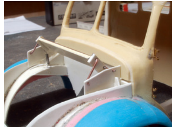
Das Walk-Fahrerhaus findet Anschluss an den Vorbau. Das Trapez-Gestänge-Scharnier macht später die Alligator-Haube beweglich
