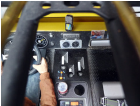
Für den Fahrer ist der Schaltzustand der Sperre jederzeit durch die eingebaute Cockpitanzeige ersichtlich
