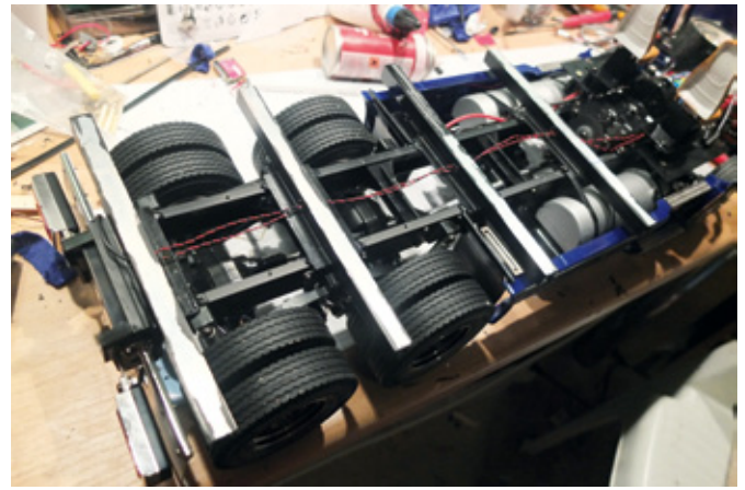
Vier Quertraversen geben dem Pritschenboden einen stabilen Unterbau
