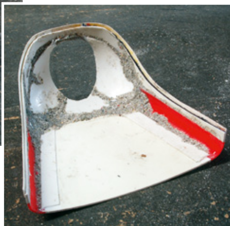
Aus neun Elementen setzt sich die Haube zusammen. Grauschimmert der Materialauftrag aus Polystyrol-Schleifstaub und flüssigem Plastikkleber
