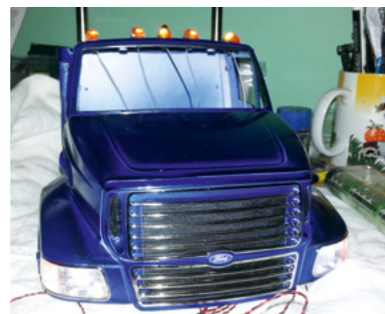
Die LED sind alle an 0,04-Quadratmillimeter-Litze gelötet worden
