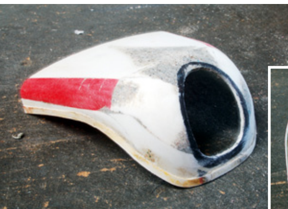
Aus neun Elementen setzt sich die Haube zusammen. Grauschimmert der Materialauftrag aus Polystyrol-Schleifstaub und flüssigem Plastikkleber
