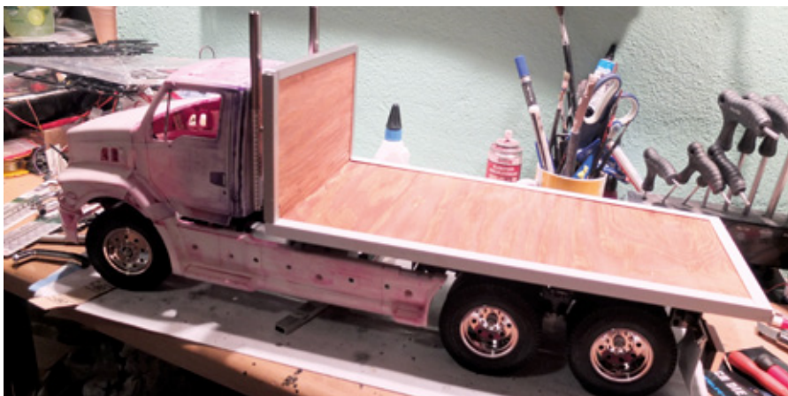
Aus 5 mm starkem Sperrholz wurden eine Stirnwand und der Boden der Pritsche gefertigt
