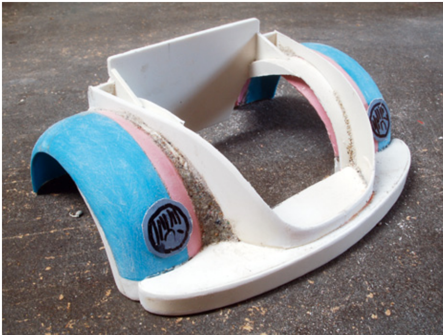
Der Vorbau entsteht unter Verwendung diverser Kunststoffformteile
