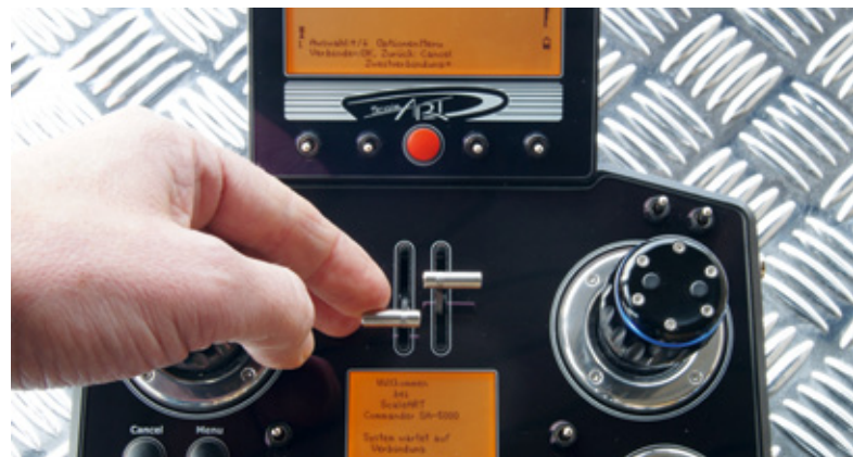
Mit den Twinsticks hat man eine zusätzliche komfortable Möglichkeit, Kettenfahrzeuge zu bewegen. Mit dem Ebenen-Umschalter kann man diese beispielsweise zum Verfahren benutzen, während beim Baggern und Laden die Backen zum Einsatz kommen
