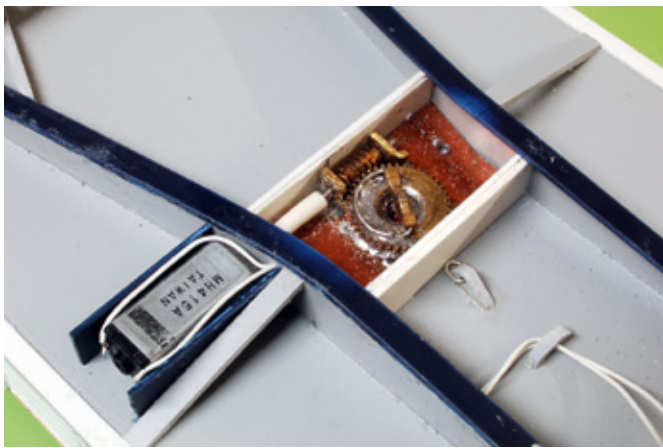
Mehrfach bewährte sich schon der „Kippantrieb von oben her“; das kleine Motörchen stemmt eine maßstäblich gewichtete Ladung in vorbildgetreuer Zeit
