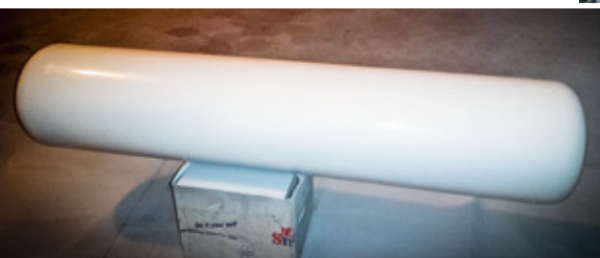
Nach dem ersten Lackieren waren keine Schweißnähte mehr zu sehen
