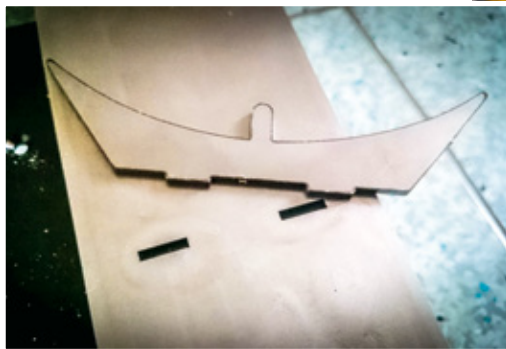
Die Halbmonde der Tankhalterung wurden von einer Spezialfirma angefertigt und sind somit passgenau
