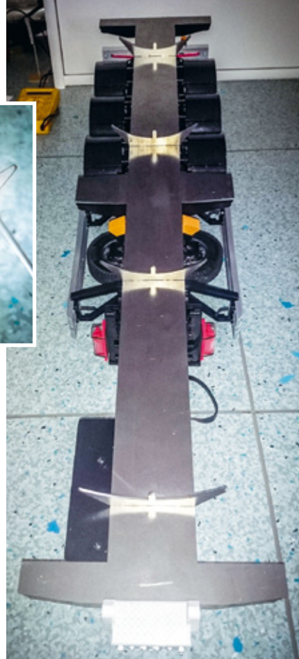
Vier dieser Halterungen fixieren die ehemaligen Feuerlöscher auf dem Chassis
