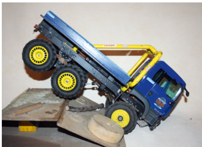
Das Heck drängt aufgrund der Kopflastigkeit in die Luft. Ballast in den letzten beiden Reifen schafft Abhilfe
