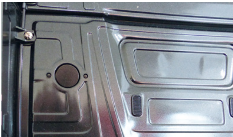
Auch wenn der Eindruck im Scheinwerferlicht täuscht, der Blindstecker in der Fahrerhausrückwand ist farblich identisch mit dem Rest
