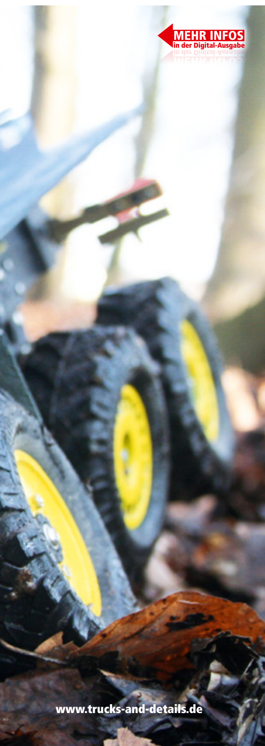
Das Heck drängt aufgrund der Kopflastigkeit in die Luft. Ballast in den letzten beiden Reifen schafft Abhilfe
