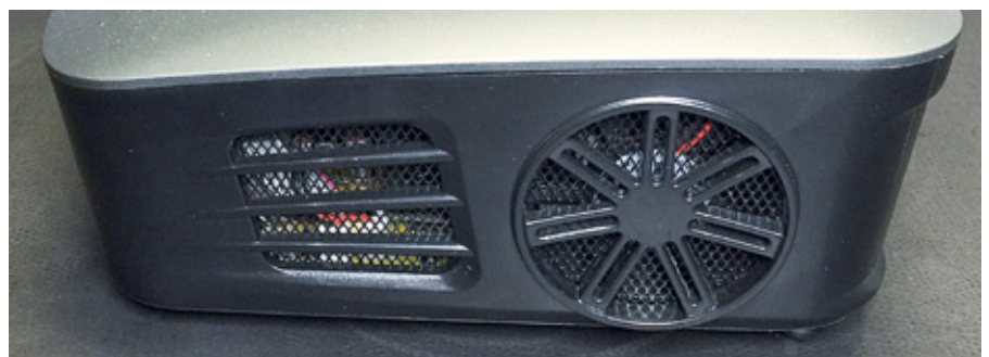
Der temperaturgeregelter Lüfter ist seitlich angeordnet und bisweilen etwas laut
