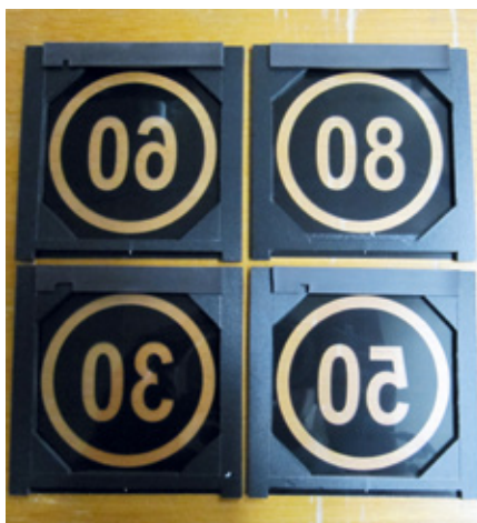
Vier verschiedene Schablonen wurden für die Anzeige der zulässigen Höchstgeschwindigkeit angefertigt
