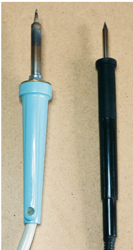
LötKolben im Vergleich: das handliche Exemplar der D200 rechts und der einer professionellen Weller-Lötstation links
