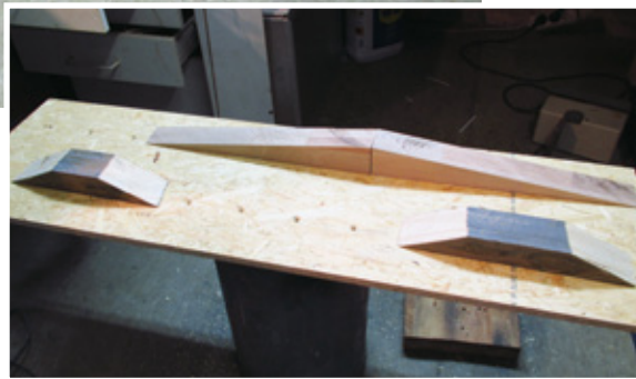
Die Verschränkungsstrecke entsteht. Auf der Unterseite der Klötze sind je zwei Holzdübel verleimt, die eine Fixierung auf der Platte ermöglichen
