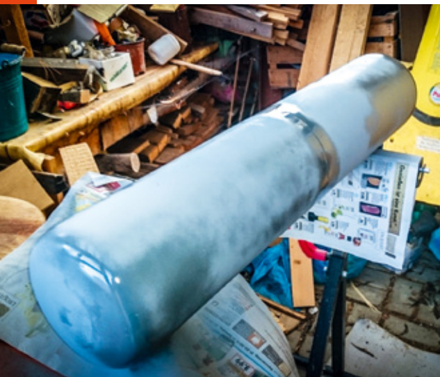
Zwei Feuerlöscher wurden zerschnitten und aneinander geschweißt. Mit gutem Ergebnis
