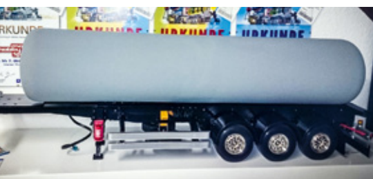
Matt grundiert passte der Tank bereits gut auf das Chassis, der Rahmen sollte noch dazu kommen
