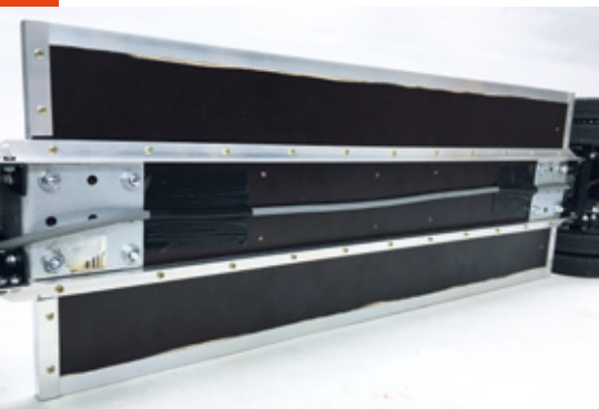
Das über die gesamte Länge verschraubte L-Profil, gepaart mit dem Eisenwinkel, verhilft dem Tiefbett zu ausreichender Steifigkeit
