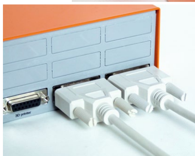
Die Rückseite der fertig aufgebauten Umschaltbox beherbergt auch die Anschlüsse für das Pneumatik-Ventil zum Ansteuern des WZW. Der Anschluss für den optional ebenfalls anschließbaren Werkzeuglängensensor komplettiert die praktische Box
