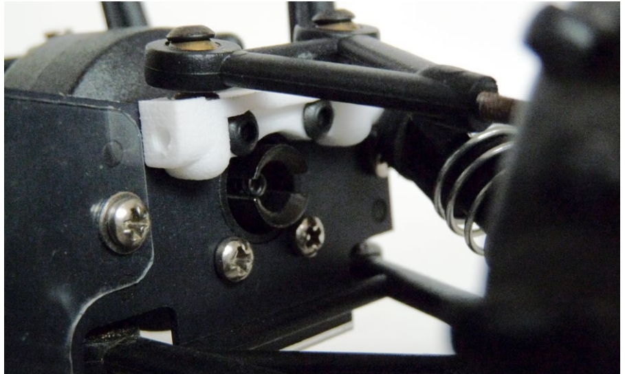
Noch vor einem eventuellen Färbegrad sollten alle Gewinde geschnitten und das eine oder andere Bohrloch auf den benötigten Durchmesser aufgerieben werden. Der (Test-) Montage am immerhin über 30 Jahre alten Modell steht dann nichts im Wege
