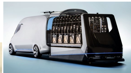
Auch ein ausgeklügeltes, vollautomatisches Ladesystem ist im Kleintransporter verbaut. Den Van selbst gibt es übrigens wirklich, bisher jedoch nur als Konzeptstudie
