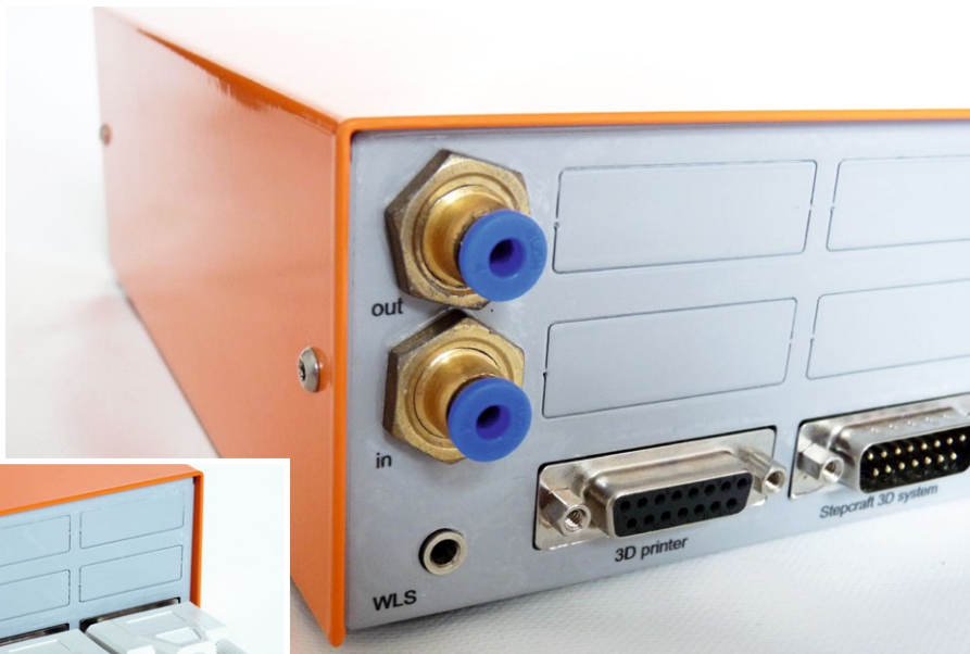
Die Rückseite der fertig aufgebauten Umschaltbox beherbergt auch die Anschlüsse für das Pneumatik-Ventil zum Ansteuern des WZW. Der Anschluss für den optional ebenfalls anschließbaren Werkzeuglängensensor komplettiert die praktische Box
