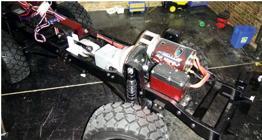
Das Beast wird über einen 55-Turns-Bürstenmotor angetrieben und verfügt über ein Zweigang-Getriebe
