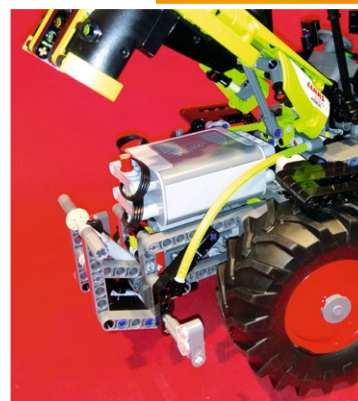
Das Batteriefach ist gut zugänglich unter der Motorhaube untergebracht
