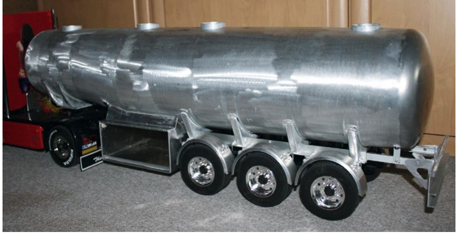
Der hintere Anfahrtschutz setzt sich aus den beiden Heckträgern, der Stoßstange und dem oberen Anfahrtschutz zusammen
