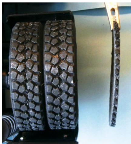
Die Doppelbereifung wurde an die Modellbreite angepasst, indem ein schmaler Streifen abgeschnitten wurde
