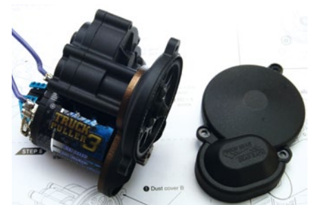
Motor und Getriebe bilden eine kompakte Einheit, die durch die Getriebeabdeckung zusätzlich geschützt wird
