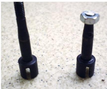
Die Achsschenkel wurden eingekürzt
