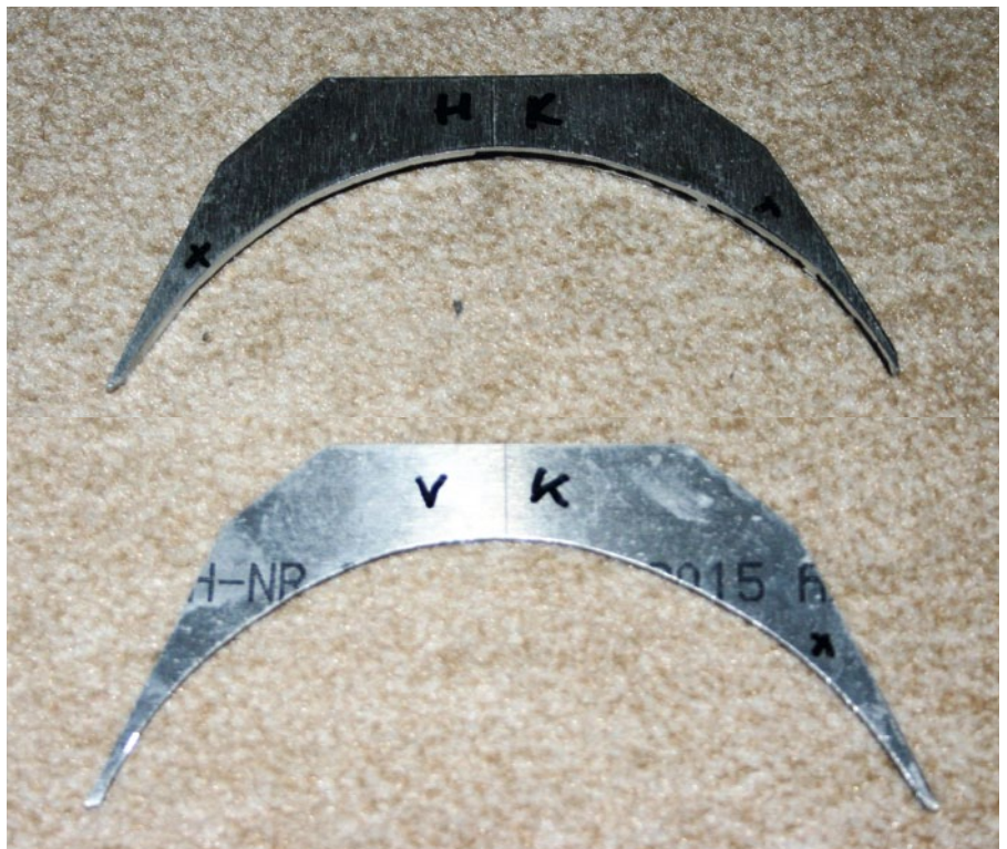
Für eine bessere Passgenauigkeit habe ich Schablonen für die beiden Königskonsolen ...
