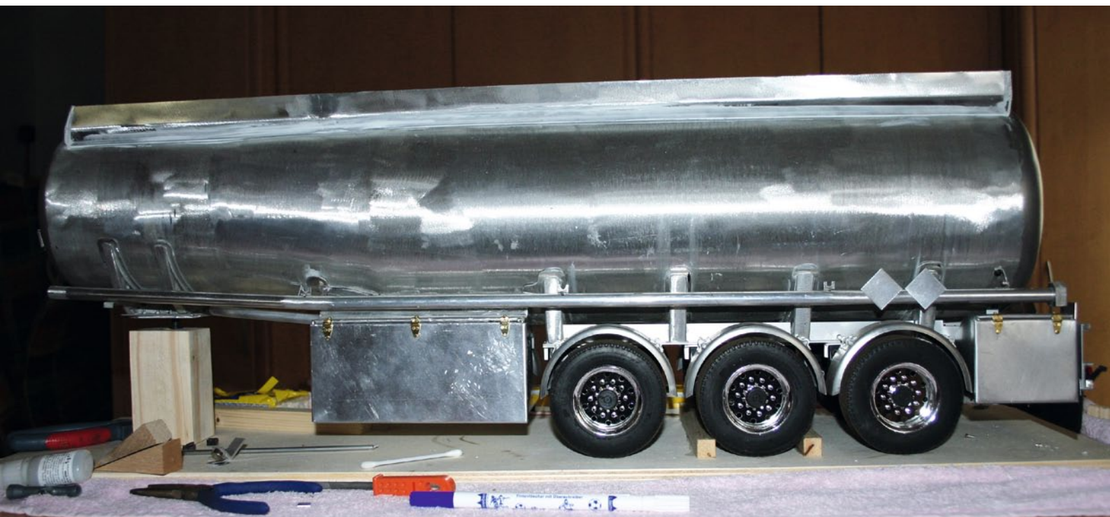
Die montierten Schlauchrohre, rechts und links, werden für die Leerschläuche zum Abpumpen des Treibstoffs an der Tankstelle benötigt
