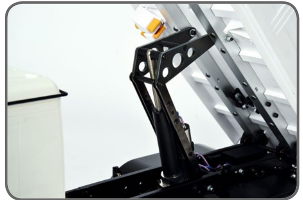
Die einteilig aus verstärktem Kunststoff gespritzte Kippbrücke wird mit dem Fahrgestell verschraubt
