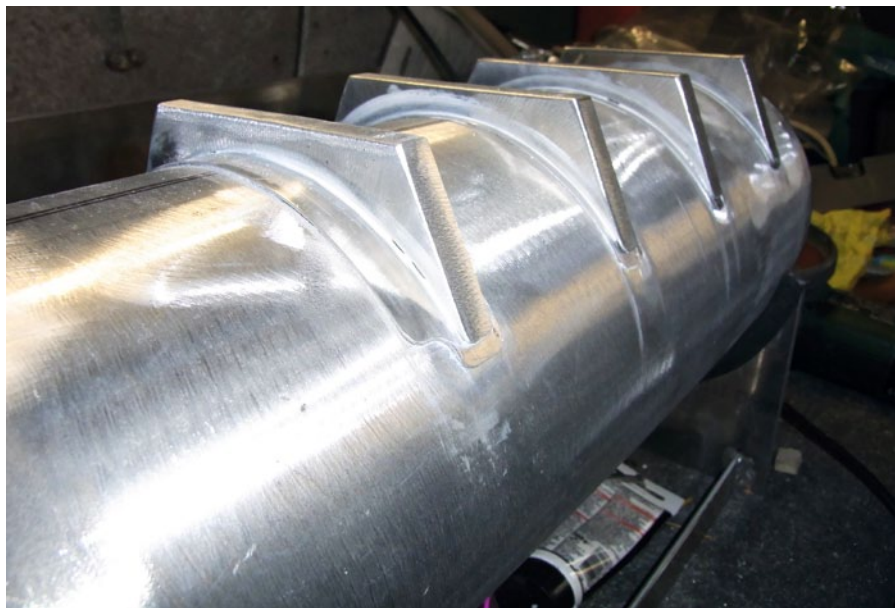
Um die Stabilität des Fahrwerks zu erhöhen, werden die Konsolen benötigt
