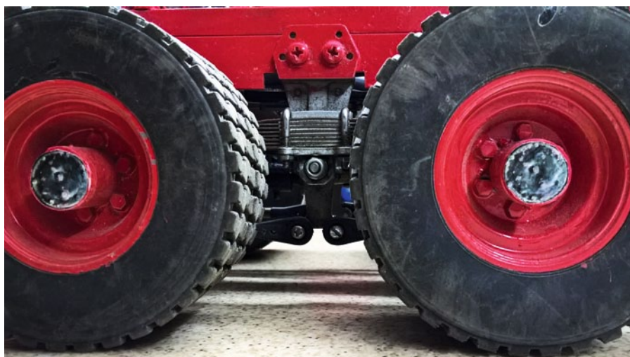
Eine einfache Blattfeder musste beim Magirus genügen
