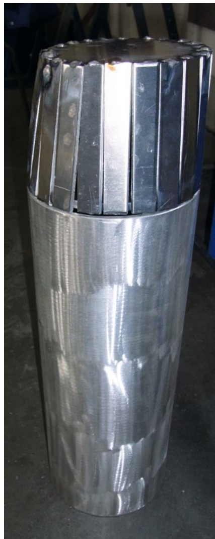
Damit die Form des Rohtanks mit dem Original übereinstimmt, wurde der steile Konus zur Probe darauf gesetzt
