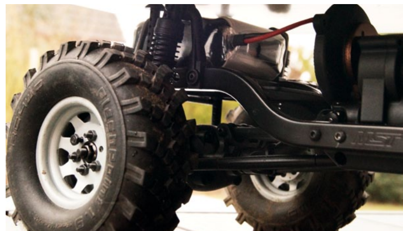
Zwischen Rahmen und Pritsche ist genug Platz für wahlweise einen 3s-LiPo oder den hier zu sehenden zehnzelligen NiMH Eneloop
