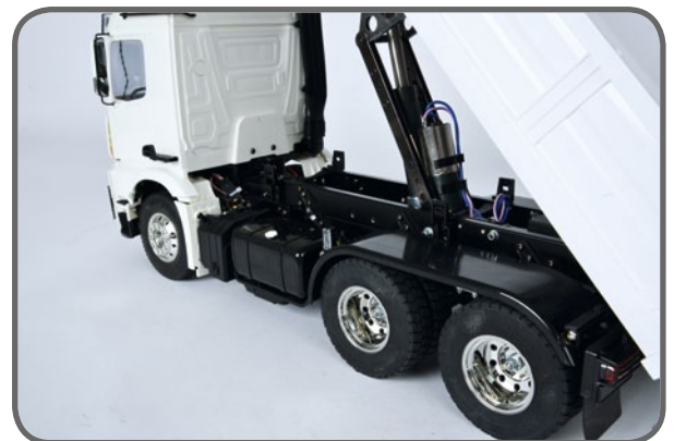
Das bewährte Dreiachs-Chassis wurde mit einem Zusatzrahmen zur Aufnahme der Mulde verstärkt
