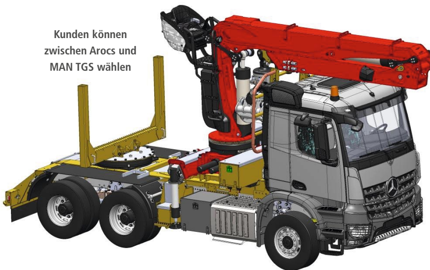
Die Rungen sind höhenverstellbar, um auf die Beladungsmenge reagieren zu können
