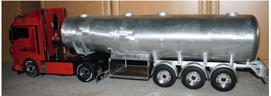
Das Schürzenblech und der obere Anfahrtschutz sind komplett montiert
