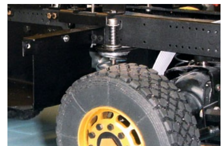
Über dem Vorderrad ist eine von insgesamt vier Schrauben zu sehen, mit denen der Federweg manuell justiert werden kann
