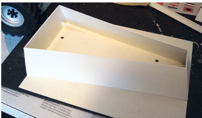
Die Alibi-Pritsche mit den seitlichen Werbeträgern entstand in kurzer Zeit aus zwei verschiedenen starken Polystyrol-Platten; über die Löcher wird die Pritsche auf die Karosseriebefestigungen am Rahmen geschoben und arretiert
