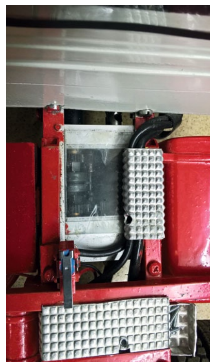
Getriebeabdeckung mit Durchblick zur besseren Einstellung
