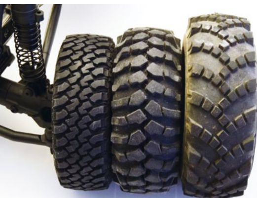
Diese drei Reifen standen zur Auswahl: neben dem Baukastentyp (links) ein 3,75 Zoll No-Name-Trial-Komplettad (Mitte) und daneben der 105 mm Flashpoint
