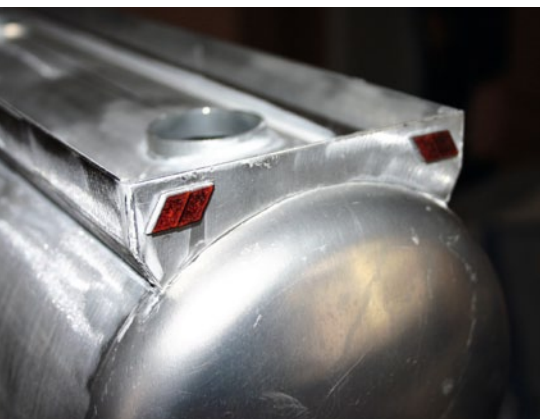
Die Domwanne soll verhindern, dass Kraftstoffe beim Befüllen ins Erdreich laufen
