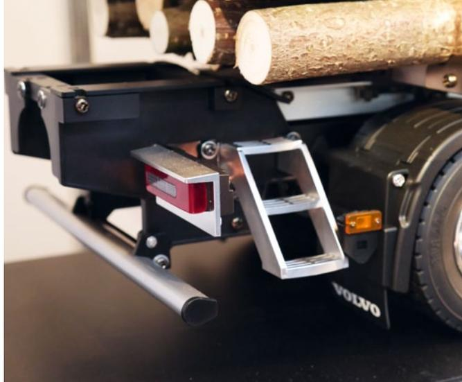
Um die Rückleuchten mit der optional empfohlenen MFC03 steuern zu können, sind aufgrund der Länge des Modells spezielle LED mit verlängerten Kabeln aus dem Tamiya-Zubehörprogramm erforderlich
