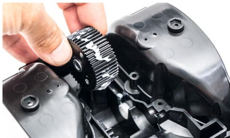
Hier sieht man, dass vor dem Einbau des vorderen Kegeldifferenzials die weißen Lagerbuchsen im Wannenchassis eingesetzt wurden
