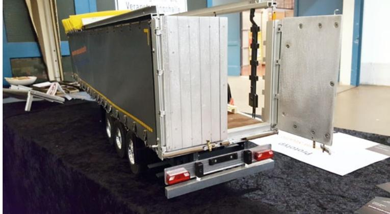
Wie beim Original werden die Hecktüren geöffnet, um die Schiebedachverriegelung zu lösen und das Verdeck nach vorne zu schieben
