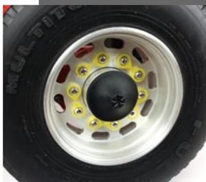
**Auf die montierten Schrauben werden die Radmutterindikatoren von Comvec-Modellbau gedrückt**
