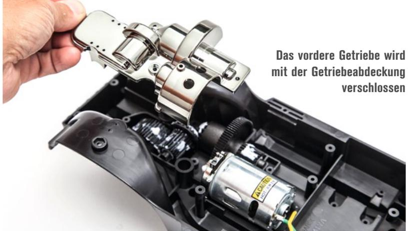
Das vordere Getriebe wird mit der Getriebeabdeckung verschlossen
