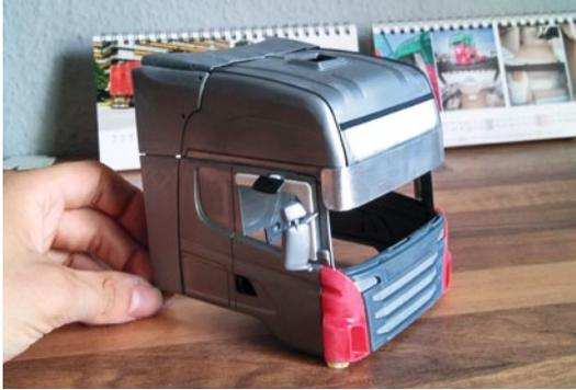
**Auch bei der Fahrerkabine sind fast alle Teile Marke Eigenbau: Die Windabweiser, das vordere Leuchtschild und die Klimaanlage auf dem Dach bestehen aus PS. Die Sonnenblende ist aus Alublech gefertigt**
