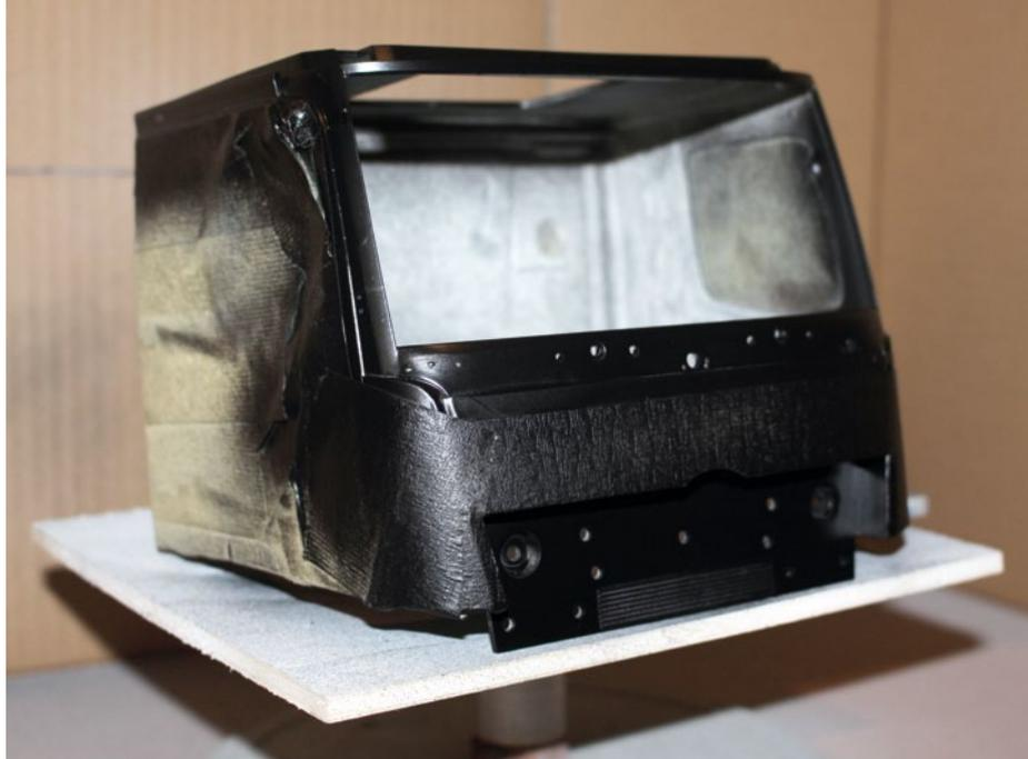
**Gerade größere Teile sollten auf einer drehbaren Scheibe lackiert werden. So ist es möglich, den Lackierwinkel zu verändern, ohne Fingerabdrücke im frischen Lack zu hinterlassen**
