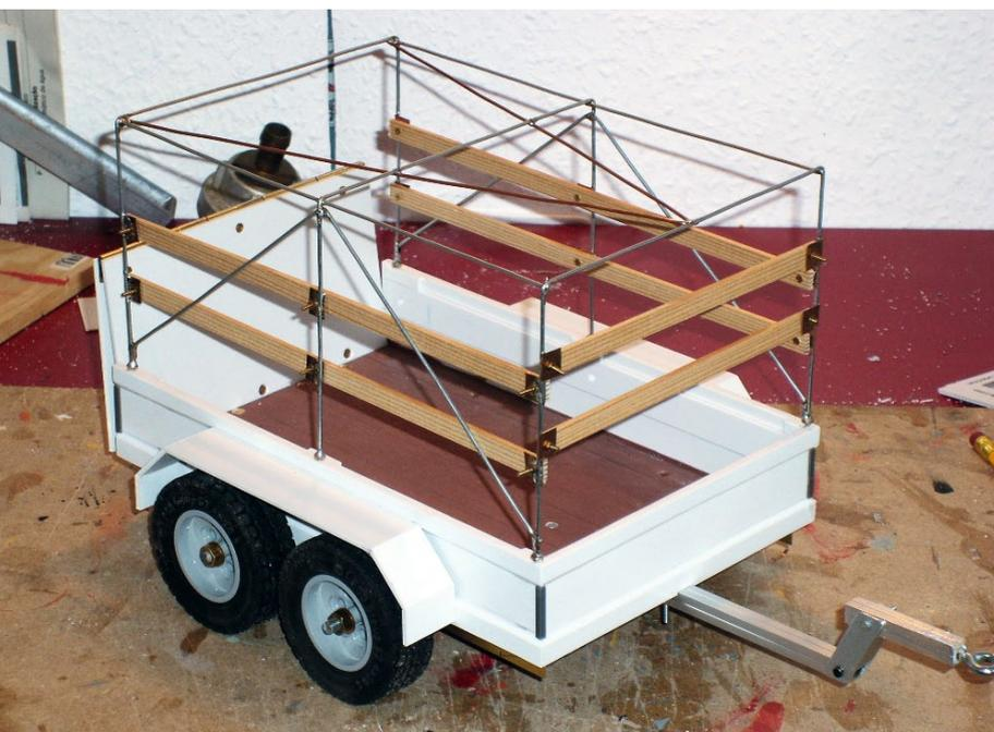
Als Basis für den Hänger dient eine 3-mm-Sperrholzplatte. Die Räder stammen von Lego. Ein Alu-Vierkantrohr in Verbindung mit einer M4-Ringschraube dient als Deichsel. Die Bordwände bestehen aus Polystyrolplatten, die mit der Bodenplatte verklebt sind
