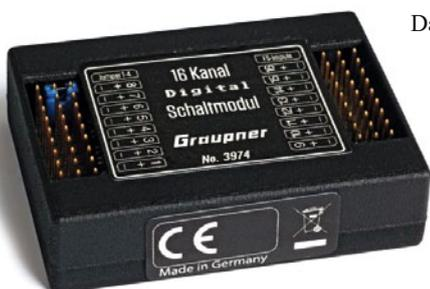
Das 16-Kanal-Digital-Schaltmodul von Graupner passt zur mz-16 HoTT und zur mz-32. Es ist SUMD 3-fähig und löst das alte Multikanal-Nautik-Modul ab. Ohne Zeitverzögerung können bis zu 16 Funktionen auf dem Touchscreen geschaltet werden. Für jeden einzelnen Kanal kann zwischen drei verschiedenen Betriebsmodi gewählt werden: Schalten (ein/aus), Blinken, Impuls (Hupe oder Lichtsignal). Das Modul wird in Deutschland hergestellt und kostet 129,99 Euro.
