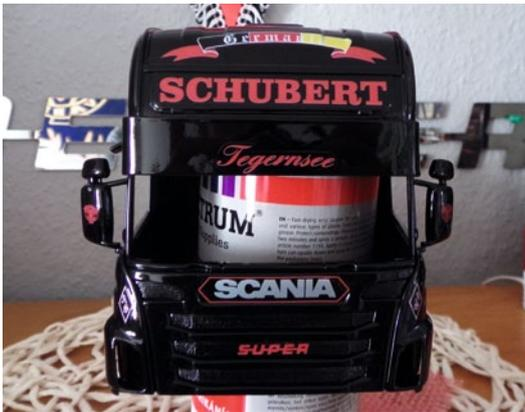
**Die Kabine, zum Trocknen aufgestellt, nachdem die erste Schicht Klarlack aufgetragen ist. Insgesamt wurde die Kabine mit drei Schichten Klarlack versiegelt**
