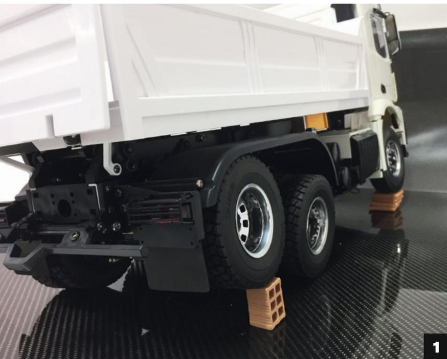
1) Dank der Federaufhängung behalten die Räder auch bei beachtlicher Achsverschrängung noch Bodenkontakt und können so ihre Antriebswirkung entfalten. 2) Mit Paket 1 wird aus der gelenkten eine angetriebene Vorderachse. 3) Mit dem Antriebspaket 2 lässt sich ein kraftvoller Allradantrieb mit Federaufhängung in Tamiyas Arocs-Hinterkipper implementieren
