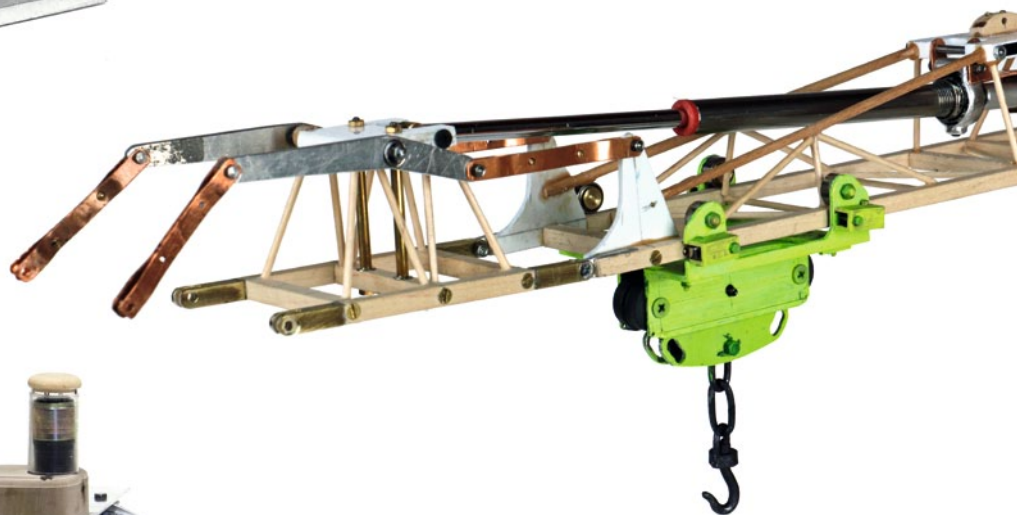
Das Verbindungsstück mit Gestänge und Einklappantrieb. Unten hängt die Laufkatze mit dem Haken, noch ohne Seil
