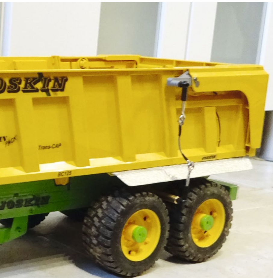
Auch die weiße Aufnahme für Trapezspindel und Getriebemotor ist im 3D-Drucker entstanden
