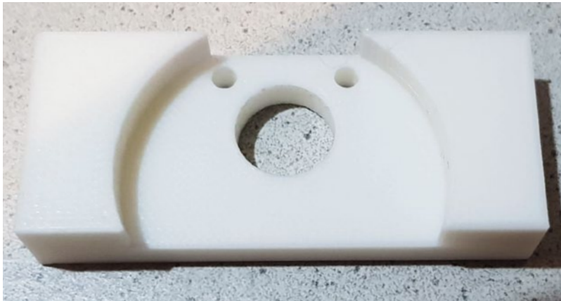
Auch die weiße Aufnahme für Trapezspindel und Getriebemotor ist im 3D-Drucker entstanden
