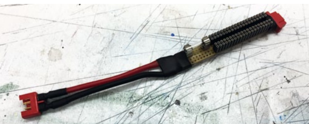
Selbst gebaute Hauptverteilerplatine, zum Anschluss des Akku, mit Sicherung und Weiterleitung an den Regler. Über die Pinleisten können Nebenverbraucher mit 12 Volt versorgt werden
