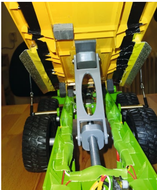
Das fertige Fahrwerk mit aufgestellter Kippermulde
