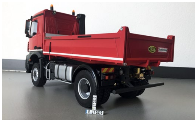
Rückansicht des Fahrzeugs mit vielen Details. Gut zu sehen sind die Verriegelungshaken der hinteren Bordwand
