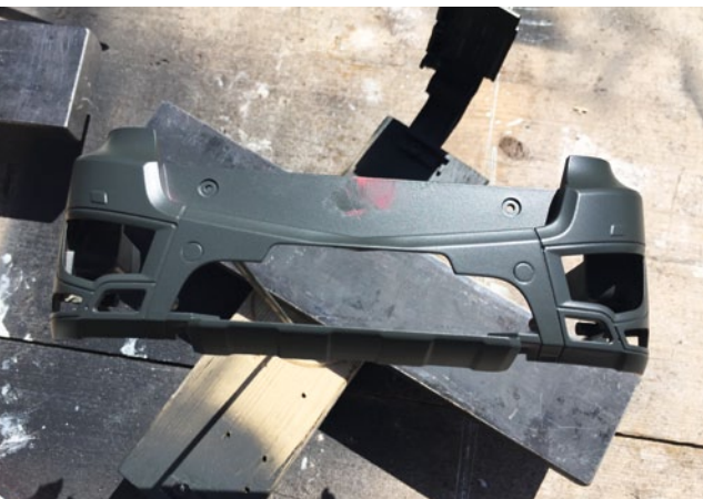
Die Stoßstange bekam eine Lackschicht aus Bumperspray
