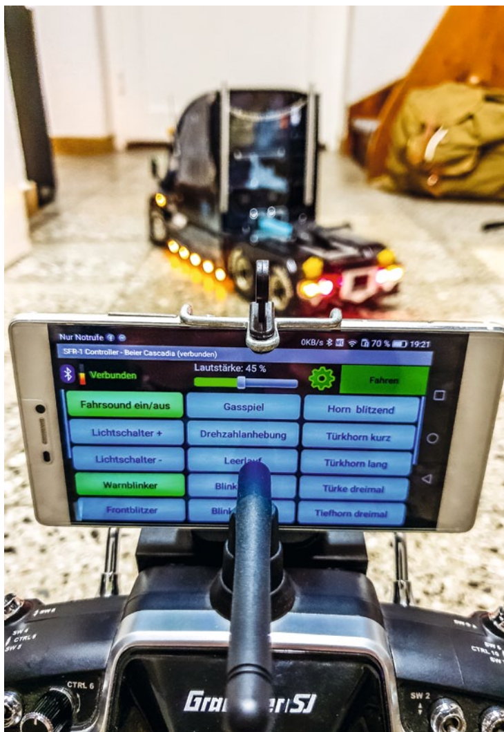
Auf der Fernsteuerung sitzt das Handy, über das sich per Bluetooth-BTC-1 das Modul steuern lässt
