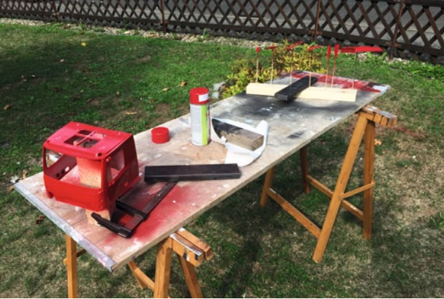
Das Lackieren der Kabinen- und Anbauteile erfolgte bei schönstem Wetter. Wichtig ist die ordentliche Vorbereitung der zu lackierenden Oberflächen
