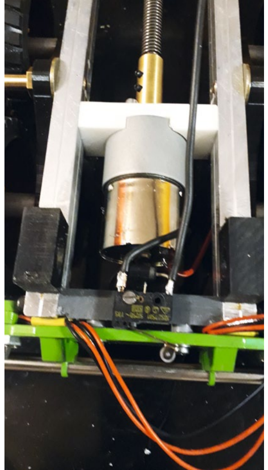
Der Fahrwerksrahmen ist aus einem Aluminiumhohlprofil gefertigt und am hinteren Ende mit zwei Lagerbolzen zum Kippen verbunden
