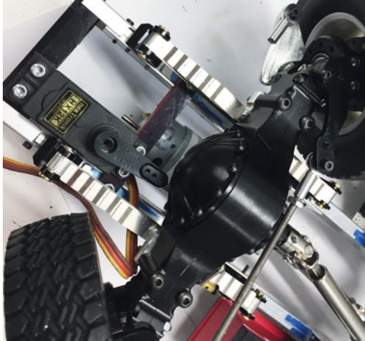
Montage des Lenkservos im Rahmen mittels selbst gebautem Querträger
