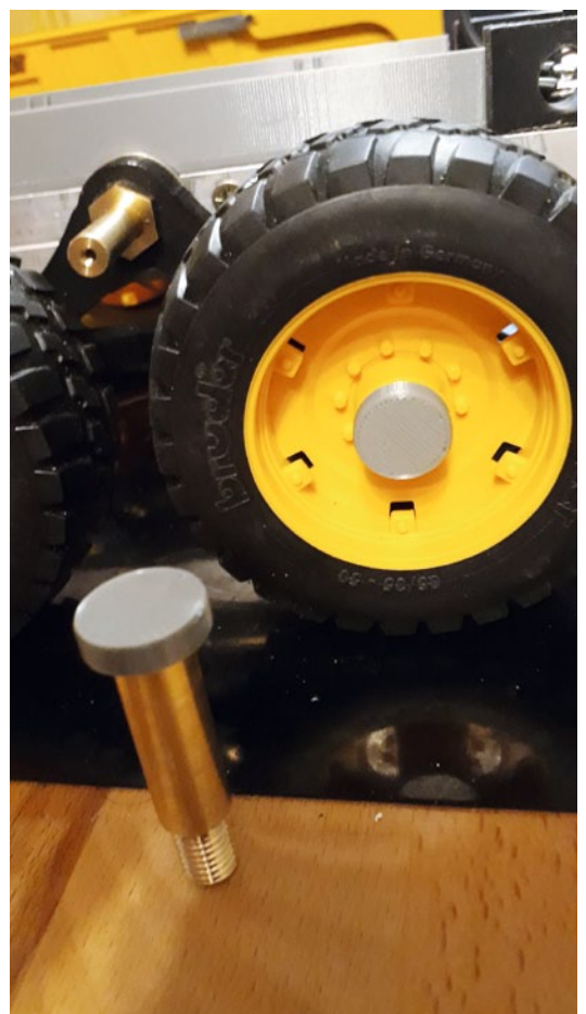
Messingwellen dienen als Achsen und öffnen in Verlängerung die Kippmulde
