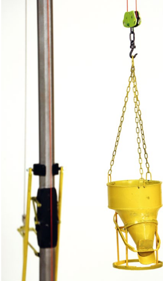
Der Schüttkübel ist aus Kunststoff gefertigt – das Oberteil ist ein Stück Abflussrohr, der Kegel ein Zuschnittteil
