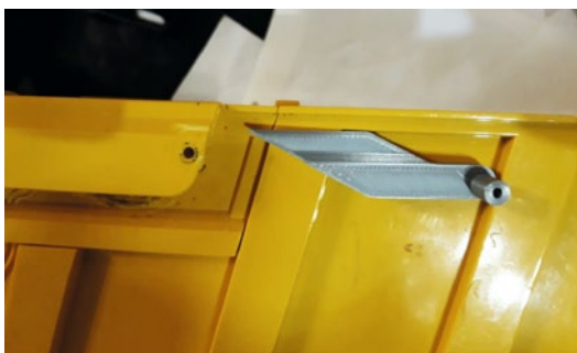
Damit sich die Kipperklappe automatisch öffnet, wurden zwei Teile im 3D-Drucker so angepasst, dass sie genau in die Aussparungen der Klappe passen und mit M3-Schrauben gesichert werden können
