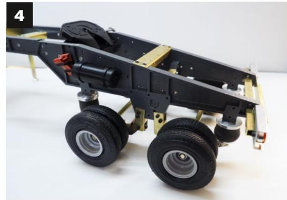
Hier fehlten 2-3 mm in den gefrästen Löchern. Die gefrästen Aufnahmen für Quertraversen in den beiden Seitenteilen waren zu klein. Die Breite des Rahmens war auf 62 mm ausgelegt. Da der Rahmen bei meinem Vorbild aber breiter ist, musste ich die Quertraversen verlängern oder neu anfertigen.
