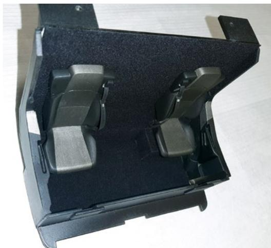
Das Fahrerhaus ist als eine Art Einsatz gefertigt, in dem der gesamte Innenraum installiert ist
