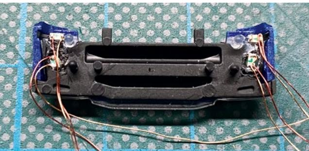
Zur Realisierung der Lichtfunktionen kamen fast drei Dutzend SMD-LEDs zum Einsatz
