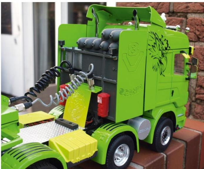
Die elektrischen Anschlüsse an der Zugmaschine
