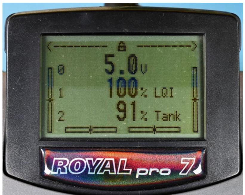
Direkt nach dem Einschalten wird diese Anzeige des LiPo-Savers Adresse 2 für zirka 10 Sekunden gezeigt (Akkuladezustand in %)
