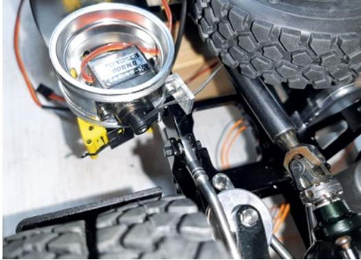
Um möglichst keine Kabel oder Servos im inneren Bereich des Rahmens liegen zu lassen, kam ein Servo für die Differenzialsperren ins Reserverad
