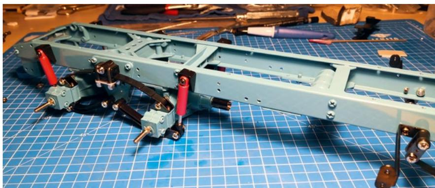
Das Chassis wurde bis auf die hintere Achsaufhängung Out Of Box zusammengesetzt. Die letzte Achse wird am Original geliftet. Beide Achsen wurden getrennt voneinander mit Luftfederattrappen aufgehängt
