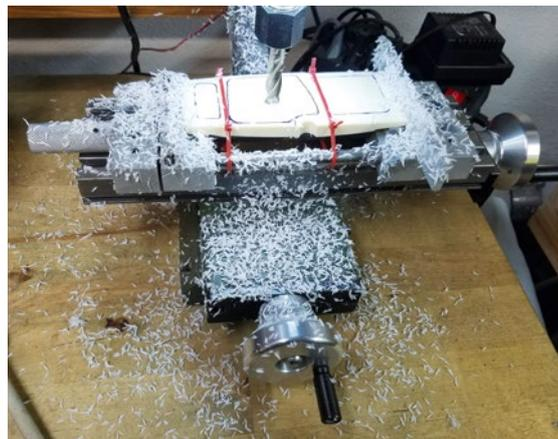
An den Hecktüren des Kastenaufbaus wurden die Innenseiten für eine Holzverkleidung ausgefräst
