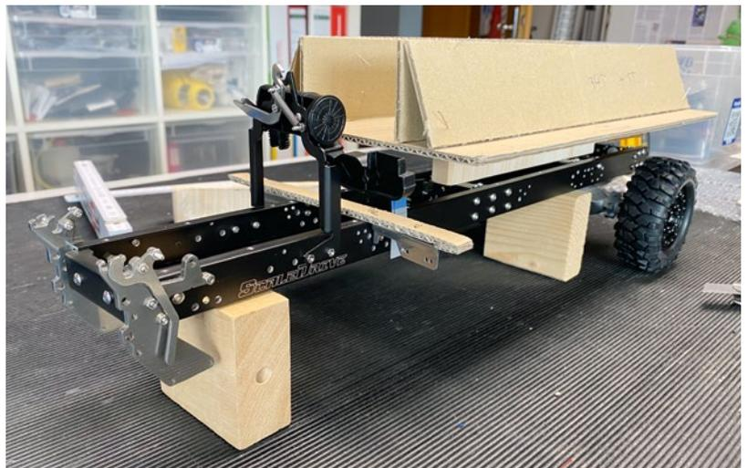
Der Pritschenaufbau-Prototyp entstand zunächst aus Karton
