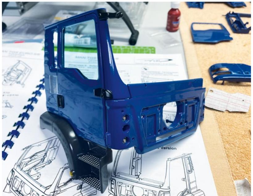
Für die Seitenwände des Fahrerhauses stand erst die Demontage der Türscharniere an
