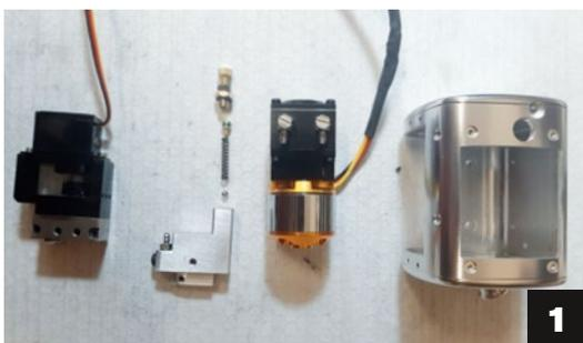
1) Das Unterbringen der Hydraulikkomponenten im Auspuff stellte eine große Herausforderung dar, mussten doch eine Pumpe mit Brushless-Motor, ein Ventil und ein Druckbegrenzungsventil dort hineinpassen. 2) Die Lösung: Ein Druckbegrenzungsventil, das gleichzeitig als Verteilerblock fungiert. Um den Druck beim Justieren regulieren zu können und die Komponenten nicht zu überlasten, entstand noch ein Druckmessanschluss für ein optionales Manometer
