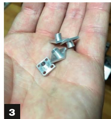
1) Die Befestigung für die Radkästen ist selbstgebaut. Zunächst wurde ein Zapfen an das Alu-Rundmaterial angedreht, ... 2) ... das eine 3-mm-Bohrung für die Schutzblechhalterung erhielt und abgestochen wurde. 3) Anschließend hieß es, das Vierkantteil abzufräsen und Löcher zu bohren für die M2-Modellschrauben
