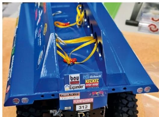
Die Pritsche wurde final verklebt und verschliffen und bekam dabei Gebrauchsspuren mit eingeschliffen, die die „used“-Optik der Ladefläche unterstreichen sollten
