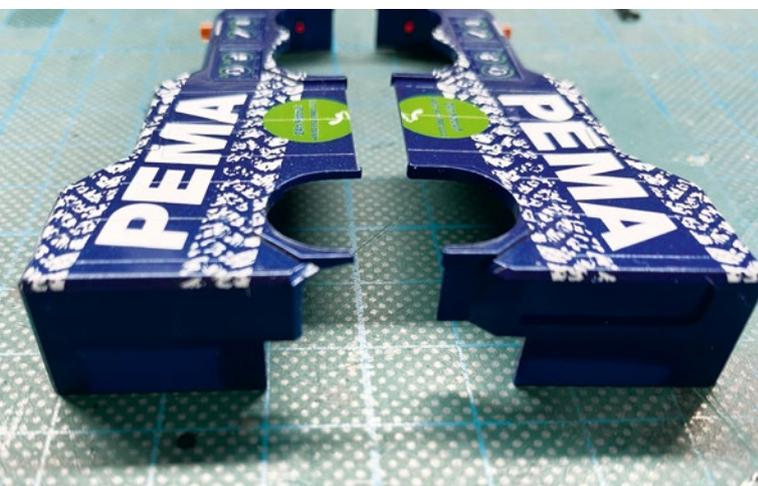
Spätestens beim Anbau der Seitenverkleidungen wird deutlich, ob man bei der Montage der Achsen sauber gearbeitet hat
