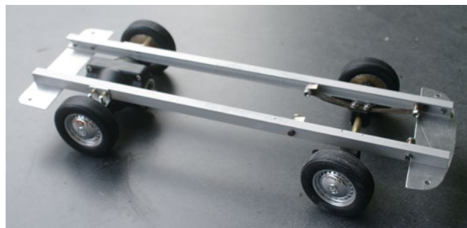
Das Fahrgestell besteht aus einem U-Profil mit zwei Achsen
