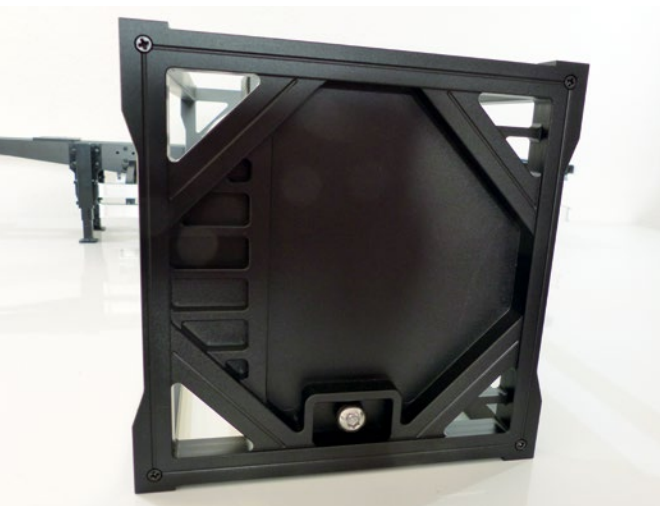
Sauber gefräste Seitenteile des Flüssigkeits-Containers
