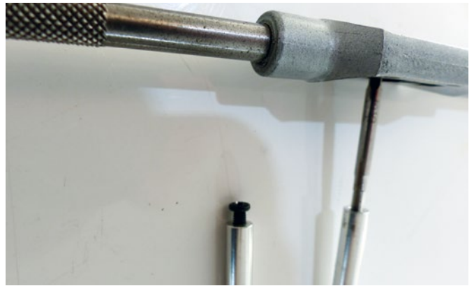
Einsatz des 3-mm-Gewindebohrers zur einfacheren Montage
