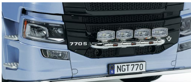
Auch der Kühlergrill hat Lampenbügel
