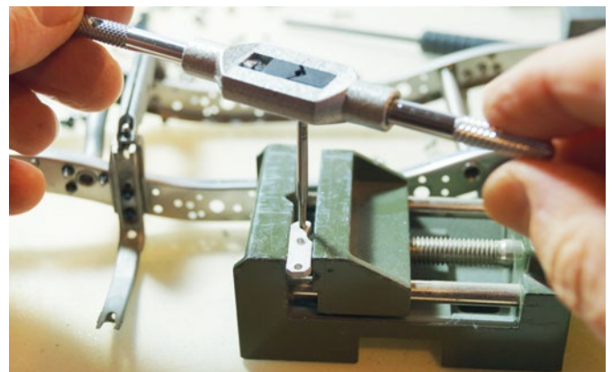
Hin und wieder muss der M2-Gewindeschneider nachhelfen, bevor die Schraube abreißt
