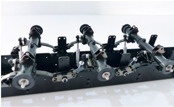
Die Blattfederung funktioniert über Wippen
