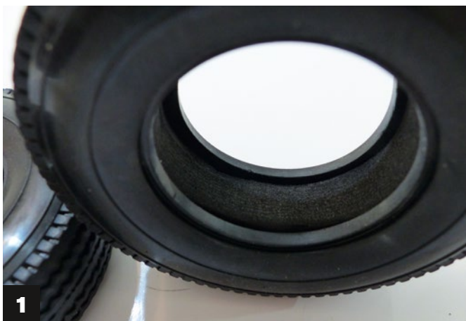
1) Ein Vorteil bei schweren Lasten sind die Schaumstoffeinlagen in den Reifen. 2) Passgenauigkeit bei allen Bohrlöchern
