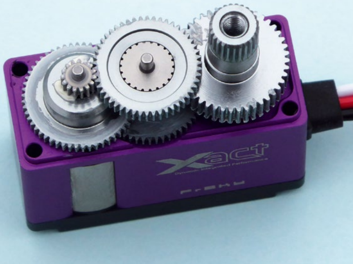
Mehrfache Kugellagerung und ein hochwertiges Servogetriebe sind charakteristisch für das Digitalservo
