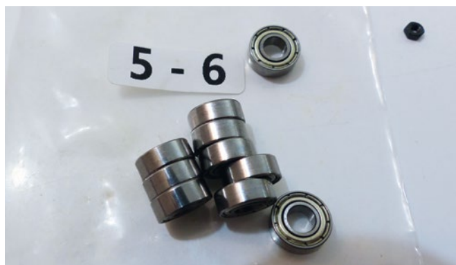
Ein Pluspunkt sind die Kugellager statt Plastikhülsen für einen sauberen Rundlauf der Achsen
