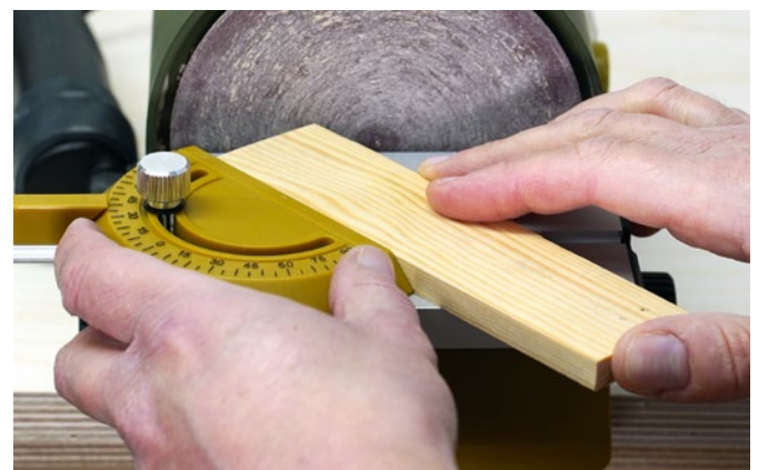
Dank des beiliegenden Anschlagwinkels sind Schrägen zwischen 1° und 89° und auch rechte Winkel realisierbar
