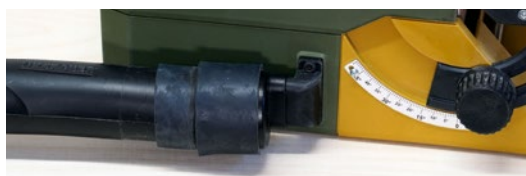
Im Winkel von -10^{\circ} bis 50^{\circ} lässt sich der 98 x 140 mm große Alu-Arbeitstisch verstellen – eine Skala zeigt das exakt an
