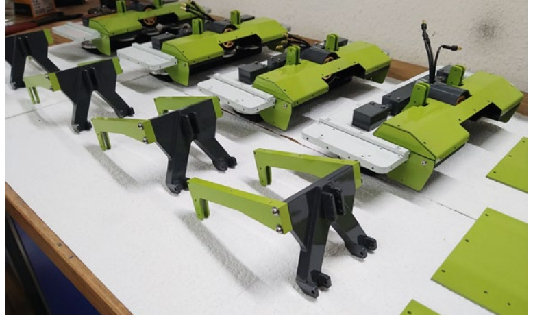
Montage der ersten lackierten Mähwerke
