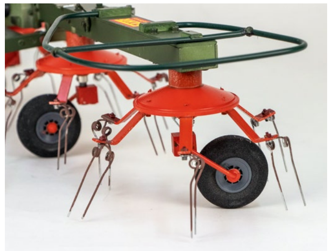
Ein fertiges Schleuderrad mit Lauftrad und Sicherheitsbügel
