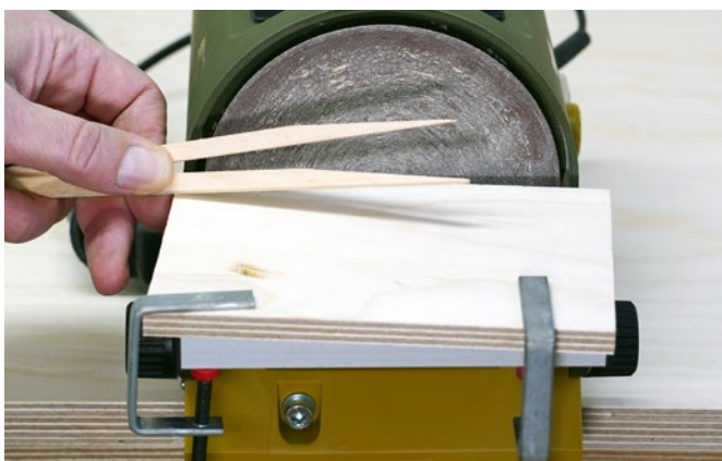
Mit Hilfswerkzeugen wie einem fixierten Brett kann man lange Schrägen zum Schäften schleifen
