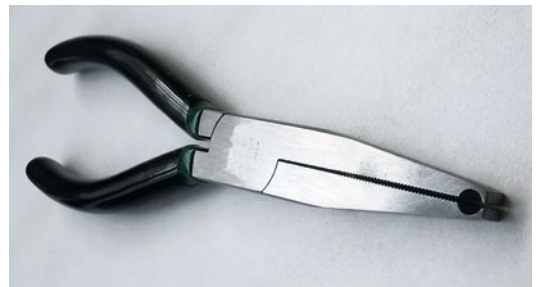
Die Zangen für Hydraulik-Schläuche gibt es für 3 und 4-Millimeter-Schläuche
