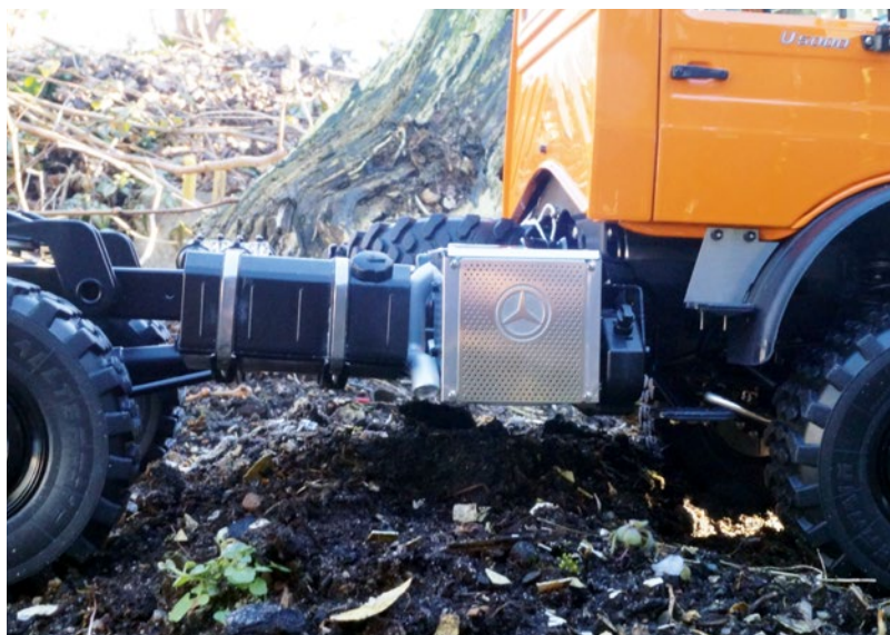
Die Bauchfreiheit im Gelände ist enorm und erlaubt neben den guten Offroad-Eigenschaften auch den Anbau von Geräten in diesem Bereich
