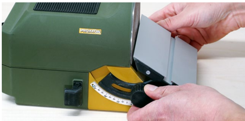
Im Winkel von -10^{\circ} bis 50^{\circ} lässt sich der 98 x 140 mm große Alu-Arbeitstisch verstellen – eine Skala zeigt das exakt an
