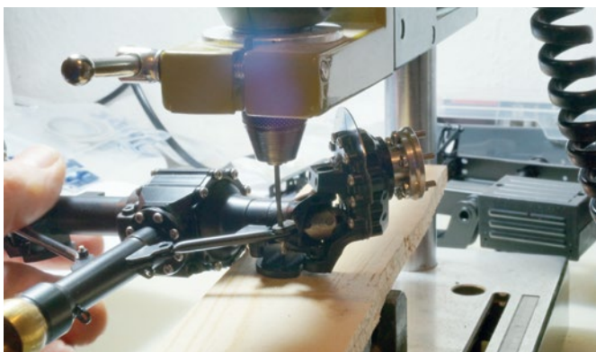
Auch wenn es schmerzt: An den Achsen müssen die Bohrungen von Streben und Achsen deckungsgleich nachgebohrt werden
