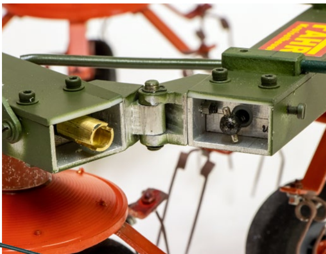
Gelenk der Triebwellen im Faltbereich des Rahmens
