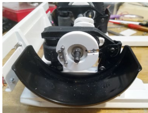
Die im Bau befindliche Trommelbremse
