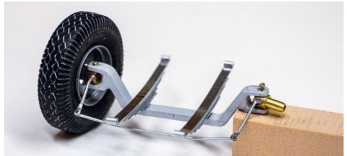
Die Vorderachse mit Träger aus Kunststoff und Metallgelenkteilen. Die Spurstangengelenke sind, gut beweglich, mit eingelöteten Nägelchen (0,7 mm dick) verbunden
