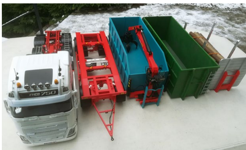
Das fertige Abroll-System im Gesamtüberblick
