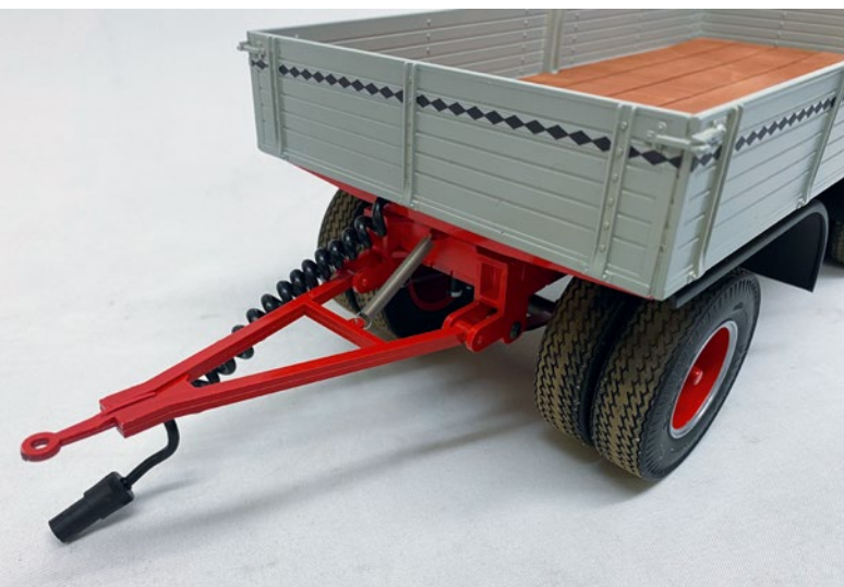
Die verstärkte Deichsel wird von einer Feder in der Waagerechten gehalten
