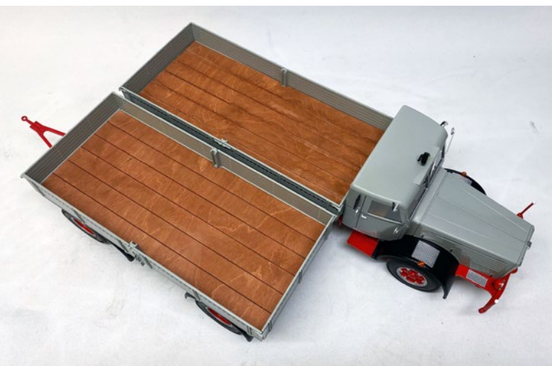
Der Holzboden wurde vor dem einkleben gebeizt, um ihn optisch stimmiger wirken zu lassen
