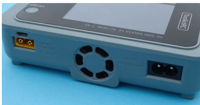
Rückseitig befinden sich die Anschlüsse für die Eingangsspannungen und der Mikro-USB-Port sowie ein kräftiger, relativ leiser Lüfter
