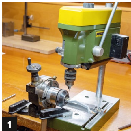
1) Das Bohren des Lochs für den 1 mm dicken Lenkzapfen unter 6 Grad Schräge im Achsträger aus Messing mit einer sehr komplizierten Aufspannung. 2) Der Fahrzeugboden mit einem ersten Seitenwandteil und der Aufnahme für das Reserverad
