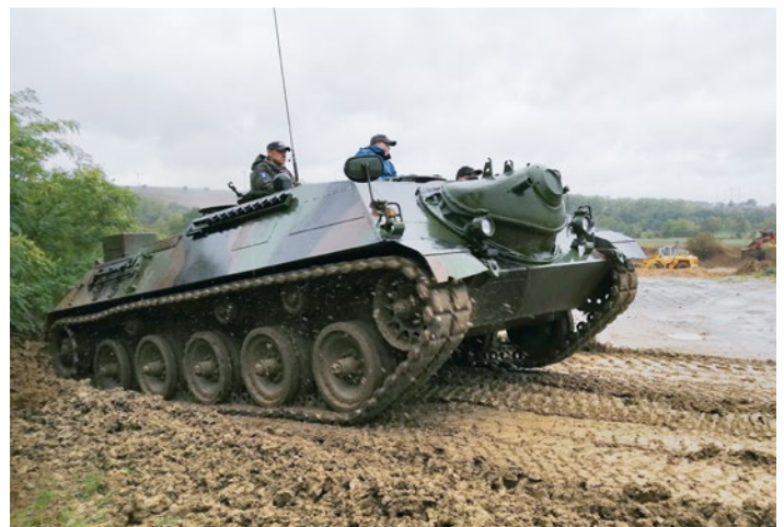
Mit einer Masse von 25,7 t war an diesem Tag der Kanonenjagdpanzer das zweitschwerste Fahrzeug, welches in Stammheim am Start war
