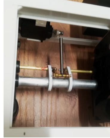
So sieht das Brems-servo mit Feder aus
