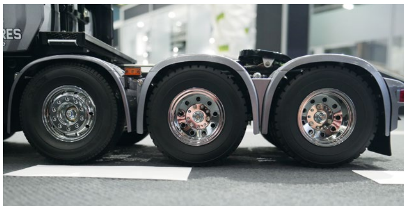
Die zweite Lenkachse ist liftbar ausgeführt
