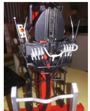
Die Schlauchführung bei den Steuerventilen
