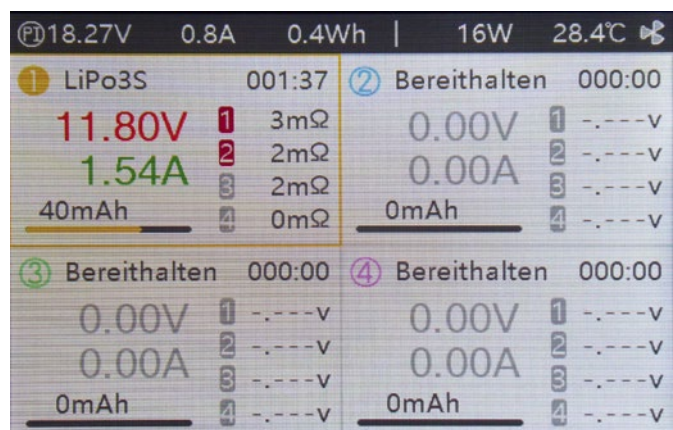
... dazu gehört auch die präzise Angabe der Innenwiderstände der Zellen
