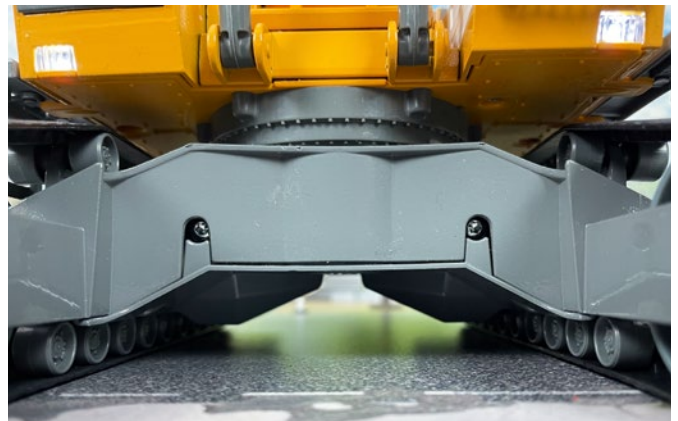
Der Unterwagen besteht größtenteils aus Metall, der Drehkranz ermöglicht eine Endlosdrehung des Oberwagens
