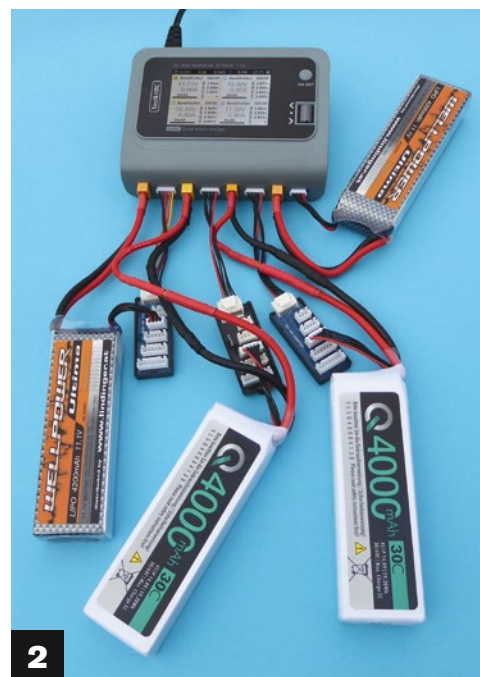
1) Das Display liegt optimal im Blickfeld, mit der Rolltaste gelangen die Einstellungen mühelos. 2) Für einen parallelen Ladevorgang werden die Akkus direkt von vorn angeschlossen, dabei sollte man aus Sicherheitsgründen auch Adapter verwenden
