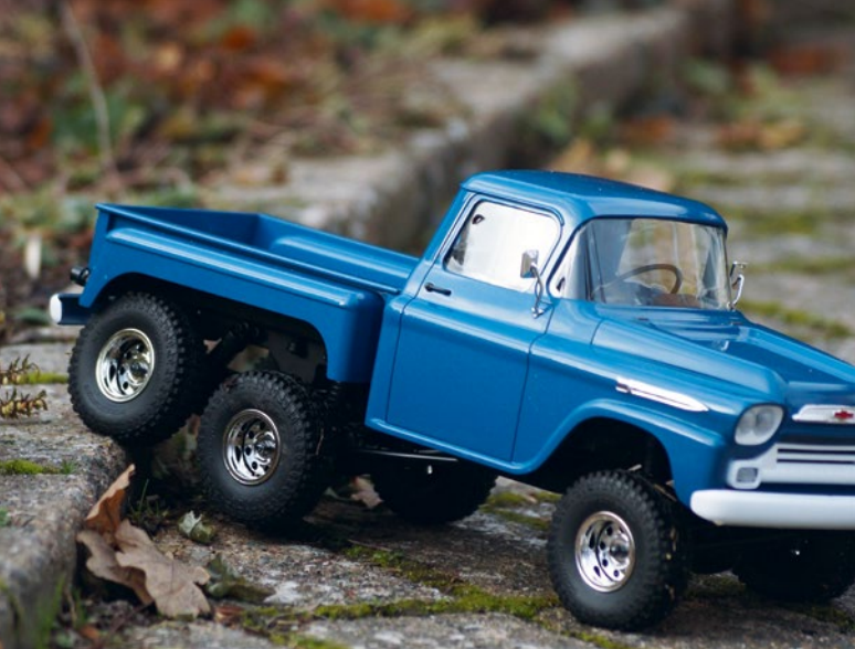
Alle drei Achsen arbeiten wirklich unabhängig voneinander
