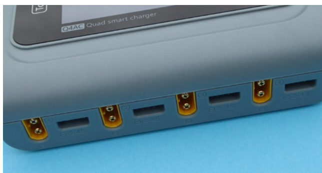
Für jeden Ausgang gibt es einen XT60- und einen Multi-Balancer-Port nach EH- und XH-Norm
