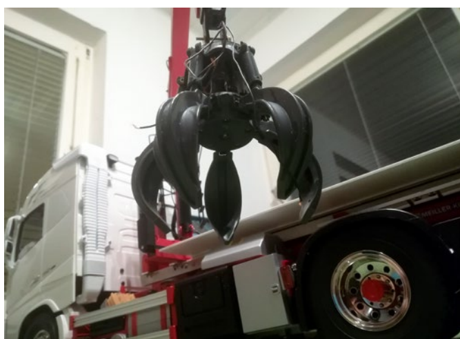
Erster provisorische Versuch mit dem umgebauten Greifer
