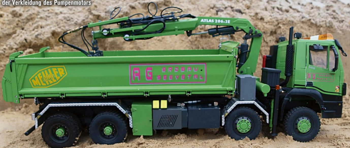
Hier noch einmal die rechte Seite mit den Staukästen und den Unterlegkeilen auf der Verkleidung des Pumpenmotors
