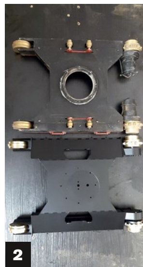
1) Zahnradkaskade für den Raupenantrieb. 2) Überwiegend besteht der neue Unterwagen aus Stahl. 3) Hier der Vergleich vom alten Lager unten und dem gekapselten Lager oben
