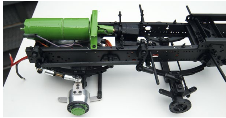
Der Motor ist wieder an seinem Platz. Darunter ist der Fahrregler positioniert
