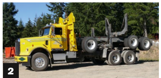
1) Ein einachsiger Trailer und ein Dreiachsanhänger bilden die A-Train-Kombination. Drehschemel sind auf dem Hals des ersten Trailers sowie dem Lastschwerpunkt am Anhänger montiert. 2) Für die Leerfahrt ist der Anhänger verladen. Die Anhänger werden an den Ladestellen mit der Verladetechnik von den Zugmitteln gehoben
