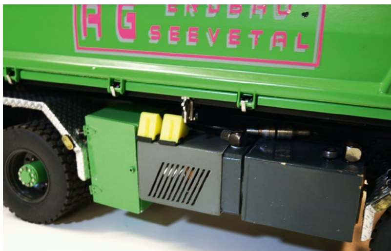
So sieht die fertige Verkleidung für den Pumpenmotor mit Unterlegkeilen aus
