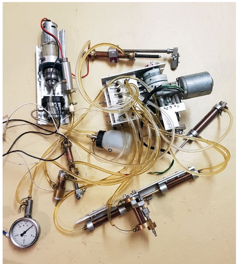
Die hydraulische Waffenanlage, die gegen eine elektrische ausgetauscht wurde
