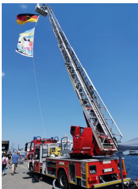
Die Drehleiter DLA (K) 23/12 der Kieler Bundeswehrfeuerwache erreicht bis zu 30 m
