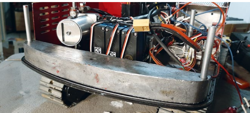
Inklusive fertigem 1,73-kg-Bleigewicht kommt das Heckgewicht schlussendlich auf 3,5 kg
