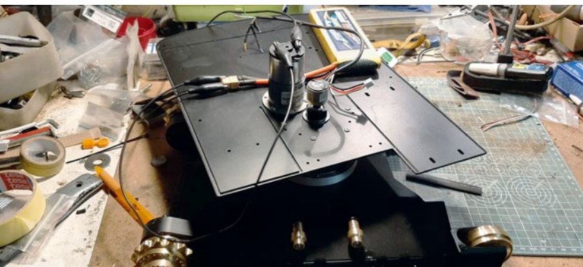
Der neue Unterwagen soll weniger Spiel zulassen. Die Drehbewegung erfolgt weiterhin elektrisch
