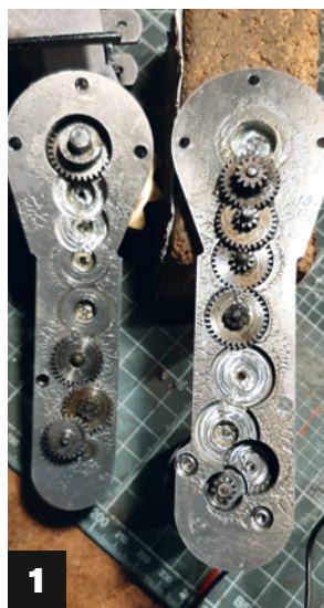
1) Zahnradkaskade für den Raupenantrieb. 2) Überwiegend besteht der neue Unterwagen aus Stahl. 3) Hier der Vergleich vom alten Lager unten und dem gekapselten Lager oben
