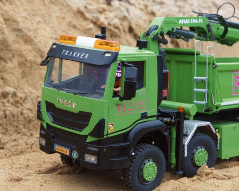
Das Fahrerhaus mit Beschriftung und weiteren Details. Hinter dem Scheinwerferglas sind die SMD-LEDs gut zu erkennen
