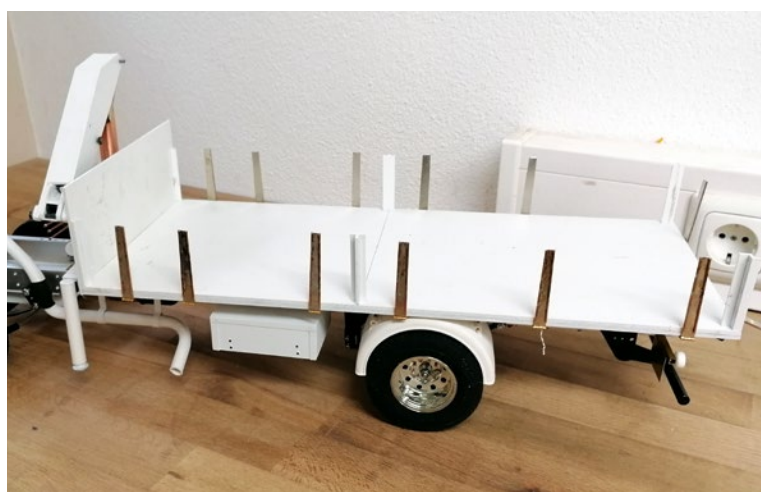
Wie die Kranattrappe besteht die Pritsche aus einem Materialmix. Als Basis dienen verschieden starke ABS-Platten
