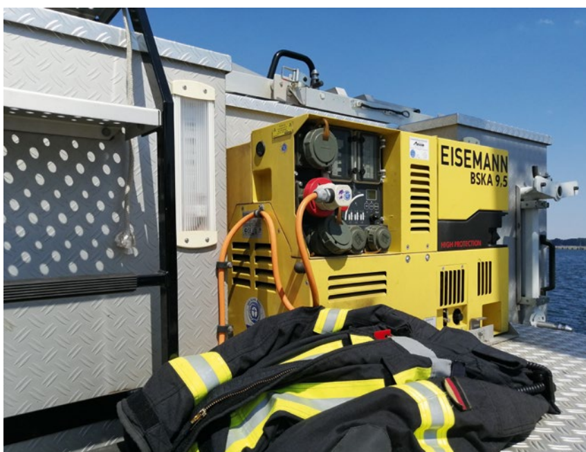
Der Stromerzeuger Eisemann BSKA 9.5 E wiegt 142 kg und liefert 9kVA bei einem Nennstrom von 13/16A sowie einer Nennspannung von 400/230V
