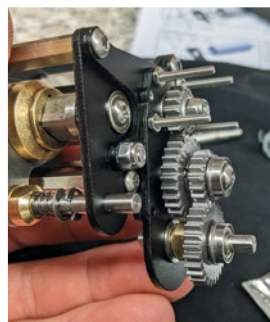
Das Modell-Upgrade besteht aus glasfaserverstärktem Kunststoff, gefrästem Stahl sowie Aluminium
