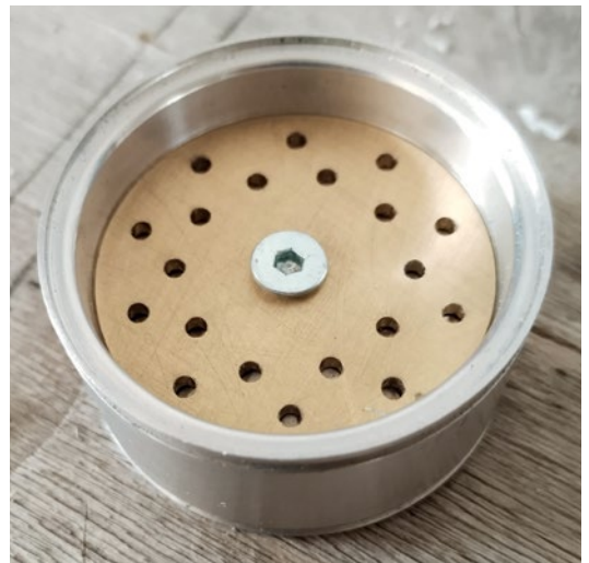
Die Schablone wurde auf die Felge gelegt und das Paar dann an der Werkbank festgeschraubt
