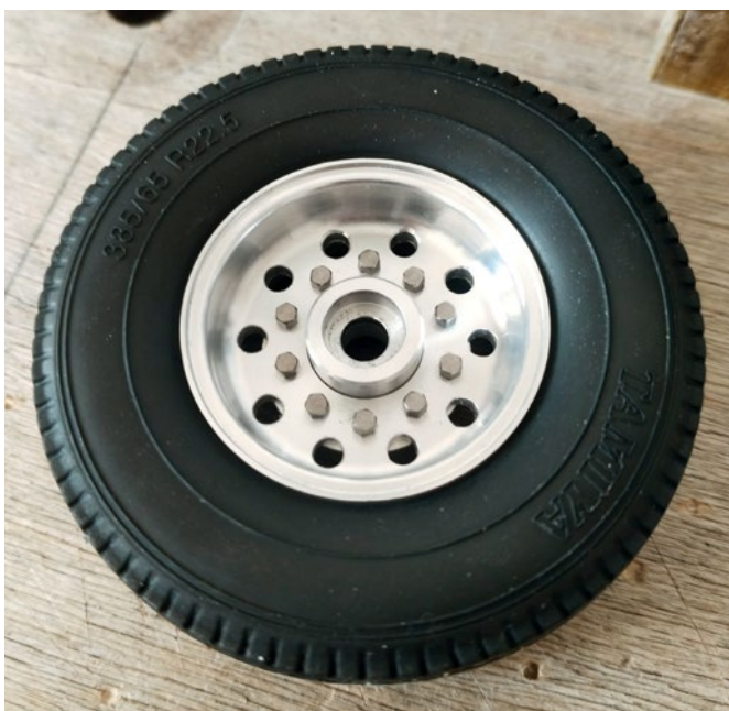
Mit einem 2-mm-Bohrer wurden die Bohrungen dann in der Alufelge eingebracht
