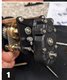
1) Weil TRUCKS & Details-Autor Christian Kamp keinen Baubericht fand, entschloss er sich dazu, selbst einen anzufertigen. 2) Ein kleiner unpassender Grat im Getriebe wurde mittels Feile etwas geglättet
