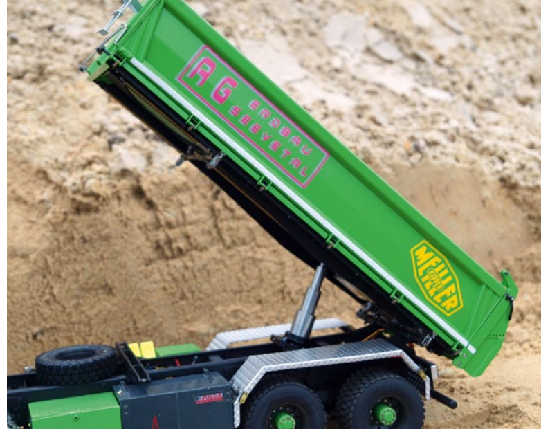
Die Kippbrücke und der Kippzylinder, der hier bei dem Vierachser sehr weit hinten sitzt
