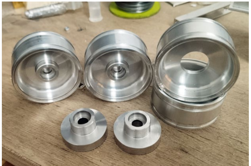
Die Alufelgen sowie die passenden Radnaben wurden CNC-gedreht
