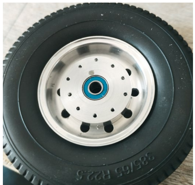
Zum Schluss wurde die Radnabe auf die Felge gelegt und über die Mittelbohrung fixiert
