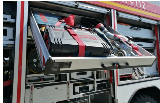
Werkzeug hat in nicht nur auszieh-, sondern auch abklappbaren Fächern seinen Platz
