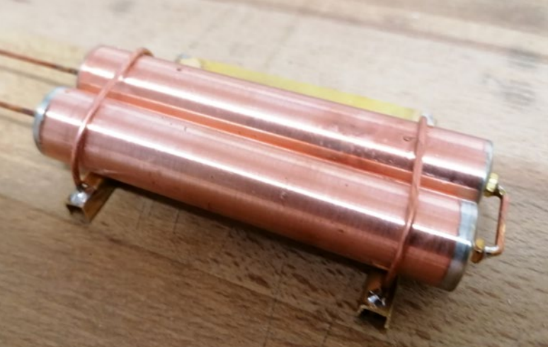
Kupfer und Messing werden gerne genutzt. Hier zum Beispiel für den Druckluftkessel
