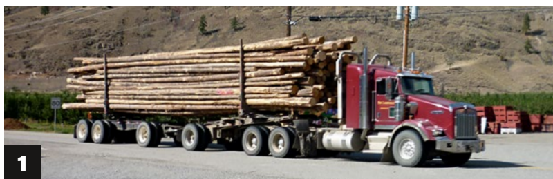
1) Ein einachsiger Trailer und ein Dreiachsanhänger bilden die A-Train-Kombination. Drehschemel sind auf dem Hals des ersten Trailers sowie dem Lastschwerpunkt am Anhänger montiert. 2) Für die Leerfahrt ist der Anhänger verladen. Die Anhänger werden an den Ladestellen mit der Verladetechnik von den Zugmitteln gehoben
