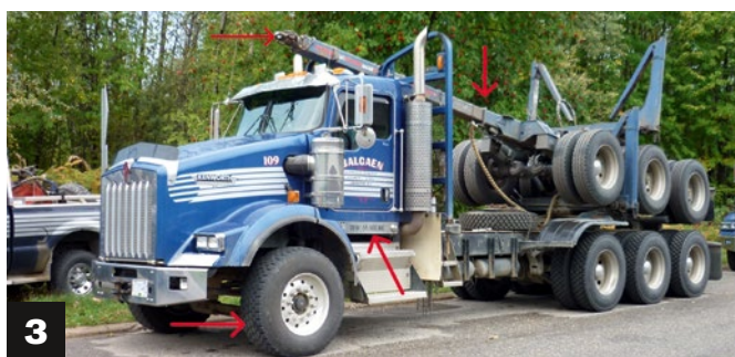
3) Die Rahmenbauweise des Anhängers mit der Stingerführung und den Klapprungen. Auf der Tür das GVW von 55.500 kg, auf der Vorderachse der Breitreifen. Für den Längenausgleich sorgt die Zugöse mit Schiebestück. 4) Im hinteren Teil des Anhängerrahmens sind der durchgesteckte Stinger sowie das Leitungsbündel zwischen Zugmaschine und Anhänger zu erkennen
