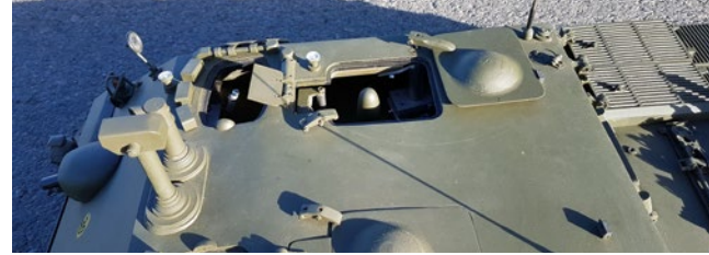
Der Bau der Hebe-Schwenk-Mechanik des Lukendeckels war komplex, ...
