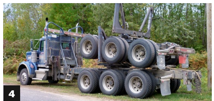
3) Die Rahmenbauweise des Anhängers mit der Stingerführung und den Klapprungen. Auf der Tür das GVW von 55.500 kg, auf der Vorderachse der Breitreifen. Für den Längenausgleich sorgt die Zugöse mit Schiebestück. 4) Im hinteren Teil des Anhängerrahmens sind der durchgesteckte Stinger sowie das Leitungsbündel zwischen Zugmaschine und Anhänger zu erkennen
