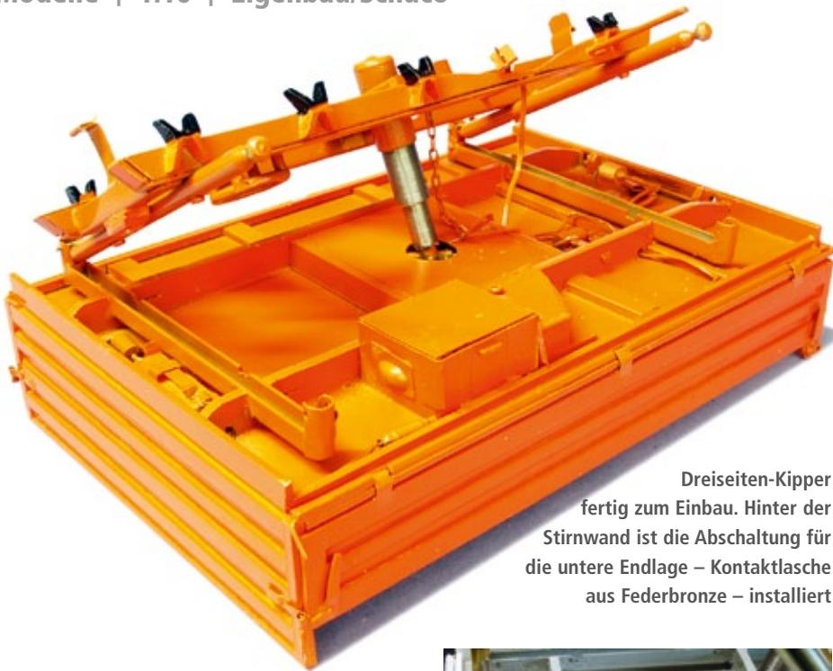
Dreiseiten-Kipper fertig zum Einbau. Hinter der Stirnwand ist die Abschaltung für die untere Endlage – Kontaktflasche aus Federbronze – installiert
