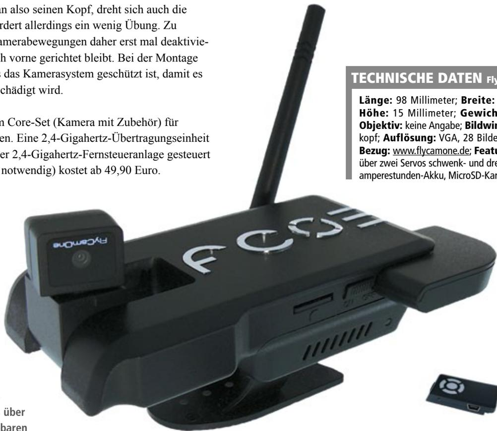
Zum Starter-Set von GlobeFlight gehört auch eine Kamera, die mit zwei Servos geschwenkt und gedreht werden kann
