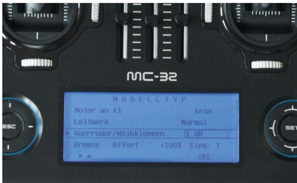
Die mc-32 wurde für den Flugmodellbau entwickelt. Die Auswahl eines Flächenprogramms ohne V-Leitwerk und mit nur einem Querruderservo (als Lenkservo) bietet sich aber auch für RC-Trucks an
