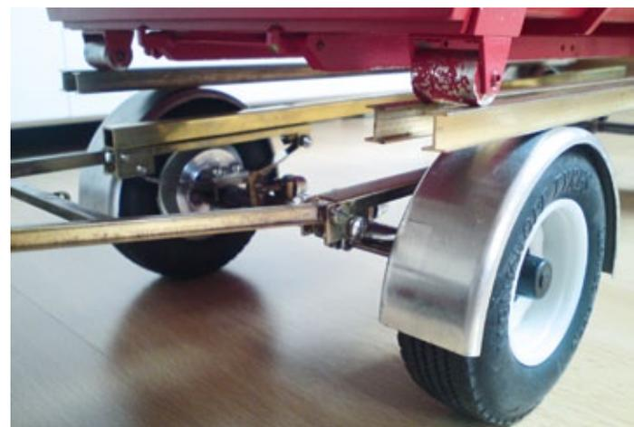
Die detaillierte Vorderachse mit Bremstrommeln und Zylindern im Blick. Auch schön zu erkennen: die Alukotflügel im Rohbau noch ohne Halter
