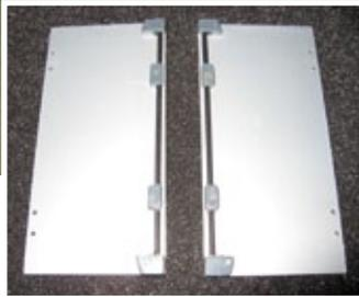
Der fertige Aufleger und die Türen bereit für die Farbe. Gut zu erkennen ist der Rahmen aus Klebeband, der dem Container nach der Lackierung die entsprechende Struktur verleiht
