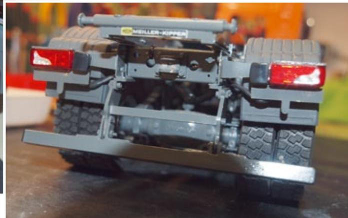
seitlichen Begrenzungsleuchten handelt es sich um orange 2 x 4-mm-LED. In den Rundumleuchten auf dem Dach sind je vier SMD eingebaut, die mit einer Conrad-Platine gesteuert werden. Die Plusleitungen der gesamten Beleuchtung sind auf der zentralen Verteilerplatine angeschlossen. Die Minusleitungen werden mit den Ausgängen der Blauzahnanlage verbunden.
