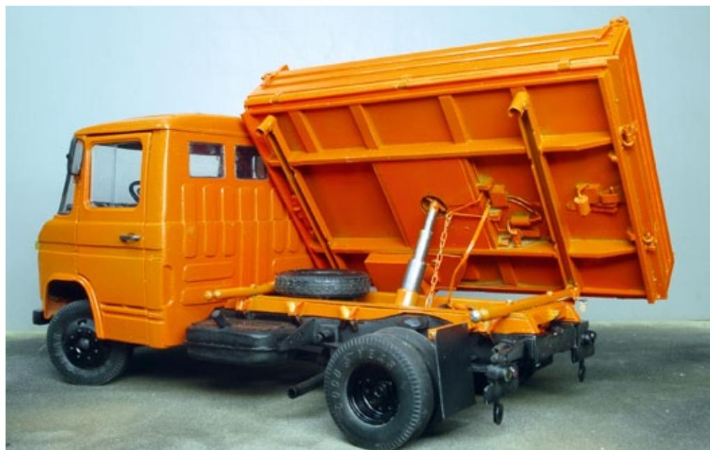
Die Kette ist gespannt und unterbricht über den abgewinkelten, A-förmigen Hebel die Stromzufuhr zum Kippantrieb. Eine parallel geschaltete Diode überbrückt nach Umpolung
