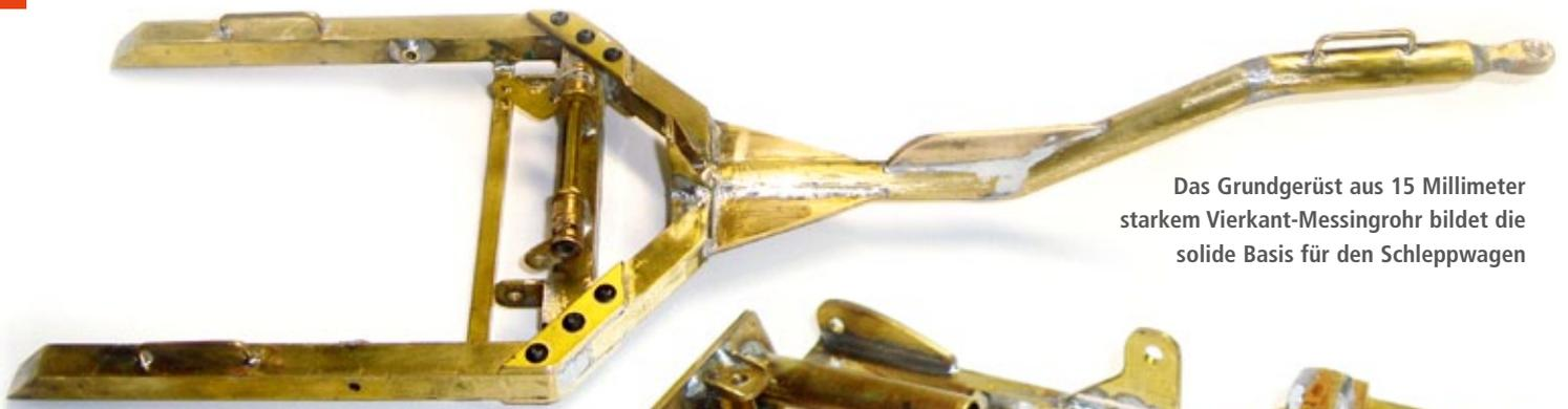
Das Grundgerüst aus 15 Millimeter starkem Vierkant-Messingrohr bildet die solide Basis für den Schleppwagen
