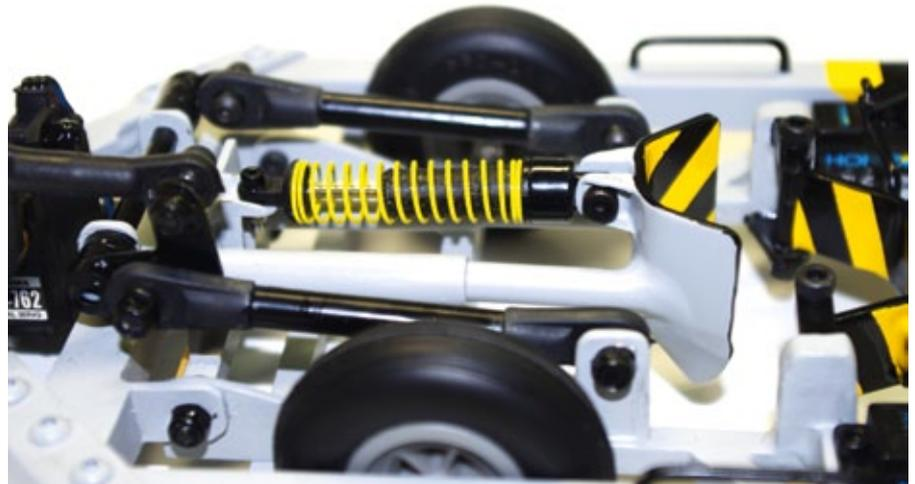
Der Stoßdämpfer am Radschuh stammt von einem RC-Car im Maßstab 1:18. Er ergänzte auch optisch den Schleppwagen hervorragend, zudem funktioniert er durch seine Leichtgängigkeit einwandfrei
