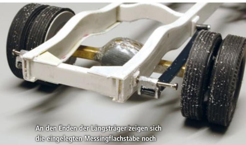
An den Enden der Längsträger zeigen sich die eingelegten Messingflachstäbe noch
