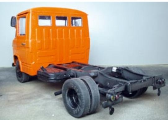
Für Niederrahmenfahrgerüste typisch: über der Hinterachse aufgeschwungene Längsträger
