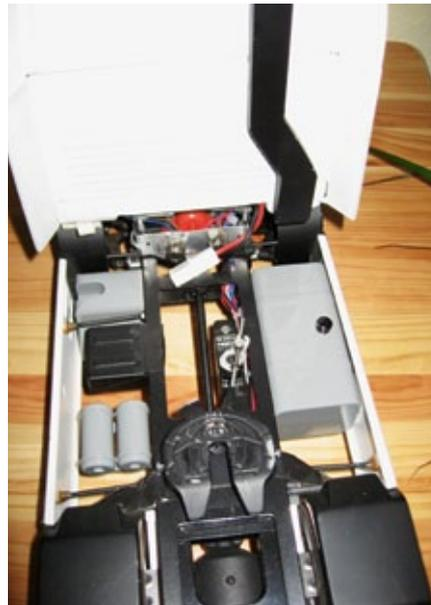
Ein Blick hinter das Fahrerhaus: rechts der gefräste Tank und mittig unter der Kabine die zwei dreipoligen Buchsen sowie der Tamiya-Ladestecker
