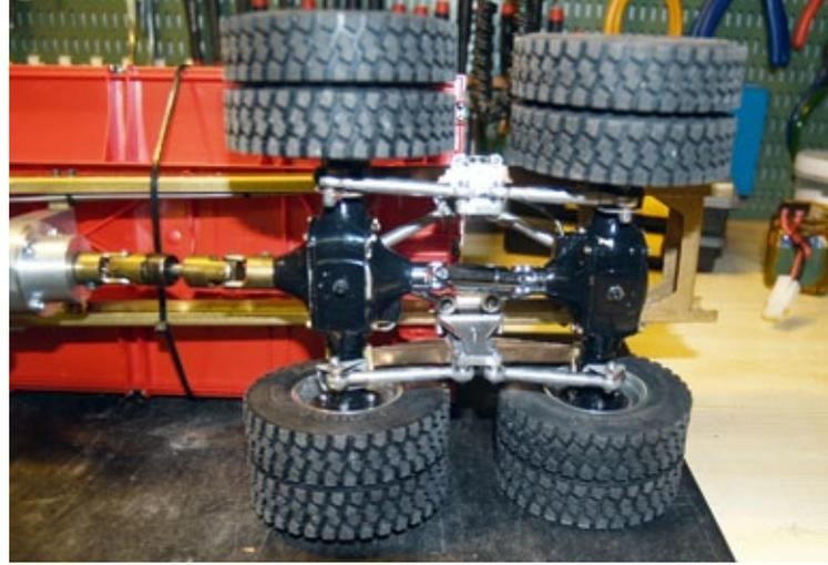
Nach einigen Versuchen entschied ich mich für einen Antriebsmotor von Servonaut. Nachdem die Antriebswelle vom Schalt- zum Verteilergetriebe eingebaut ist, werden Vorder- und Hinterachse montiert und mit dem Verteilergetriebe verbunden. Auch wenn noch nicht alle Achsen vorhanden waren, ließ ich die bisher verbauten Antriebskomponenten einlaufen. Mit einem solchen Testlauf habe ich immer gute Erfahrungen gemacht, zumal sich so auch die Einstellung des Schaltservos ohne Last gut vornehmen lässt.
