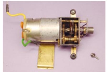
Blick in das Zweigang-Schaltgetriebe; das Ritzel der Motorwelle greift in das große Zahnrad auf der Vorgelegewelle, das – einer hohen Untersetzung geschuldet – über die Hülse zur Motoraufnahme hinausragt
