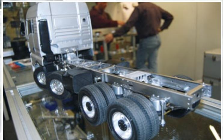
Neu bei Stehr Modellbau ist das MTS 14, ein Luftbalg-Federsystem mit 3D-Achsaufhängung passend für den „Tamiya-Maßstab“
