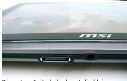
Die untere Seite beherbergt die kleinen Stereo-Lautsprecher und ermöglicht den Anschluss des 12V-DC-Netzteils oder einer optionalen Dockingstation. Diese offeriert neben der Ladefunktion noch einen vollwertigen HDMI-Ausgang, einen weiteren USB-Anschluss und einen Ethernet-LAN-Anschluss
