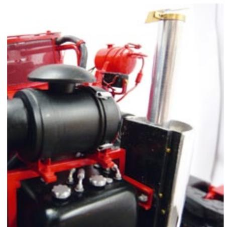
Blick vom Fahrerhaus auf den Schwerlastturm. Die Auspuffrohre werden durch ein Microservo geöffnet und geschlossen
