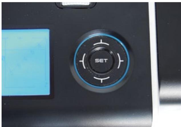
Die Programmierung erfolgt über das berührungsempfindliche Touch-Bedienfeld. Den Außenring kann man entweder „drehen“ oder man tippt wie mit Vierwegetasten auf die entsprechende Richtung. Die Mitte bestätigt – oder springt einen Schritt zurück
