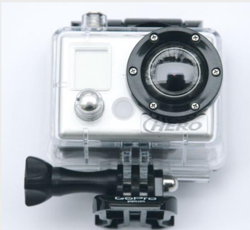
Die GoPro HD 960 ist eine sehr beliebte FPV-Kamera. Im reichhaltigen Zubehörsortiment findet sich auch ein wasserdichtes Schutzgehäuse
