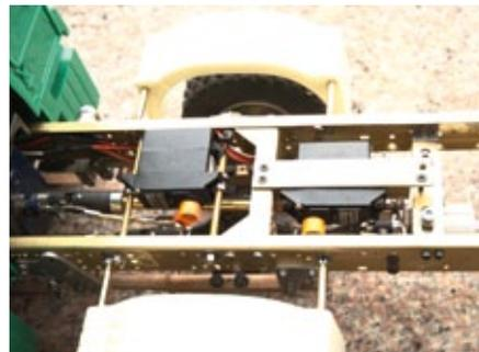
Das linke Servo ist für das Schaltgetriebe, das rechte für die hinteren Differenzialsperren
