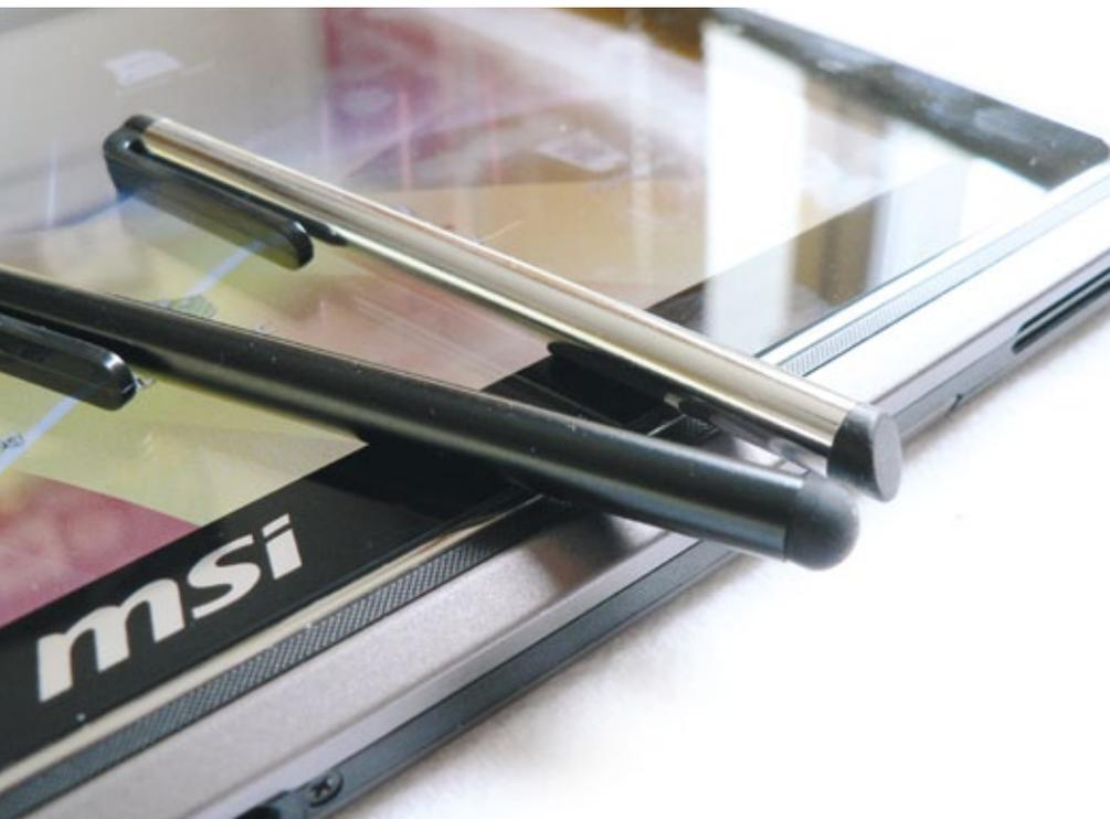
Die CAD-Bearbeitung erfordert den Einsatz eines Bedienstifts, wobei für punktgenaues Arbeiten eine Version mit schräger Spitze zum Einsatz kommen sollte. Alle anderen Arbeiten lassen sich leichter mit einer runden, weichen Spitze erledigen
