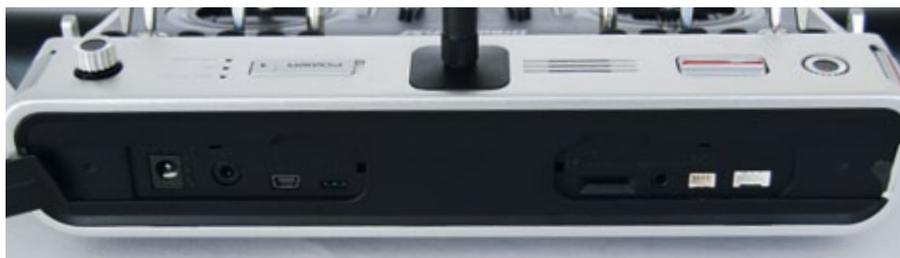
An der Stirnseite der mc-32 liegen unter zwei Abdeckungen acht Schnittstellen verborgen. Von links nach rechts: Ladebuchse, Lehrer-Schüler-Buchse, Mini-USB-Schnittstelle, Data-Anschluss für die Smart-Box, Micro-SD-Slot, Kopfhöreranschluss, Buchse für den Anschluss eines externen HF-Moduls und die noch unbelegte SPI-Schnittstelle
