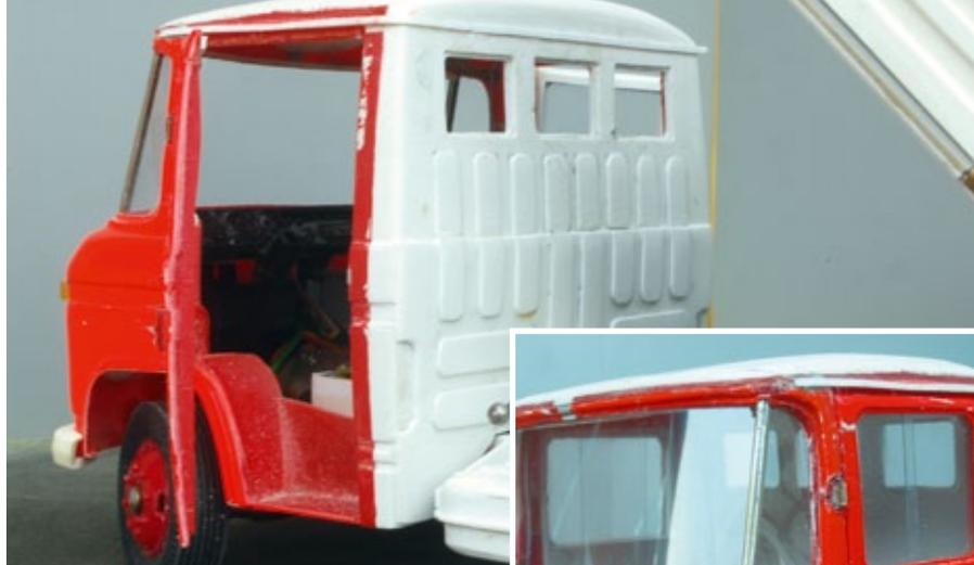
Vom Kastenwagen können nur der Windlauf und die Türen übernommen werden. Dach und Rückwand erfordern Eigenleistung
