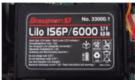
Der 1s-LiPo mit satten 6.000 Milliamperestunden Kapazität genügt für Sender-Betriebszeiten von mindestens fünf Stunden
