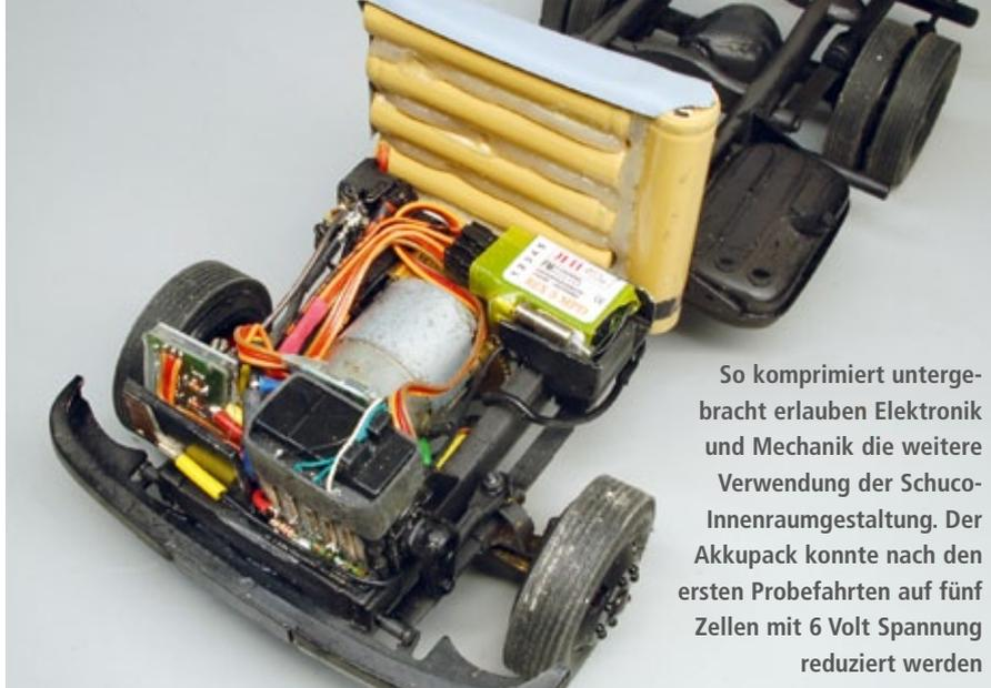
So komprimiert untergebracht erlauben Elektronik und Mechanik die weitere Verwendung der Schuco-Innenraumgestaltung. Der Akkupack konnte nach den ersten Probefahrten auf fünf Zellen mit 6 Volt Spannung reduziert werden
