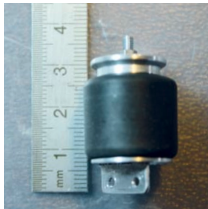
Luftfederbalg der Hinterachse, vier Stück davon übernehmen die Federung; trotz des realistischen Aussehens handelt es sich nur um eine Attrappe
