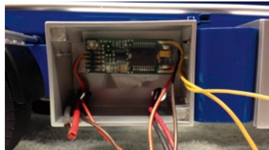
Als Fahrregler kommt ein MFR-Modul von Servonaut zum Einsatz
