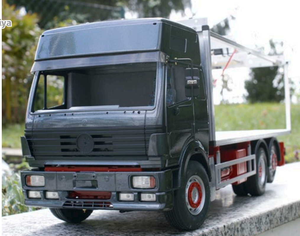
Ein Rahmen aus Aluminium bildet das Grundgerüst für den Schwenkwandaufbau
