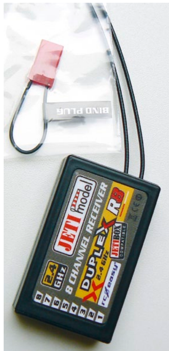
Der Achtkanal-Empfänger mit Bindstecker, wie er im hier beschriebenen Tamiya Scania-Truck verbaut wurde
