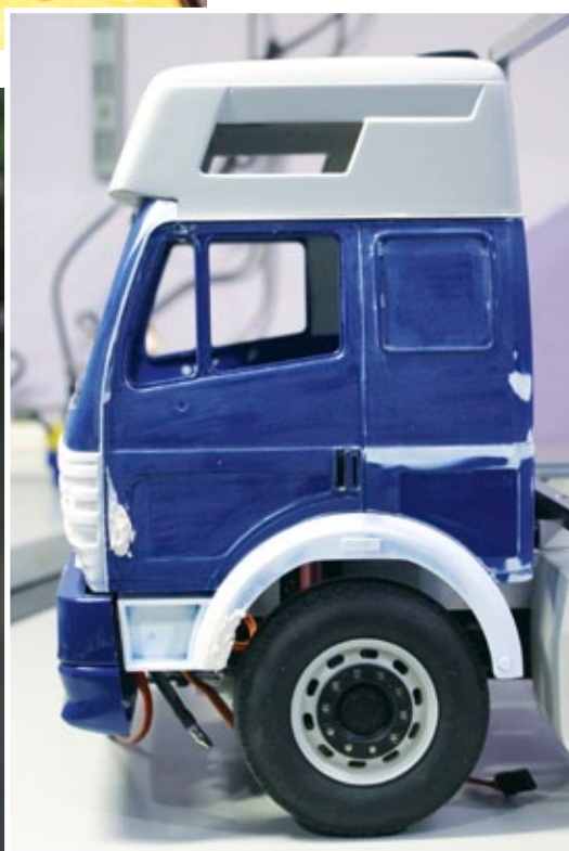
Anprobe: Das Eurocab-Dach wird auf das Fahrerhaus gesetzt. Ebenfalls sind hier die Vorbereitungen für die Kotflügel zu sehen
