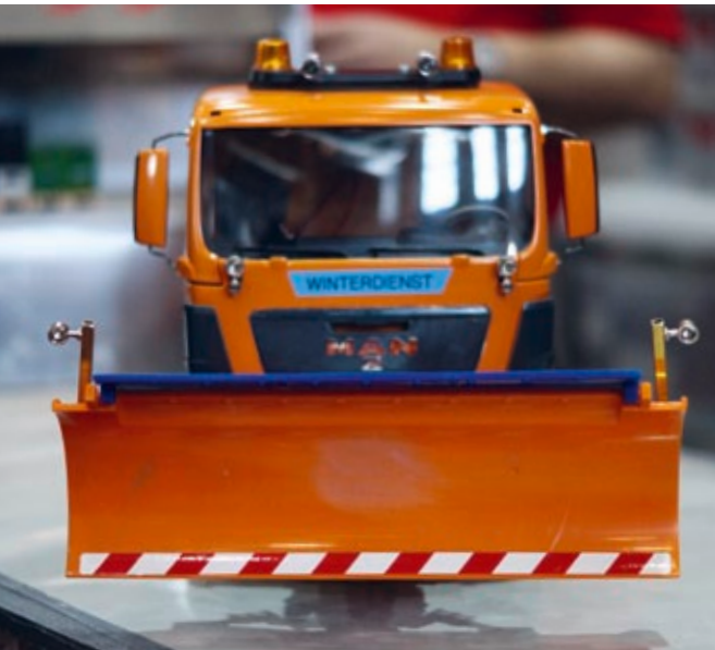
Blick auf das Räumschild. Diese modifizierte Variante von Dickie ist im Bausatz enthalten
