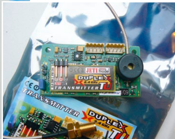
Diese Platine wird in den Sender eingebaut. Gut zu sehen ist links der Anschluss für die Jeti Box
