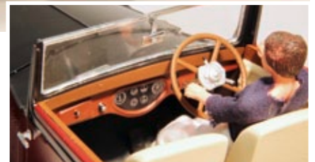
An den beiden Hebeln am Lenkrad stellt man bei Autos aus dieser Zeit den Zündzeitpunkt und das Gemisch ein
