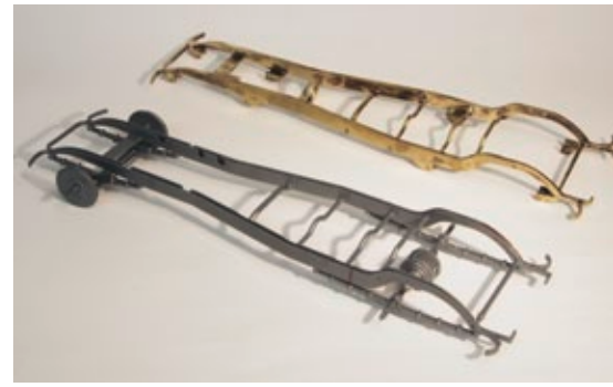
Dank genauer Arbeit ist der Messingrahmen ein exaktes Abbild des Kunststoffrahmens
