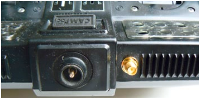
Der vergoldete Antennensockel für den 2,4-Gigahertz-Betrieb
