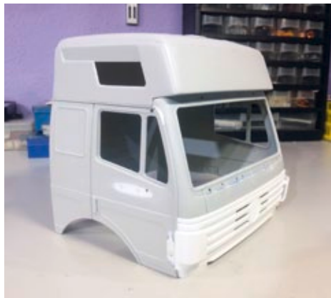
Runter mit der alten Farbe: Ein Bad in Bremsflüssigkeit hat den blauen Lack am Fahrerhaus entfernt
