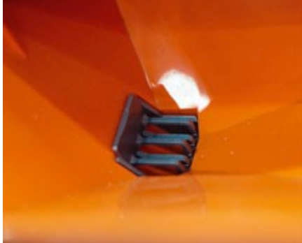
Blick in den Trichter. Ein Gitter sorgt dafür, dass keine zu großen Teile durch die Anlage rutschen und Schäden anrichten
