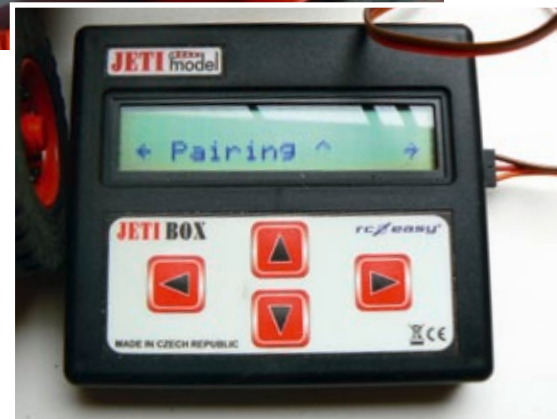
Das Binden von Sender und Empfänger mittels der Jeti Box
