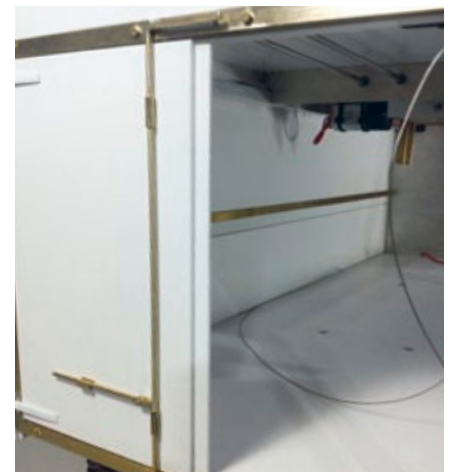
Blick ins Innere des Aufbaus. Man erkennt die Gewindestangen auf der Oberseite, die das gleichzeitige Öffnen von oberer und unterer Tür ermöglichen
