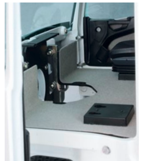
Das Bodenblech des Fahrerhauses wird mit selbstklebendem Velours im gleichen Farbton wie in den Türverkleidungen versehen; für die Sitze sind spezielle Konsolen gedacht
