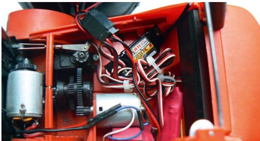
Handlich: Der Einbau eines Fünfkanal-Empfängers in einem robbe-Gabelstapler gestaltet sich weitgehend problemlos
