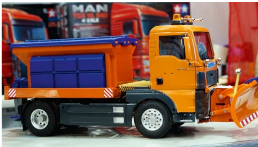
Highlight des Winterdienstfahrzeugs ist der Aufbau. Dieser kann mit Streugut wie beispielsweise Salz befüllt werden
