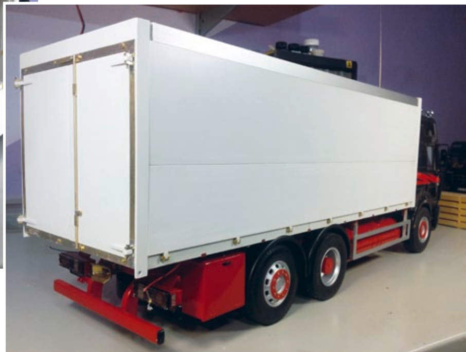
Der fertige und noch unlackierte Schwenkwandaufbau
