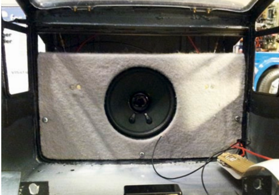
Hinter der Sitzbank ist der Lautsprecher für einen vorbildgetreuen Klang des Mercedes Benz 1838 verbaut
