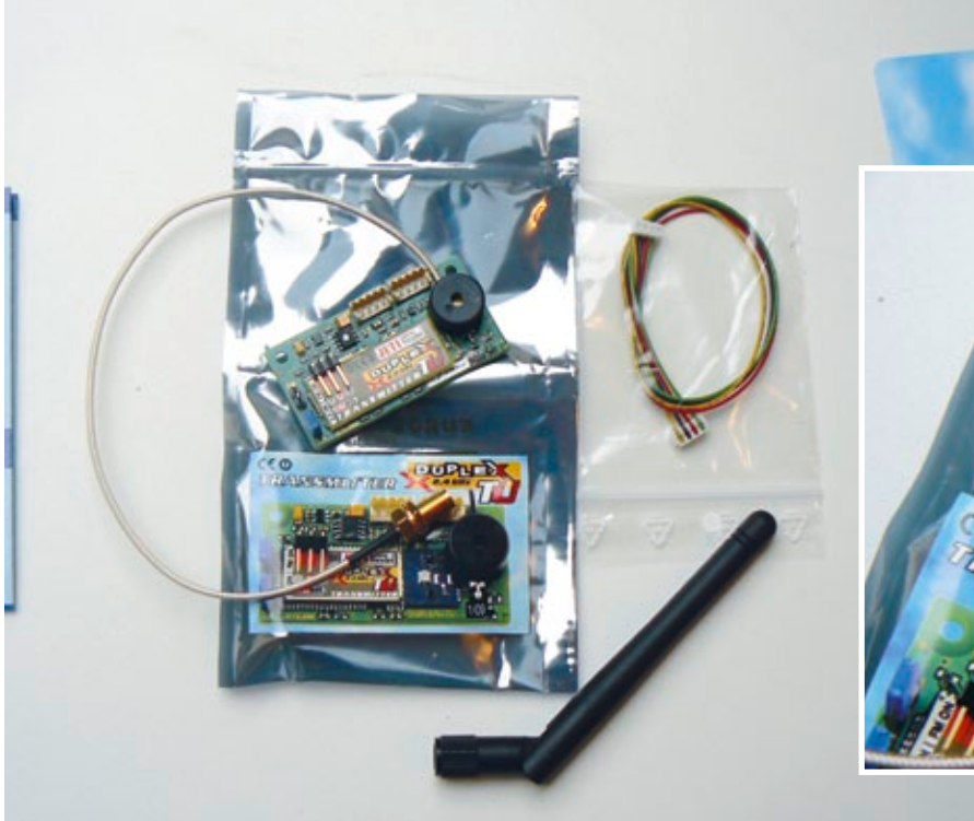
Out of the box: Das Jeti Duplex TU-Sendemodul mit Patchkabel und Antenne
