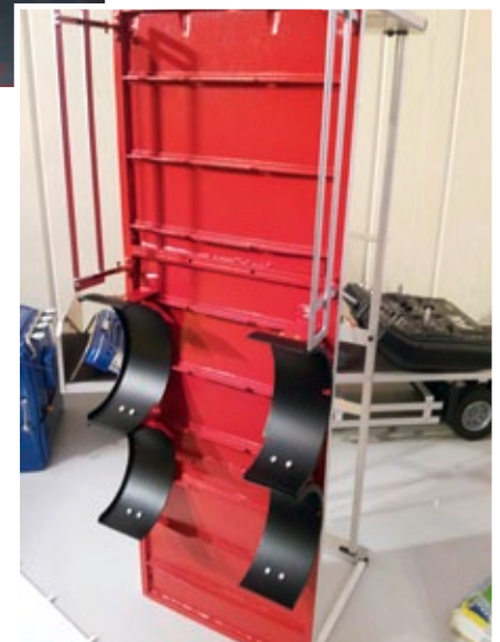
Der lackierte Boden vom Getränkeaufbau. Er besteht aus drei quadratischen Polystyrol-Platten. Querstreben aus 3-Millimeter-Sperrholz sorgen für die nötige Stärke
