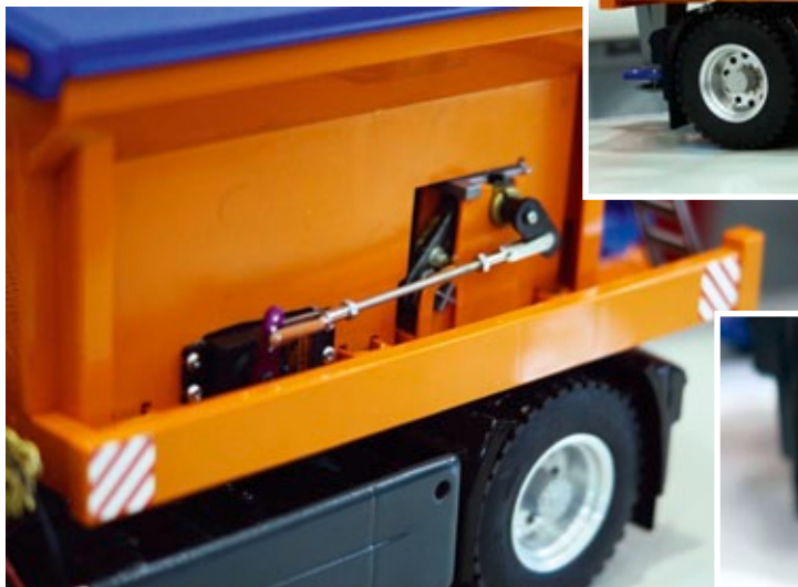
Über ein Servo wird eine Umlenkung gesteuert, die das Streugut auf der Straße aufbringt
