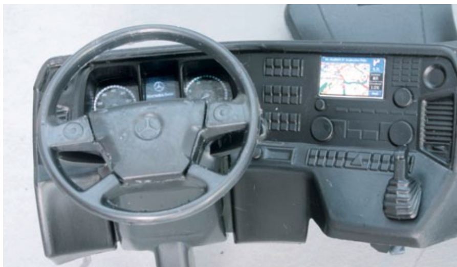
Das Armaturenbrett mit Kombiinstrument und Navi wird vor dem Einbauen komplett montiert
