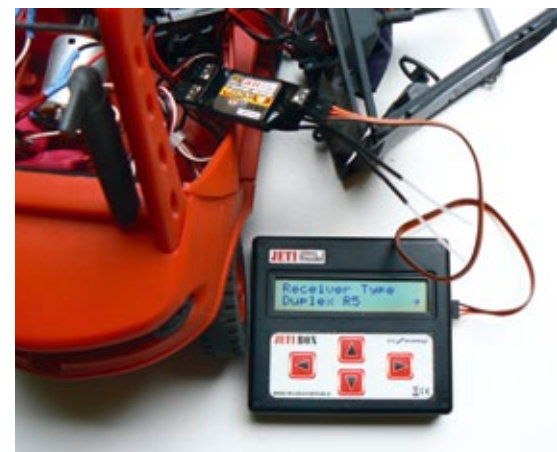
Die Jeti Box erkennt selbstständig, welcher Empfänger angeschlossen ist
