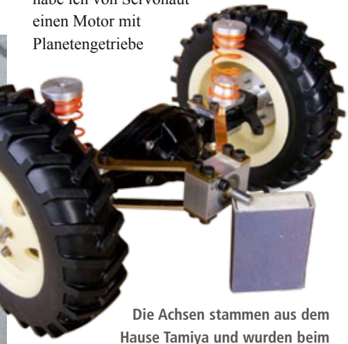
Blick aufs Fahrwerk. Der Motor ist ein GM32U450 von Servonaut
