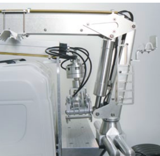
Der zusammengeklappte Kran, abgelegt auf dem Fahrerhaus Schutzgitter. Gut zu erkennen ist der Stammkamm zum Anklemmen der Holzstämm
