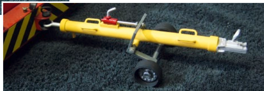
Es kommt Farbe ins Spiel. Beide Halter für die Blattfedern wurden erneuert, der vordere trägt zusätzlich das Hebeservo
