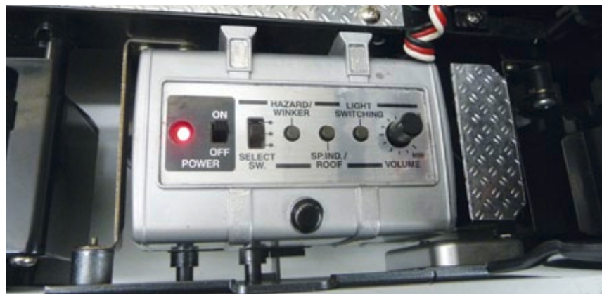
Die Steuereinheit befindet sich im rechten Tank. Schwarz hinterlegt ist der Hauptschalter. Mit dem „Select“-Schalter wird der Fahrmodus gewählt. Mit den Tastern wird die Lichtfunktion geschaltet. Rechts außen wird die Lautstärke geregelt
