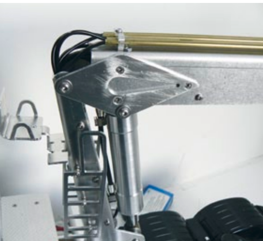
Ausgefräste Stellen, die beim Vorbild durch Schweißnähte mehr Halt geben sollen, sind hier optisch ansprechend umgesetzt
