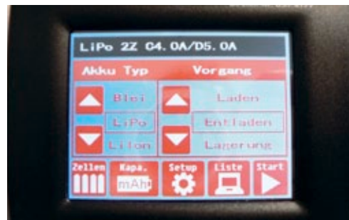
Das große Display ermöglicht einen sehr schnellen Überblick und gibt auf Druck auch den genauen Stand des Balancers bekannt sowie eine Live Vorschau auf die Ladekurve
