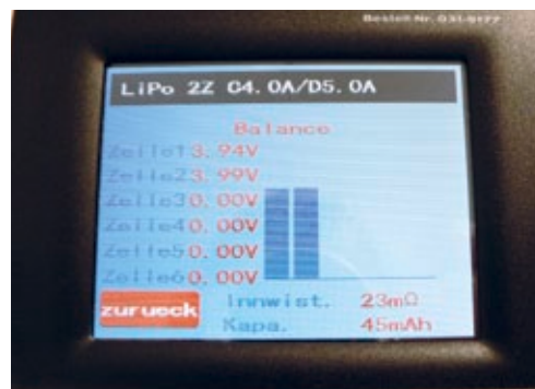
Einen Überblick über die Akkuwerte des Balanceranschlusses kann man sich jederzeit während des Ladens aufrufen. Sogar diverse Parameter und Sicherheitseinstellungen können in einem der fünf Speicher hinterlegt werden
