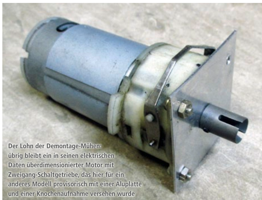
Die richtigen Typen: äußerlich in gebrauchtem Zustand, beinhalten sie das begehrte, da klein bauende Planetenschaltgetriebe
