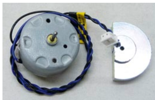
Der kleine Elektromotor mit aufgesetzter Unwuchtscheibe sorgt für die Vibration im Modell
