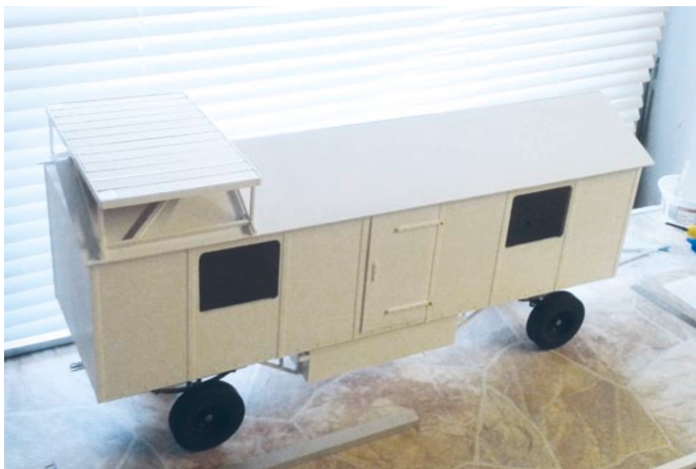
Die Plattform besteht aus einer Art Lattenrost
