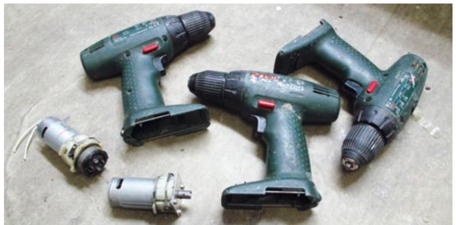
Die richtigen Typen: äußerlich in gebrauchtem Zustand, beinhalten sie das begehrte, da klein bauende Planetenschaltgetriebe
