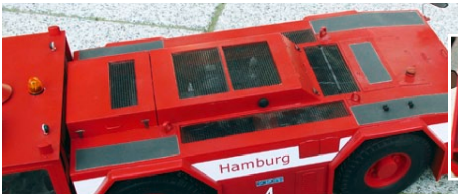
Die zahlreichen Belüftungsöffnungen wurden mit einem geätzten Messinggitter realisiert
