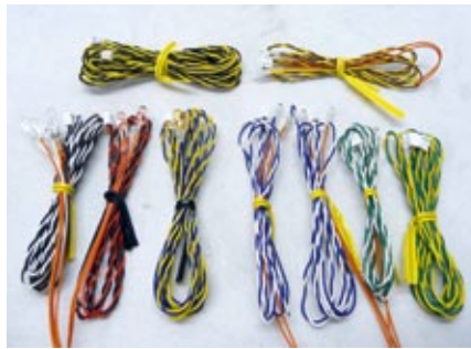
Die 3- und 5-Millimeter-LED sind bereits verkabelt und mit Steckern versehen
