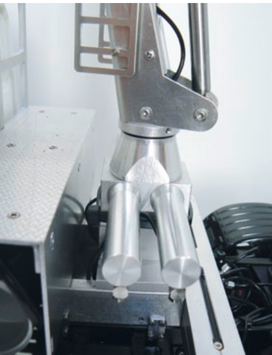
Der Kransockel mit seinen doppelwirkenden Hydraulikzylindern
