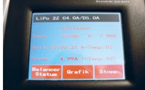
Das große Display ermöglicht einen sehr schnellen Überblick und gibt auf Druck auch den genauen Stand des Balancers bekannt sowie eine Live Vorschau auf die Ladekurve
