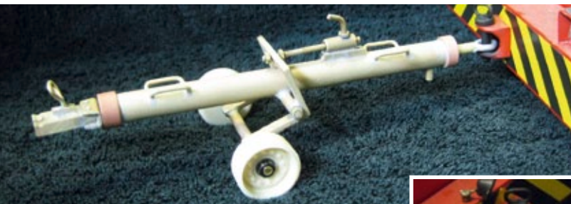
Die Schleppstange wurde nach dem Verlöten gesandstrahlt, die Räder sind aus Resin. Die Höhenverstellung ist funktionsfähig
