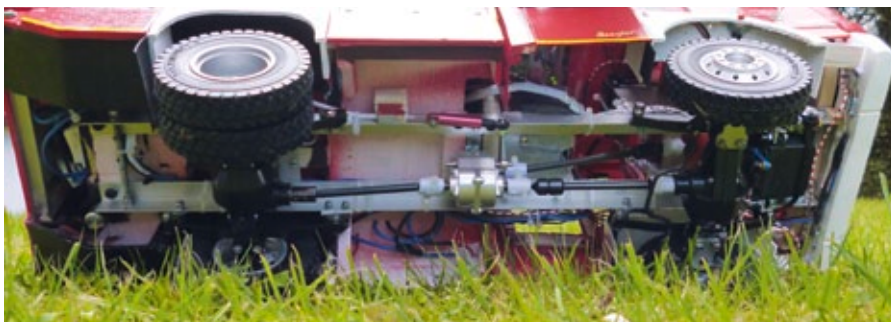
Ein Blick unter das Modell: Das Verteilergetriebe ist gut zu erkennen
