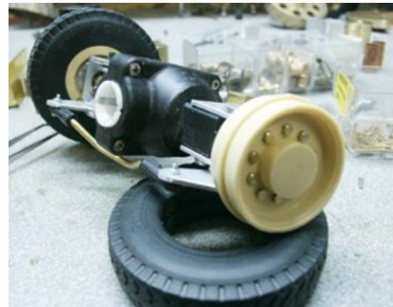
Die Achse ist einbaufertig. Durch eine Reihe von Einzelmaßnahmen konnte die erforderliche Spurweite erreicht werden. Die Felgen werden durch zehn Sechskantschrauben auf den Naben gehalten
