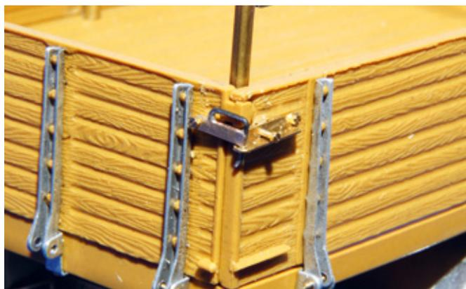
Die Verschlüsse der Ladebordwände sind im Eigenbau entstanden
