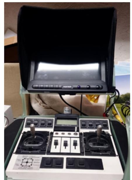
Das komplette Senderpult aus Fahrersicht: Die Lichtschutzhaube lässt sich demontieren.
