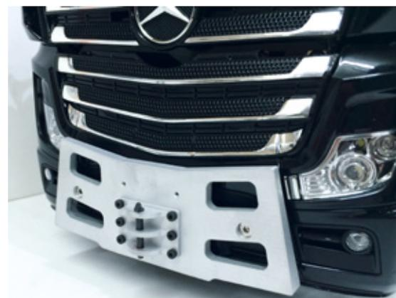
Die Doppelregisterkupplung wird an den vorhandenen Bohrungen der Frontschürze befestigt. Im oberen Bereich kann noch der Nummernschildhalter angebracht werden
