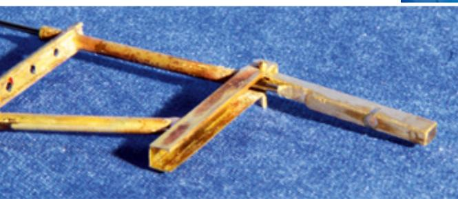
Der Stahl schiebt sich aus dem Rohr und drückt dadurch den Winker nach außen
