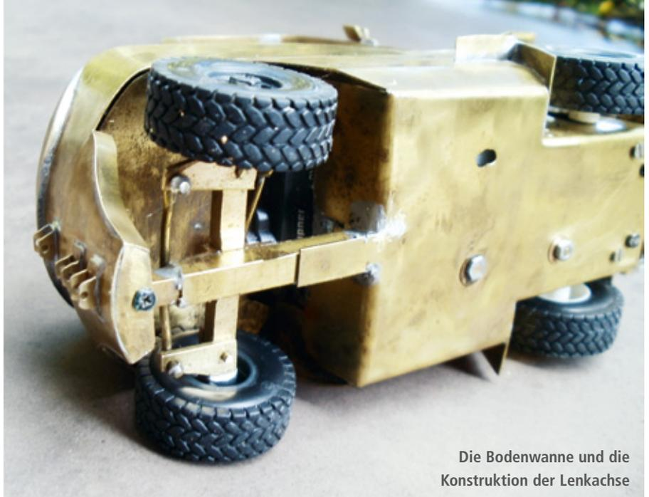
Die Bodenwanne und die Konstruktion der Lenkachse
