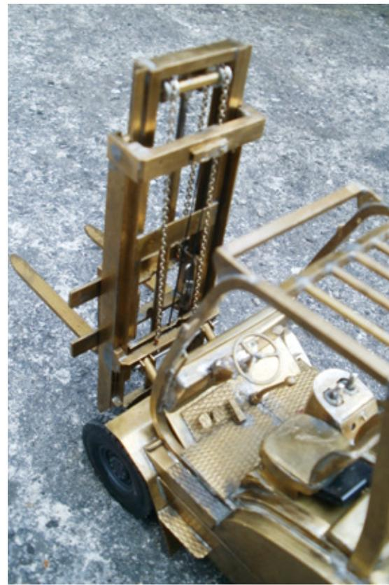
Am oberen Ende des inneren Rahmens sind die Umlenkrollen der Hubketten eingebaut
