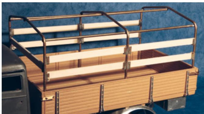
Der Holzspriegelaufbau ist ein Eigenbau aus Messing und Holz aus dem Schiffsmodellbau
