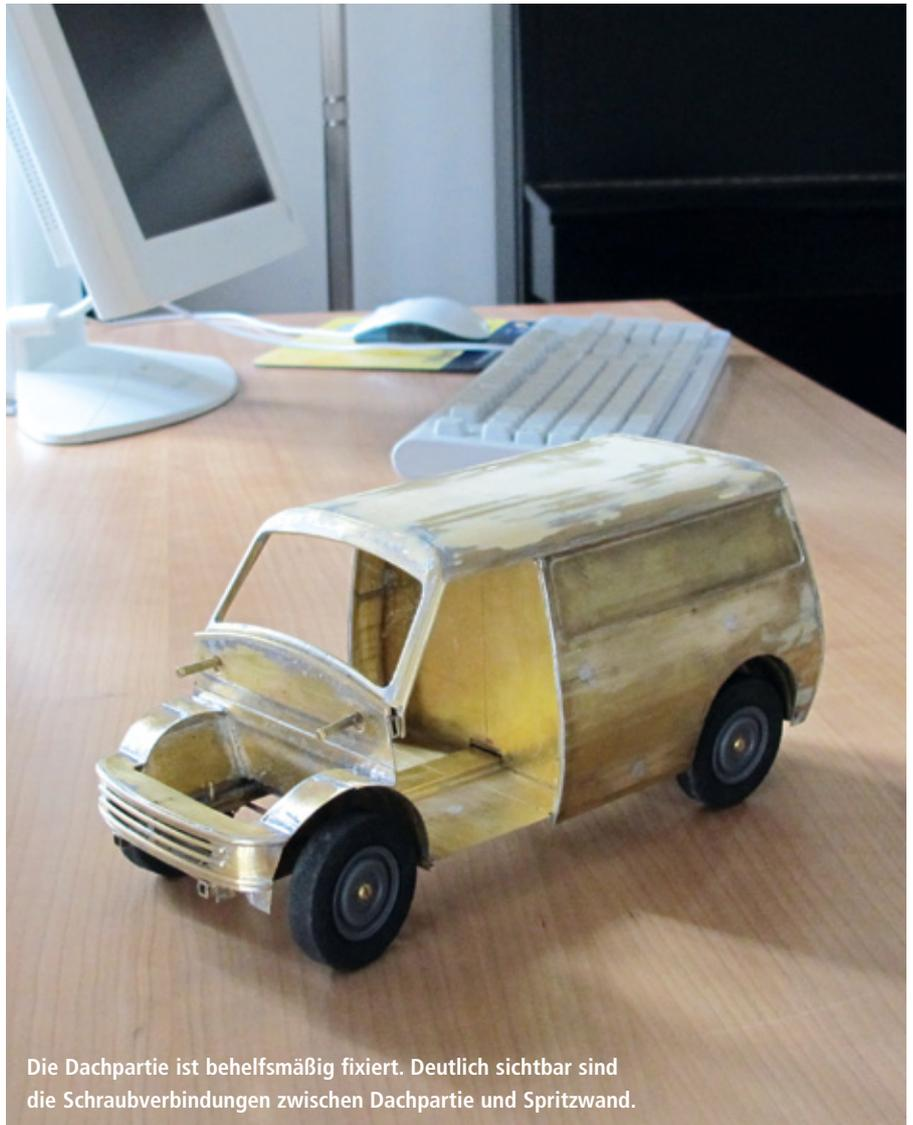
Die Dachpartie ist behelfsmäßig fixiert. Deutlich sichtbar sind die Schraubverbindungen zwischen Dachpartie und Spritzwand.
