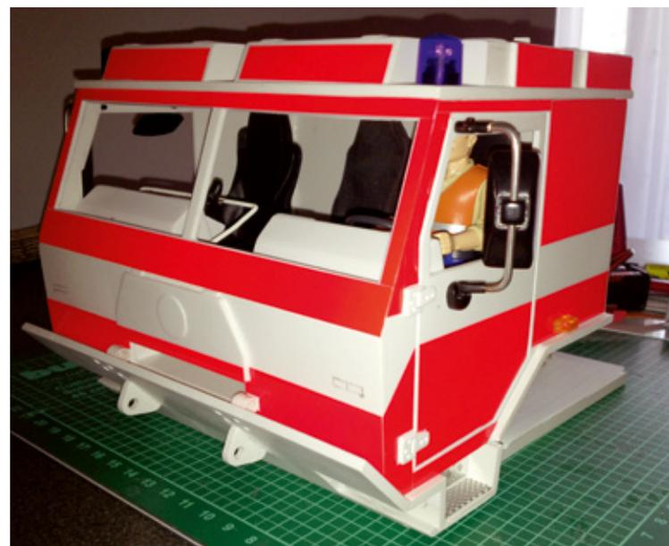
Die Folienbeklebung ermöglicht bei Schäden einen schnellen Austausch
