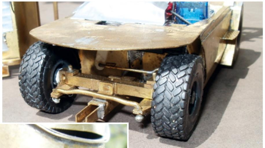
Aufhängung und Anlenkung der Lenkachse sind auf diesem Bild gut zu erkennen
