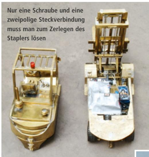
Nur eine Schraube und eine zweipolige Steckverbindung muss man zum Zerlegen des Staplers lösen
