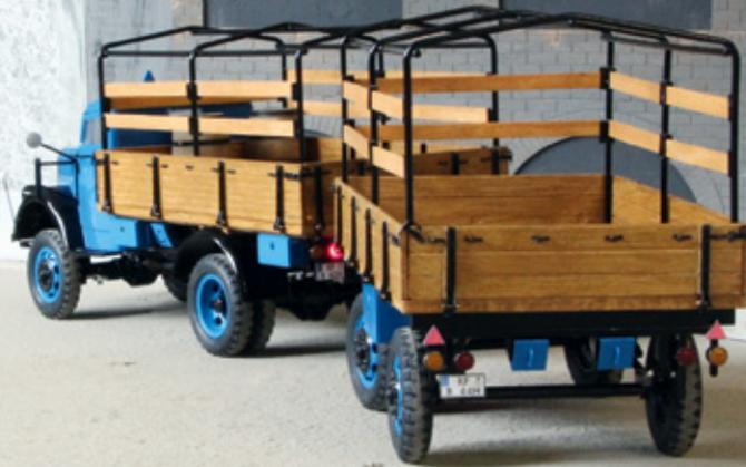
Aufgrund des Drehschemels läuft der Anhänger gut hinter dem Zugfahrzeug her, rückwärts rangieren ist allerdings Übungssache
