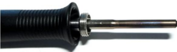
Zum Wechseln der Dauerlötspitzen werden die Rändelschraube gelöst ...
