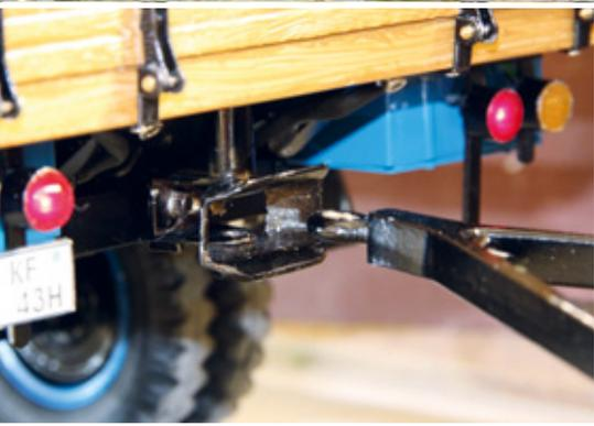
Dank der automatischen Anhängerkupplung und der Feder an der Deichsel kann der Opel jederzeit völlig selbstständig seinen Anhänger aufnehmen oder abstellen
