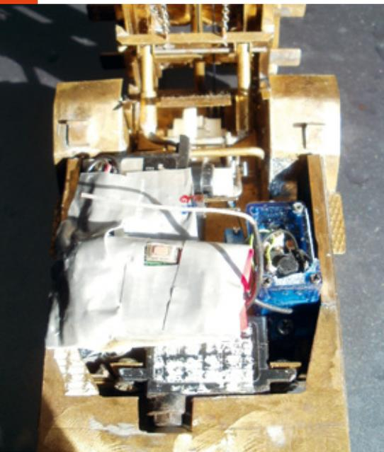
In der Bodenwanne sieht man vorne das Lenkservo, blau ist das modifizierte Servo für den Hubantrieb und vorne das Servo zum Neigen des Hubmasts
