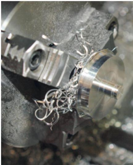
Die rohe Form der Nabendeckel ist so weit gedreht. Man erkennt den Einstich für den O-Ring, welcher später den Nabendeckel in Position halten wird
